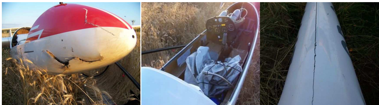
Fot. 1-3. Widoczne uszkodzenia przodu kadłuba, tablicy przyrządów i ogona
