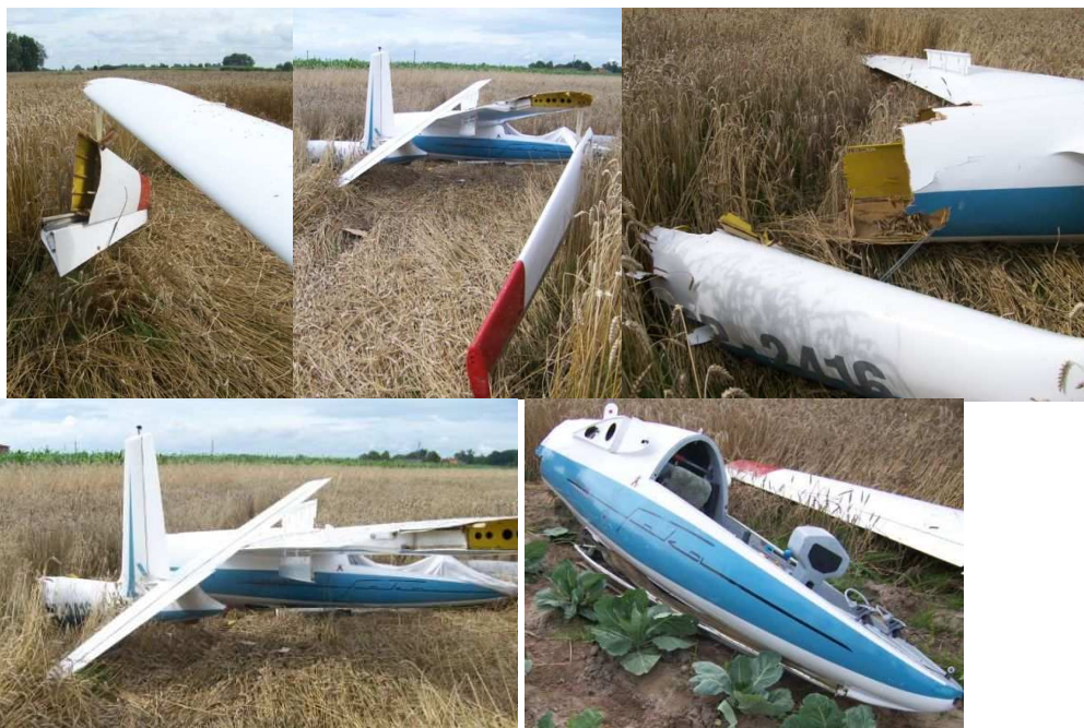
Fot.1-5. Widoczne uszkodzenia prawego skrzydła i kadłuba szybowca SZD-24-4A Foka o znakach SP- 2416
