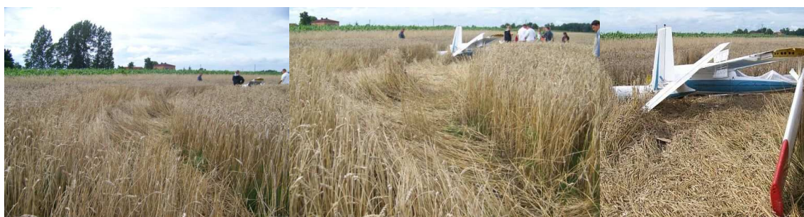
Fot. 6. Ślad przyziemia B; 7. Ślad obrotu szybowca C; 8. Szybowiec po zatrzymaniu D
