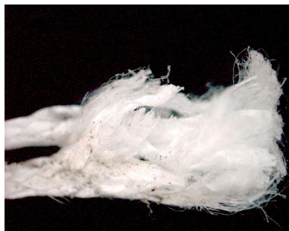
fot. 10. Widoczne częściowe przecięcie i częściowe rozerwanie pętli zamykającej
