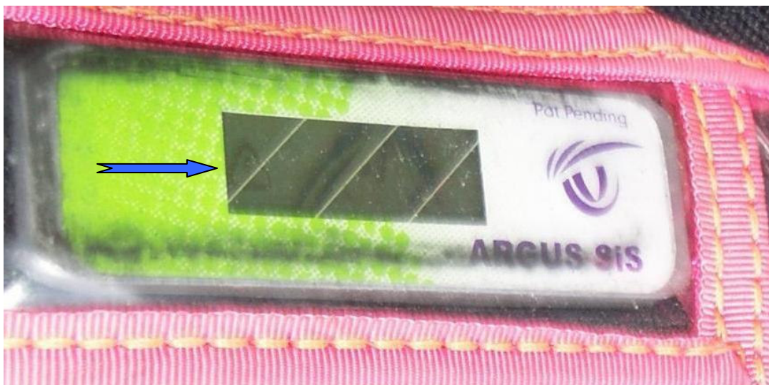
fot. 8. Widoczne uszkodzenie wyświetlacza ciekłokrystalicznego. Niebieska strzałka wskazuje wyświetlony znak.
