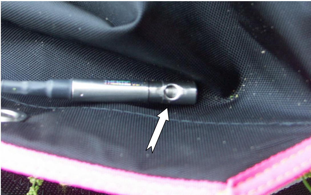
fot. 3. Widok końcówki tnącej automatu AAD. Strzałka wskazuje otwór w korpusie zamknięty przez nóż.
