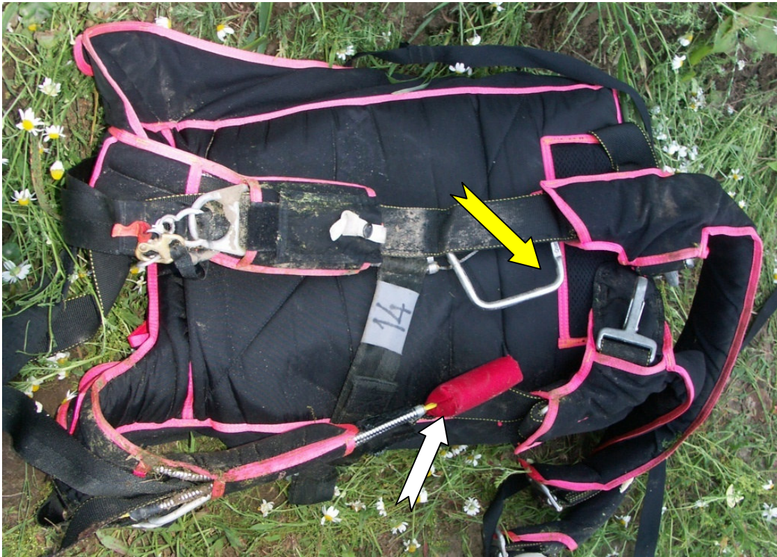
fot. 7. Widok na plecową część pokrowca. Na uprząży widoczne niewyciągnięte uchwyty wyczepiania czaszy głównej (biała strzałka) i otwierania czaszy zapasowej (żółta strzałka).
