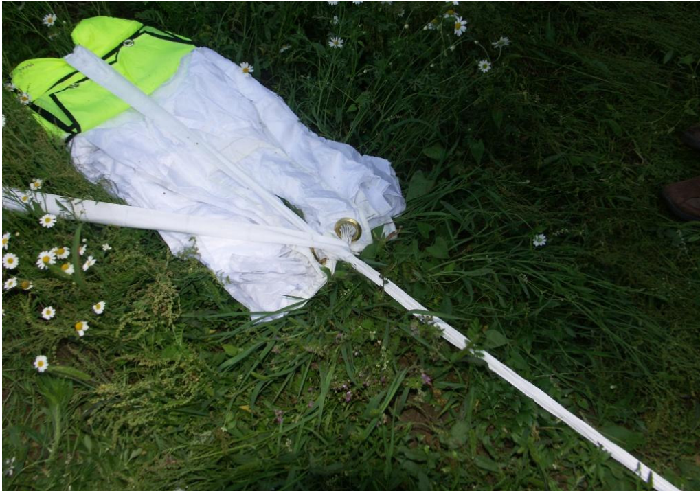
fot. 2. Widok czaszy zapasowej, częściowo wysuniętej z osłony i osłony z taśmą łączącą oplatającą linki.
