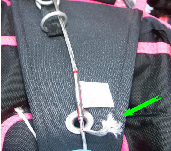
fot. 4. Widok zawleczki uchwytu otwierania czaszy zapasowej i górnej części pętli zamykającej. Zielona strzałka wskazuje nierówny koniec rozdzielonej pętli zamykającej.
