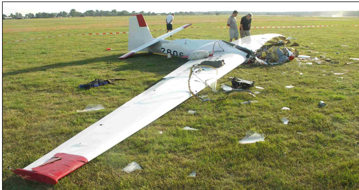
8 – Rozbity szybowiec, widok ogólny, prawa strona. Dobrze widoczne prawe skrzydło szybowca. Poważniejsze uszkodzenia prawego skrzydła zlokalizowane przy końcówce.
