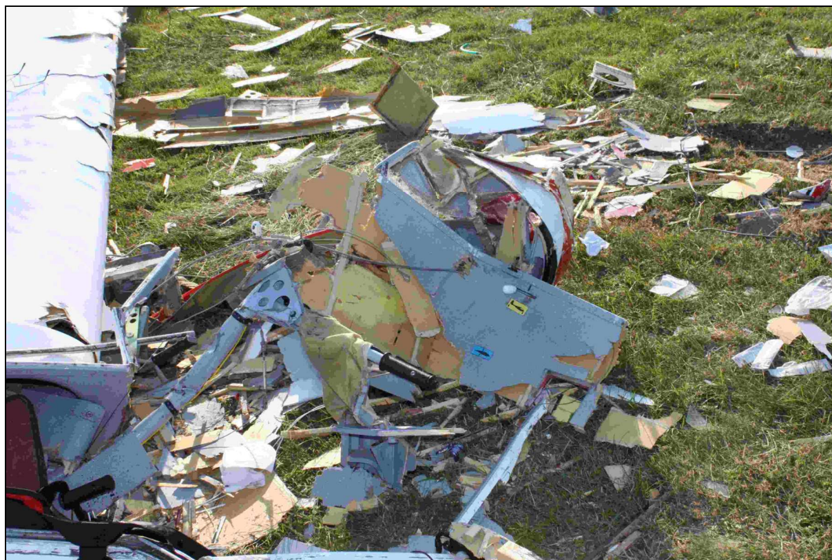
11 – Zniszczona przednia część kadłuba, widok z prawej strony.
