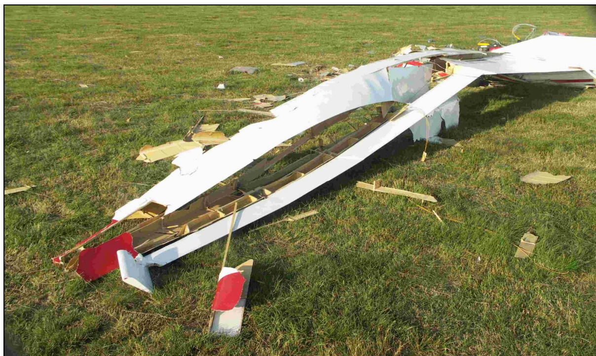
7 – Zniszczone lewe skrzydło od strony spływu i końcówki – zbliżenie. Widoczna zniszczona końcówka i lotka.
