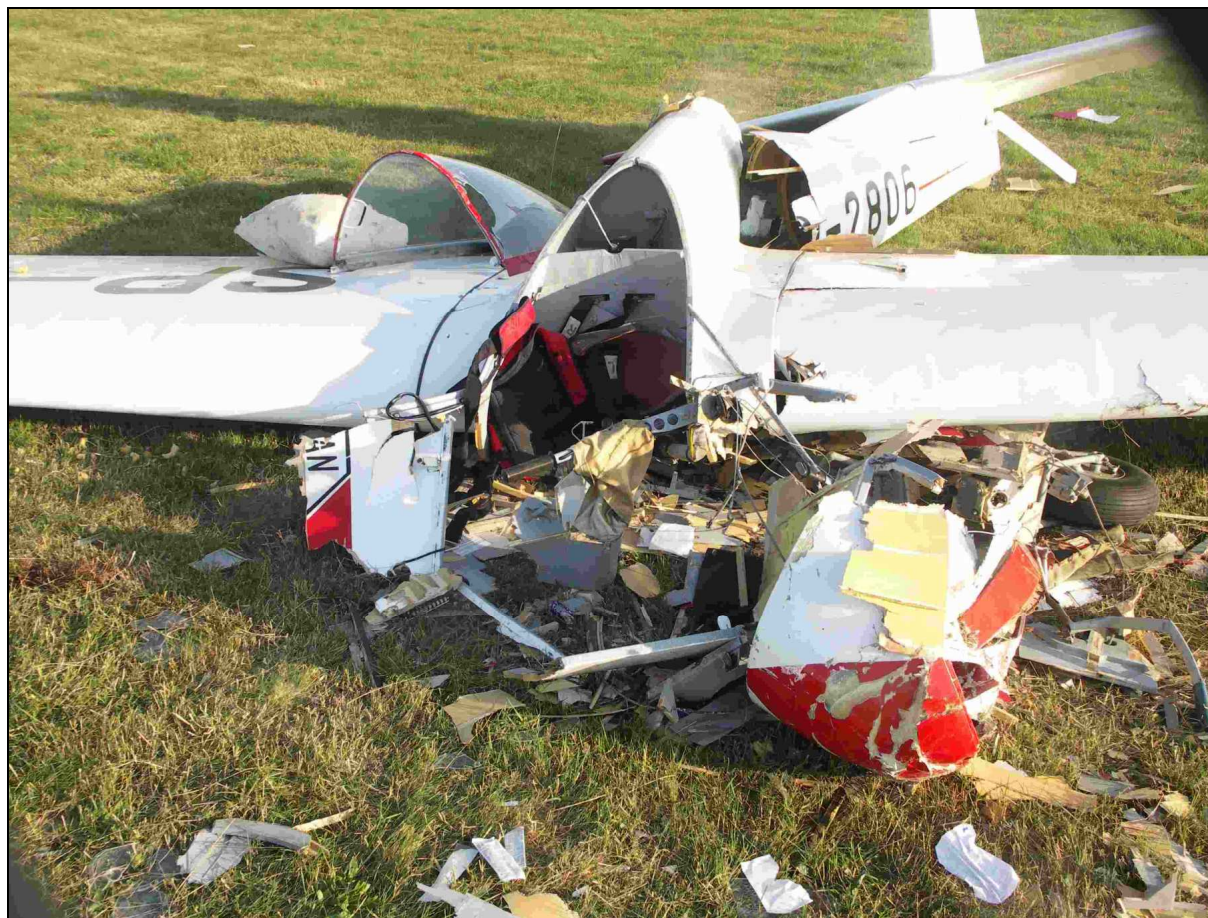
10 – Zniszczona przednia część kadłuba, widok od przodu.
