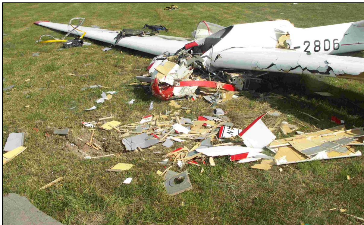
12 – Zniszczona przednia część kadłuba, widok z lewej strony.
