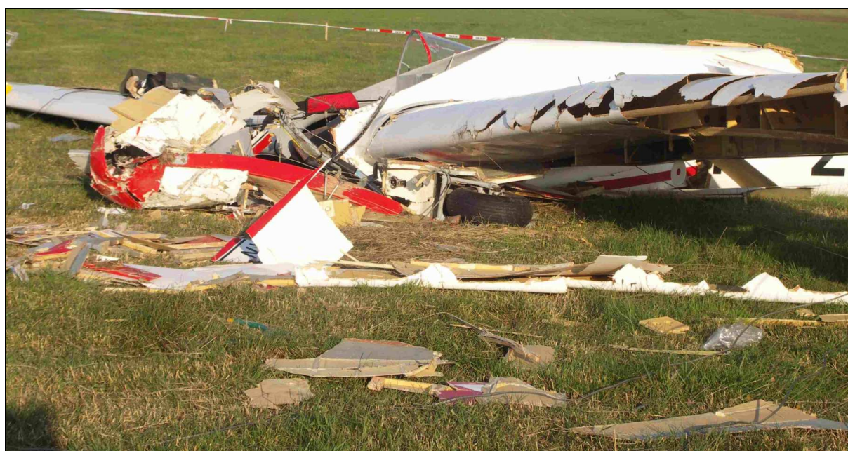
13 – Zniszczona przednia część kadłuba, widok z lewej strony.
