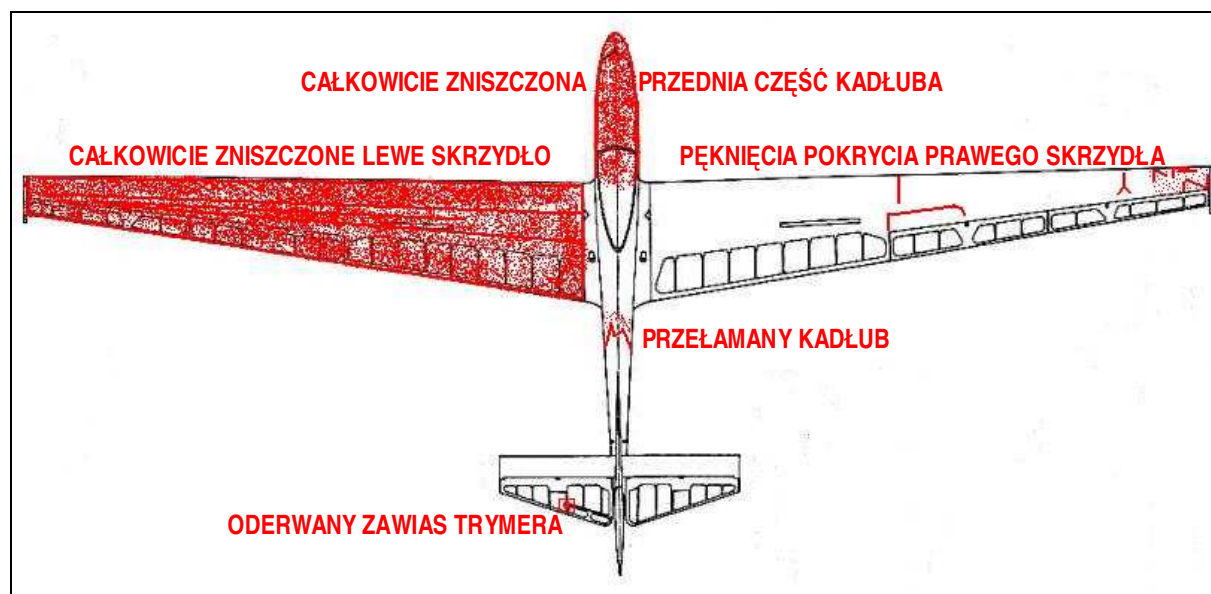
32 – Schematycznie zaznaczone zniszczenia struktury szybowca w wyniku wypadku.
