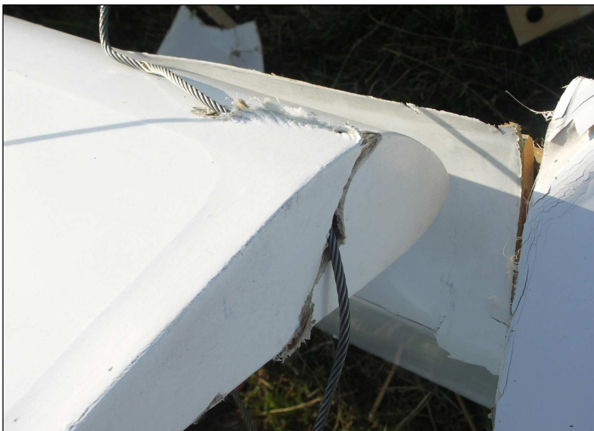
22 – Lewa lotka przy żeberku nasadowym. Widoczna lina holownicza wcięta w żeberko. Widoczna na zdjęciu „dolna” część liny prowadzi do spadochronika liny, część „górną” – w stronę wyciągarki.
