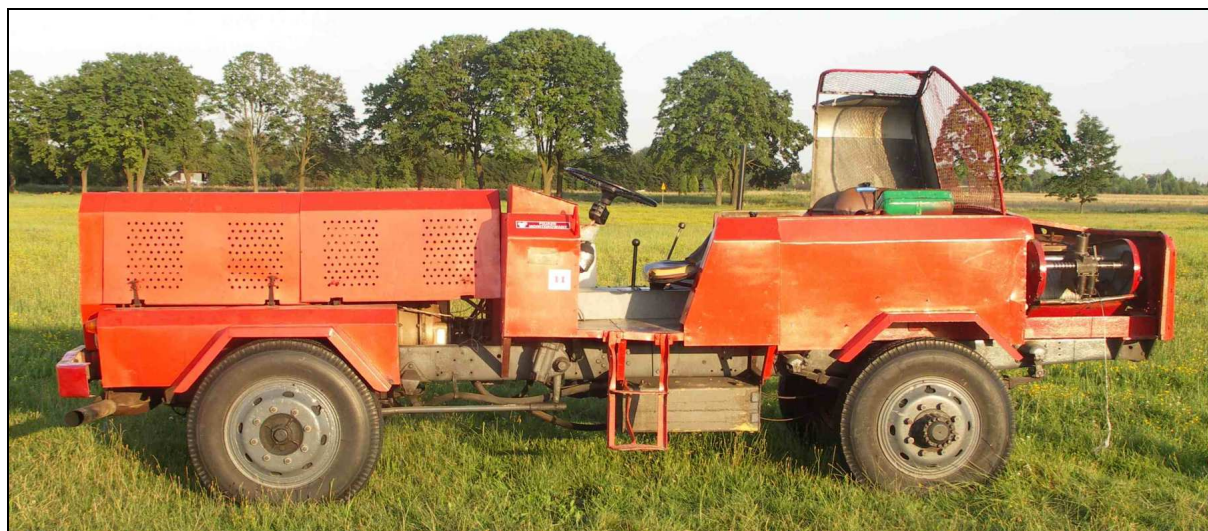
29 – Wyciągarka Tur użyta do wyholowania szybowca – widok ogólny.
