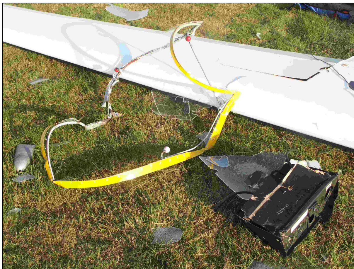
17 – Prawe skrzydło w rejonie nasady lotki – widoczne uszkodzenia pokrycia. Na pierwszym planie wyrwana tablica przyrządów, szczątki oszklenia i zniszczona rama przedniej części osłony kabiny.
