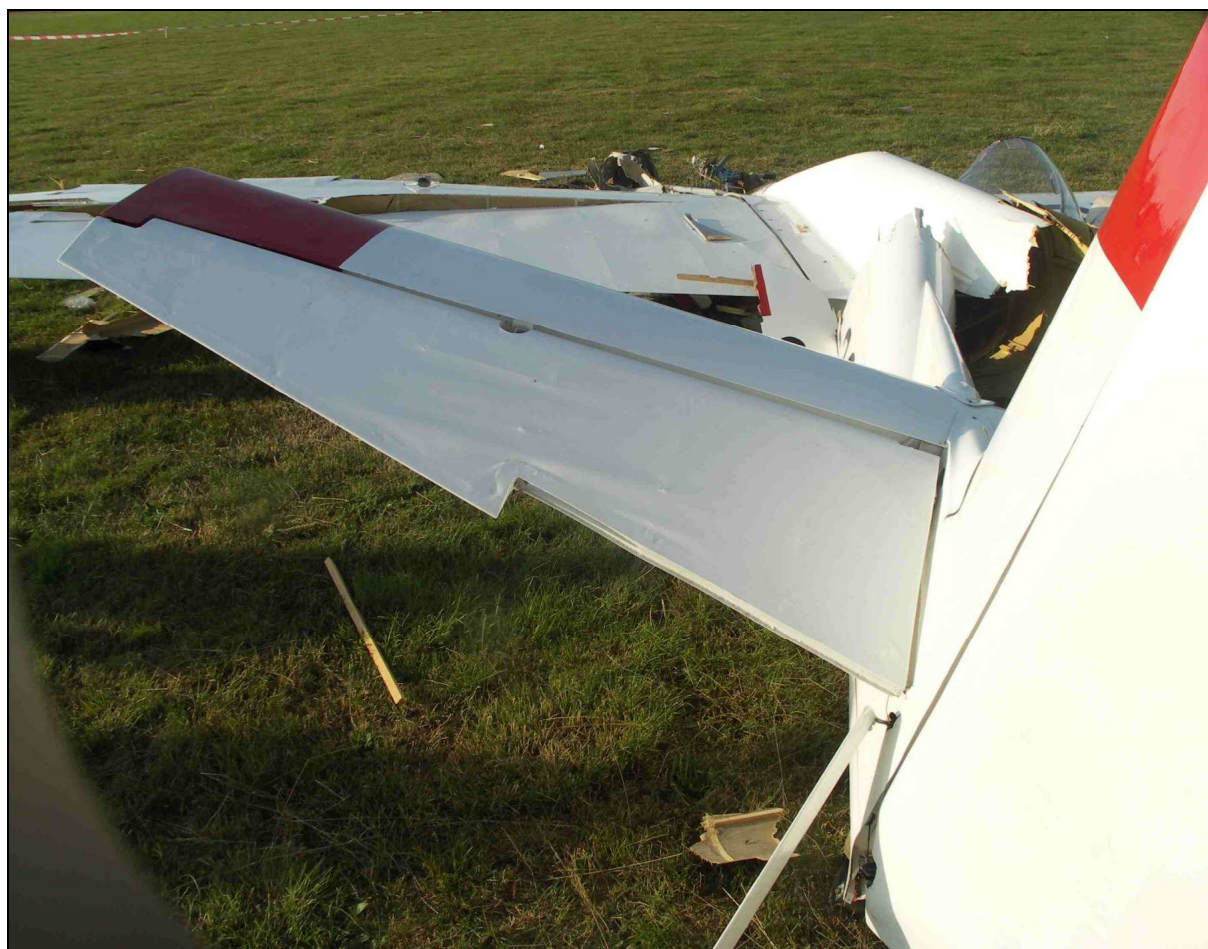
15 – Odłamana za skrzydłami tylna część kadłuba z usterzeniem, widok z tyłu.
