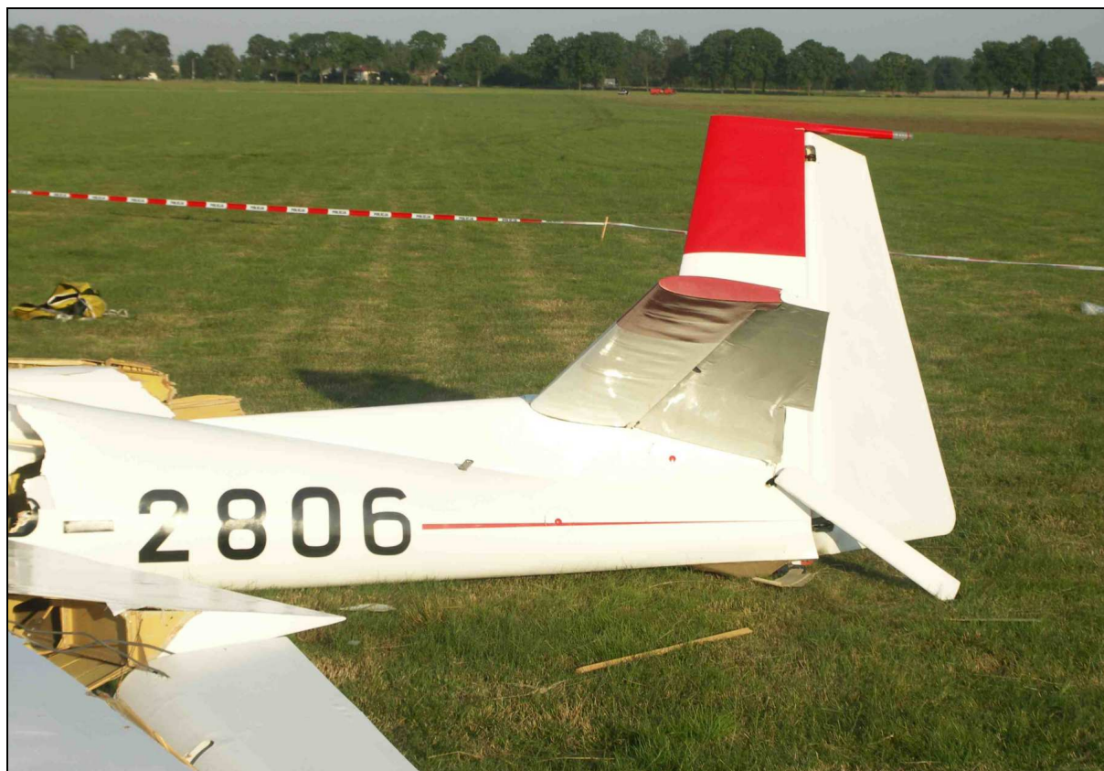
14 – Odłamana za skrzydłami tylna część kadłuba z usterzeniem, widok z lewej strony.
