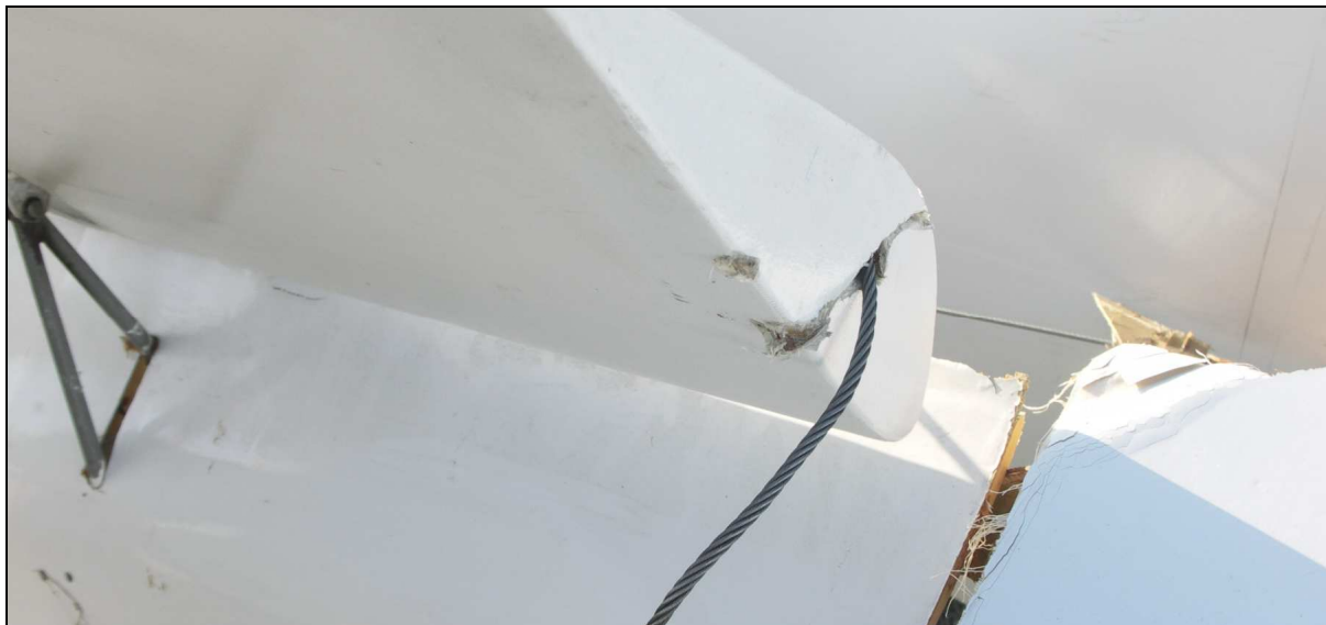
23 – Lewa lotka przy żeberku nasadowym. Widoczna lina holownicza wcięta w żeberko.
