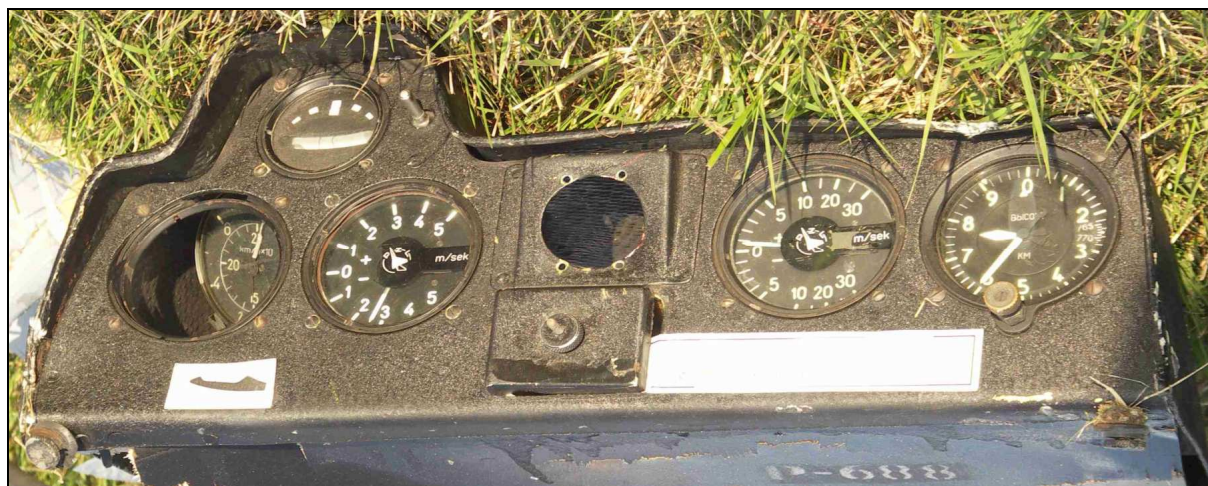
18 – Wyrwana tablica przyrządów – zbliżenie. Widoczne zachowane wskazania przyrządów.
