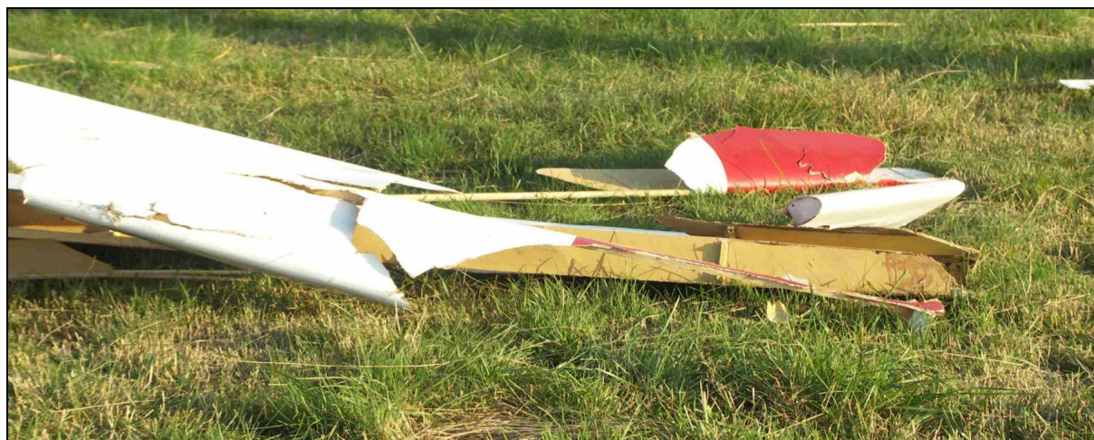
20 – Zniszczona końcówka lewego skrzydła – zbliżenie od przodu.
