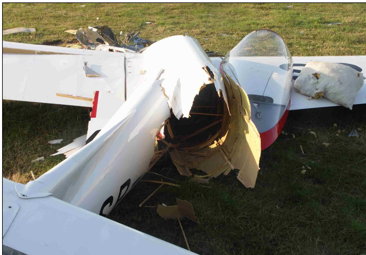
16 – Widok od tyłu na przełom kadłuba.
