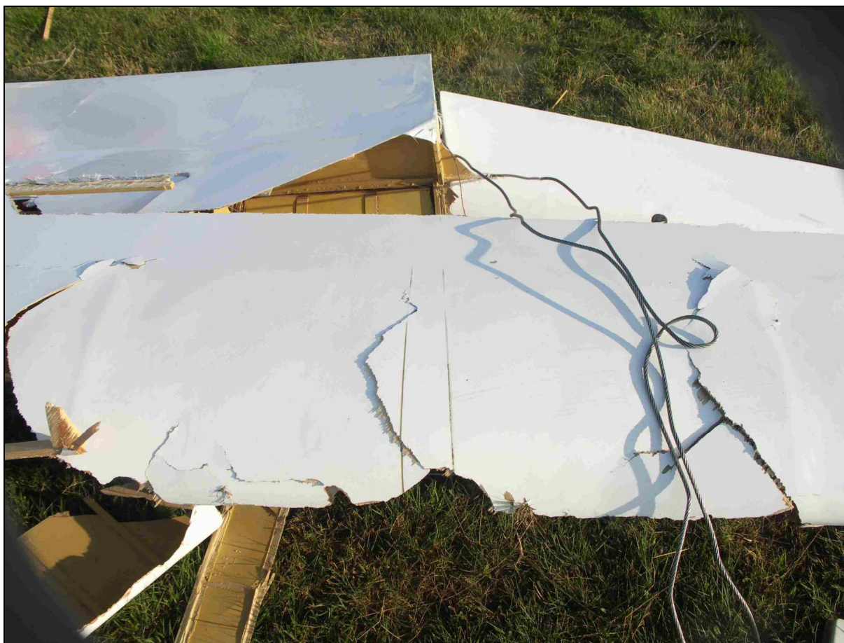
24 – Ślad szarpnięcia liną holowniczą zaczepioną o lotkę na zniszczonym pokryciu kesonu lewego skrzydła.
