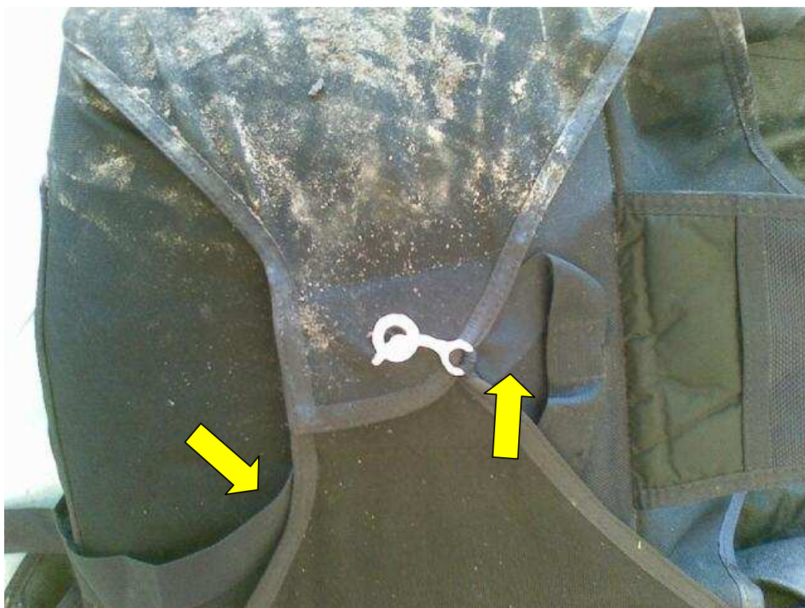
Widok pokrowca w położeniu na boku. Żółtymi strzałkami zaznaczono nieprawidłowy przebieg taśmy łączącej pilocik z czaszą pod bocznymi wyłogami pokrowca.
