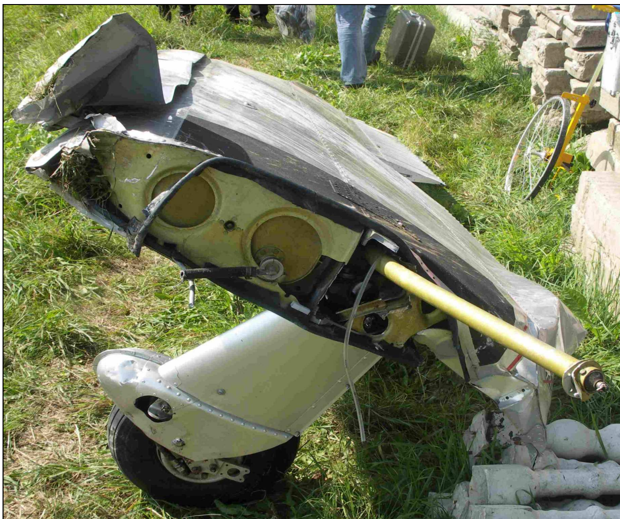
64 – Prawe skrzydło od strony żebra nasadowego.
