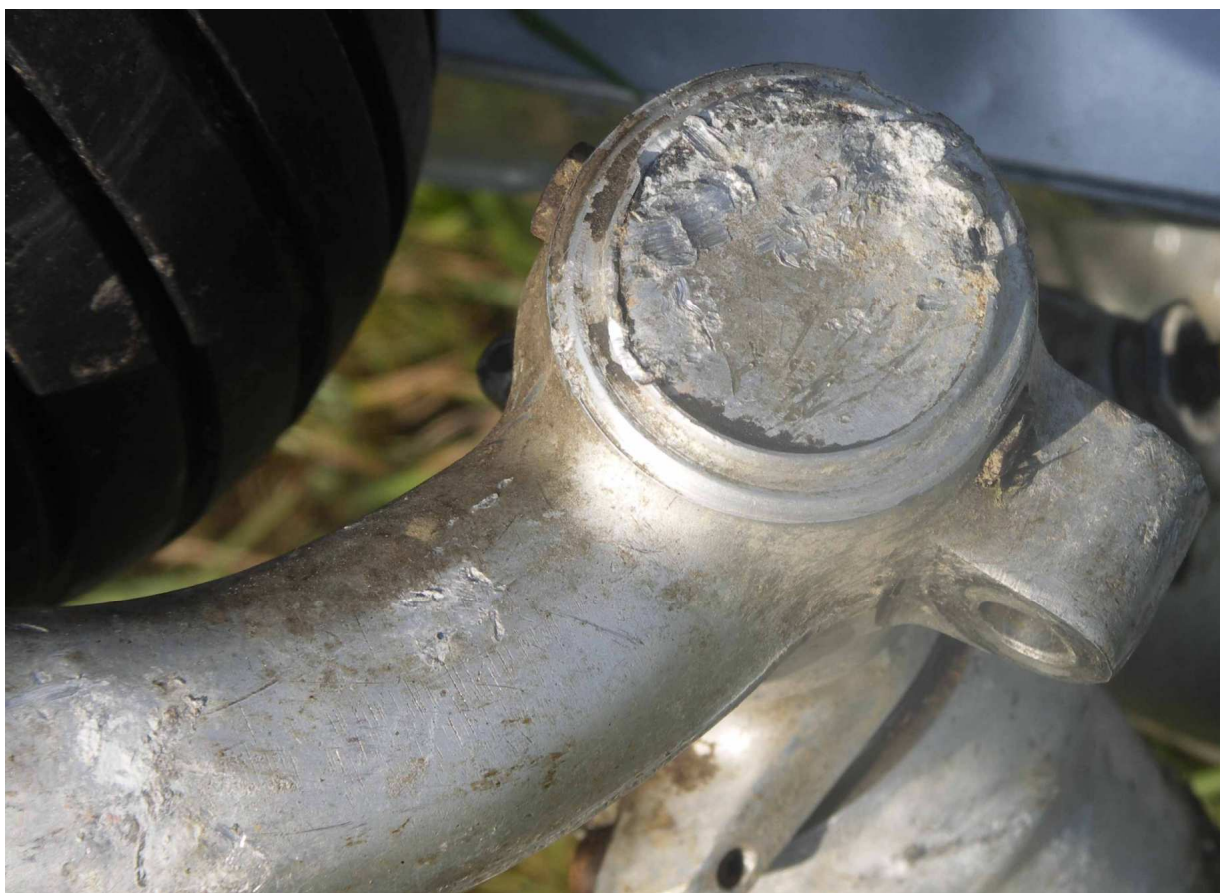
46 – Zbliżenie na fragment półwidelca koła przedniego – widoczne uszkodzenia spowodowane kontaktem z nawierzchnią gruntu (zarzyciem w żwirowo-kamienną podsypkę budowanej drogi dojazdowej).
