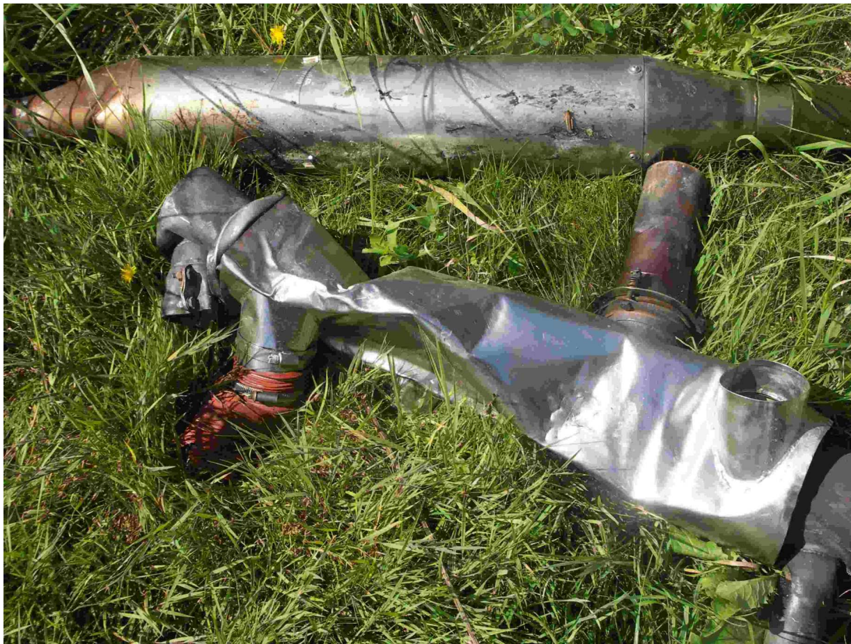
67 – Tłumik układu wydechowego silnika (u góry) i zniszczony kolektor spalin z nagrzewnicą powietrza.
