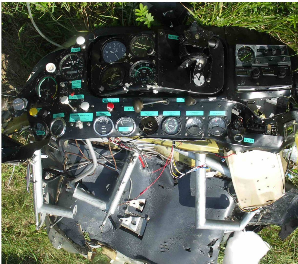
36 – Sciana ogniowa ze sterownicami nożnymi, płyta pozioma i tablica przyrządów wycięte z wraku kadłuba.
