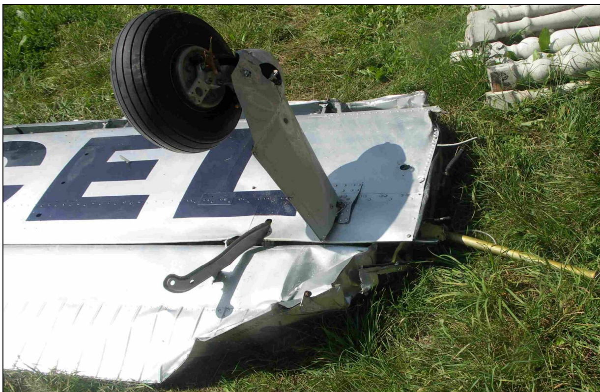
63 - Prawe skrzydło od spodu – część nasadowa z podwoziem głównym.
