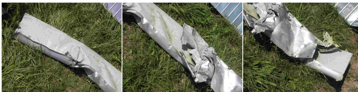
51, 52, 53 – Zniszczony segment slotu lewego skrzydła.
