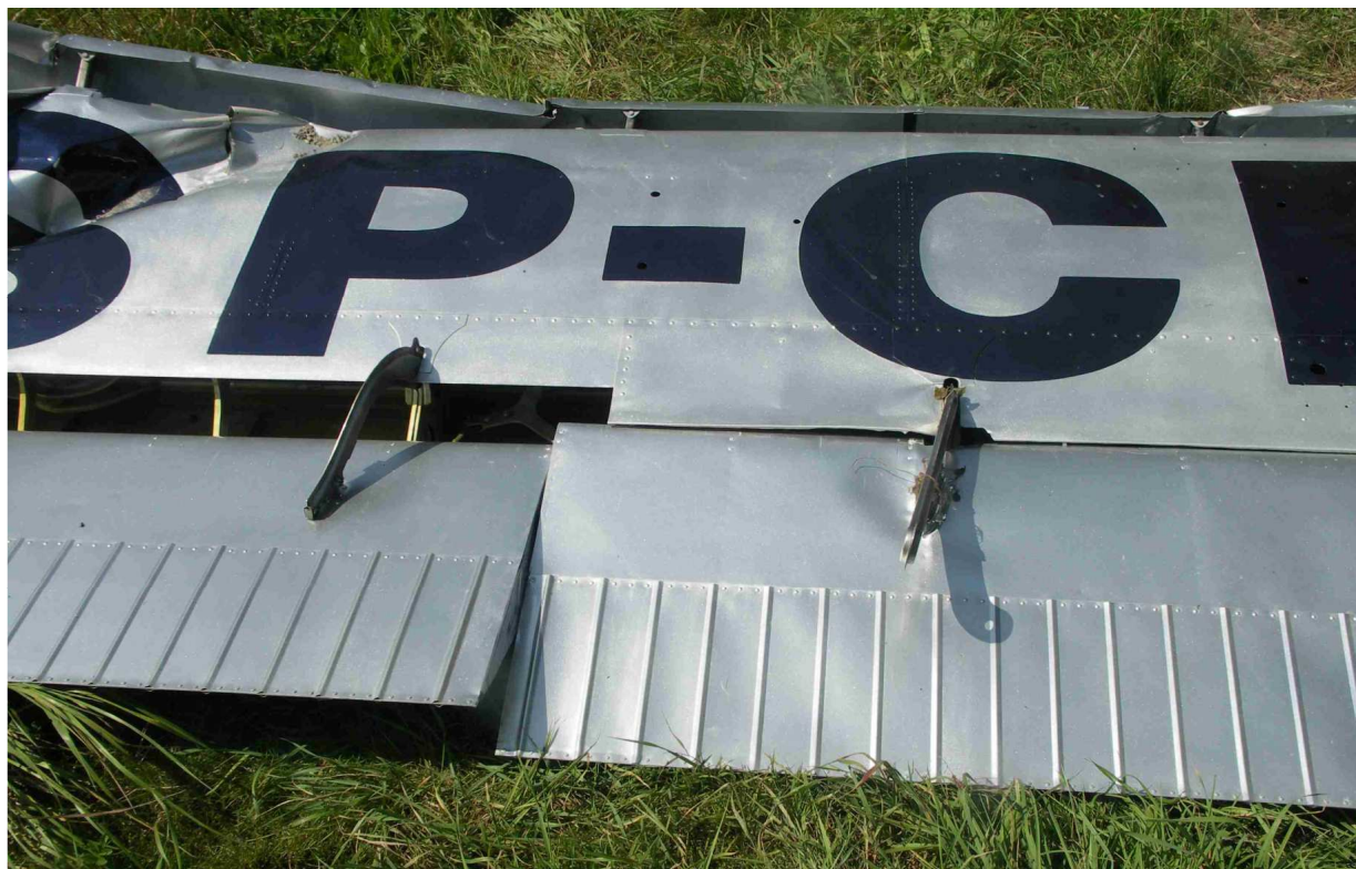
62 – Prawe skrzydło od spodu – część środkowa (widoczny podział lotka-klapa).
