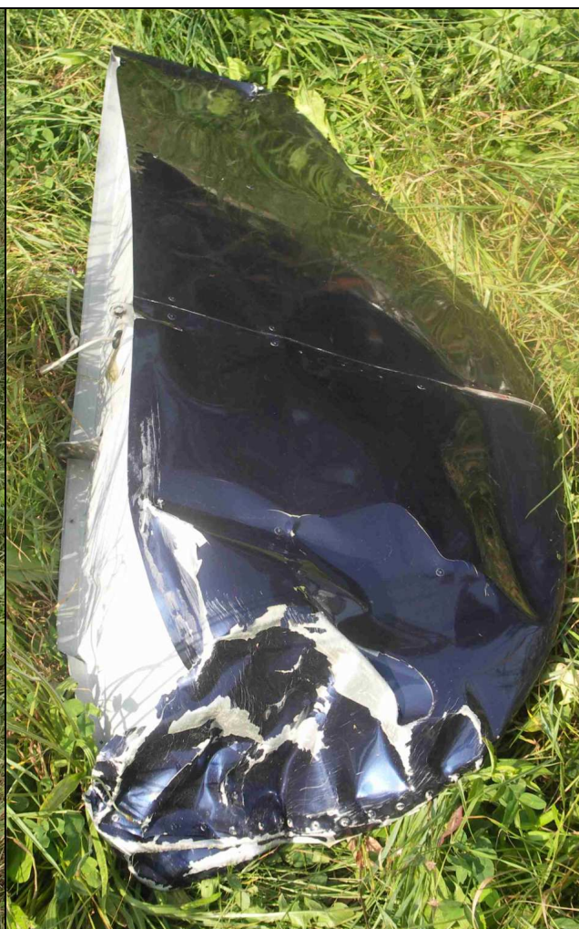
48 – Końcówka lewego skrzydła. Widoczne wgniecenie od uderzenia o komin na dachu budynku.
