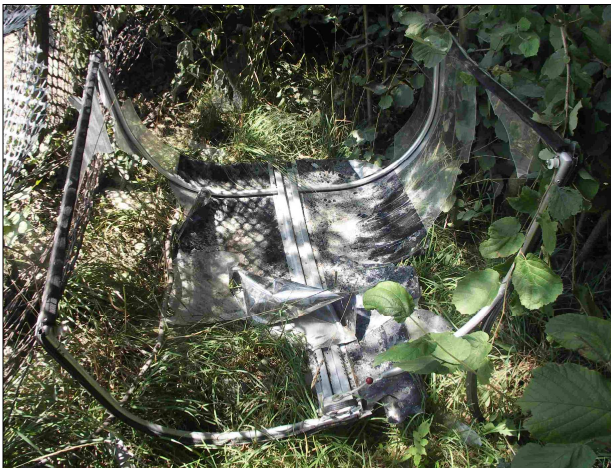
34 – Zniszczona osłona kabiny. ALBUM ILUSTRACJI
