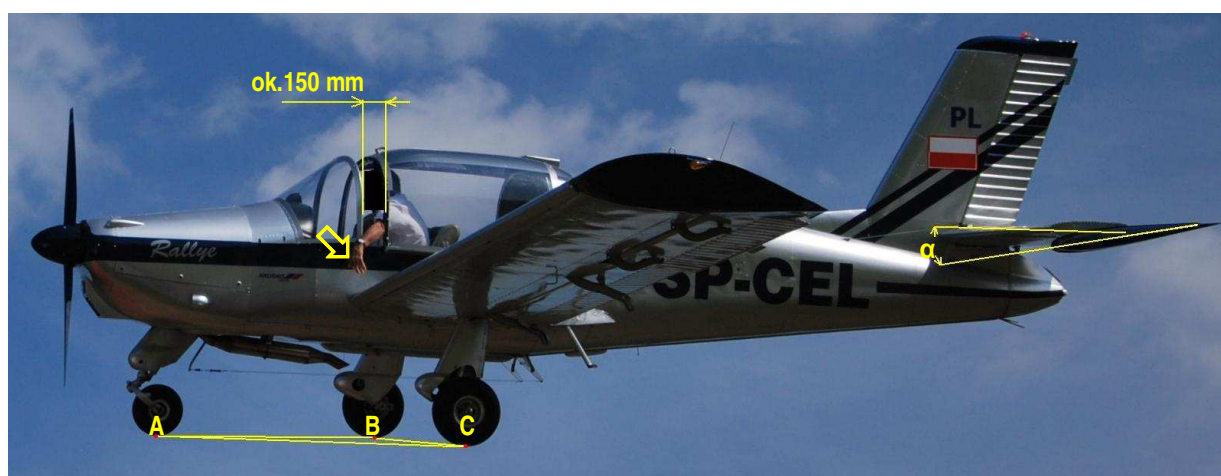
10 – Samolot tuż po zrzuceniu wiązanki kwiatów, podczas zbliżania się do miejsca wypadku (ok. 33 m do zderzenia z kominem) – powiększony fragment zdjęcia „3”. Widoczna osłona kabiny odsunięta o ok. 150 mm, lewa ręka pilota wysunięta z kabiny [wskazana strzałką], wychylenie steru wysokości do góry o kąt \alpha ok. 11-12°. Trójkąt utworzony przez dolne punkty kół podwozia [A, B, C] skrajnie bliski linii prostej, co oznacza, że oś obiektywu aparatu fotograficznego leży niemal w płaszczyźnie wyznaczonej przez ten trójkąt. Pozwala to określić kąt przechylenia samolotu w chwili wykonania zdjęcia, wobec znanego umiejscowienia osoby fotografującej względem trajektorii lotu samolotu.
