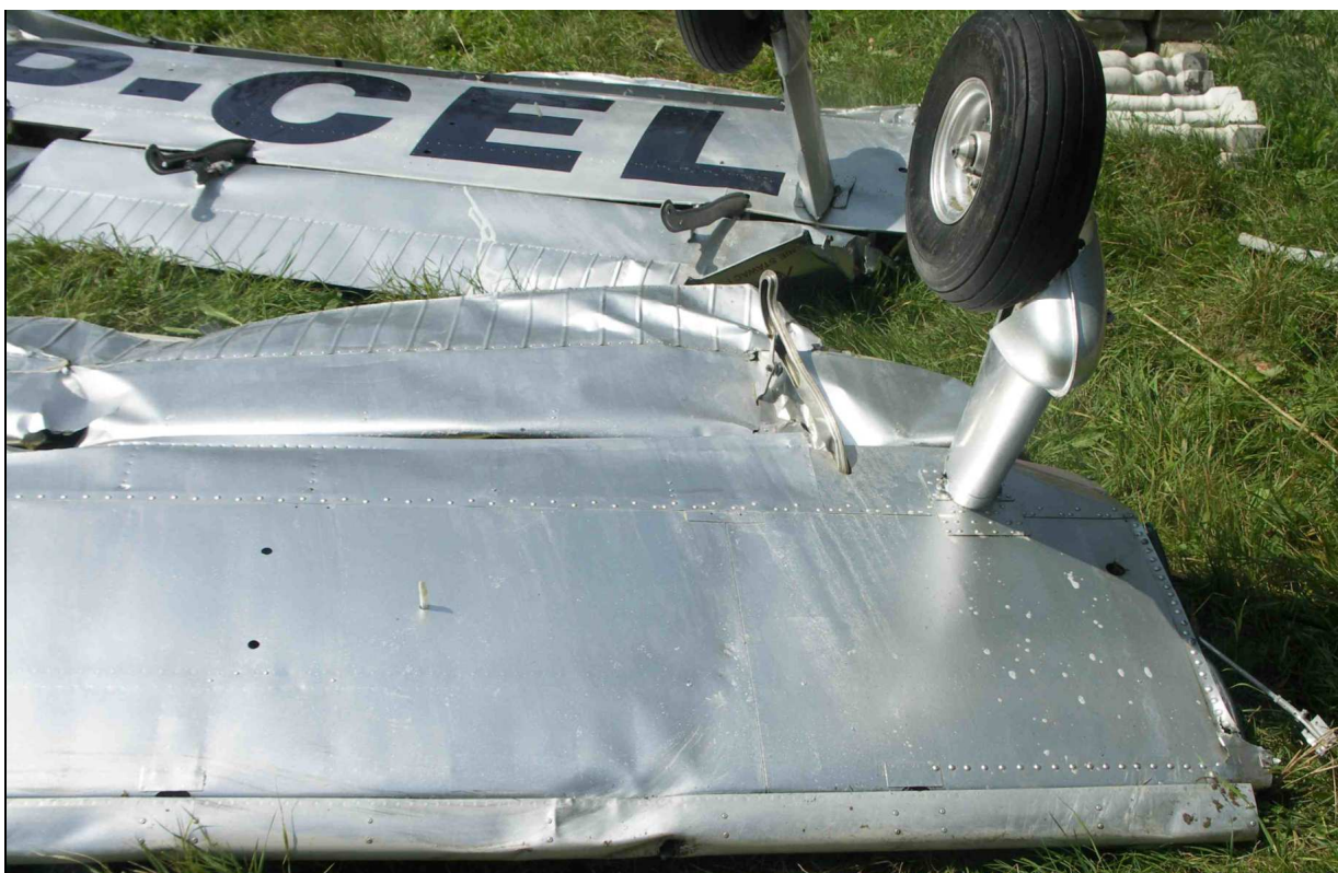
54 – Lewe skrzydło od spodu – część nasadowa z podwoziem głównym.
