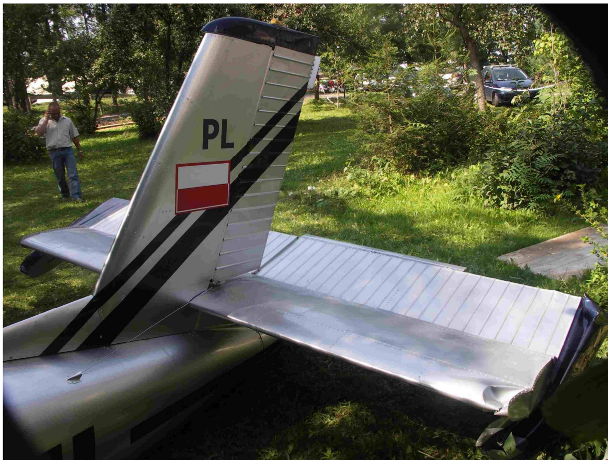
65 – Usterzenie – widoczne uszkodzenie lewej końcówki usterzenia poziomego.
