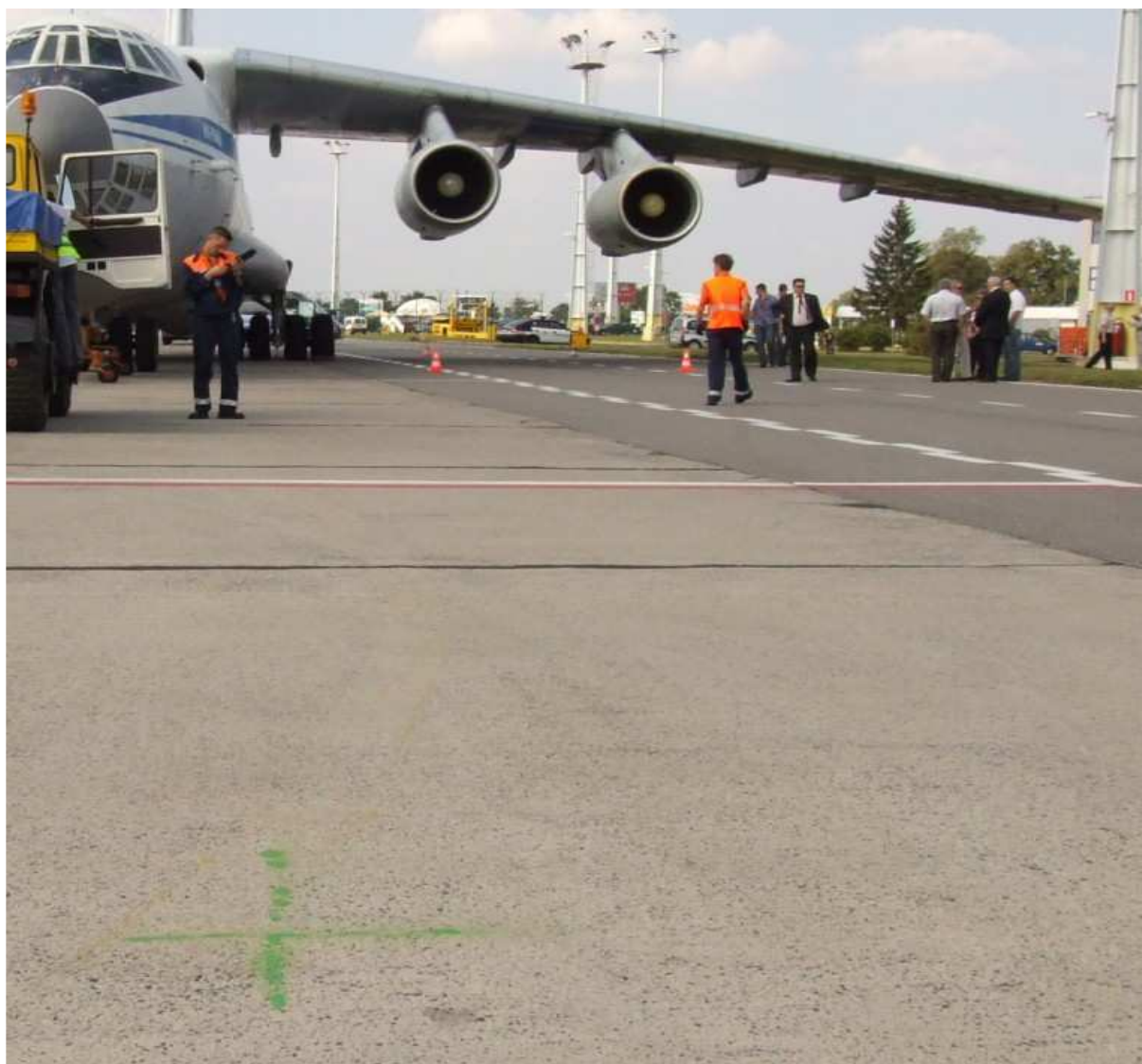
5 - Położenie punktu odniesienia nr 1 „trasy kołowania”, wg którego realizowano wprowadzanie samolotu na miejsce postojowe (punkt ten wyznacza zieloną linię pokazaną na ilustracjach 2 i 3).
