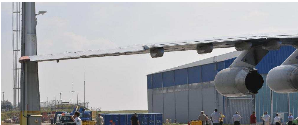
9 - Zderzenie skrzydła z masztem oświetleniowym - widok od tyłu.
