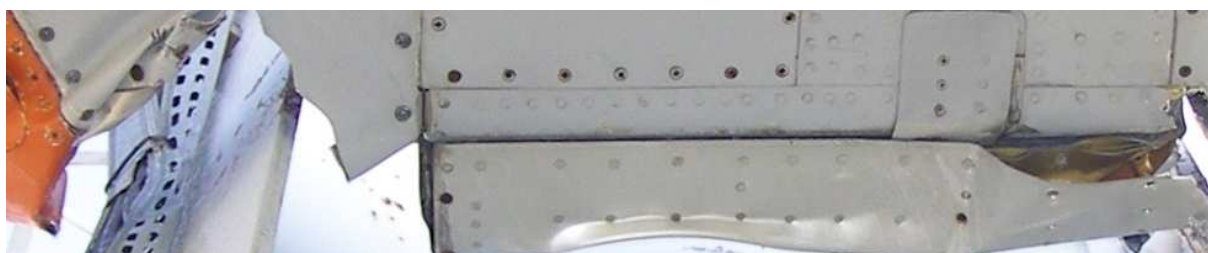
15 - Uszkodzenie końcówki lewego skrzydła po zderzeniu z masztem oświetleniowym-widok z dołu.
