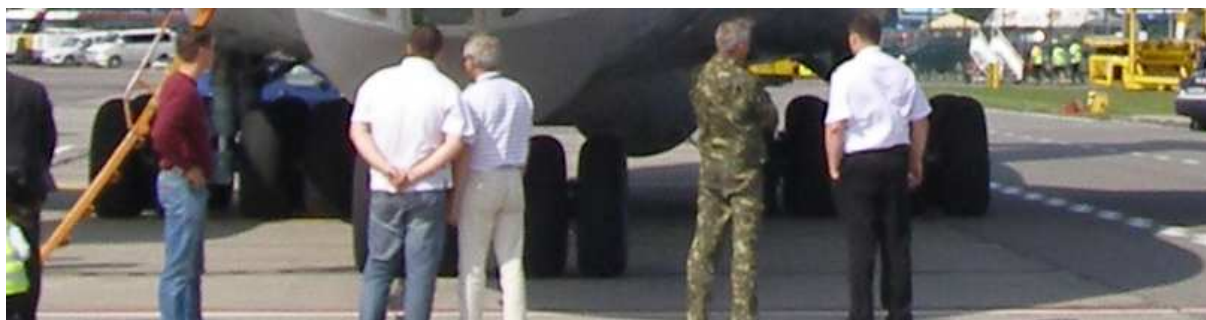
8 – Zbliżenie na podwozie samolotu. Widać, że zewnętrzne koła lewego podwozia głównego znajdują się na drodze serwisowej. Aneks 14 zaleca, aby dla statków powietrznych kategorii D minimalna odległość zewnętrznych kół podwozia od krawędzi drogi kołowania wносиła 4,5 m.
