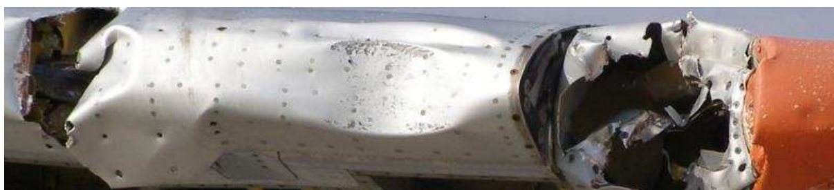
11 - Widok uszkodzeń krawędzi natarcia skrzydła.
