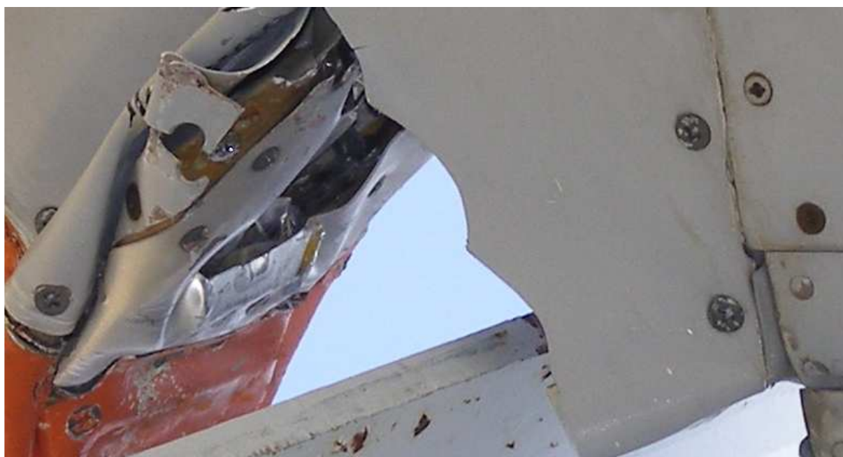
13 - Uszkodzenie krawędzi natarcia lewego skrzydła-widok z dołu.
