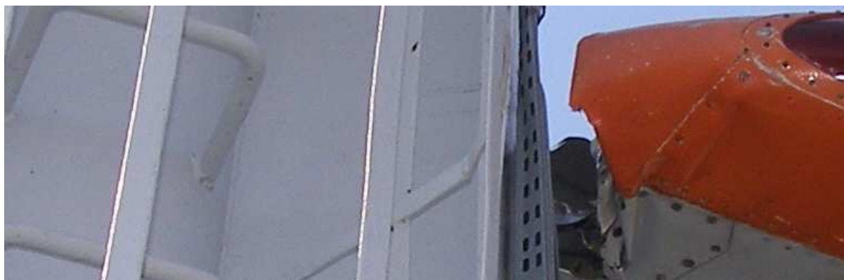
14 - Uszkodzenie końcówki lewego skrzydła po zderzeniu z masztem oświetleniowym.
