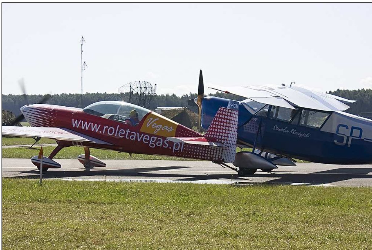
7 – Chwila tuż po zderzeniu – śmigło samolotu RWD 5R już się zatrzymało po uderzeniu w usterzenie samolotu Extra 300L; pilot samolotu Extra 300L usiłuje „uciec” spod najeżdżającego na jego samolot samolotu RWD 5R, który toczy się pod działaniem siły bezwładności.
