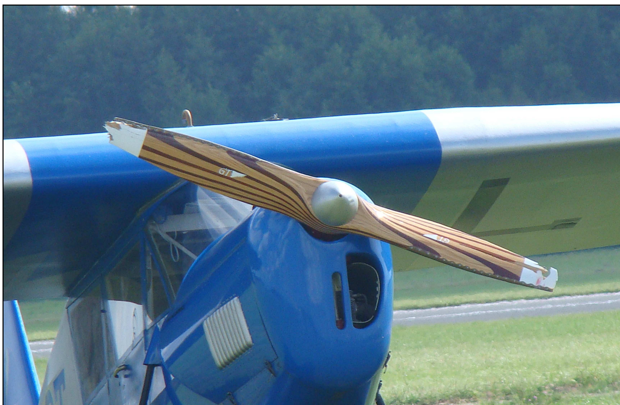
11 – Uszkodzone śmigło samolotu RWD 5R.
