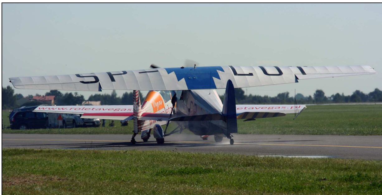
8 – Dalszy ciąg zderzenia – potracony niesymetrycznie samolot Extra 300L zmienia kierunek kołowania w prawo; samolot RWD 5R wpadając spodem kadłuba na końcówkę jego prawego usterzenia poziomego uszkadza dolne pokrycia i rozrywa przewód paliwowy. Widoczne wylewające się z RWD 5R paliwo, rozpylone strumieniem zaśmigłowym samolotu Extra 300L.
