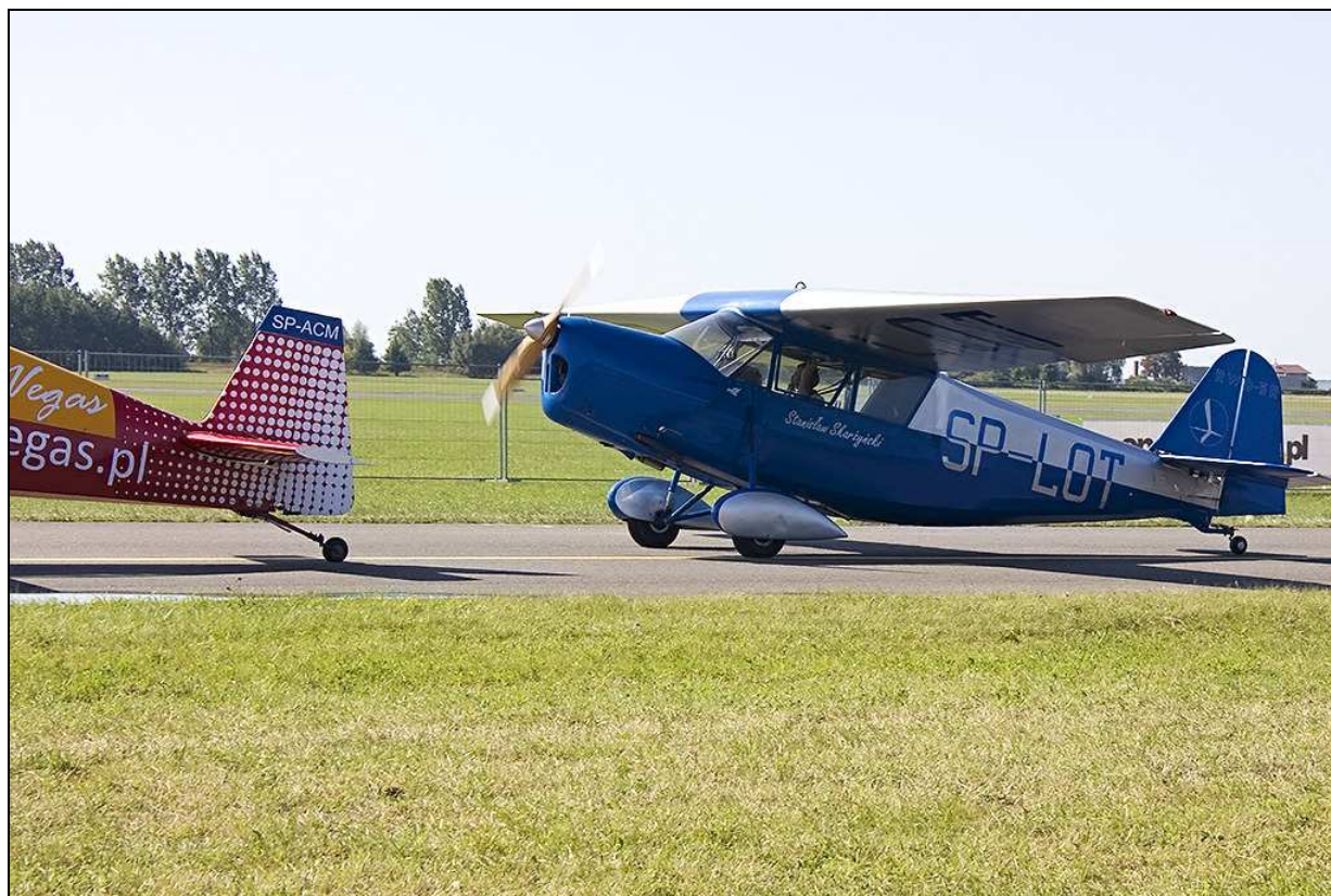
5 - Chwila tuż przed zderzeniem - samolot RWD 5R dogania samolot Extra 300L w trakcie kołowania. Samolot Extra 300L kołuje praktycznie w osi drogi kołowania, samolot RWD 5R nieco w prawo od niej (około 1/2 rozstawu kół podwozia). Zwraca uwagę konstrukcyjne ograniczenie widoczności do przodu dla pilota samolotu RWD 5R.
