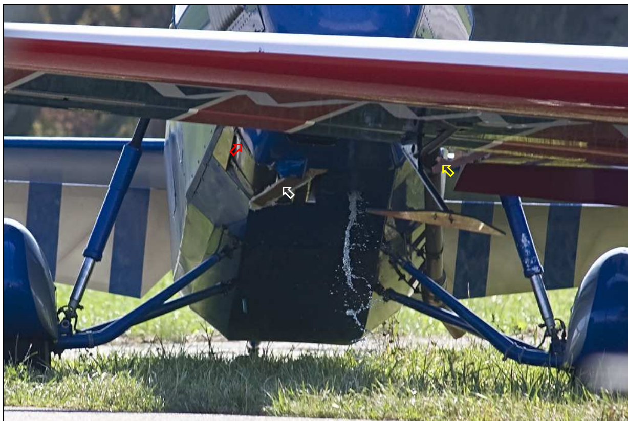
10 – Oba samoloty po zjechaniu z drogi kołowania i zatrzymaniu - zbliżenie. Widoczne uszkodzenia końcówki prawego segmentu steru wysokości samolotu Extra 300L [żółta strzałka], uszkodzenia dolnej osłony silnika RWD 5R [czerwona strzałka] z wbitym w nią fragmentem żeberka steru wysokości samolotu Extra 300L [biała strzałka] i strumień paliwa, wylewający się spod osłon silnika RWD 5R.
