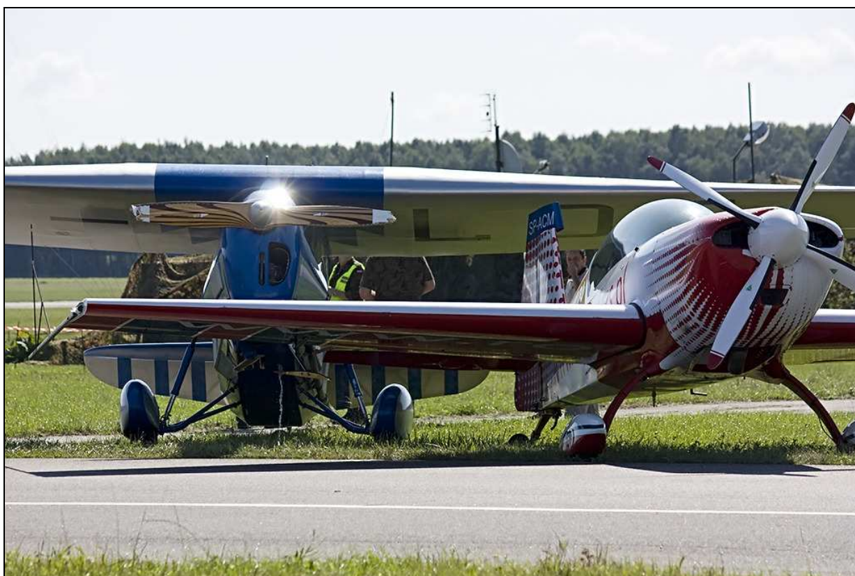
9 – Oba samoloty po zjechaniu z drogi kołowania i zatrzymaniu. Widoczne uszkodzenia końcówek łopatek śmigła RWD 5R i strumień paliwa, wylewający się spod osłon jego silnika.
