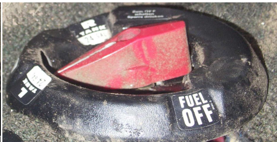
29 – Pokrętko głównego zaworu paliwowego, przestawione na pobór paliwa z lewego zbiornika.
