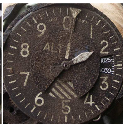
26 i 27 – Skala zniszczonego wysokościomierza z widoczną nastawą ciśnienia regionalnego QNH=1027 [hPa]; z prawej uszkodzona puszka przyrządu (zdjęcie z dnia następnego po wypadku).
