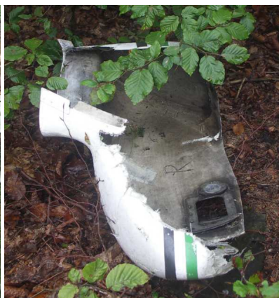
50 – Zniszczona owiewka prawego koła podwozia.
