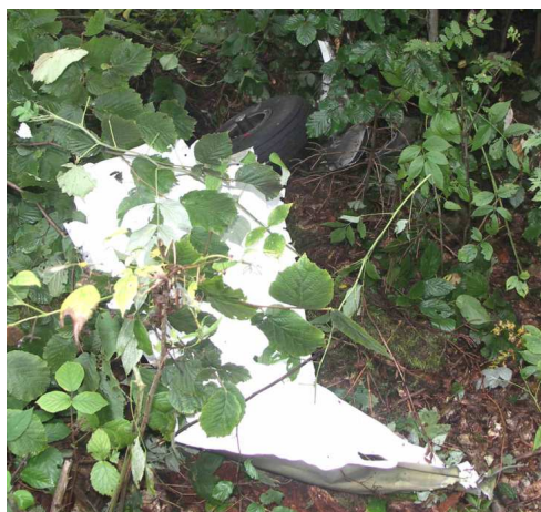
44 i 45 – Fragment lewego skrzydła z połamanym podwoziem.
