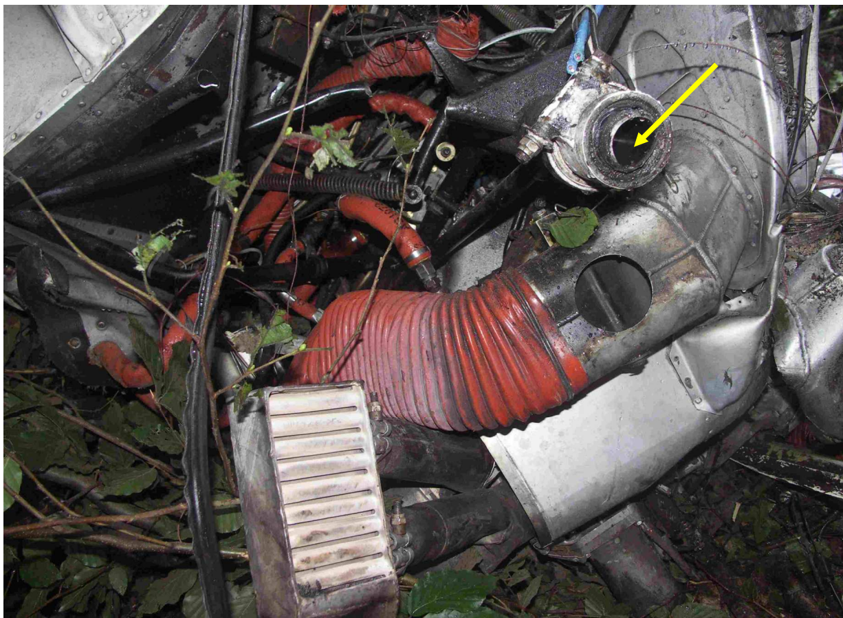
18 – Zbliżenie na elementy zespołu napędowego. Widoczny fragment łoża podwozia przedniego z resztką wytłumianej goleni (👉).
