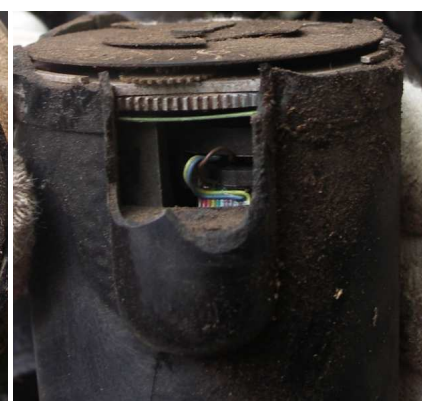
26 i 27 – Skala zniszczonego wysokościomierza z widoczną nastawą ciśnienia regionalnego QNH=1027 [hPa]; z prawej uszkodzona puszka przyrządu (zdjęcie z dnia następnego po wypadku).
