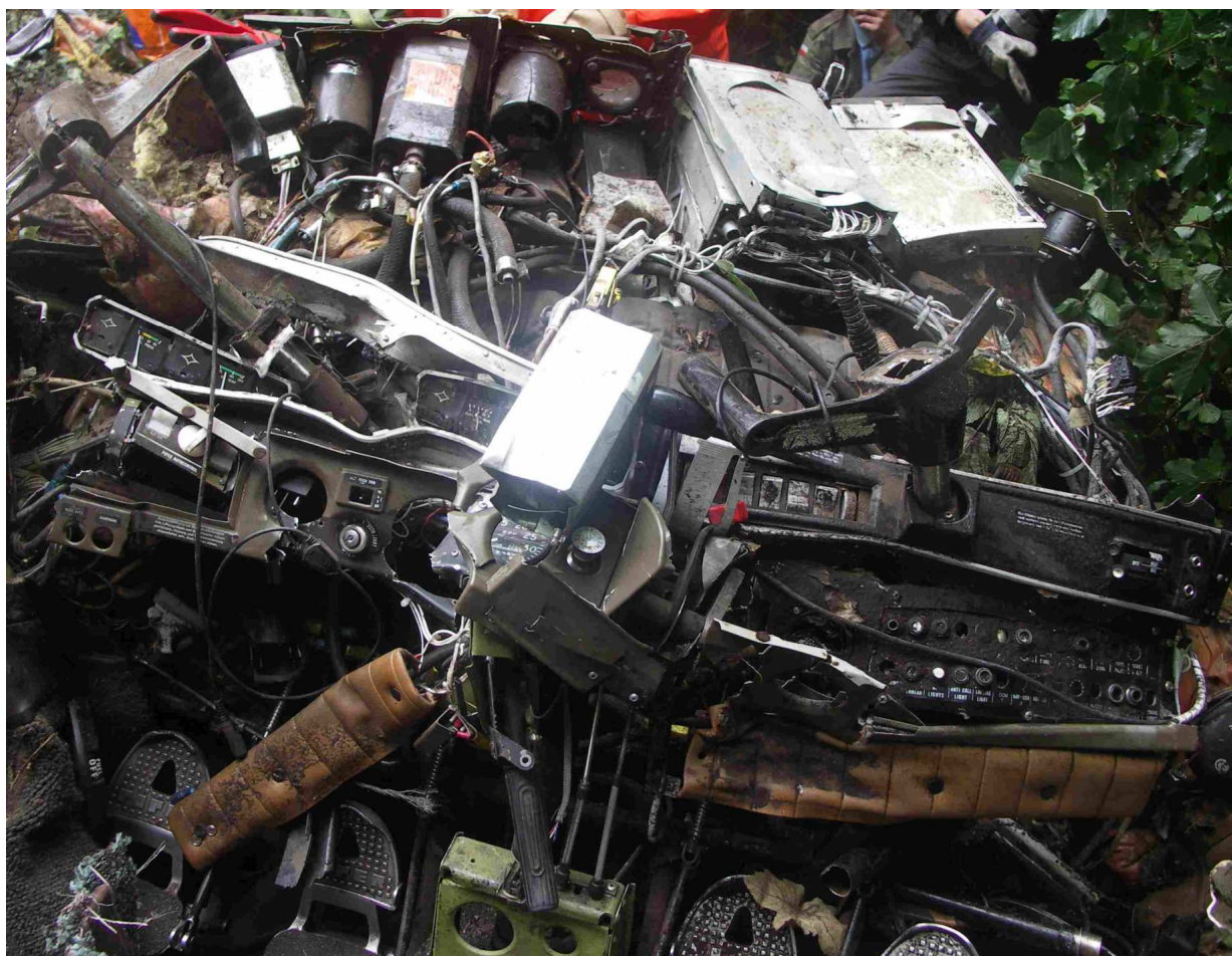
20 – Szczątki tablicy przyrządów i pulpitu poziomego; widoczne sterownice nożne i wyłamane wolanty.
