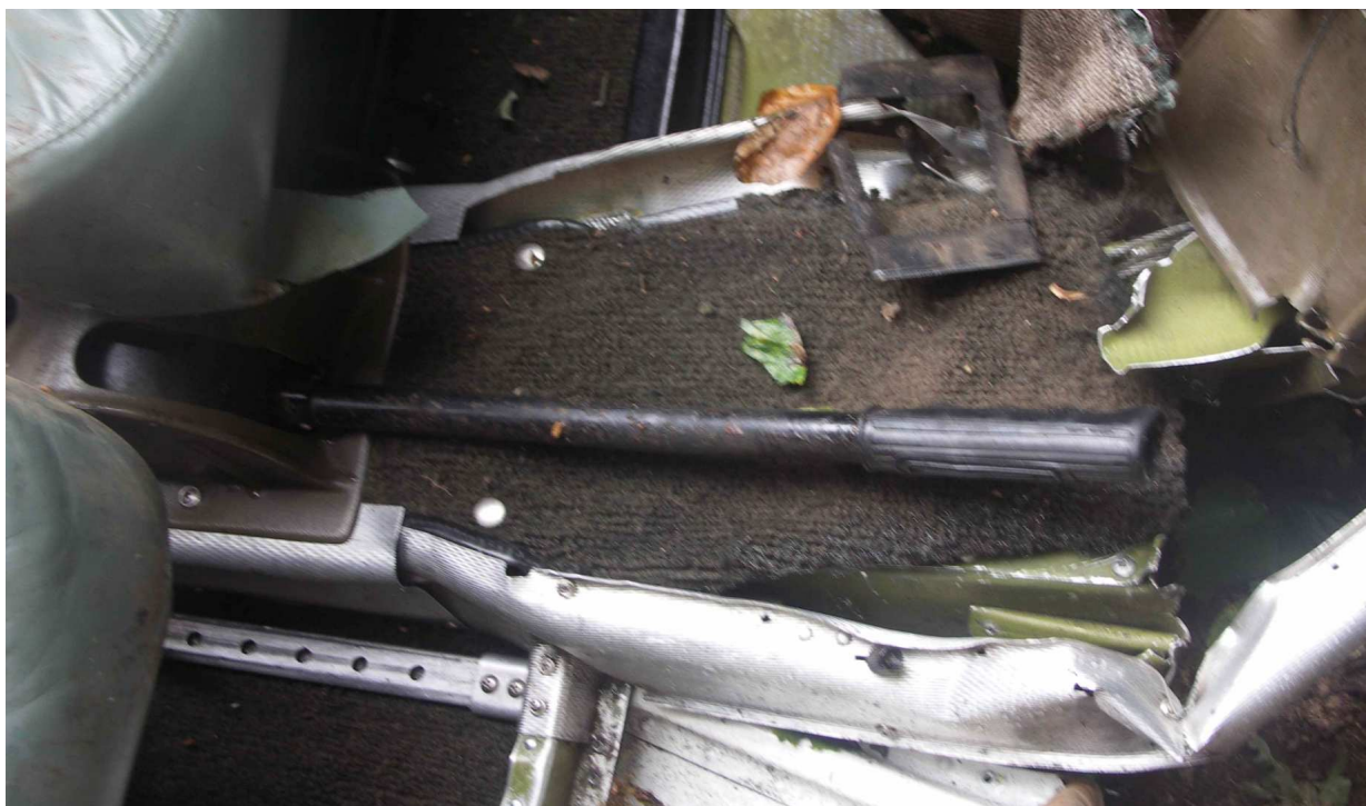
30 – Dźwignia sterowania klapami w położeniu SCHOWANE.
