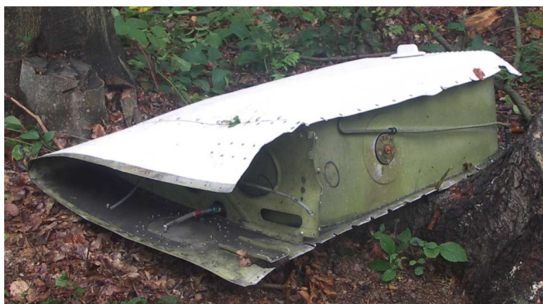
57 i 58 – Segment kesonu noskowego lewego skrzydła ze zbiornikiem paliwa.
