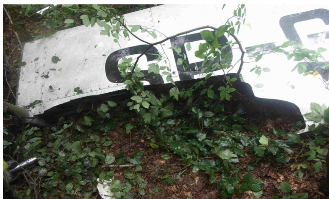
46 i 47 – Fragmenty lewego skrzydła – zwraca uwagę brak lotki.
