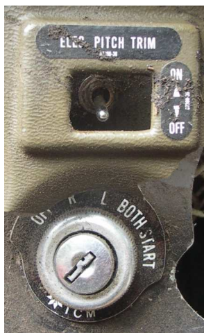
28 – Przelicznik trymera i stacyjka rozrusznika ze złamanym kluczykiem.
