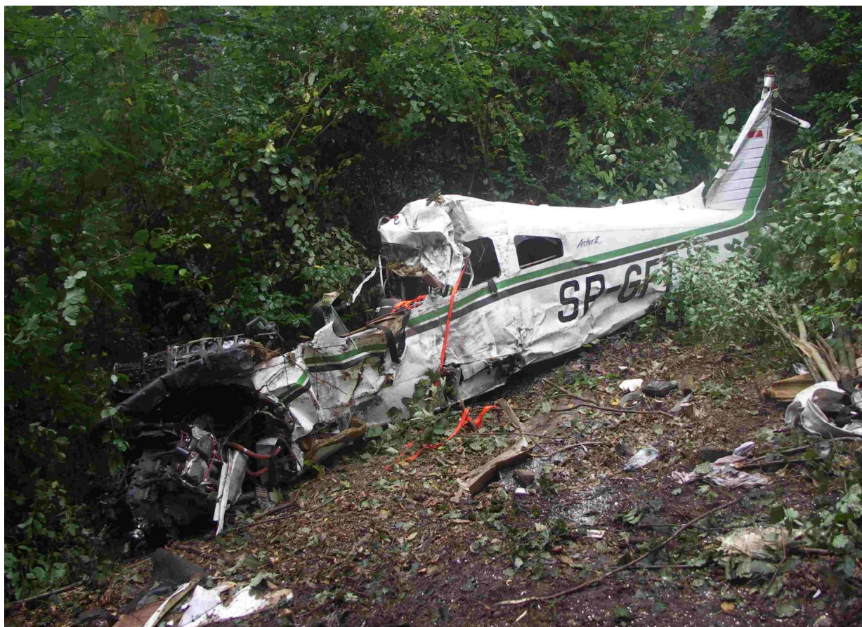
15 – Kadłub samolotu na miejscu wypadku – widok ogólny po podniesieniu do oględzin.
