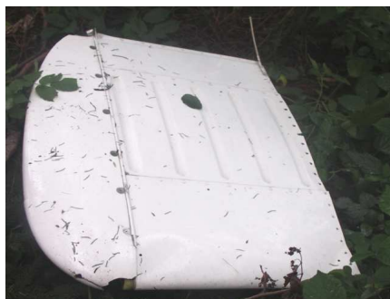
55 – Końcówka płyty statecznika poziomego.
