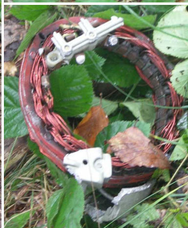
33, 32, 33 i 34 – Miejsce uderzenia kołpakiem śmigła (wskazane strzałką), fragment zniszczonego wieńca koła zębatego rozrusznika na wale śmigła i szczątki zniszczonej prądnicy .
