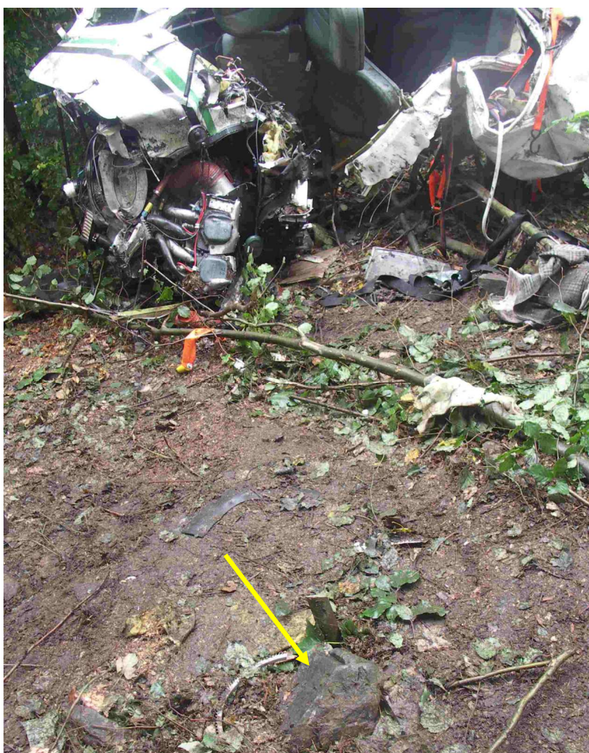
33, 32, 33 i 34 – Miejsce uderzenia kołpakiem śmigła (wskazane strzałką), fragment zniszczonego wieńca koła zębatego rozrusznika na wale śmigła i szczątki zniszczonej prądnicy .
