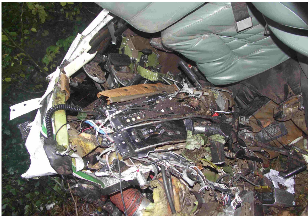
19 – Kabina po wypadku – widoczne fotele, szczątki tablicy przyrządów i sterownice.
