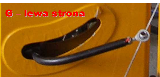
40, 41 – Zakończenie popychacza tylnego wyprowadzone z kadłuba, z końcówkami wyposażonymi w przeguby kuliste do połączenia z dźwigniami na półkach steru wysokości [szczegóły G na fot.33]. Końcówki odłączono od dźwigni na półkach steru wysokości podczas demontażu samolotu po jego wydobyciu z jeziora.
