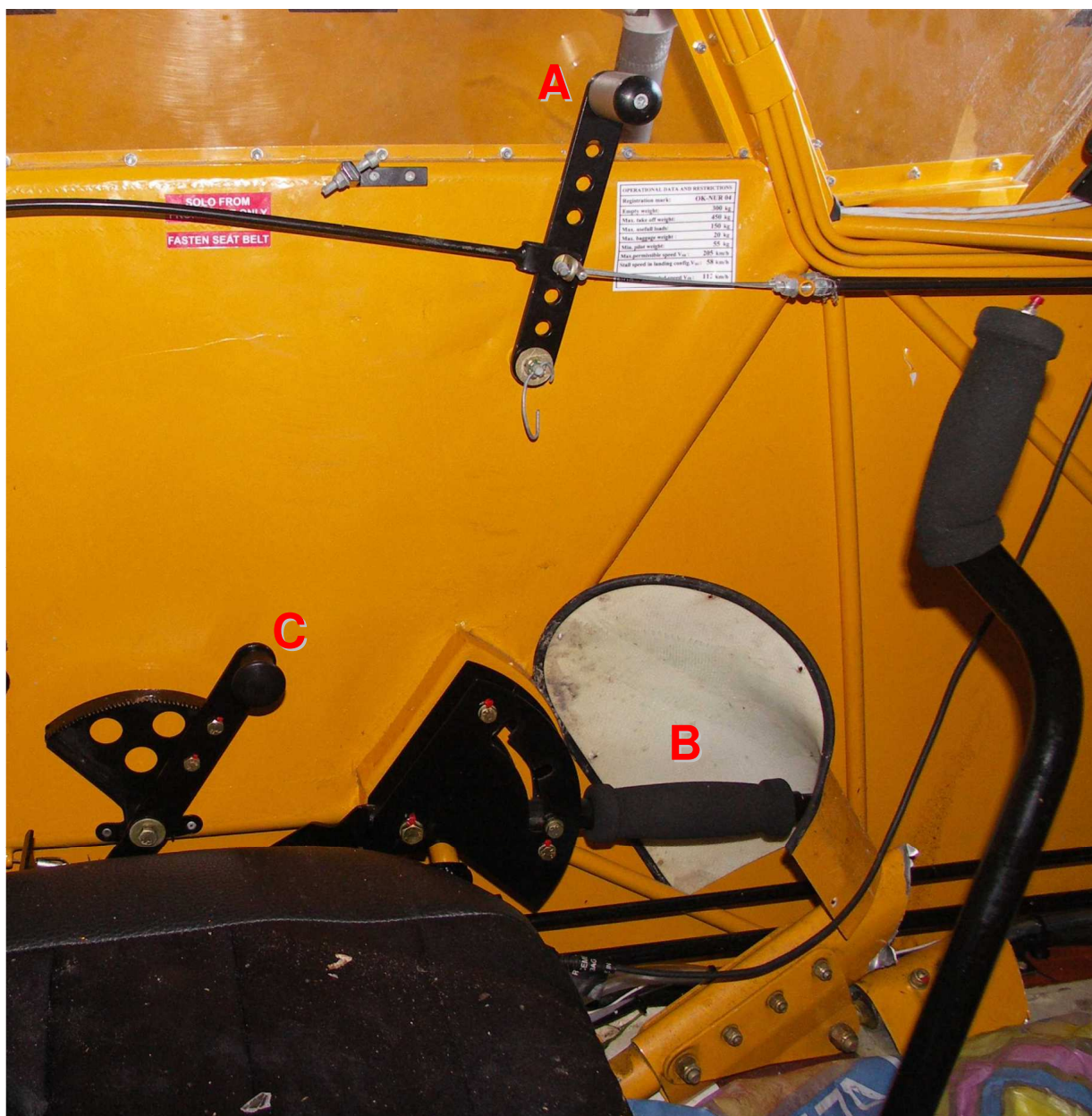
28 – Lewa ściana kabiny pilota. Widoczne położenia dźwigni gazu (A), sterowania klapami (B) i sterowania klapką wyważającą steru wysokości (C).
