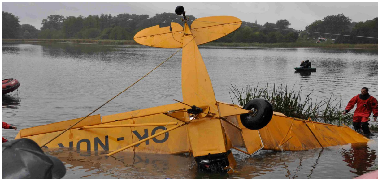
8 – Samolot przy brzegu – początek odwracania do normalnej pozycji. Widoczne zniszczenia podwozia i zastrzałów prawego skrzydła oraz uszkodzenia kadłuba i prawego skrzydła.
