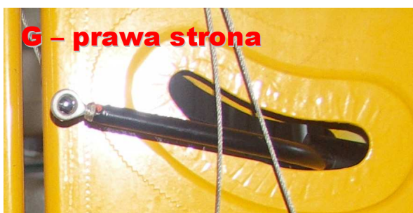
40, 41 – Zakończenie popychacza tylnego wyprowadzone z kadłuba, z końcówkami wyposażonymi w przeguby kuliste do połączenia z dźwigniami na półkach steru wysokości [szczegóły G na fot.33]. Końcówki odłączono od dźwigni na półkach steru wysokości podczas demontażu samolotu po jego wydobyciu z jeziora.
