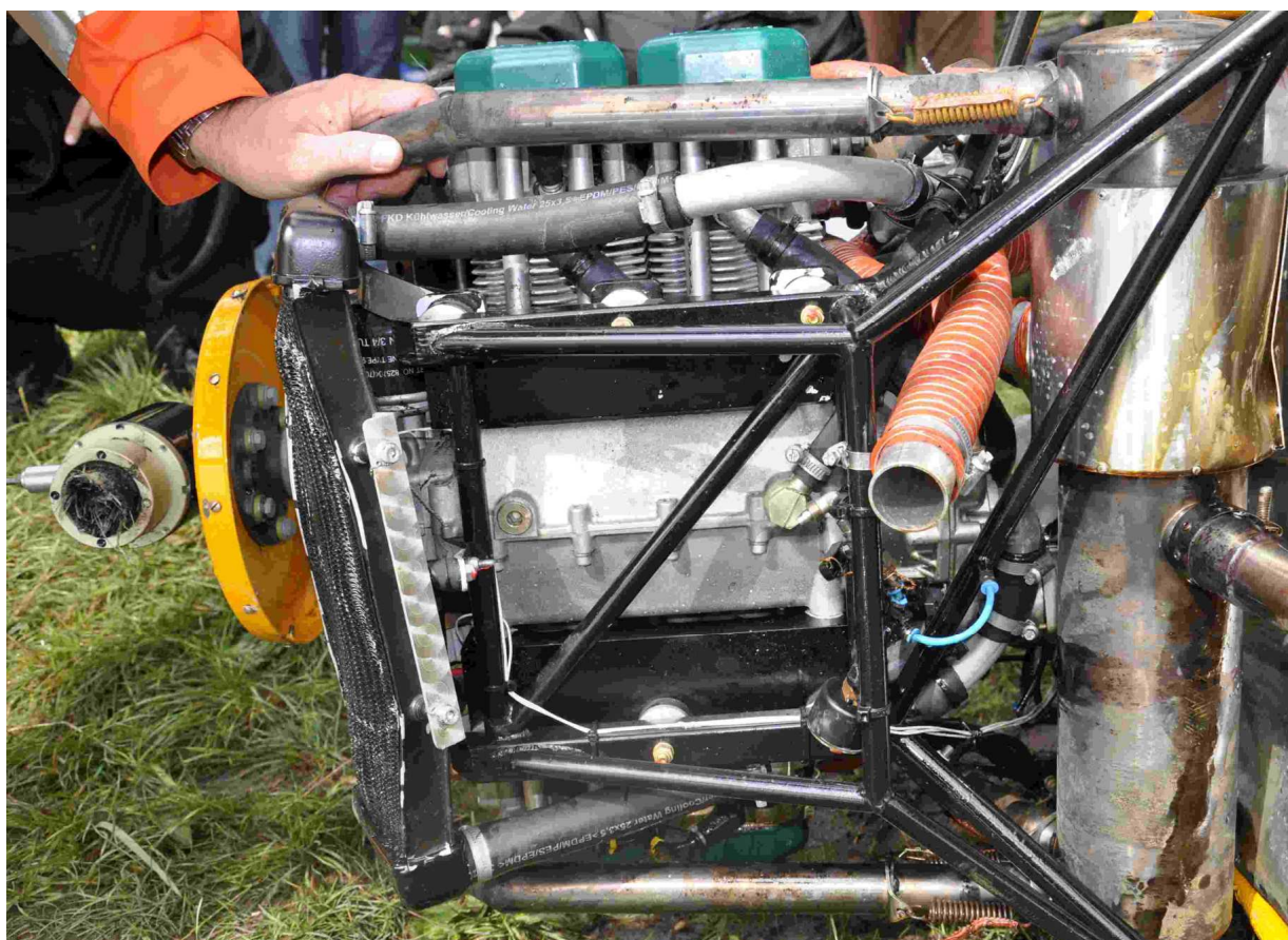
13 – Silnik, dół. Widoczne zniszczone śmigło i chłodnica płynu chłodzącego silnik.
