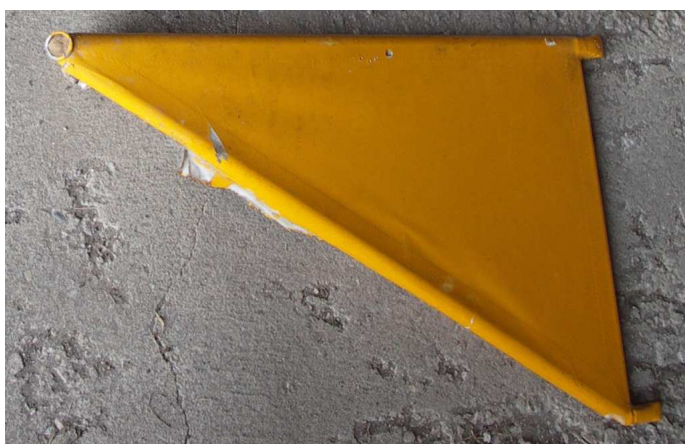
17 – Lewa goleń podwozia głównego oderwana od kadłuba, oś koła odłamana.
