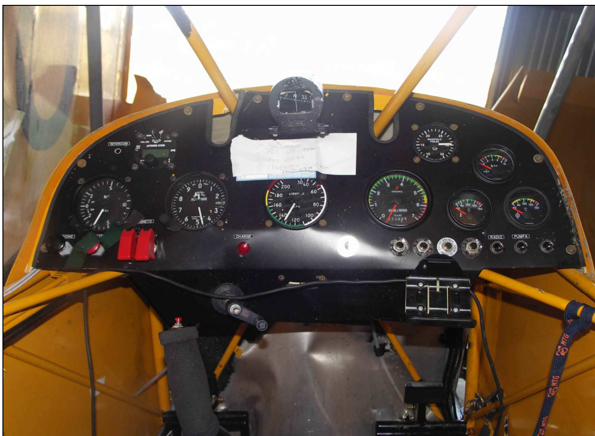
24 – Wnętrze kabiny pilota (przedniej) – widok na tablicę przyrządów. Widoczna rękojeść drążka sterowego, pedały steru kierunku i korbka sterowania skokiem śmigła.
