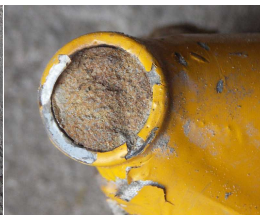
18 – Zbliżenie na odłamane oś koła lewego podwozia głównego.
