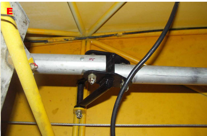
39 – Połączenie popychaczy na wahaczu w połowie długości tylnej części kadłuba [szczegóły E na fot.33].
