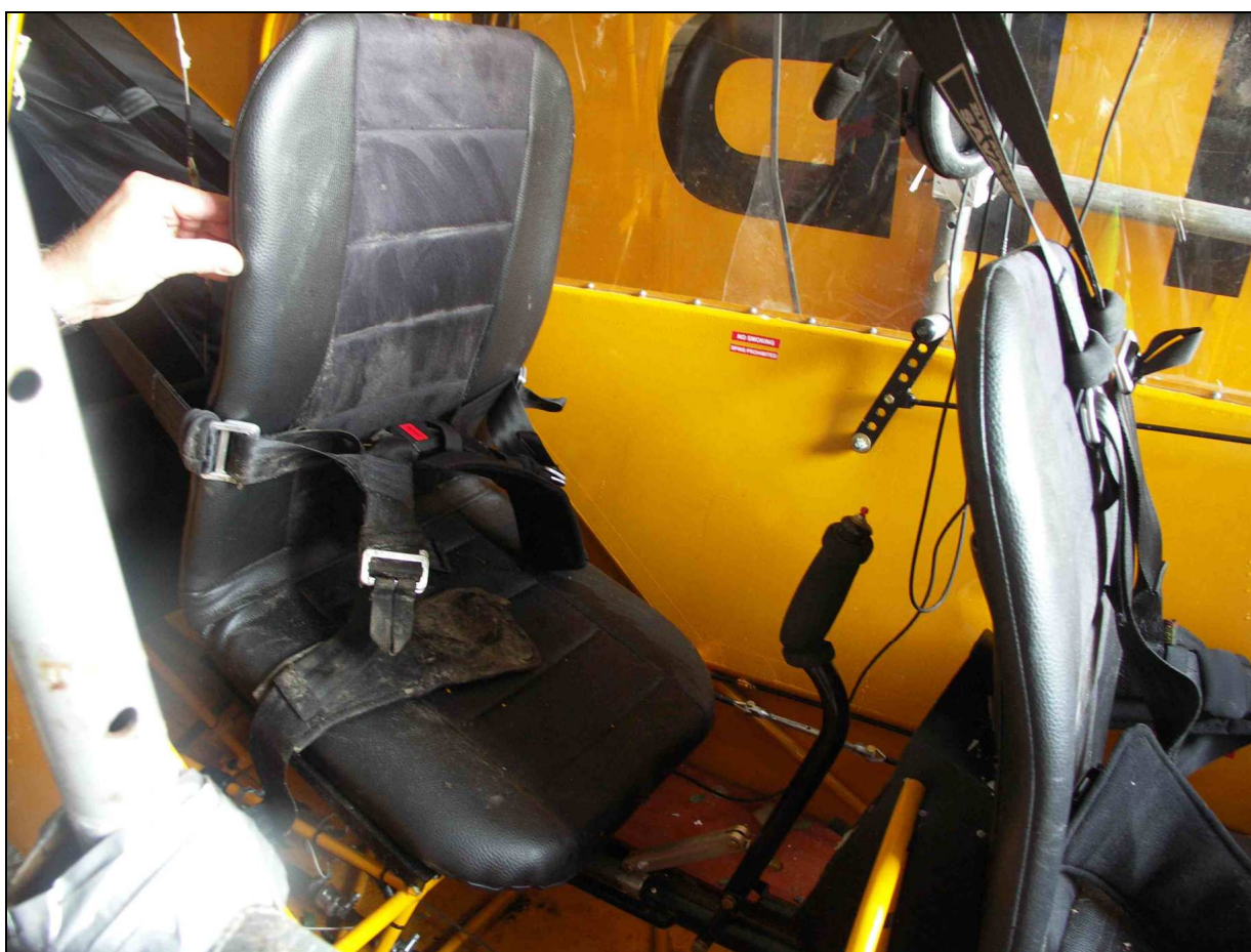
44 – Fotel tylny odchylny do przodu i przytrzymywany pasami bezpieczeństwa zapiętymi na jego oparciu, tylny drążek w skrajnym przednim położeniu. Bezpośredni kontakt popychacza frezowanego z fotelem tylnym zabezpieczonym zapiętymi pasami bezpieczeństwa nie jest możliwy w żadnym położeniu drążka sterowego.
