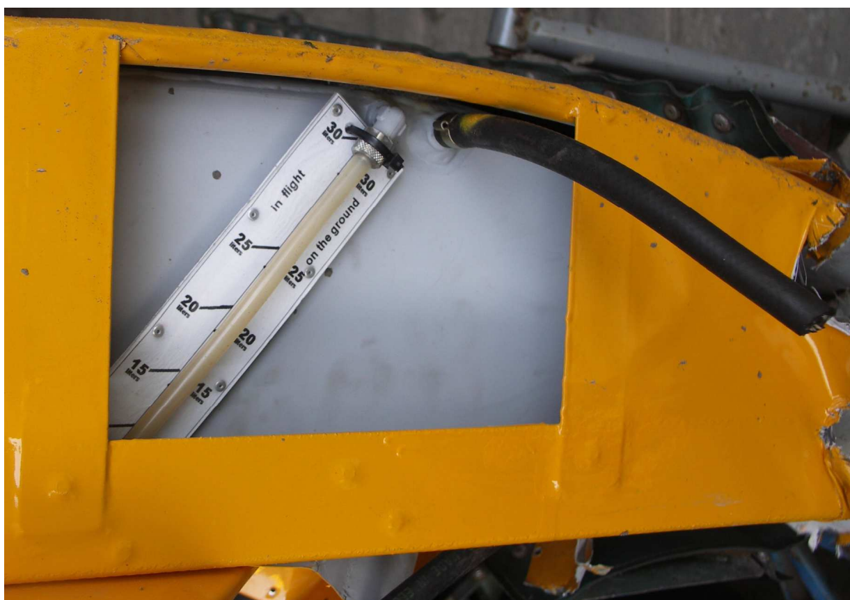
31 – Żebro nasadowe lewego skrzydła z wykresem, w którym widać zbiornik paliwa z rurkowym wskaźnikiem poziomu paliwa. Widoczny wychodzący ze zbiornika czarny przewód paliwowy, odcięty podczas demontażu.
