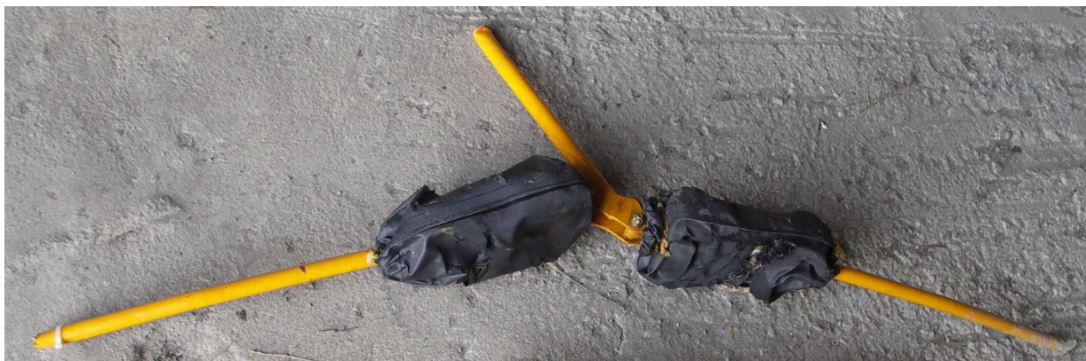
19 – Zespół zastrzałów podwozia głównego z gumowymi amortyzatorami w pokrowcach, oderwany od reszty konstrukcji.
