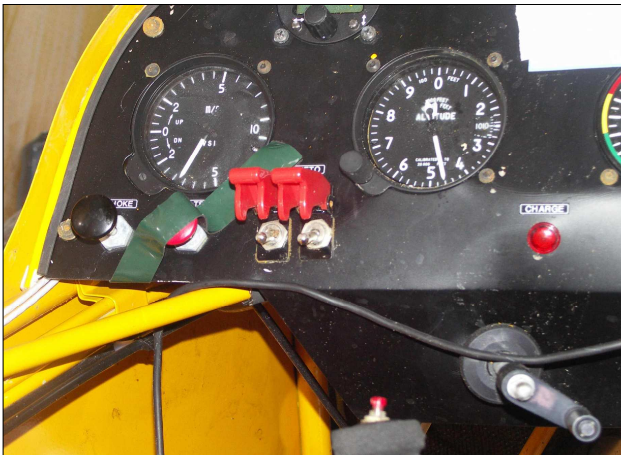
25 – Fragment tablicy przyrządów, widoczne położenie przelączników instalacji elektrycznej.
