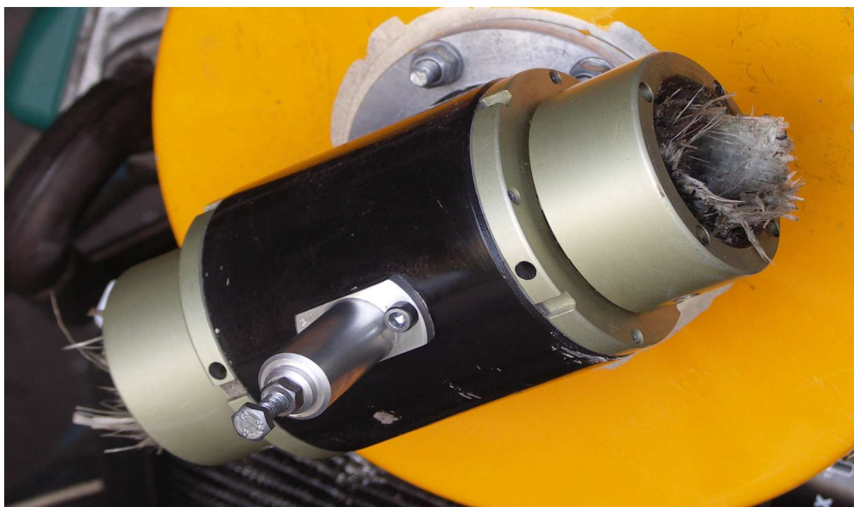
15 – Piasta śmigła. Resztki konstrukcji łopat świadczą o ich gwałtownym zniszczeniu.
