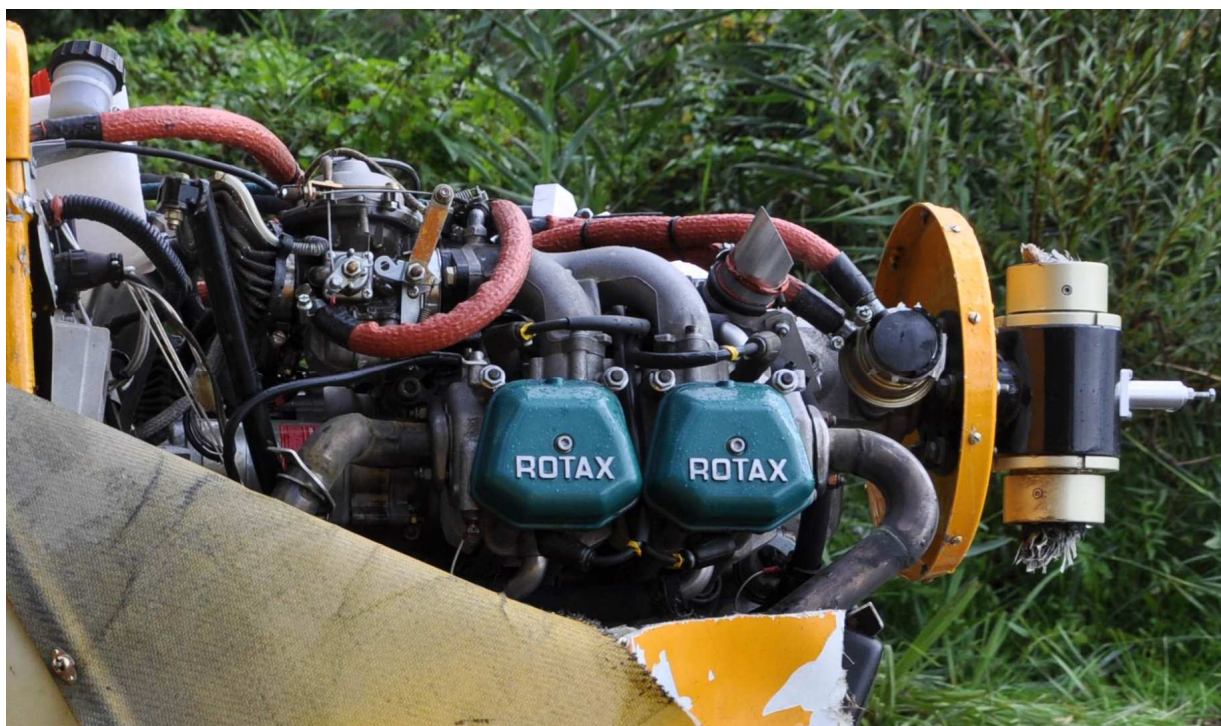
11 – Silnik, prawa strona. Widać zniszczone śmigło i osłony silnika oraz zgnieciony filtr lewego gaźnika. Ciągłość kinematyczna układów sterowania zespołu napędowego zachowana.
