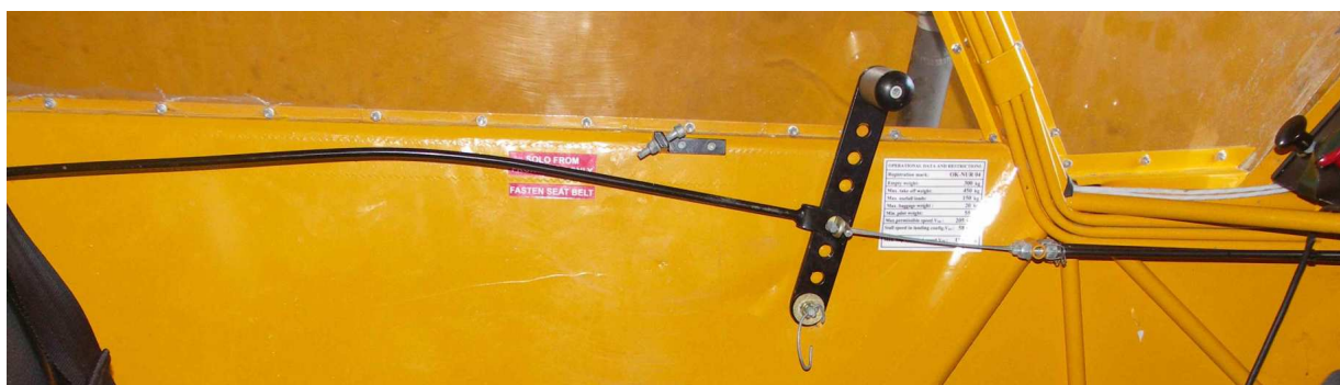
29 – Lewa ściana kabiny pilota. Widoczne uszkodzenie (wyboczenie) popychacza łączącego przednią i tylną dźwignię gazu.
