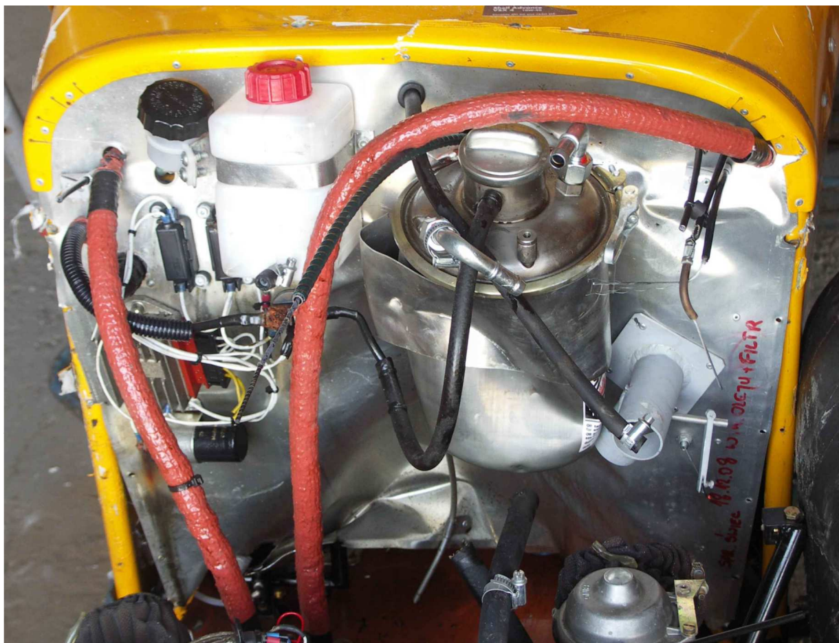
16 – Przegroda ogniowa po odjęciu łoża z silnikiem. Widoczne zgniecenie zbiornika płynu chłodzącego silnik wskutek kontaktu z agregatami silnika oraz zniszczenie przegrody ogniowej.
