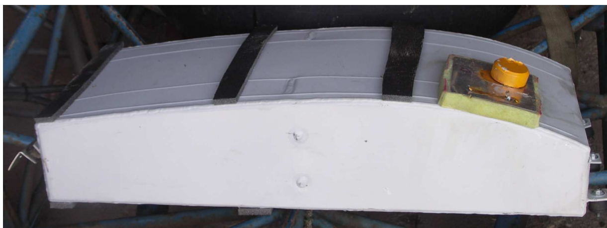
32 – Prawy zbiornik paliwa, wymontowany ze skrzydła.
