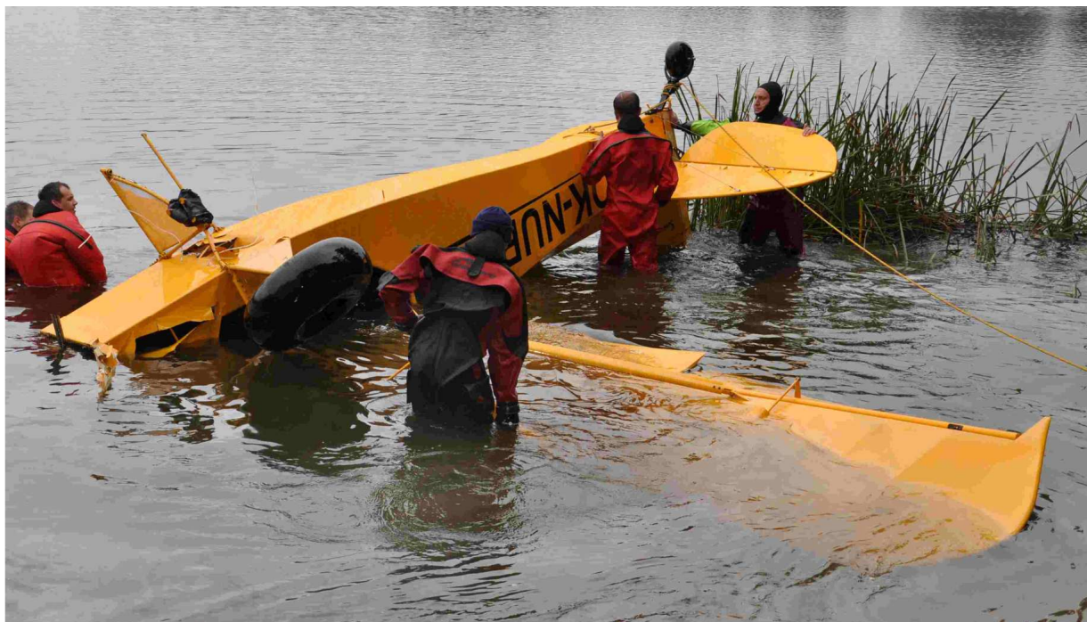
6 – Samolot przy brzegu. Widoczne uszkodzenia podwozia głównego i pokryć przedniej części kadłuba.
