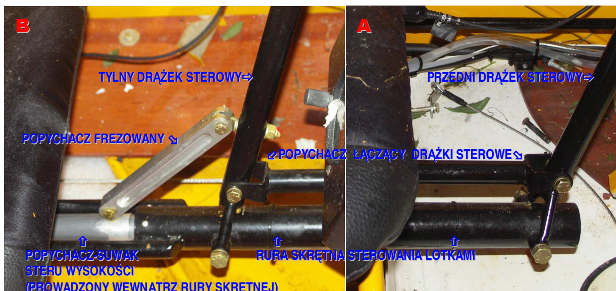
34 – Drążek tylny [szczegół B na fot.33], popychacz sterowania sterem wysokości wewnątrz czarnej rury skrętnej napędu lotek przemieszcza się w niej jak suwak, poruszany frezowanym krótkim popychaczem frezowanym łączącym go z drążkiem sterowym. Widać skraj siedziska tylnego fotela z wyraźnym odciskiem popychacza frezowanego [po doświadczeniu pokazanym na fot.45/46].
