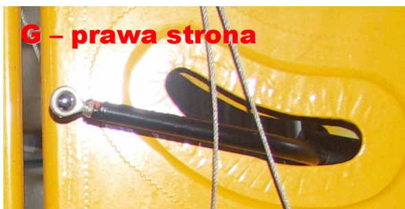
8, 9 – Zakończenie popychacza tylnego wyprowadzone z kadłuba, z końcówkami wyposażonymi w przeguby kuliste do połączenia z dźwigniami na półówkach steru wysokości [szczegół G na fot.1].
