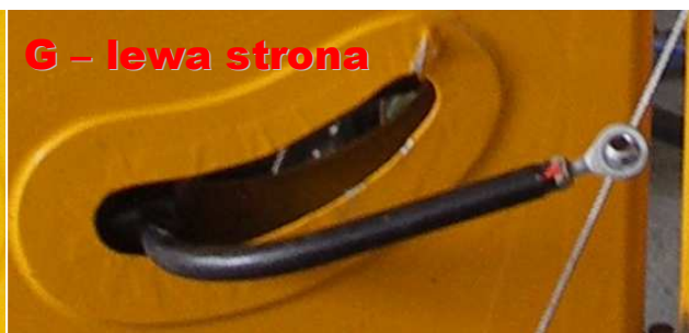
8, 9 – Zakończenie popychacza tylnego wyprowadzone z kadłuba, z końcówkami wyposażonymi w przeguby kuliste do połączenia z dźwigniami na półówkach steru wysokości [szczegół G na fot.1].
