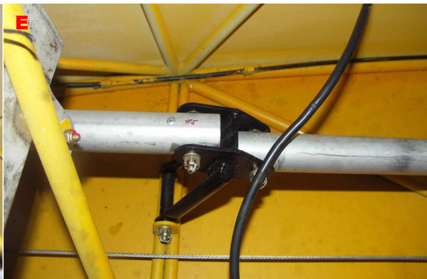
7 – Połączenie popychacza na wahaczu w połowie długości tylnej części kadłuba [szczegół E na fot.1].
