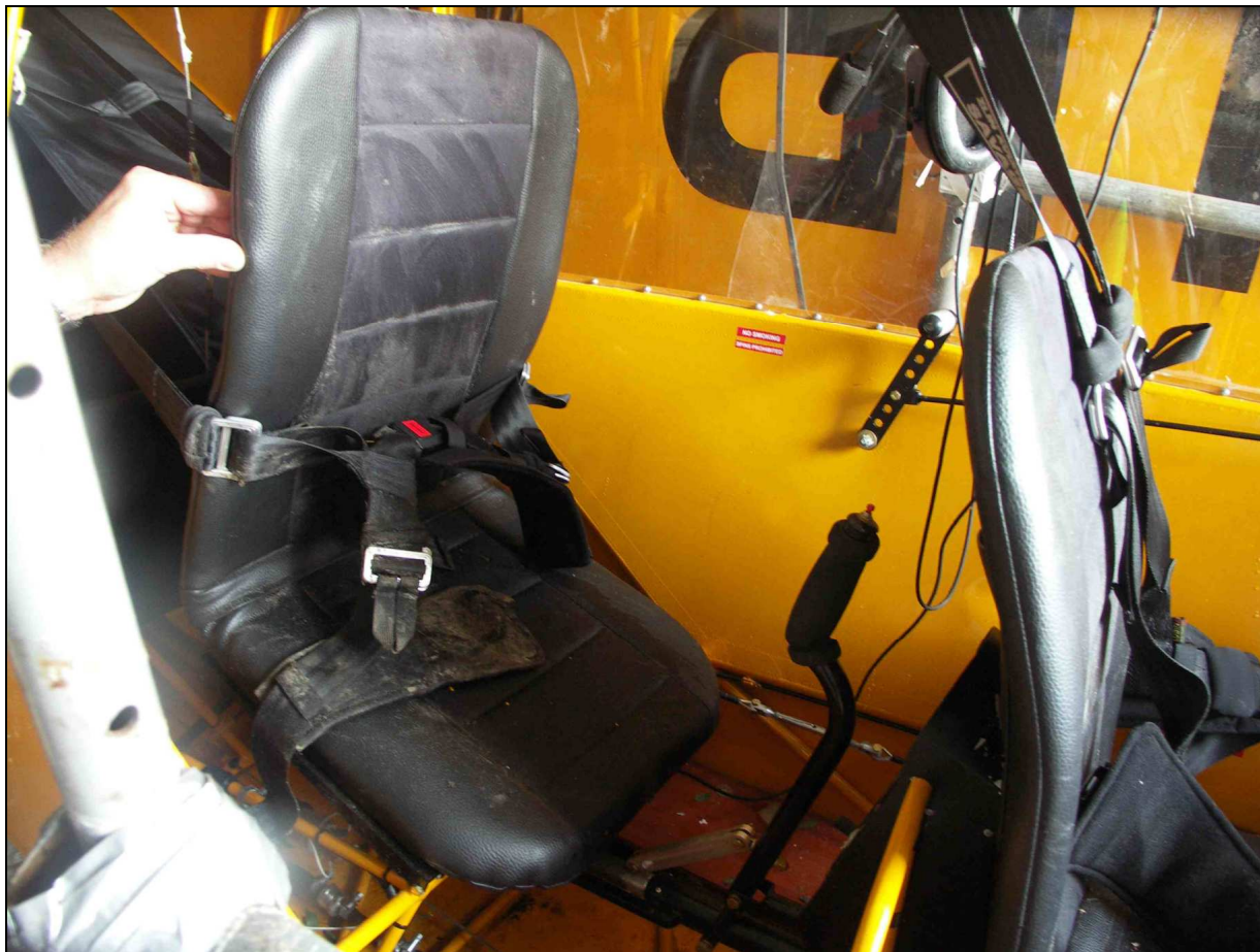
12 – Fotel tylny odchylony do przodu i przytrzymywany pasami bezpieczeństwa zapiętymi na jego oparciu, tylny drążek w skrajnym przednim położeniu.
