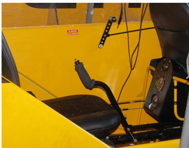
10, 11 – Tylna kabina – pokazane skrajne tylne [po lewej] i skrajne przednie [po prawej] położenie drążka sterowego.
