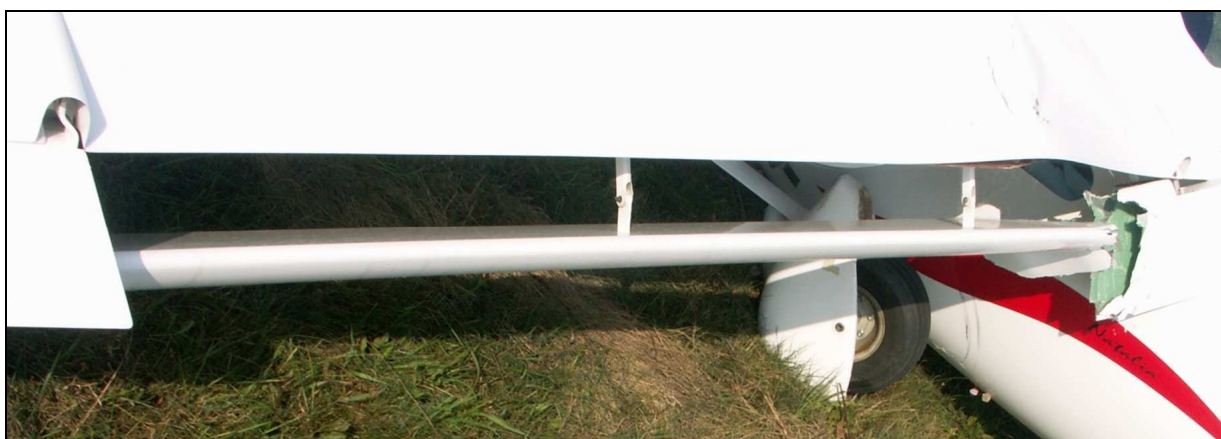
11 – Zniszczona klapa na lewym skrzydle od strony spływu. W tle wyłamane lewe podwozie główne.
