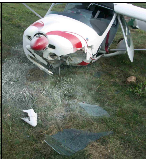
6 – Szczałki oszklenia wiatrochronu i owiewki koła podwozia przed samolotem.
