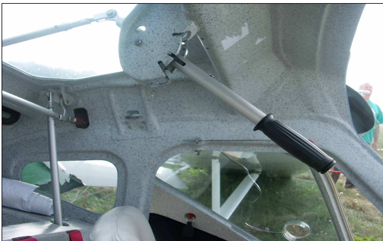
15 – Wnętrze kabiny – widok na lewą burtę i sufit. Dźwignia kłap w położeniu „WYPUSZCZONE - START”.
