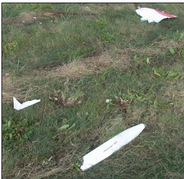
5 – Szczałki dolnej osłony silnika i łopata śmigła.
