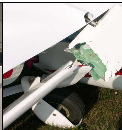
14 – Przełom lewej kłapy od tyłu.
