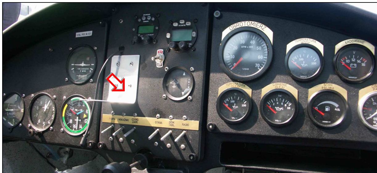
17 – Tablica przyrządów, widok ogólny. Czerwona strzałką wskazana donitowana do tablicy blaszana „pótczka”, stanowiąca element zagrożenia dla głowy pilota w razie wypadku połączonego z przewracaniem się kadłuba. Jest to klasyczny przykład nieprzemyślanej modyfikacji ingerującej w projekt typu.
