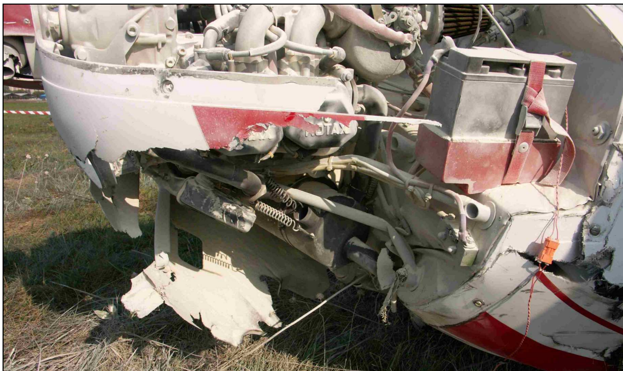
21 – Silnik z lewej strony. Widoczne zniszczenia łoża, instalacji silnikowych i dolnej osłony oraz ślady przewencyjnie użytego środka gaśniczego.
