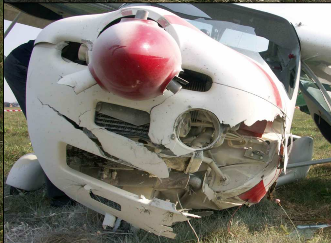
9 i 10 – Zniszczone śmigło i dolna osłona silnika.
