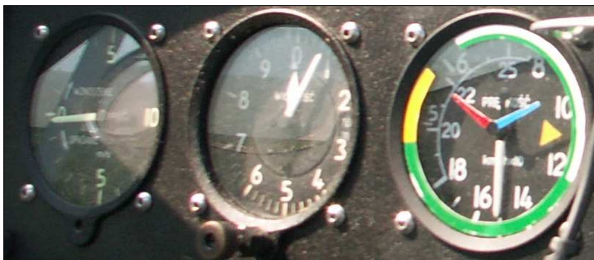
18 – Zbliżenie na podstawowe przyrządy pilotażowe – od lewej: wariometr, wysokościomierz, prędkościomierz.
