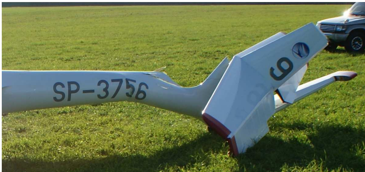
12 – Złamana i ukrzywiona belka ogonowa z usterzeniem, lewa strona.
