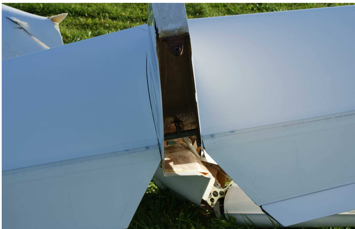
17 – Widok z góry na zniszczone usterzenie pionowe – widoczna tylna ścianka dźwigara statecznika pionowego.
