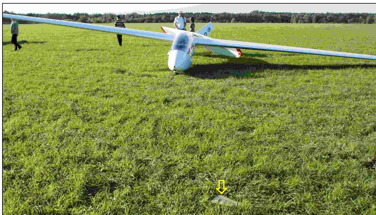
5 – Szybowiec po wypadku i [na pierwszym planie] oderwana pokrywka luku kontrolnego na grzbiecie kadłuba.
