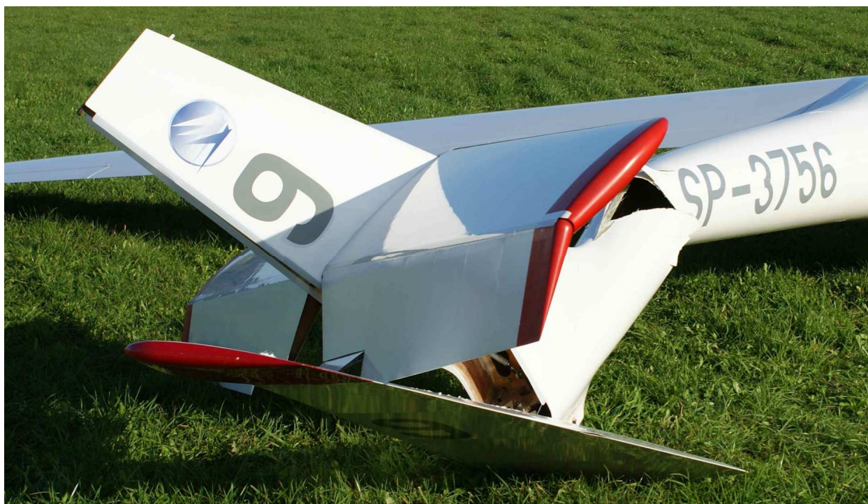
14 – Zniszczone usterzenie – widok ogólny z prawej strony od tyłu.
