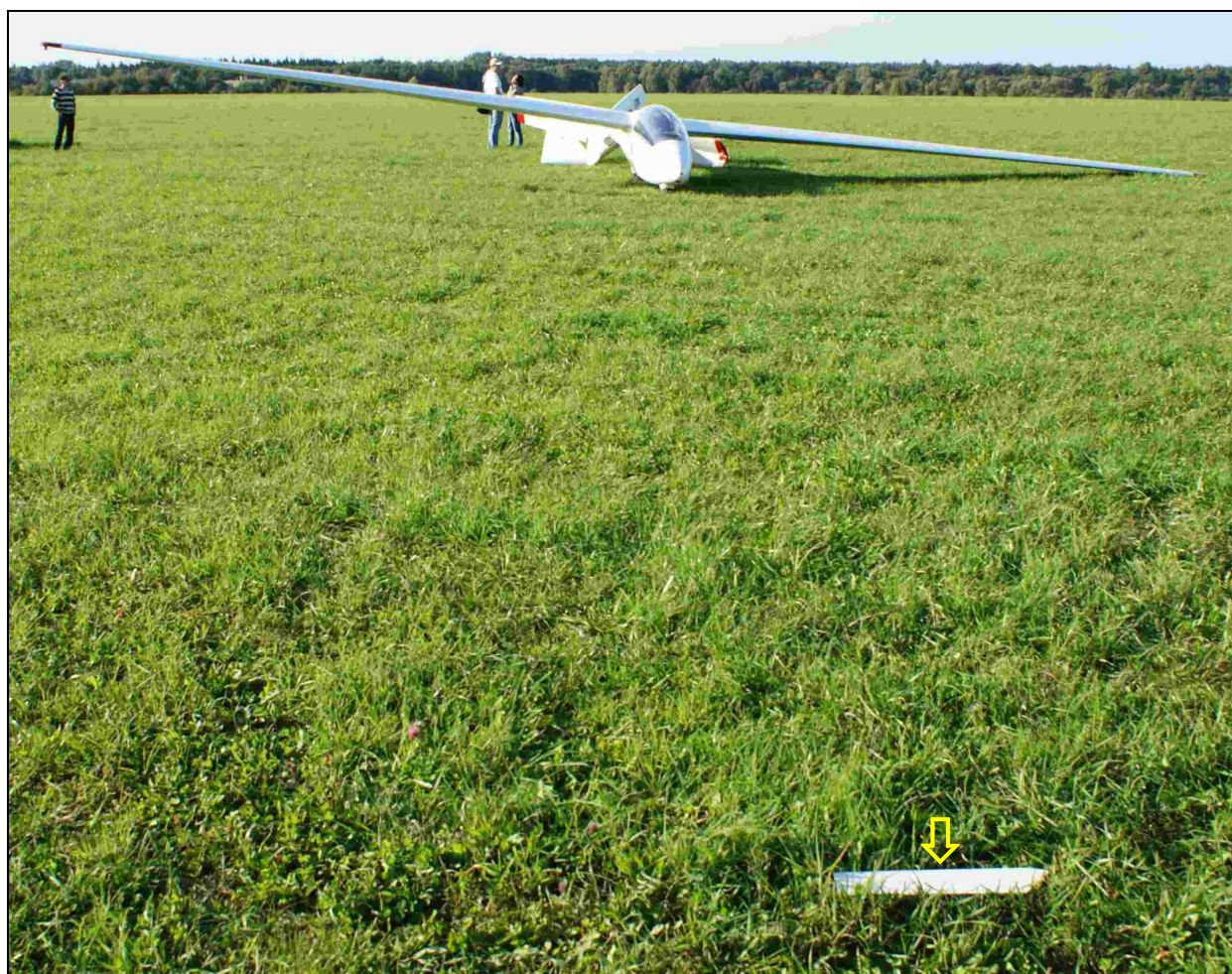
4 – Szybowiec po wypadku i [na pierwszym planie] oderwana klapka wyważająca lewego segmentu steru wysokości.
