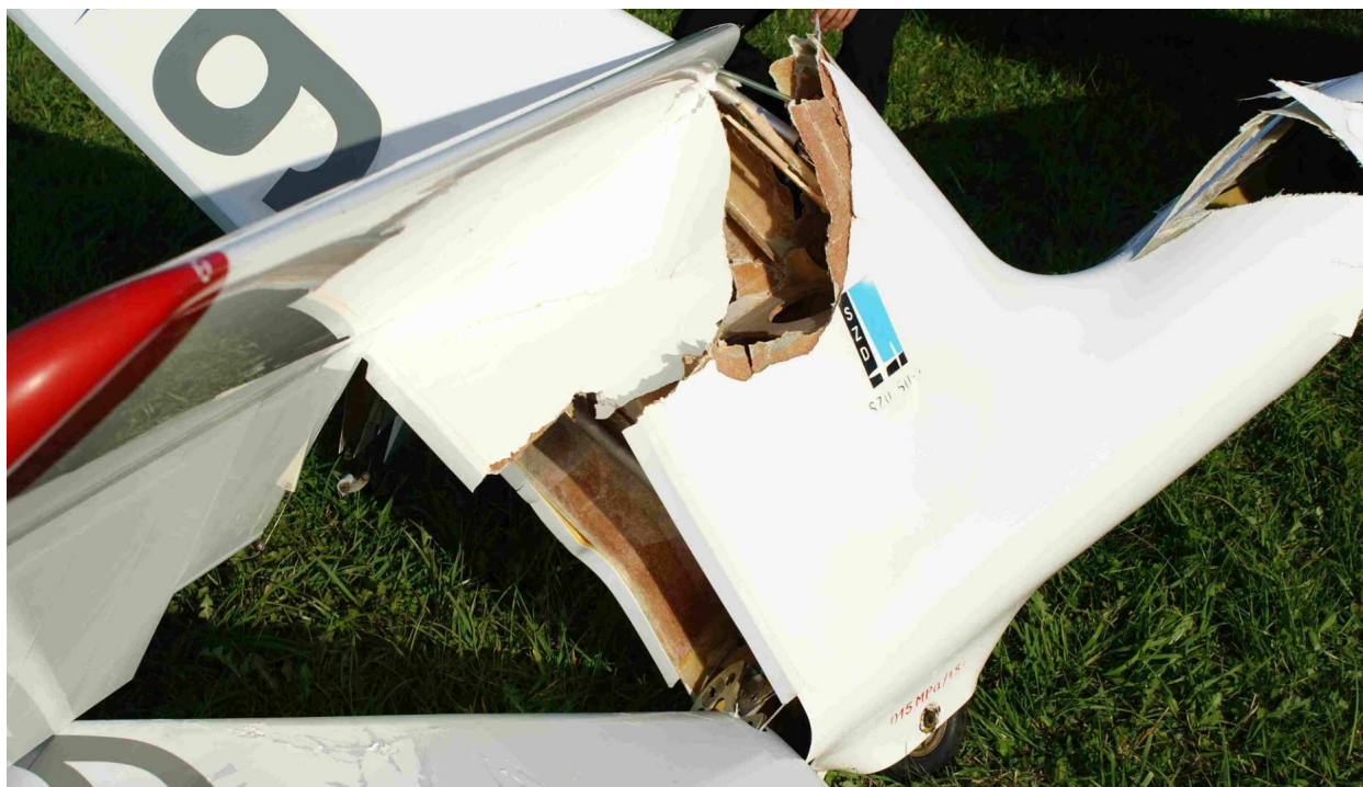
15 – Przełom statecznika pionowego, prawa strona od tyłu. Widoczny ster kierunku, pozostający na dolnym zawiasie.
