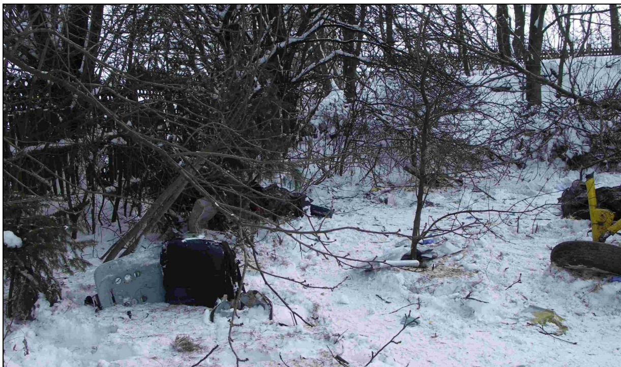
44 – Fotel pilota, wyrwany i wyrzucony ze śmigłowca siłą bezwładności.
