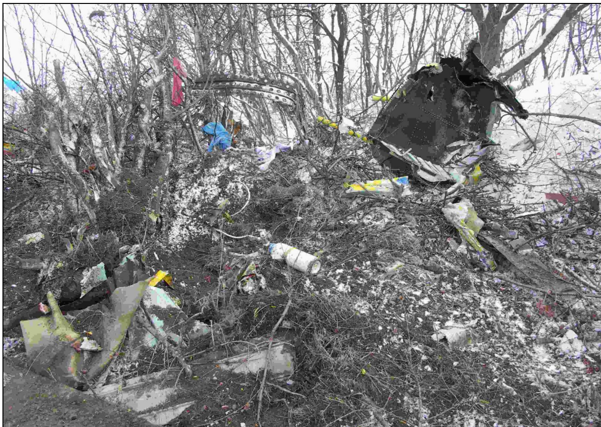
27 – Szczątki podłogi i dolnej części struktury kadłuba. Na dalszym planie większy fragment pokrycia kadłuba.
