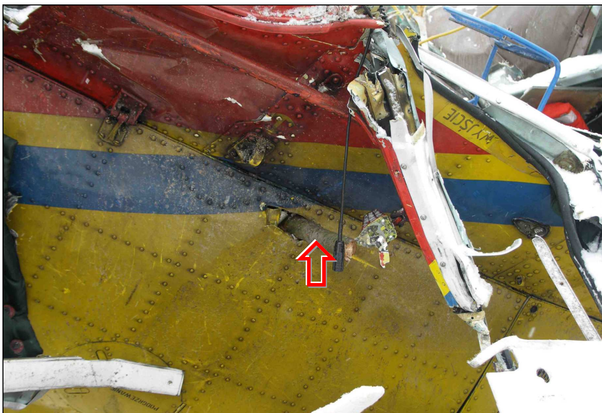
51 – Fragment pokrywy lewego silnika, przebitej na wylot gałęzią drzewa [w centrum kadru, wskazana strzałką].
