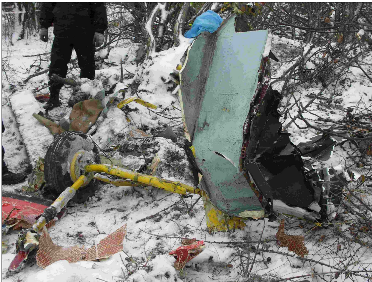
29 – Fragment pokrycia strukturalnego zbiornika paliwa oraz lewe podwozie główne.
