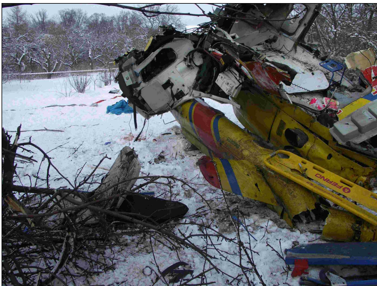
49 – Wywrócona górna część kadłuba i rozsypane wyposażenie medyczne. Widoczna połamana belka ogonowa i oderwany tylny segment kadłuba.
