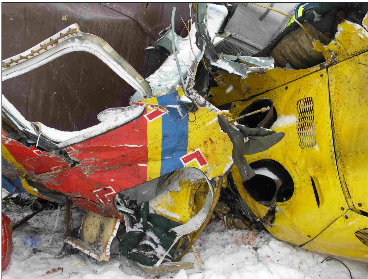
45 – Prawa strona wywróconego kadłuba. Na pierwszym planie fragment zniszczonego pokrycia prawej burty z obramowaniami okien.
