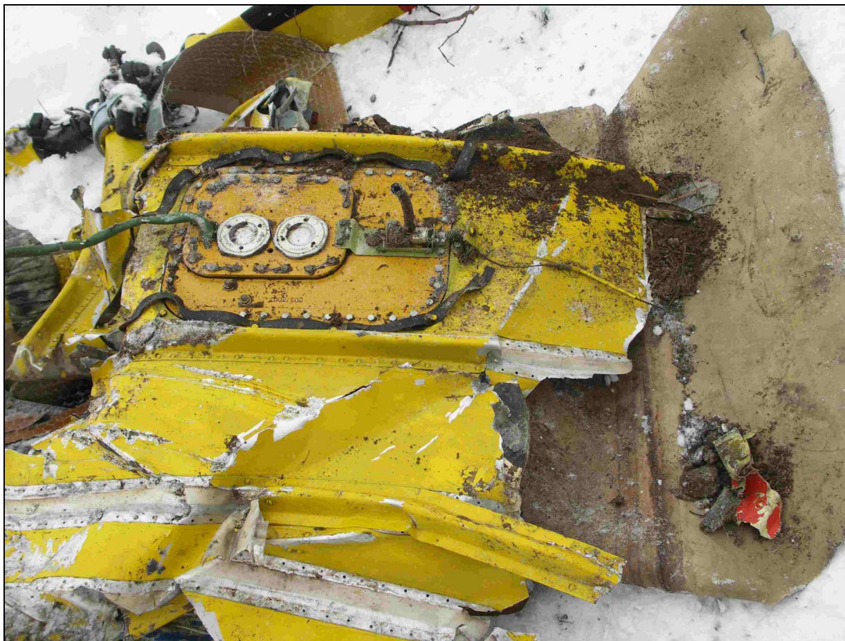
30 – Fragment pokrycia strukturalnego zbiornika paliwa z nadajnikami poziomu paliwa.
