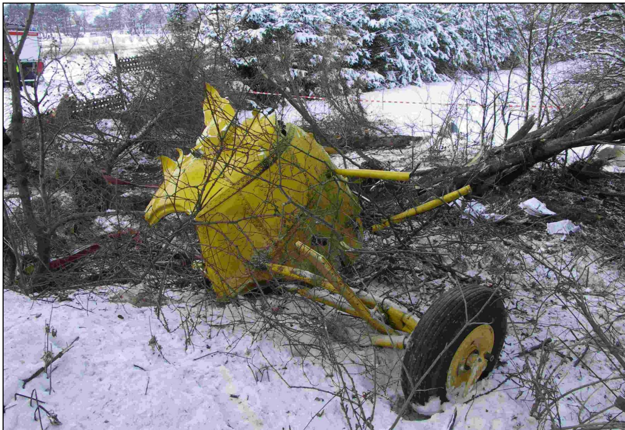
28 – Fragment pokrycia strukturalnego zbiornika paliwa oraz zamocowane do niego lewe podwozie główne i zastrzały prawego podwozia głównego.
