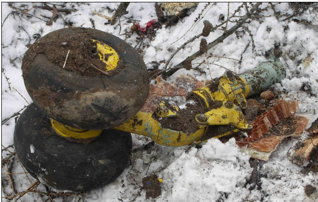
32 – Przednie podwozie po wykopaniu z gruntu, pod nim szczątki łopaty wirnika głównego [wypełniacz ulowy].
