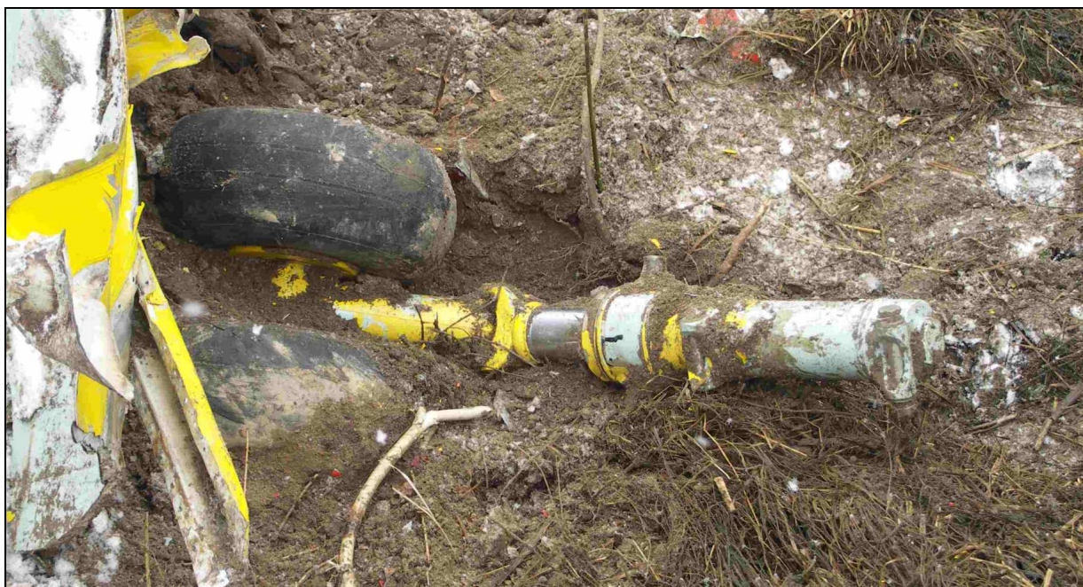
31 – Podwozie przednie częściowo zagłębione w grunt.
