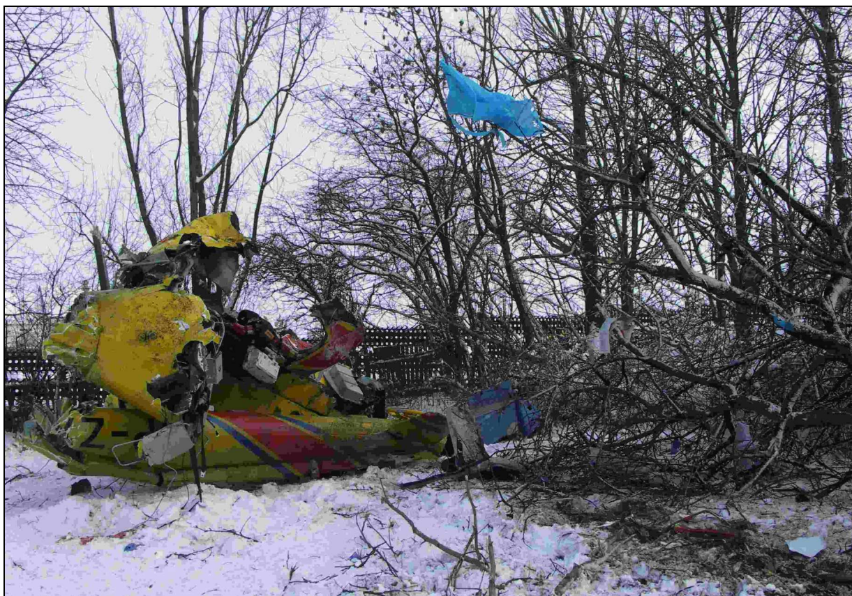
39 – Ogólny widok zniszczonego kadłuba. Z prawej strony kadru drzewa połamane i powalone przez ślizgający się po nich kadłub.
