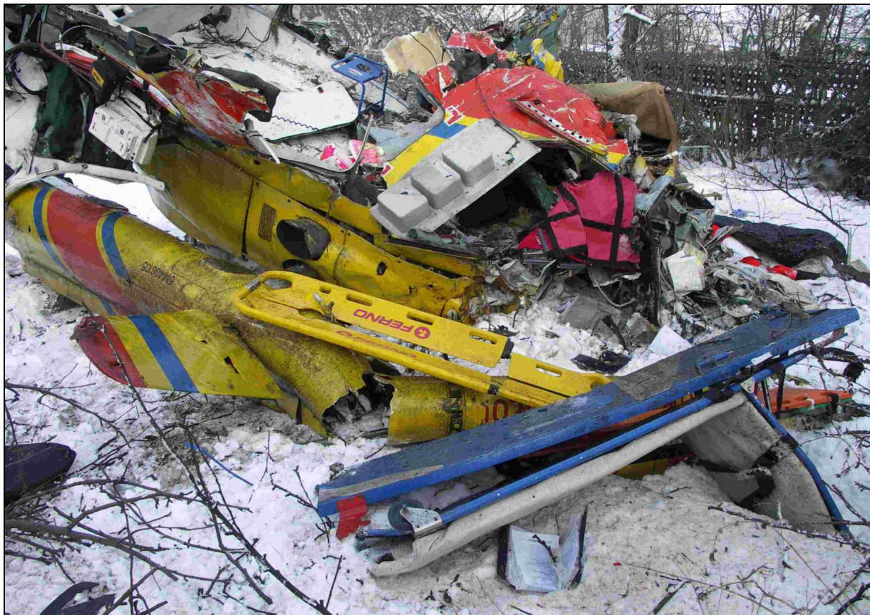
48 – Wywrócona górna część kadłuba i rozsypane wyposażenie medyczne. Widoczna połamana belka ogonowa.
