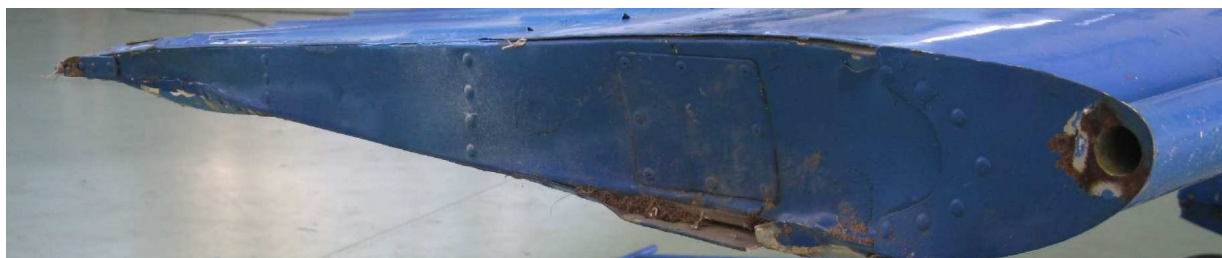
12 – Uszkodzone wskutek zetknięcia z ziemią przy dobiegu żebro końcowe prawej końcówki steru wysokości.
