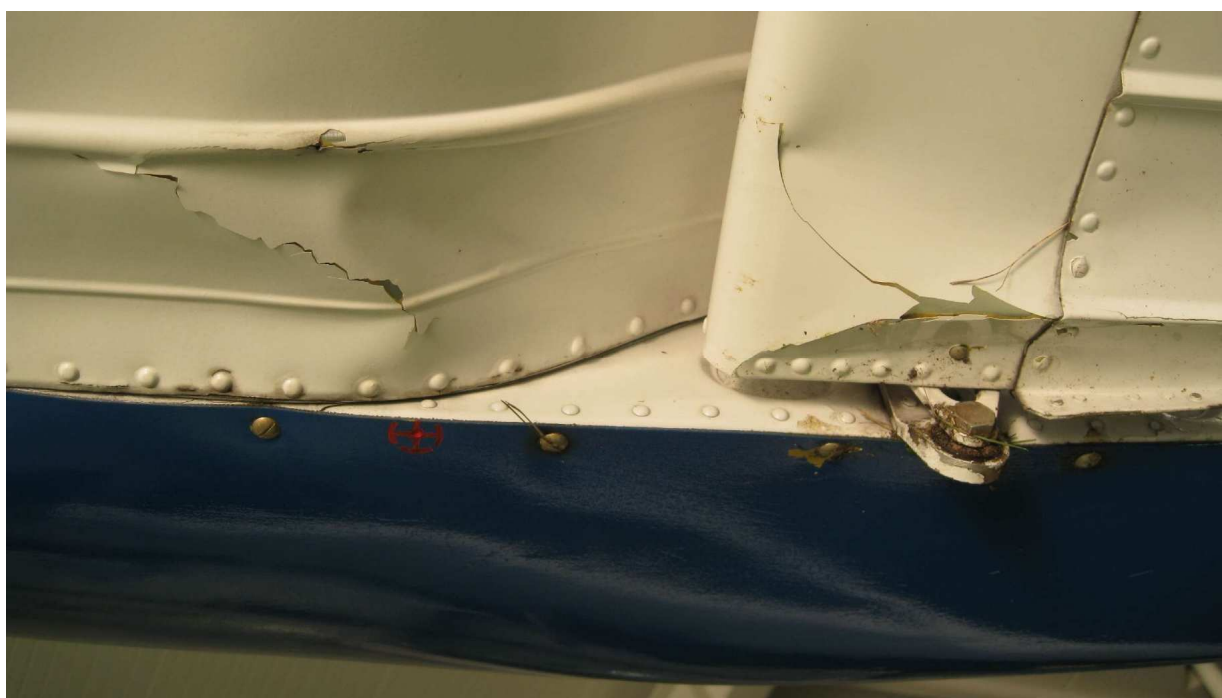
16 – Uszkodzenia prawej zakończenia prawej lotki na nosku i pokryć spływowej części skrzydła w rejonie jego prawej końcówki, pokazane od dołu.
