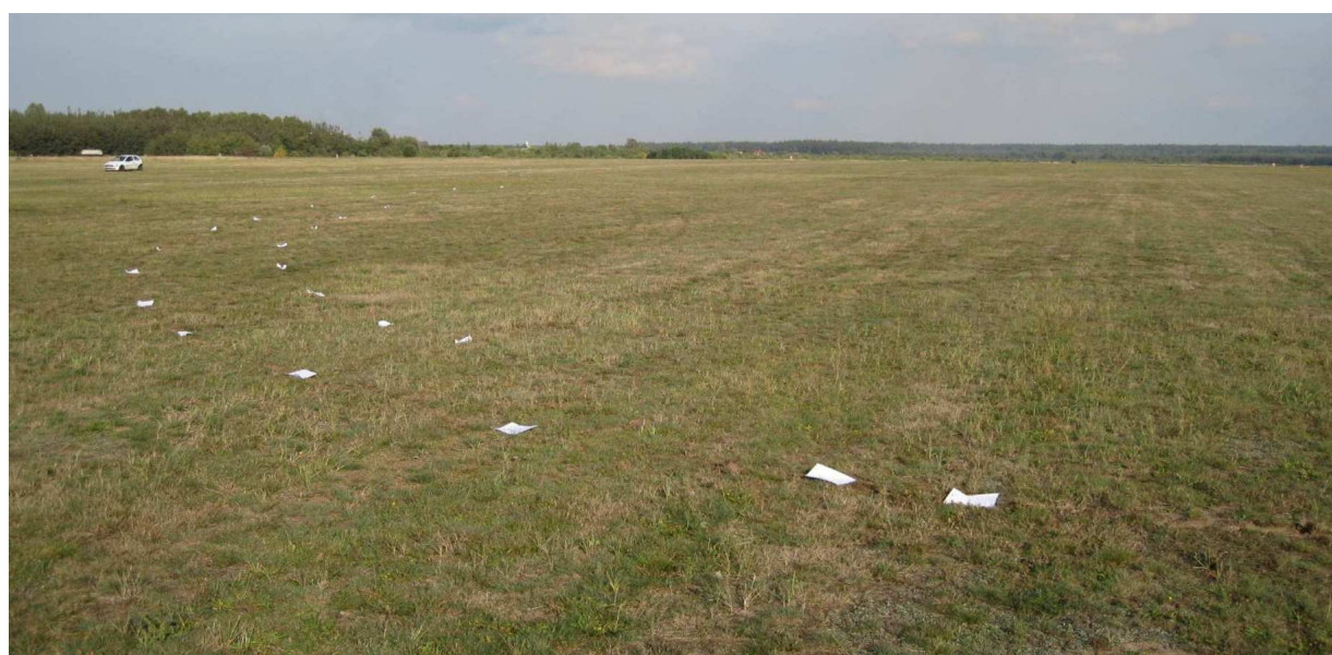
7 – Ślad dobiegu po utracie kierunku w lewo – dla lepszej widoczności oznakowany kartkami papieru. Widok w kierunku przeciwnym do kierunku lądowania.
