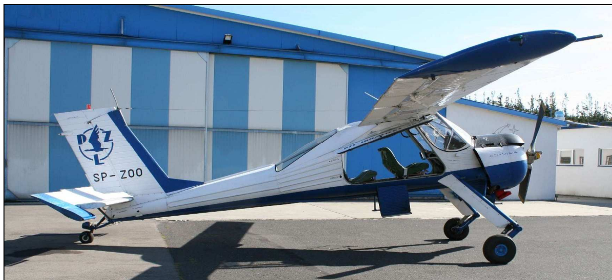
8 – Ogólny widok samolotu po wypadku (samolot umyty). Nie widać uszkodzeń podwozia.
