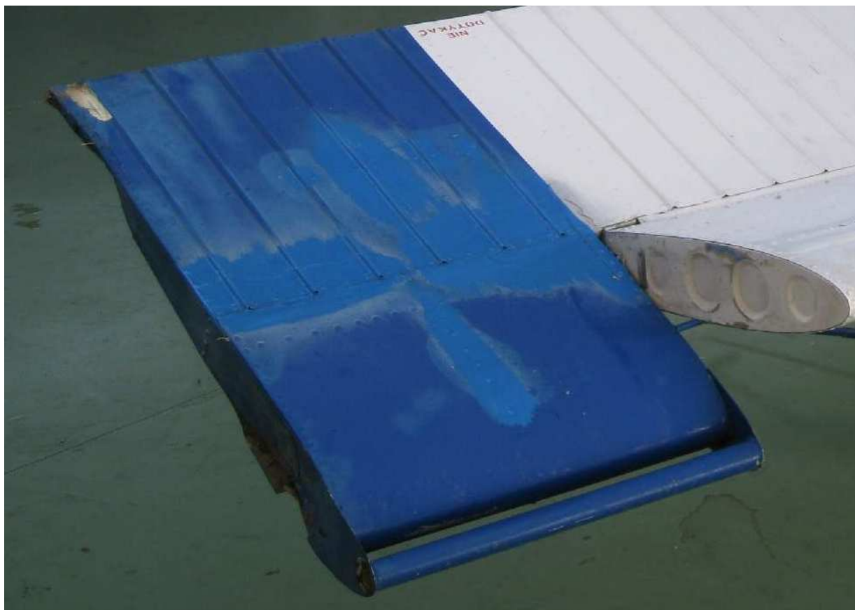
11 – Uszkodzona prawa końcówka steru wysokości – widok ogólny.
