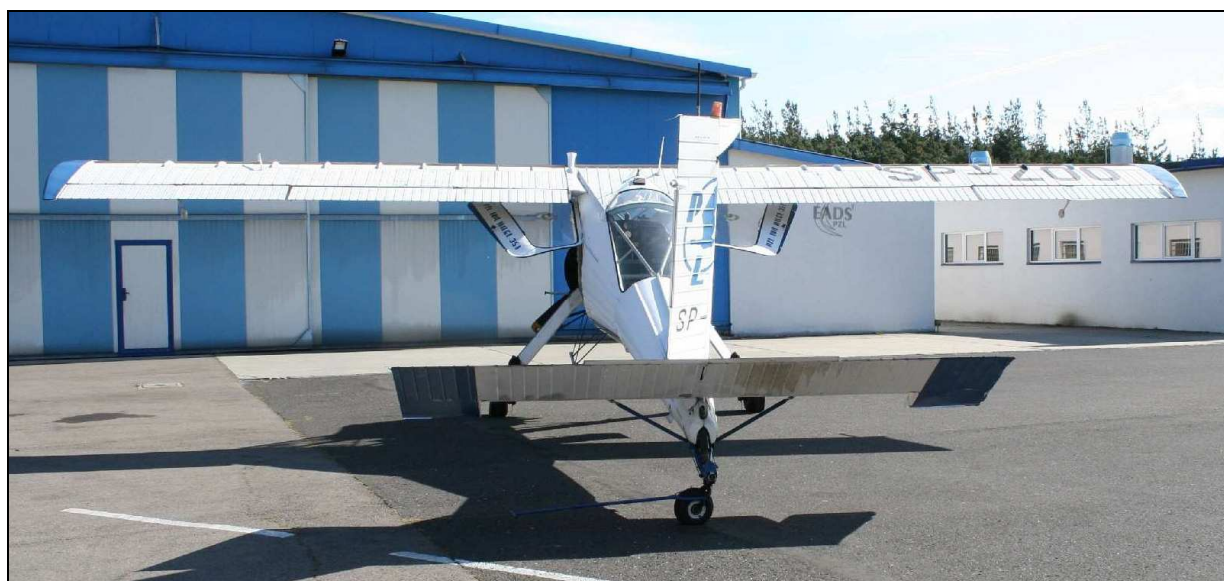
10 – Ogólny widok samolotu z tyłu po wypadku. Nie widać oznak zniekształceń (zakłócenia niwelacji).
