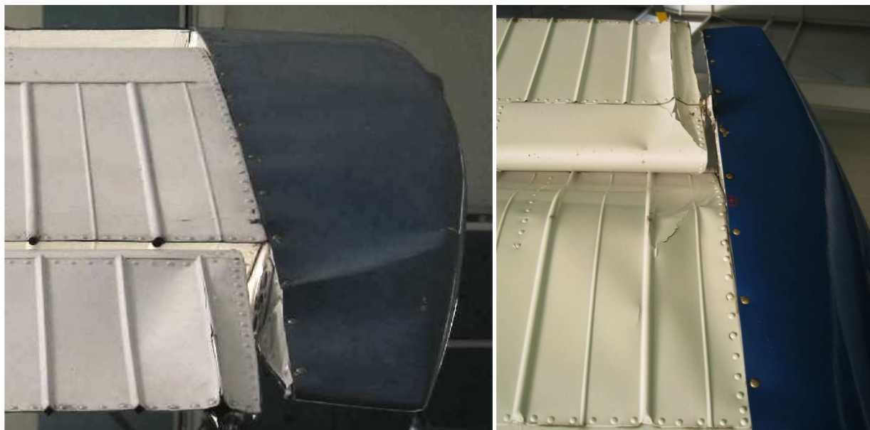
14, 15 – Uszkodzenia prawej końcówki skrzydła, zakończenia prawej lotki i pokryć spływowej części skrzydła w rejonie jego prawej końcówki, pokazane od góry (z lewej) i od dołu (z prawej).
