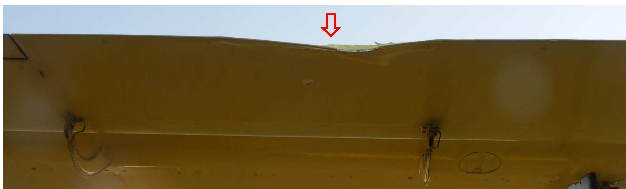
9 – Uszkodzenie krawędzi spływu lotki lewego górnego skrzydła – widok z tyłu od spodu.
