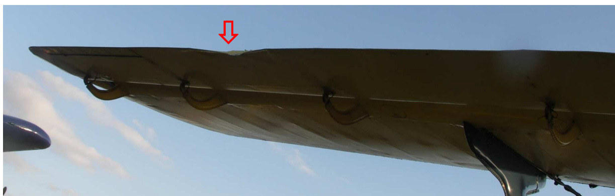
7, 8 – Uszkodzenie krawędzi spływu lotki lewego górnego skrzydła – widok ogólny z tyłu od spodu.
