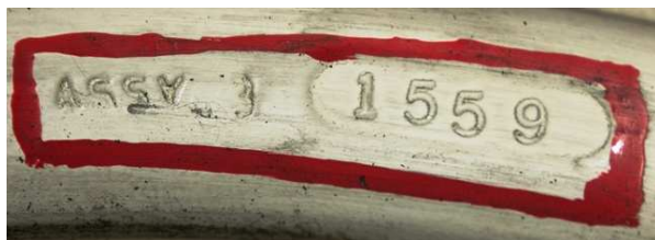
30a, b. Numery identyfikacyjne koła NWA 2: nr zespołu (Assy) i nr seryjny (S/N).
