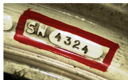
20a, b. Numery identyfikacyjne koła MWA 3 nr zespołu (Assy) i nr seryjny (S/N).
