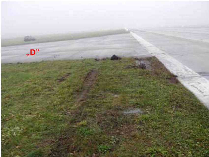
9. Ślad lewego podwozia głównego przed wjazdem na drogę kołowania D; w tym momencie koła podwozia przedniego były jeszcze na pasie.
