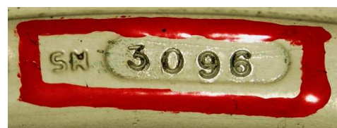
26a, b. Numery identyfikacyjne koła NWA 1: nr zespołu (Assy) i nr seryjny (S/N).
