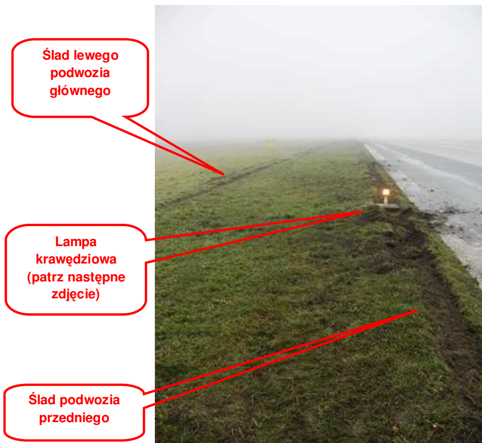
10. Ślady podwozia przedniego i lewego głównego na wysokości pierwszej zniszczonej przez samolot lampy.
