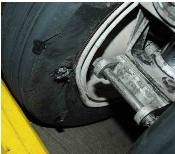
31a, b. Zdjęcie koła NWA 2 wykonane zamontowanego na samolocie. Wyraźnie widoczne uszkodzenia opony i felgi, których nie można nie zauważyć przy przedlotowym przeglądzie samolotu.
