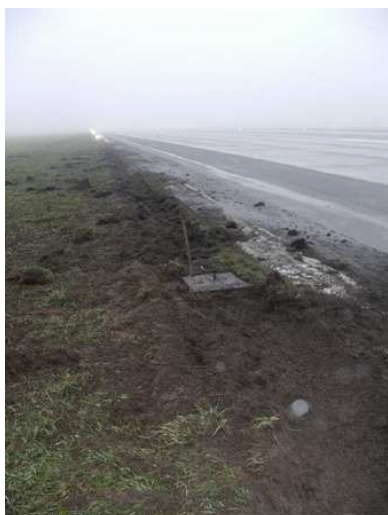
13a, b. Druga, zniszczona przez przednie podwozie, lampa krawędziowa.
