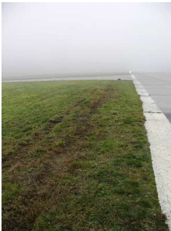
8. Ślad lewego podwozia głównego obok drogi startowej; w tym momencie koła podwozia przedniego były jeszcze na pasie.
