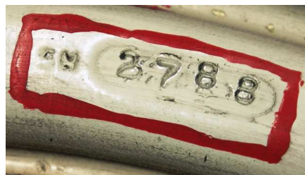
30a, b. Numery identyfikacyjne koła NWA 2: nr zespołu (Assy) i nr seryjny (S/N).
