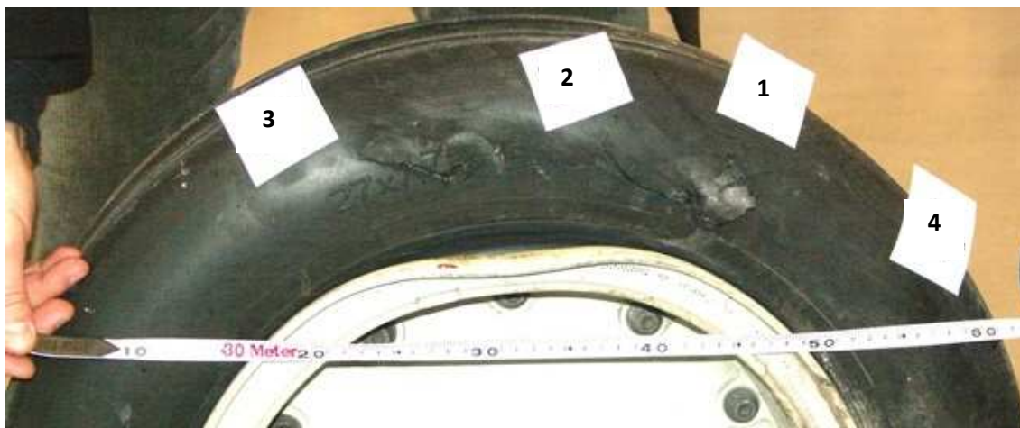
32. Umieszczenie uszkodzeń na NWA 2 (zdjęcie wykonane w hangarze).
