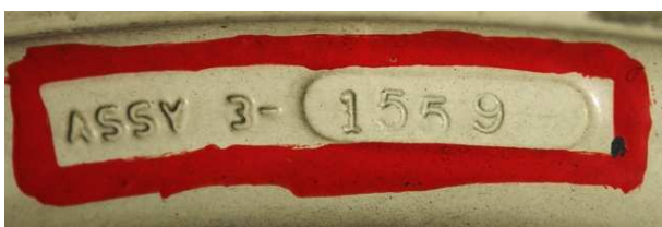
26a, b. Numery identyfikacyjne koła NWA 1: nr zespołu (Assy) i nr seryjny (S/N).
