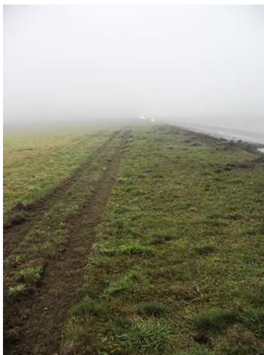
12. Ślad lewego podwozia głównego, na tym odcinku równoległy do drogi startowej.
