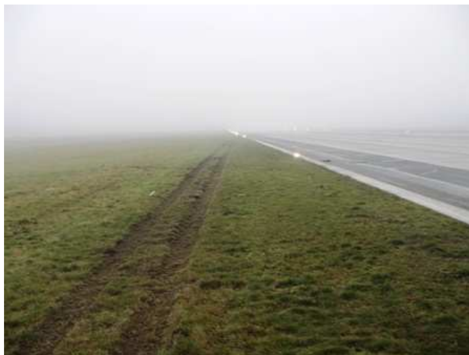
16. Ślad lewego podwozia głównego – powrót samolotu na drogę startową.
