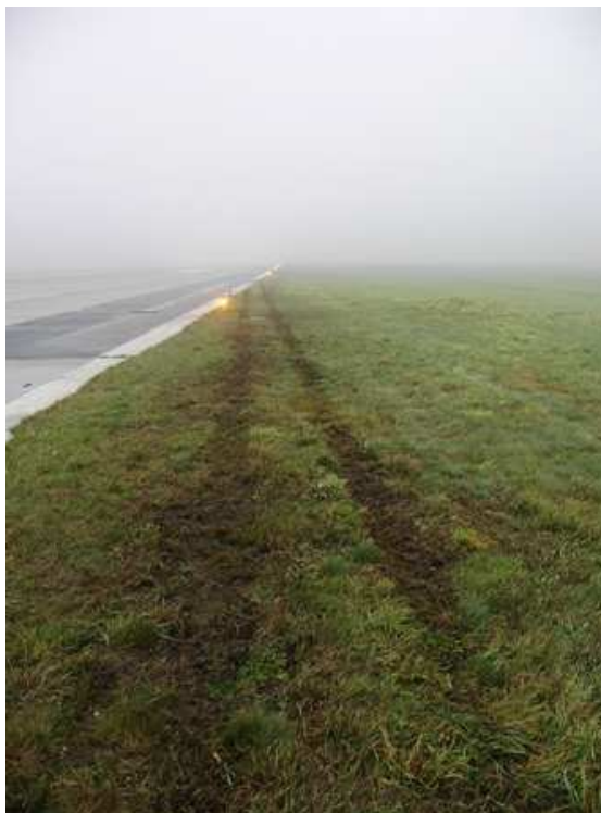
7. Ślady lewego podwozia głównego – zjazd samolotu z drogi startowej (kierunek wykonania zdjęcia – przeciwny do kierunku dobiegu).
