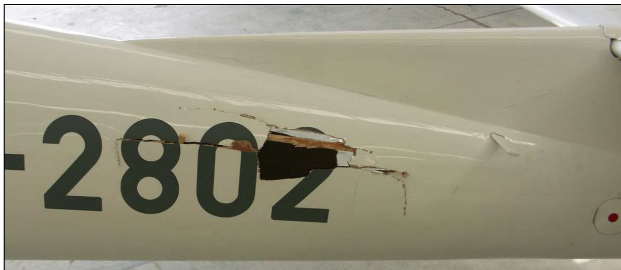
42 – Lewa strona tylnej części kadłuba, uszkodzenia od przebicia usterzeniem poziomym szybowca SP-1801.
