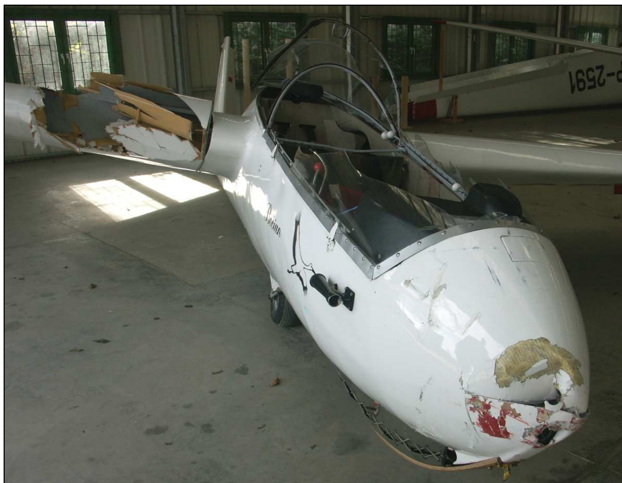
44 – Szybowiec SP-2802, zbliżenie od przodu. Widoczne uszkodzenia noska skrzydła, noska kadłuba i zniszczenie oszklenia kabiny.
