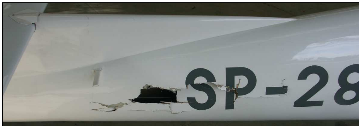
43 – Prawa strona tylnej części kadłuba, uszkodzenia od przebicia usterzeniem poziomym szybowca SP-1801.
