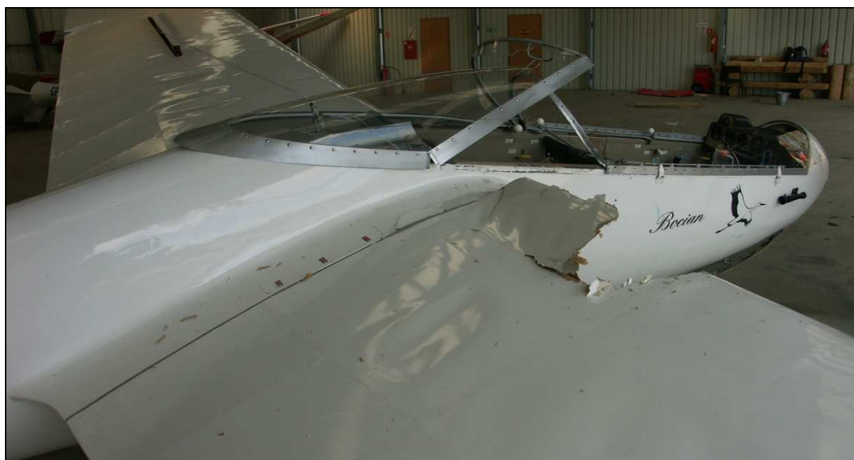
58 – Zbliżenie na przednią część kadłuba \frac{3}{4} z prawej od tyłu. Widoczne uszkodzenie noska skrzydła i zniszczone oszklenie kabiny.
