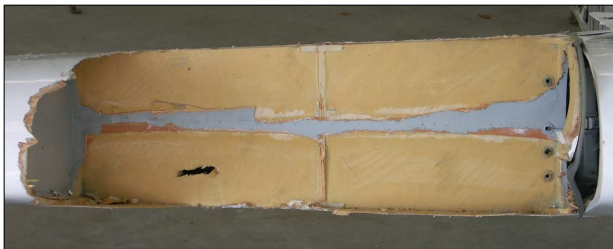
41 – Pierwszy od nasady segment noska prawego skrzydła szybowca SP-2802 zniszczony wskutek kolizji z ramą wrót hangaru, szczątki konstrukcji skrzydła usunięte.
