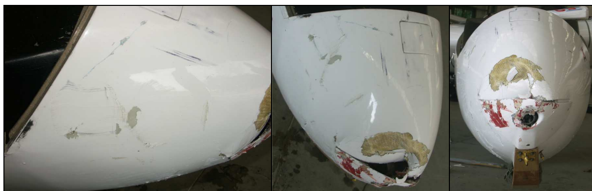
45, 46, 47 – Uszkodzenia noska kadłuba w zbliżeniach.
