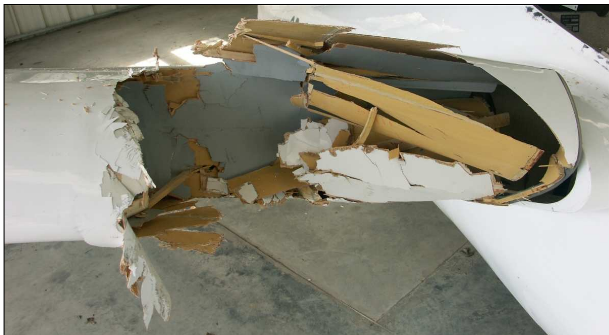
40 – Pierwszy od nasady segment noska prawego skrzydła szybowca SP-2802 zniszczony wskutek kolizji z ramą wrót hangaru.
