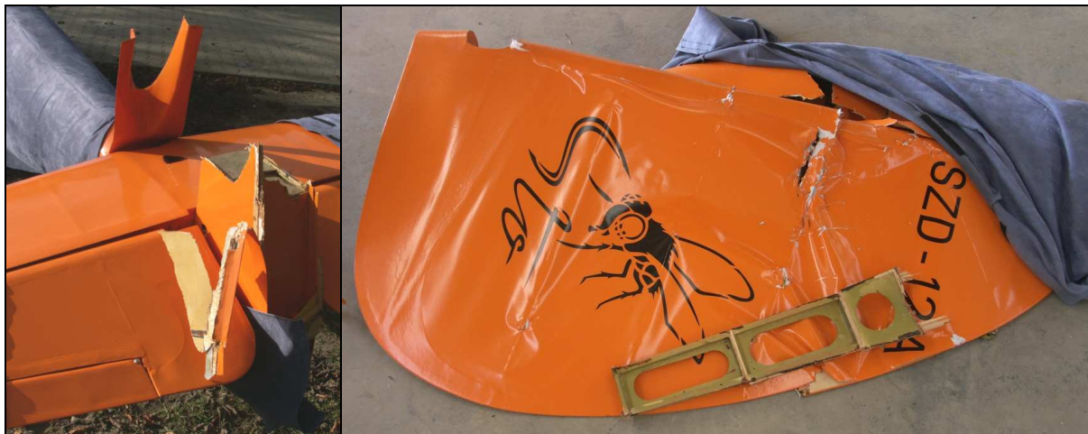
66, 67 – Tył kadłuba szybowca SP-1801 z oderwanym usterzeniem pionowym i jego oderwane usterzenie pionowe.
