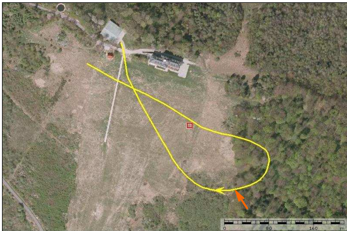
23 – Ortofotomapa otoczenia AOSSPRz w Bezmiechowej z naniesioną orientacyjnie wg opisu jednego ze świadków trasą końcowego fragmentu lotu szybowca SP-2802. Kwadratem zaznaczono wskazane przez pilotującego miejsce pierwszego przyziemienia podczas dołotu . Strzałką orientacyjnie wskazane miejsce, w którym znajdował się szybowiec na pierwszym z sekwencji zdjęć 7-22, tj. na zdjęciu 7. [ www.geoportal.gov.pl ].
