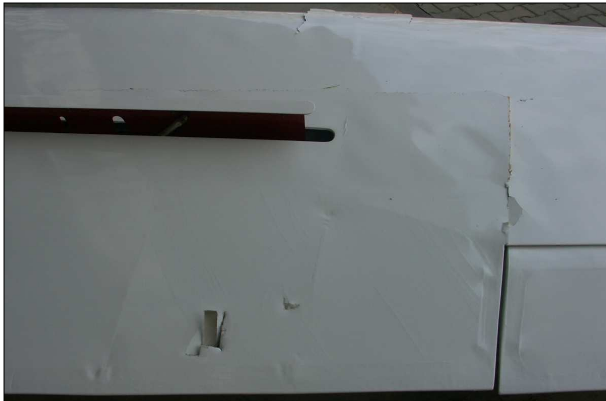
38 – Uszkodzenia skrzydła szybowca SP-2802 powstałe w wyniku kolizji z usterzeniem szybowca SP-1801, widok z tyłu i od góry.
