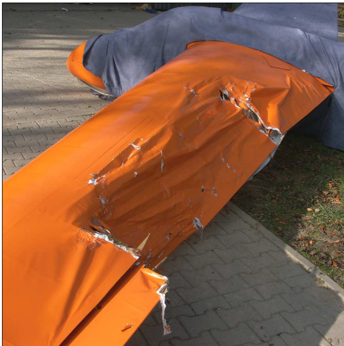
65 – Zniszczony spływ lewego skrzydła i uszkodzona lotka szybowca SP-1801.
