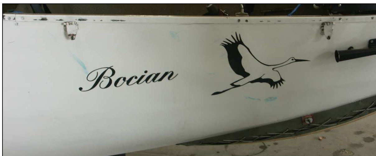
59 – Prawa burta kabiny – widoczne niebieskie ślady kontaktu z metalowym regałem stojącym obok wejścia.
