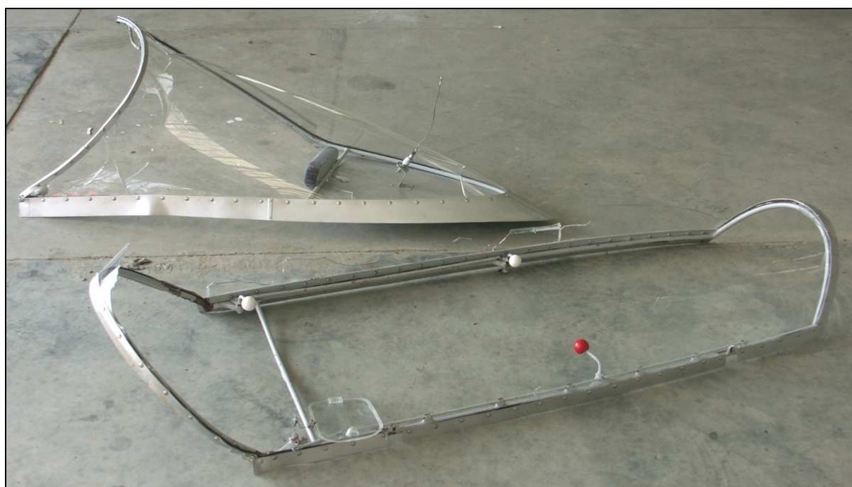
61 – Zniszczone ramy oszklenia kabiny. Na pierwszym planie osłona przednia.
