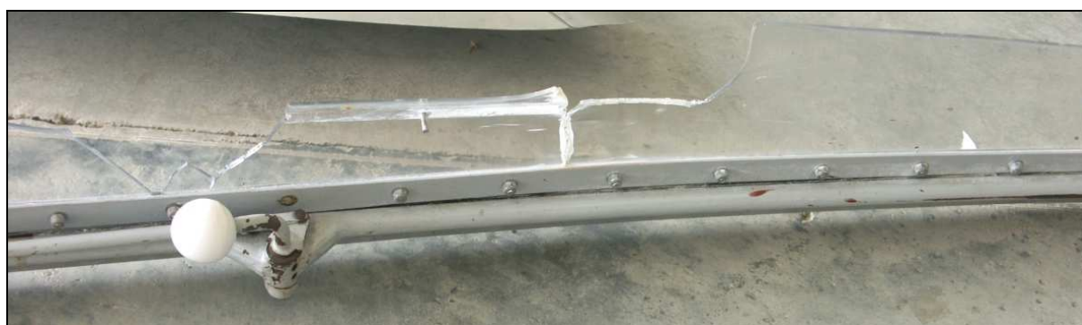
62 – Zbliżenie na uchwyt otwierania przedniej osłony kabiny od strony wewnętrznej.
