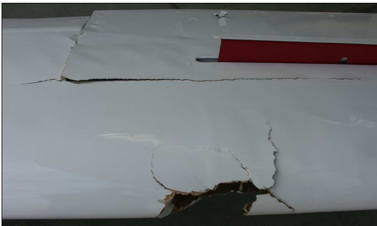
37 – Uszkodzenia skrzydła szybowca SP-2802 powstałe w wyniku kolizji z usterzeniem szybowca SP-1801, widok z przodu i od góry.
