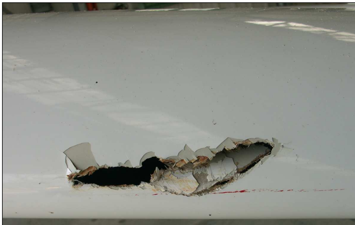
39 – Uszkodzenie-przebicie noska prawego skrzydła szybowca SP-2802.
