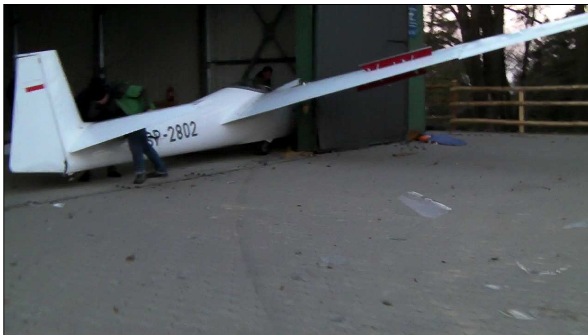
33 – Kilkanaście sekund po wypadku – szybowiec SP-2802 wbity noskiem prawego skrzydła u nasady w obramowanie otwartych wrót hangaru. Widoczny skręcający w prawo ślad jego koła, szczątki oszklenia kabiny oraz oderwane usterzenie pionowe szybowca SP-1801 (w pokrowcu) odrzucone pod narożnik hangaru [fot. T.Litewka].
