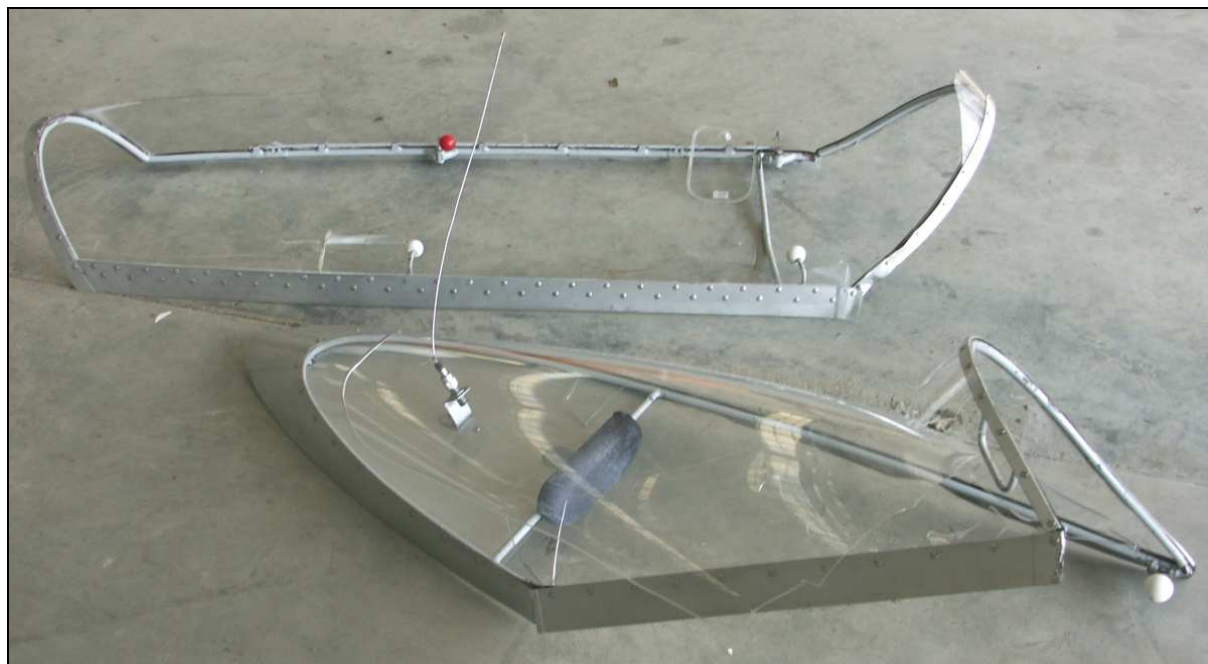
60 – Zniszczone ramy oszklenia kabiny. Na pierwszym planie osłona tylna.
