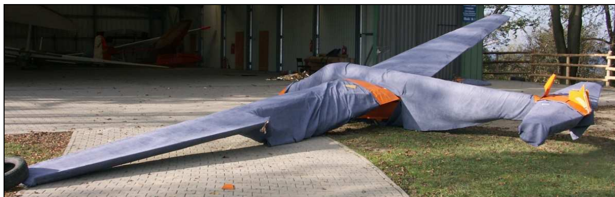
64 – Uszkodzony szybowiec SZD-12A Mucha Sto SP-1801 na miejscu wypadku (przemieszczony).
