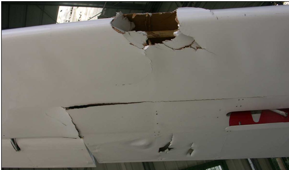
36 – Uszkodzenia skrzydła szybowca SP-2802 powstałe w wyniku kolizji z usterzeniem szybowca SP-1801, widok z przodu i od spodu.
