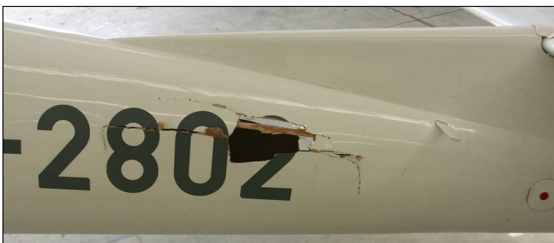
Szybowiec SP-2802 - widoczne uszkodzenia tylnej części kadłuba, spowodowane jej przebicciem w wyniku kolizji z usterzeniem poziomym szybowca Mucha 100.
