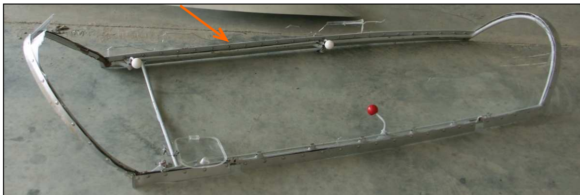
Rama przedniej osłony kabiny z resztkami oszklenia; strzałką zaznaczone najbardziej prawdopodobne miejsce uderzenia głową, a ściślej żuchwą przez pilota.
