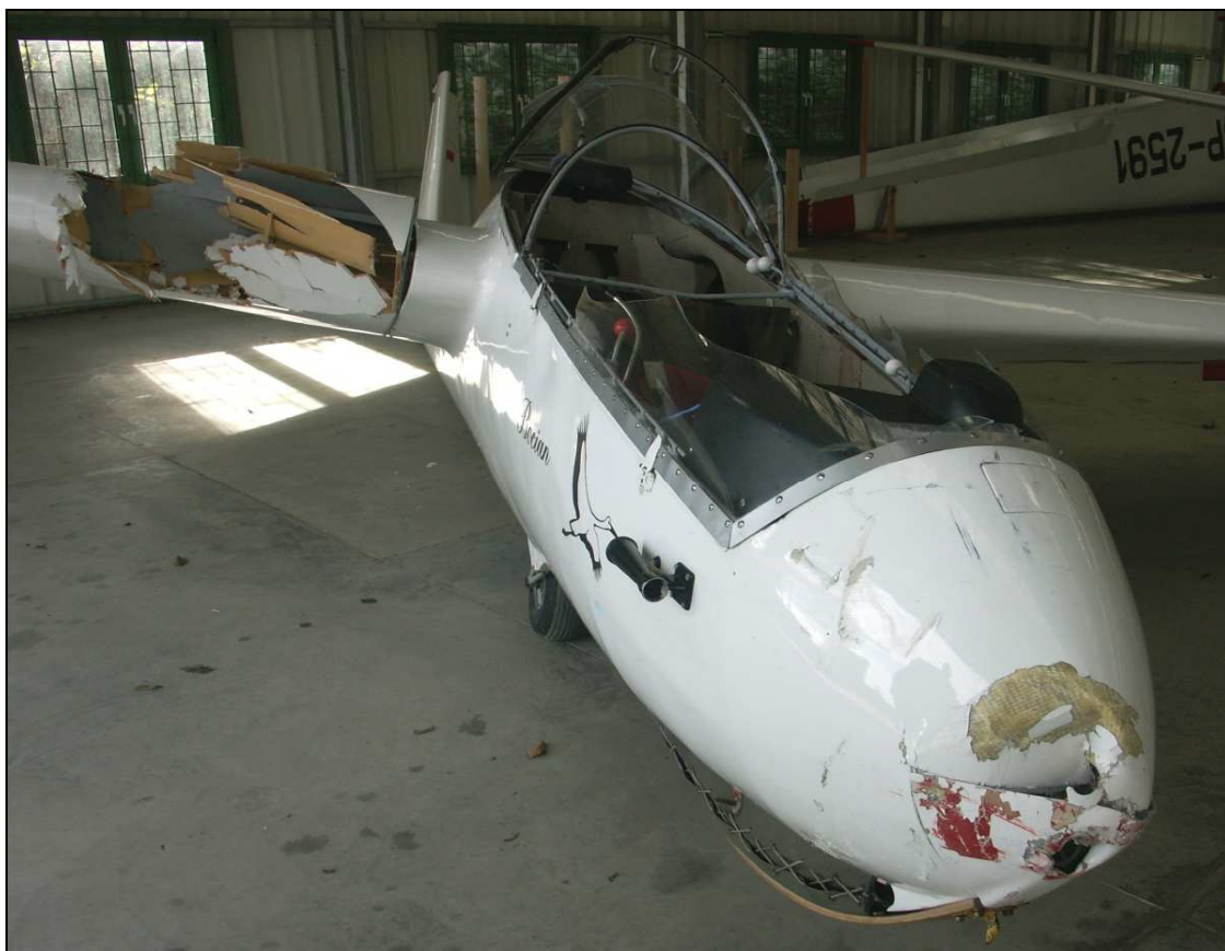
Szybowiec SP-2802, zbliżenie od przodu. Widoczne zniszczenie noska prawego skrzydła u nasady, uszkodzenie noska kadłuba i zniszczenie oszklenia kabiny.
