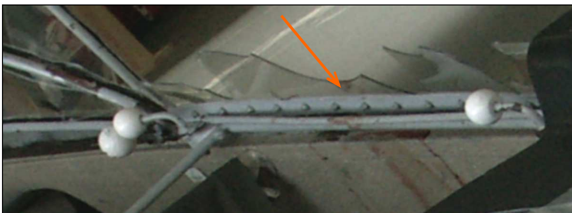
Ślady krwi na dolnej rurze ramy przedniej osłony kabiny i lewej burcie wnętrza kabiny w widoku \frac{3}{4} od przodu. Zwracają uwagę ostre resztki oszklenia. Strzałką zaznaczone najbardziej prawdopodobne miejsce uderzenia głową, a ściślej żuchwą przez pilota.
