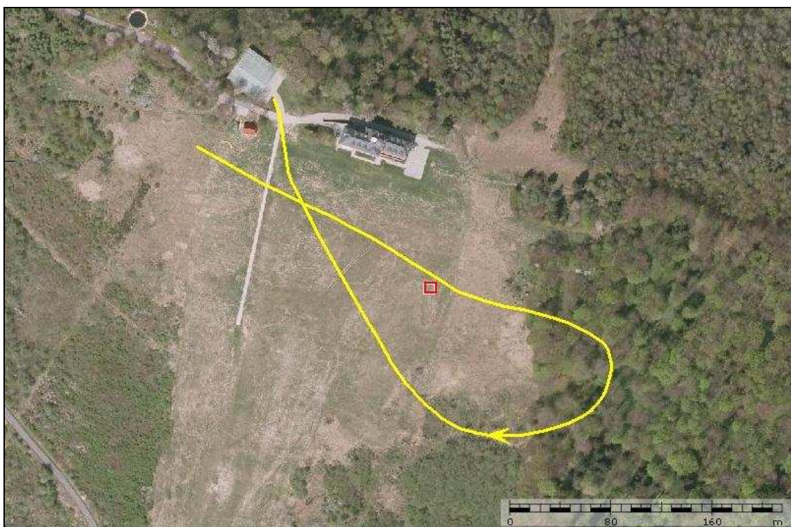
Ortofotomapa otoczenia AOSSPRz w Bezmiechowej z naniesioną orientacyjnie wg opisu jednego ze świadków trasą końcowego fragmentu lotu szybowca SP-2802. Kwadratem zaznaczono wskazane przez pilotującego miejsce pierwszego przyziemienia podczas dolotu . Patrz Album Ilustracji oraz Analiza Raportu. [www.geoportal.gov.pl].
