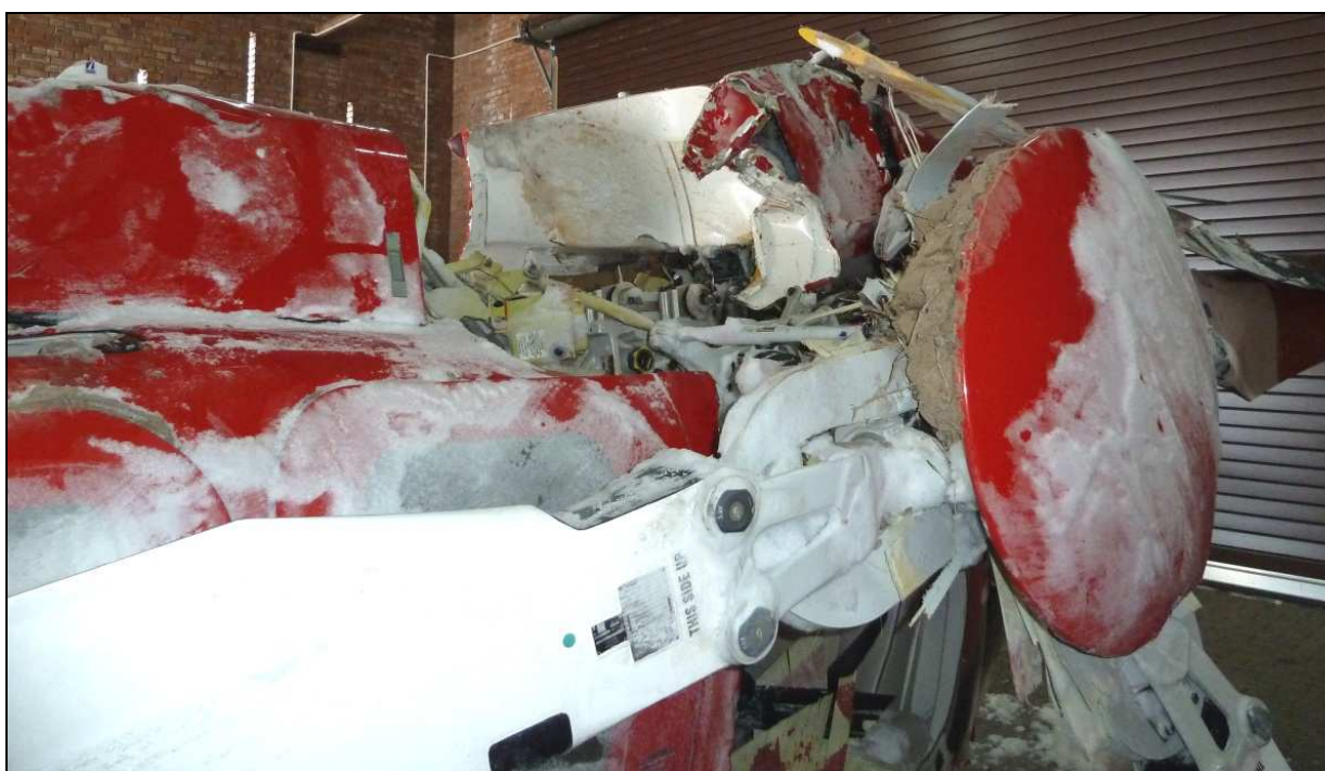
29 - Wyłamana z zamocowań przekładnia wirnika głównego – zbliżenie \frac{3}{4} od przodu z lewej .
