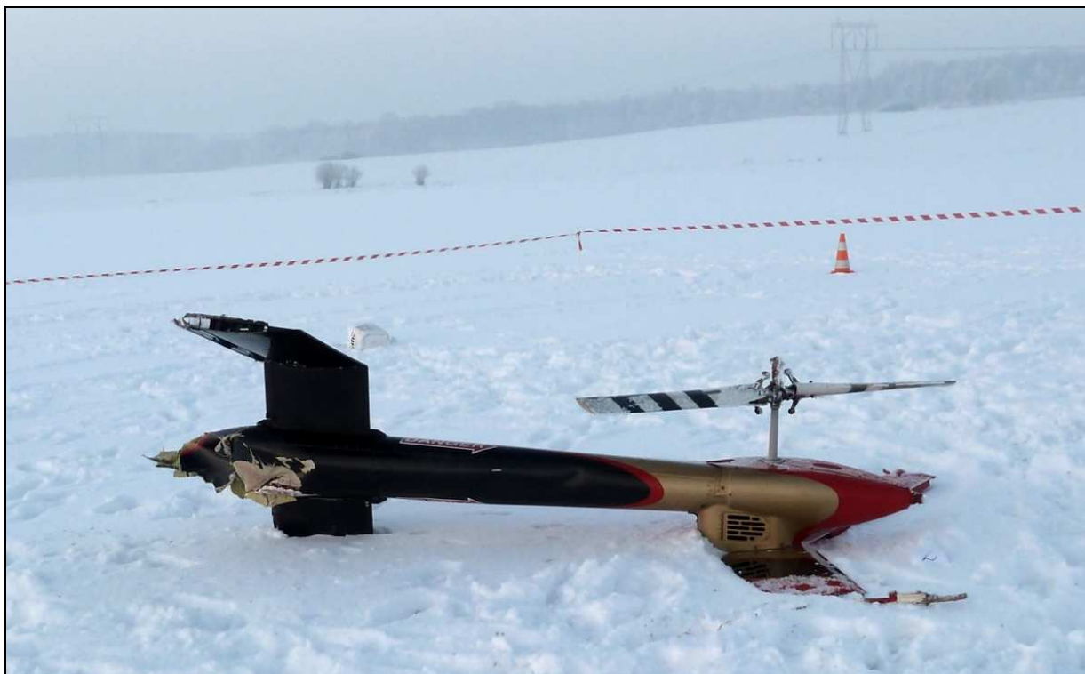
21 – Odtamana część belki ogonowej z usterzeniem i wirnikiem ogonowym – zbliżenie.
