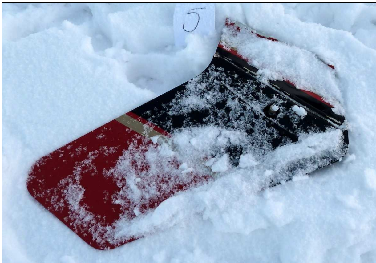
24 – Fragment odłamanego usterzenia - zbliżenie.
