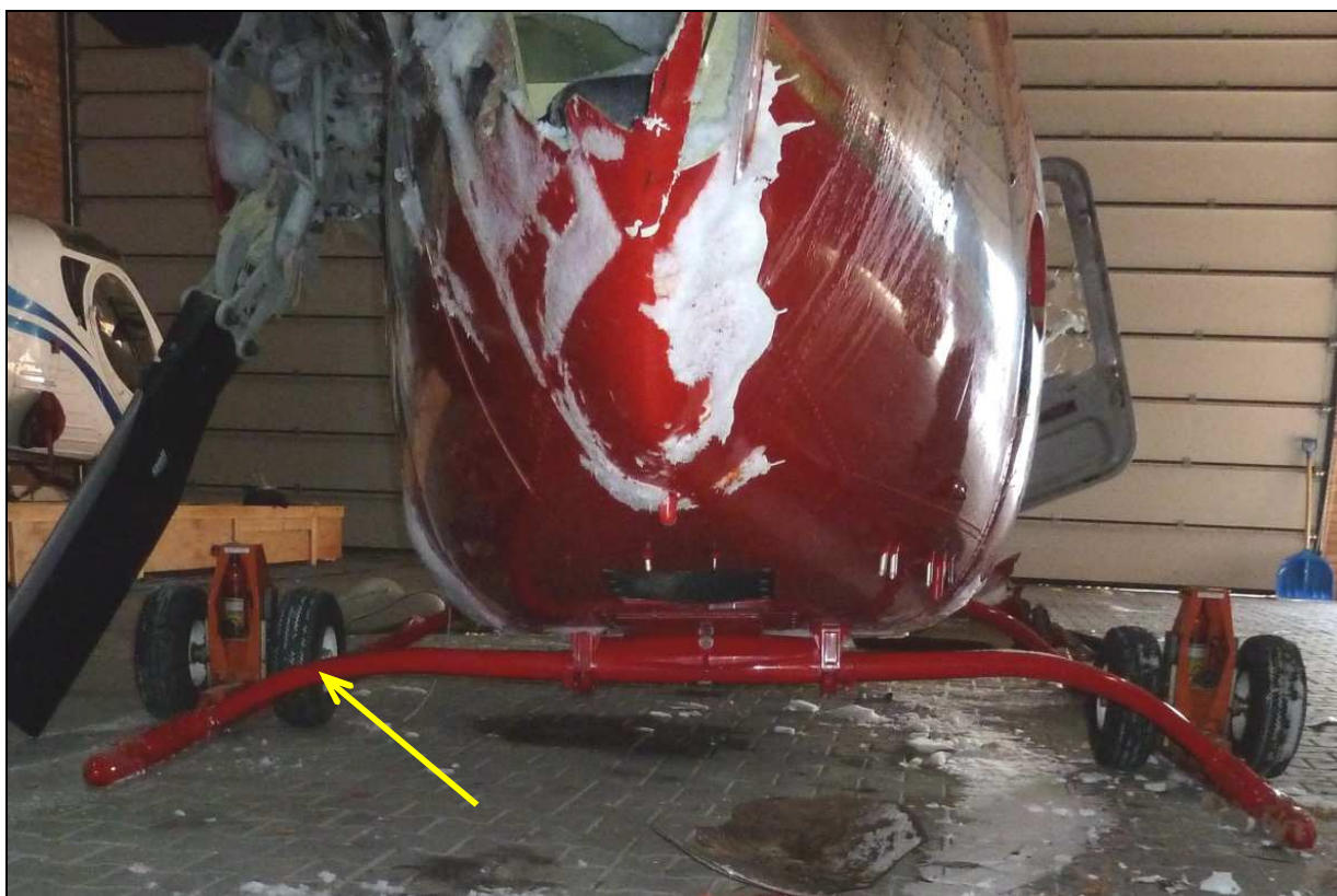
33 – Widok kadłuba śmigłowca od tyłu – zwraca uwagę wyraźne odkształcenie lewego tylnego wspornika płóz podwozia.
