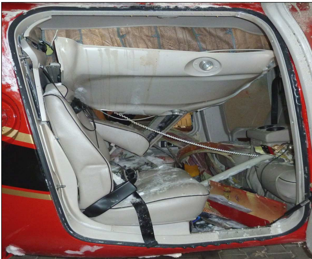
32 – Wnętrze kabiny pasażerskiej – widoczne znaczne wgniecenie sufitu przez zerwaną z zamocowań przekładnię główną.
