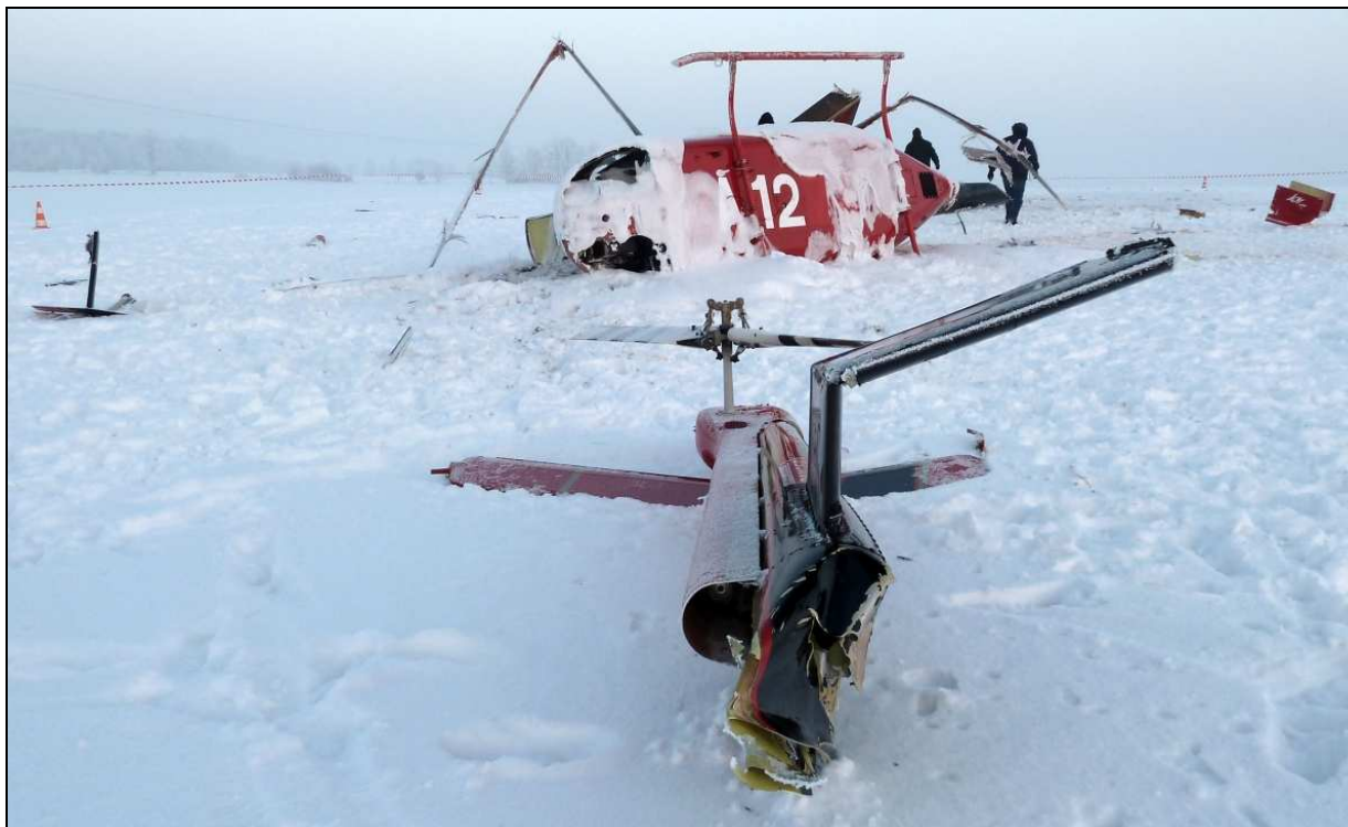
20 – Odtłamana część belki ogonowej z usterzeniem i wirnikiem ogonowym – zbliżenie na tle rozbitego śmigłowca.
