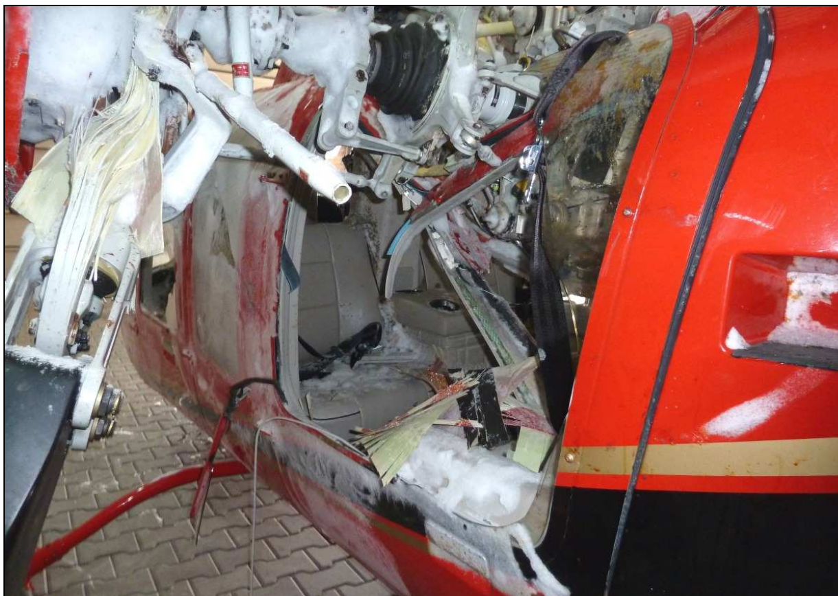
30 - Wytamana z zamocowań przekładnia wirnika głównego – zbliżenie ¾ od tytu z lewej. Przekładnia znalazła się wewnątrz kabiny śmigłowca.
