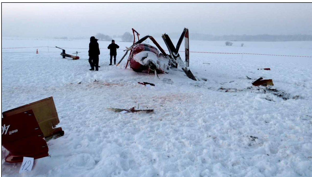
15 – Rozbity śmigłowiec i jego szczątki – na pierwszym planie elementy osłon silnika i odłamki łopat wirnika głównego; na dalszym planie po lewej stronie kadru odłamany koniec belki ogonowej z usterzeniem i wirnikiem ogonowym. Na śniegu widoczne plamy oleju.
