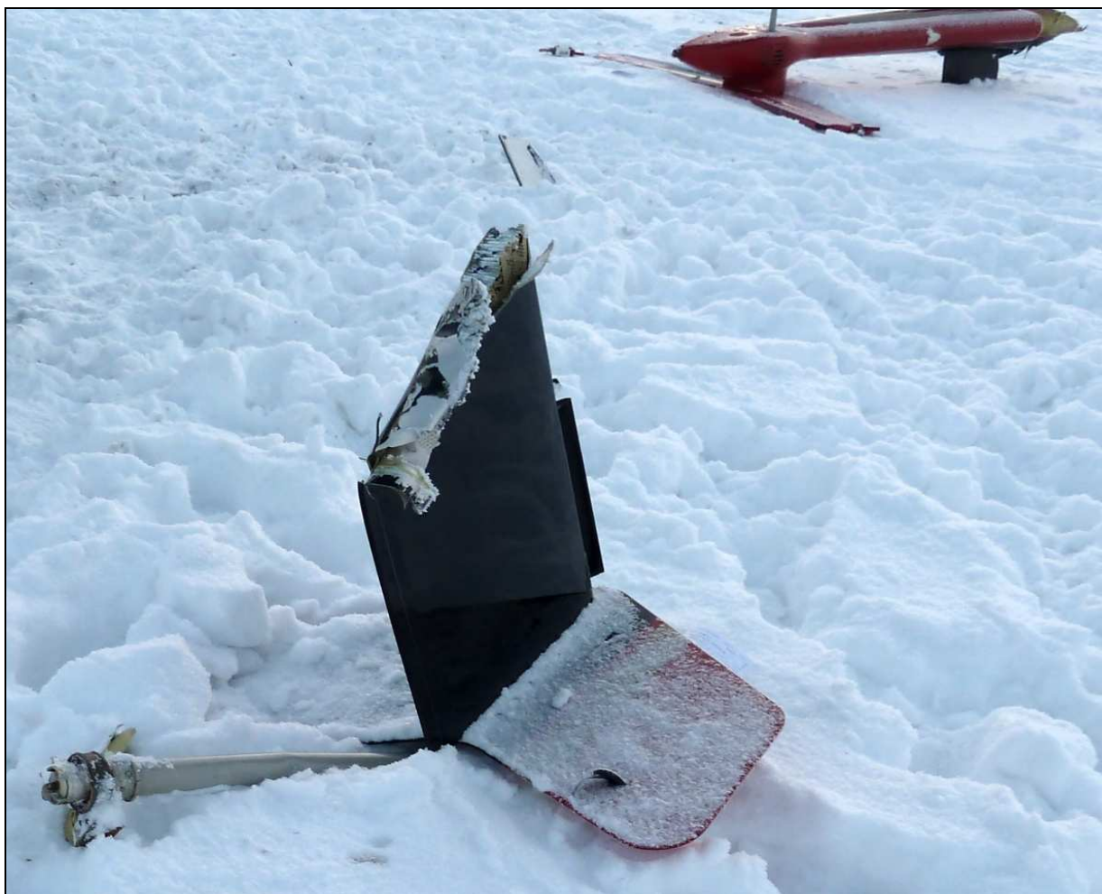
23 – Fragment odłamanego usterzenia i odcinek wału napędowego wirnika ogonowego - zbliżenie.
