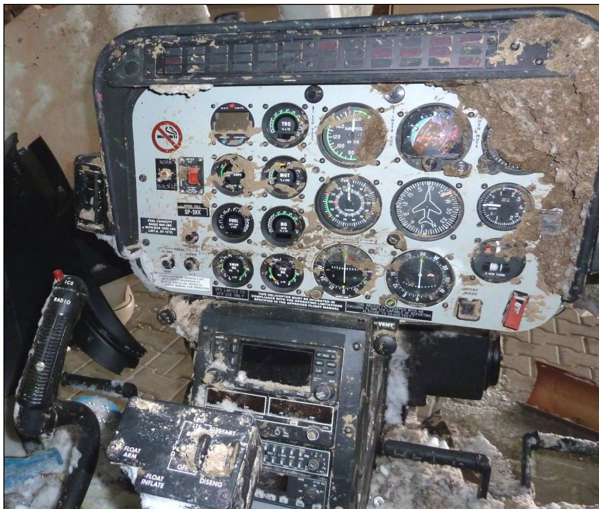
39 – Tablica przyrządów i pulpity centralny. Widoczny drążek sterowy lewego fotela i sterownice nożne.
