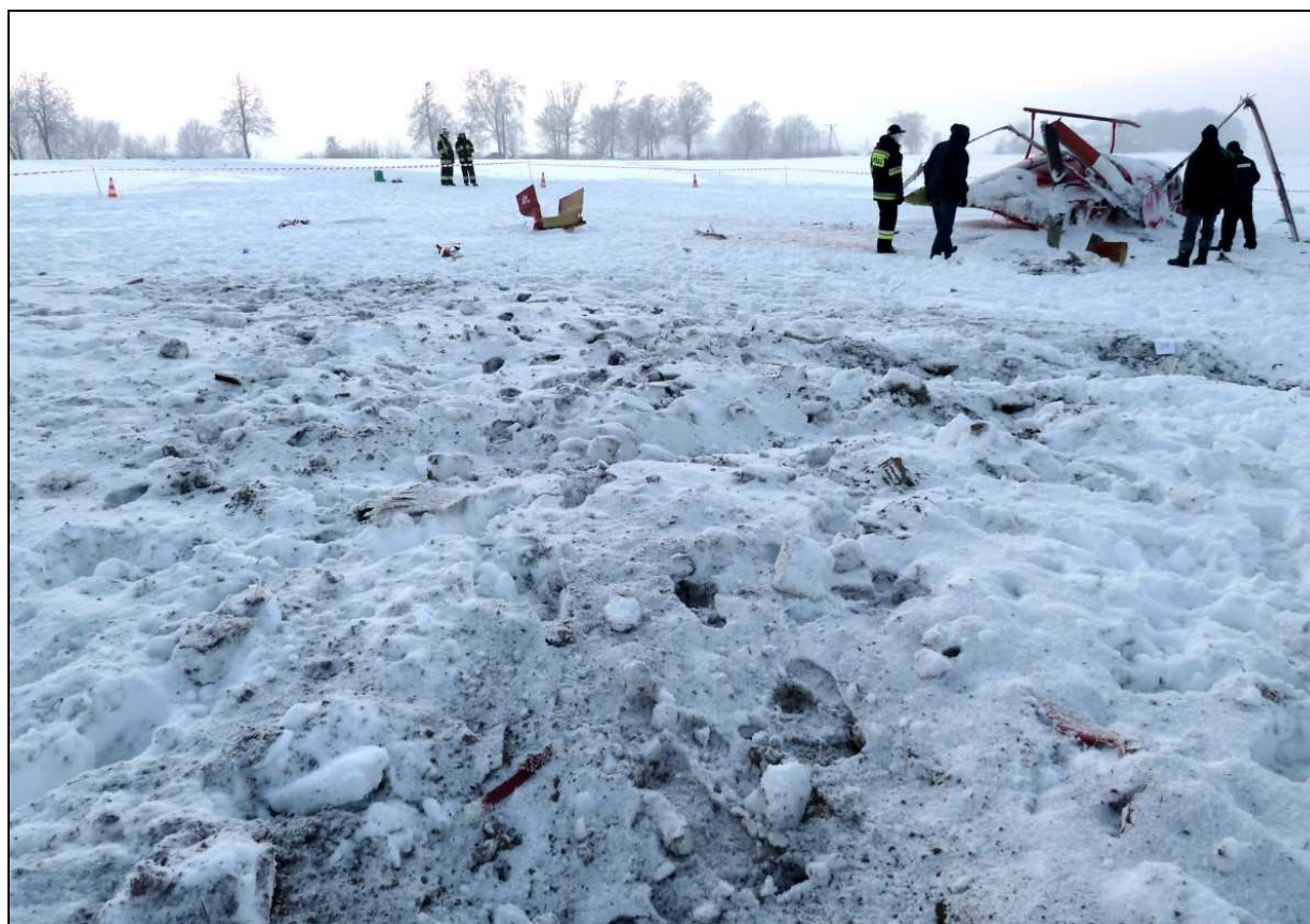
12 – Ślad odbicia kadłuba, na śniegu widoczne drobne odłamki łopaty wirnika głównego.
