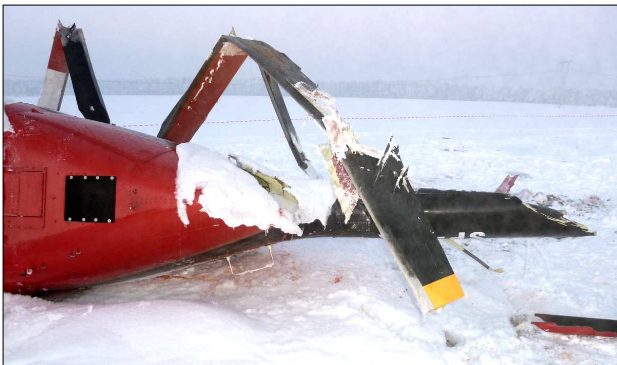
18 – Zbliżenie przełomu belki ogonowej i zniszczonej jednej z łopat wirnika głównego.
