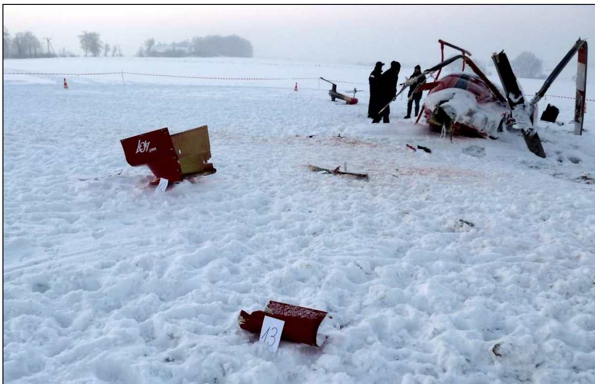
14 – Rozbity śmigłowiec i jego szczątki – na pierwszym planie elementy osłon silnika i odłamki łopaty wirnika głównego; na dalszym planie odłamany koniec belki ogonowej z usterzeniem i wirnikiem ogonowym. Na śniegu widoczne plamy oleju.
