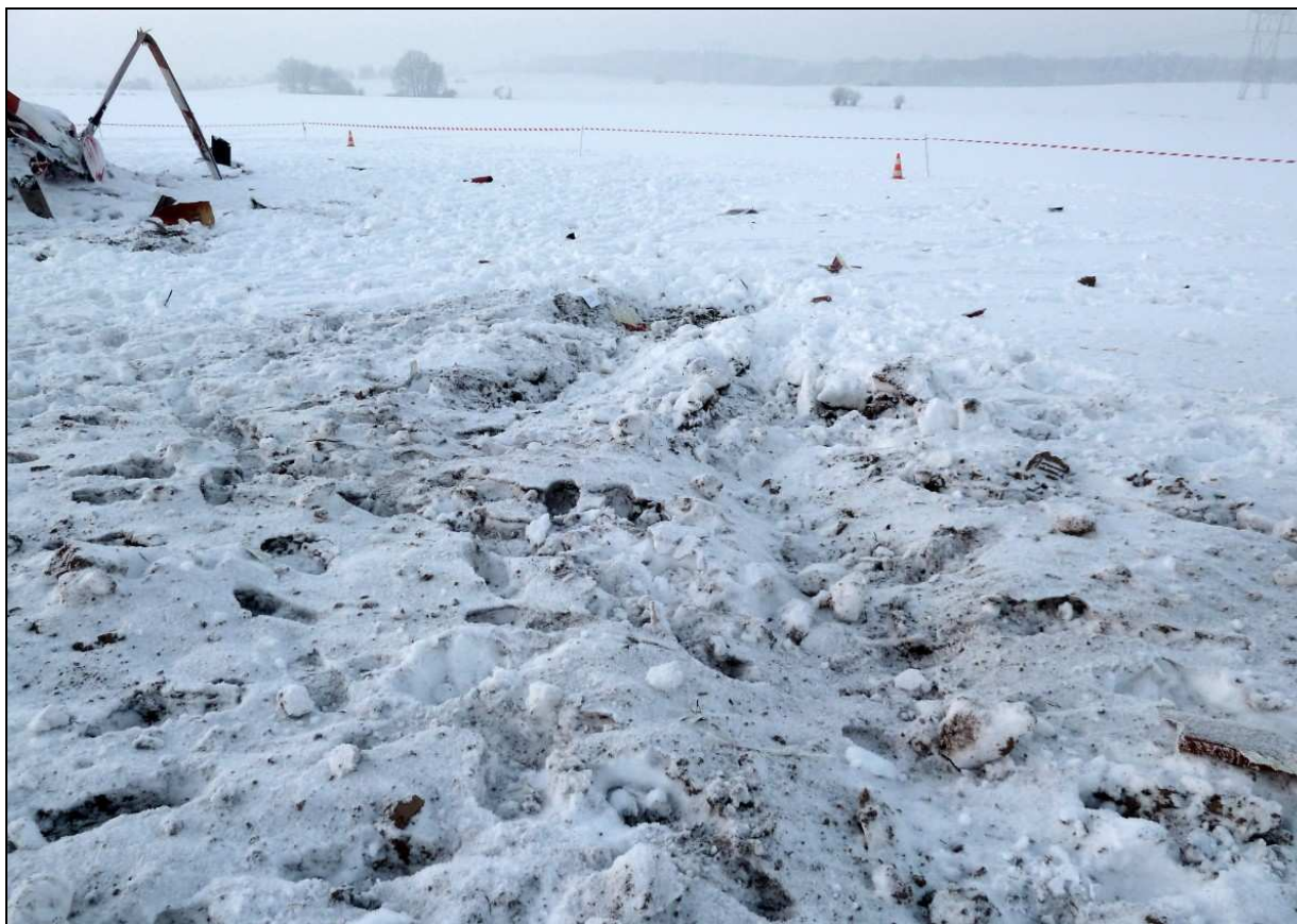
13 – Ślad kontaktu wirnika głównego z nawierzchnią, na śniegu widoczne drobne odłamki łopaty wirnika głównego.
