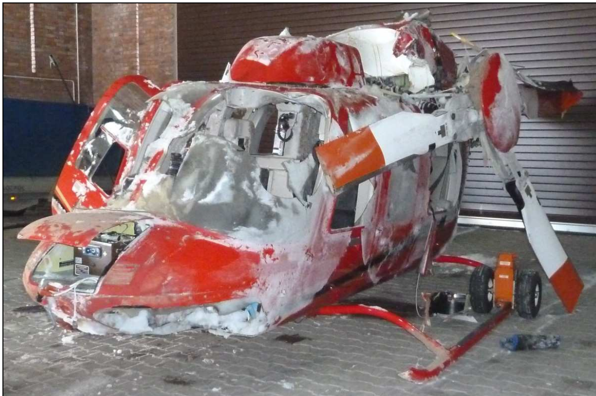
28 – Kadłub śmigłowca w hangarze, widok \frac{3}{4} od przodu z lewej strony. Zwraca uwagę wyłamana z zamocowań przekładnia wirnika głównego.
