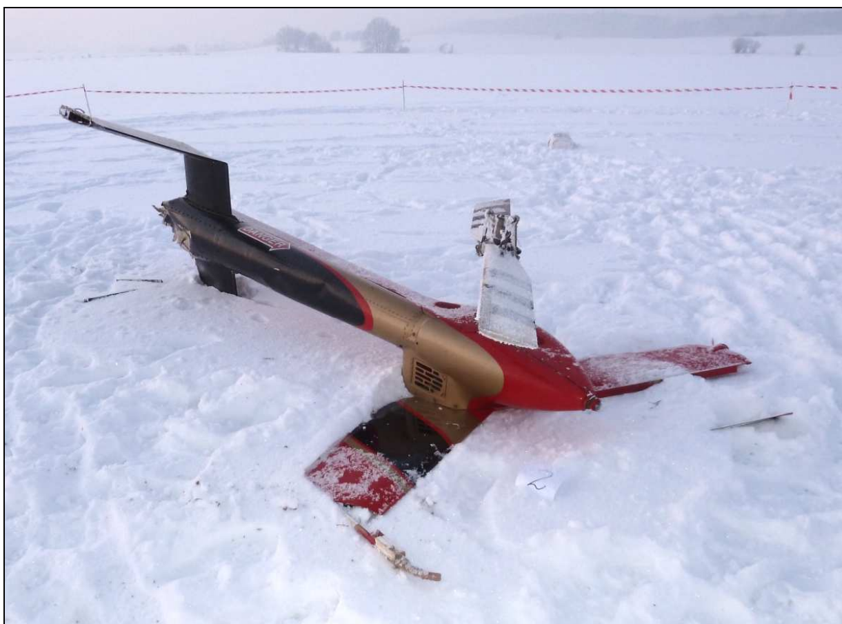
22 – Odtamana część belki ogonowej z usterzeniem i wirnikiem ogonowym – zbliżenie.
