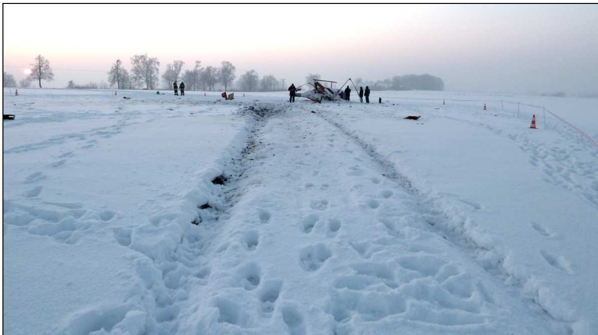
9 – Ślad płóz podwozia na miejscu wypadku, w tle zniszczony śmigłowiec.
