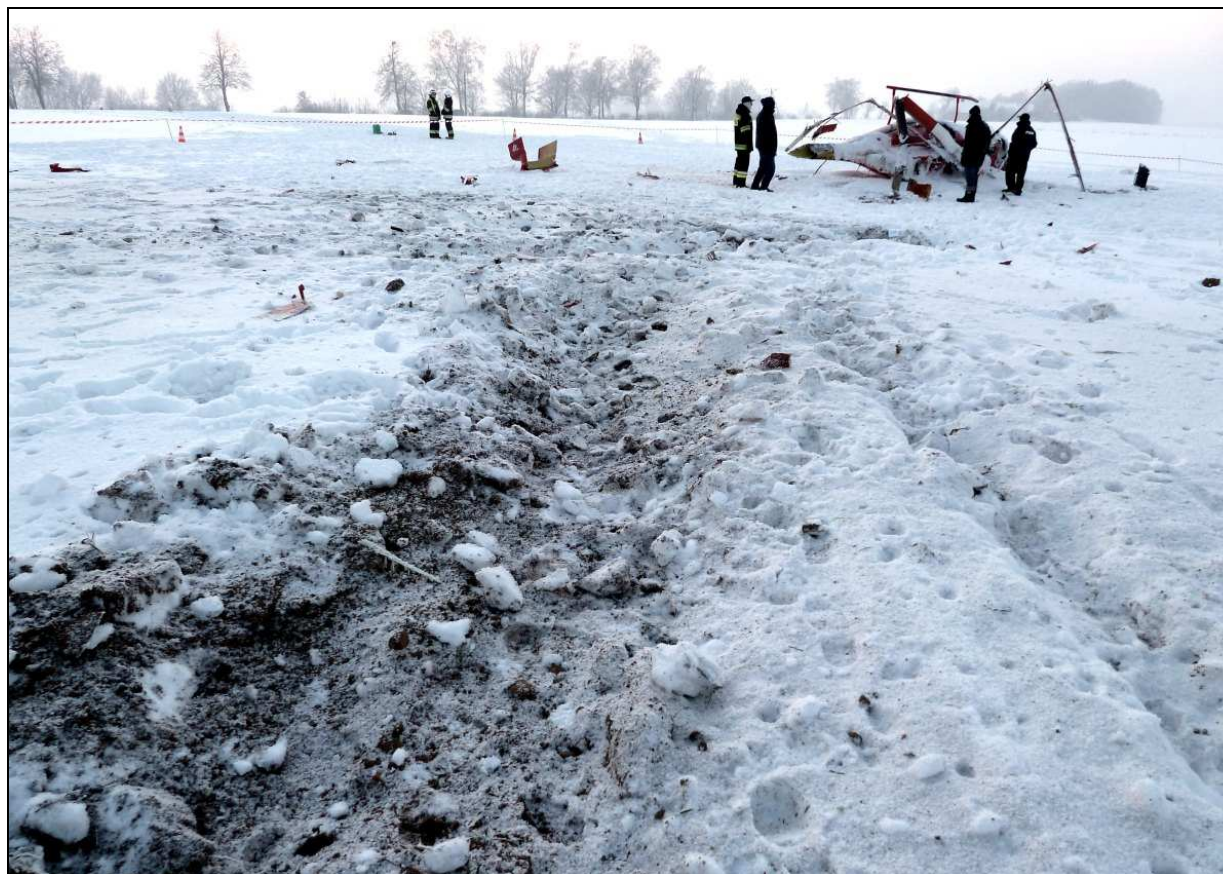
11 – Ślad silniejszego zarycia lewej płozy podwozia na miejscu wypadku, w tle ślad odbicia kadłuba i zniszczony śmigłowiec.
