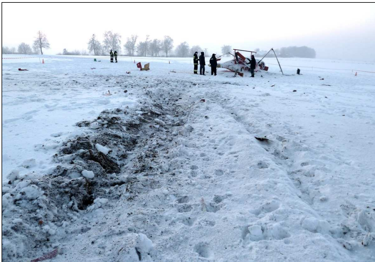
10 – Ślad płóz podwozia na miejscu wypadku i ślad silniejszego zarycia lewej płozy, w tle ślad odbicia i zniszczony śmigłowiec.
