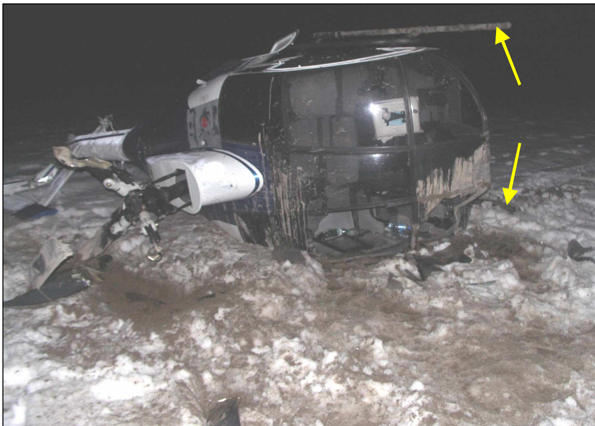
21 – Ogólny widok śmigłowca z przodu w zbliżeniu. Zwraca uwagę całkowite zanieczyszczenie błotem przednich części płóz podwozia wskutek zarycia nimi w glebie [fot.PKBWL].
