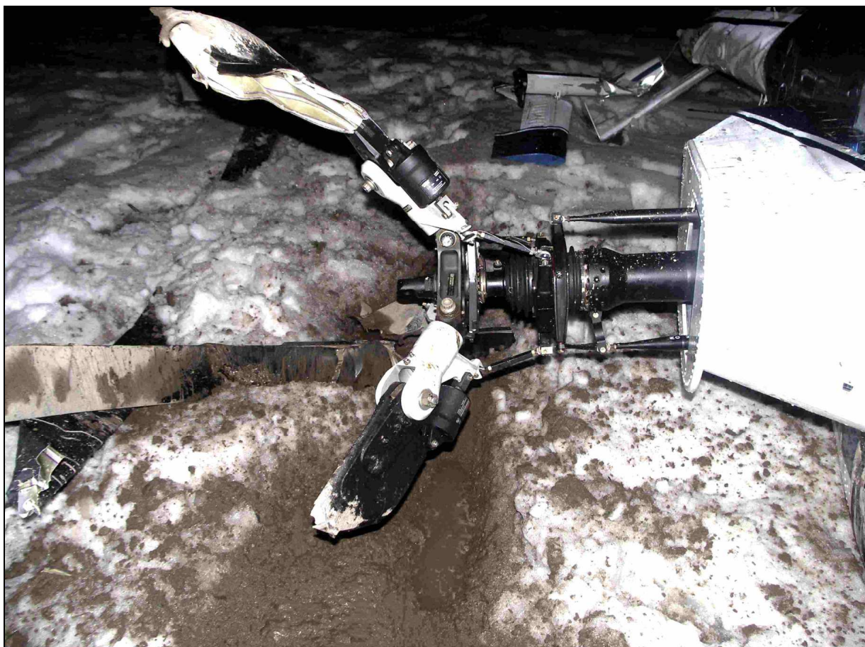
15 – Głowica wirnika głównego z resztkami łopat, widok od przodu [fot. PKBWL].
