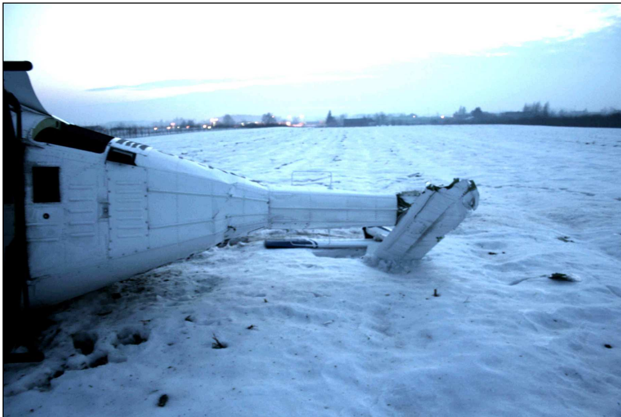
12 – Tylna część kadłuba śmigłowca od spodu. Widoczne złamanie belki ogonowej oraz zniszczenia pokrycia stożkowej części kadłuba [fot.KP Policji w Grójcu].
