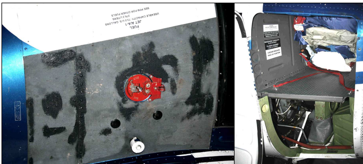
18 – Górne pokrycie zbiornika paliwa z wlewem. Brak śladu wycieków [fot.KP Policji w Grójcu]. 18 – Otwarty bagażnik [fot.KP Policji w Grójcu].
