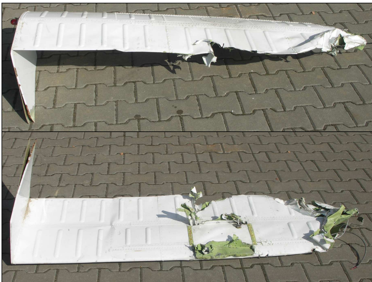
34 i 35 – Zniszczony statecznik poziomy od dołu i od góry [fot.PKBWL].
