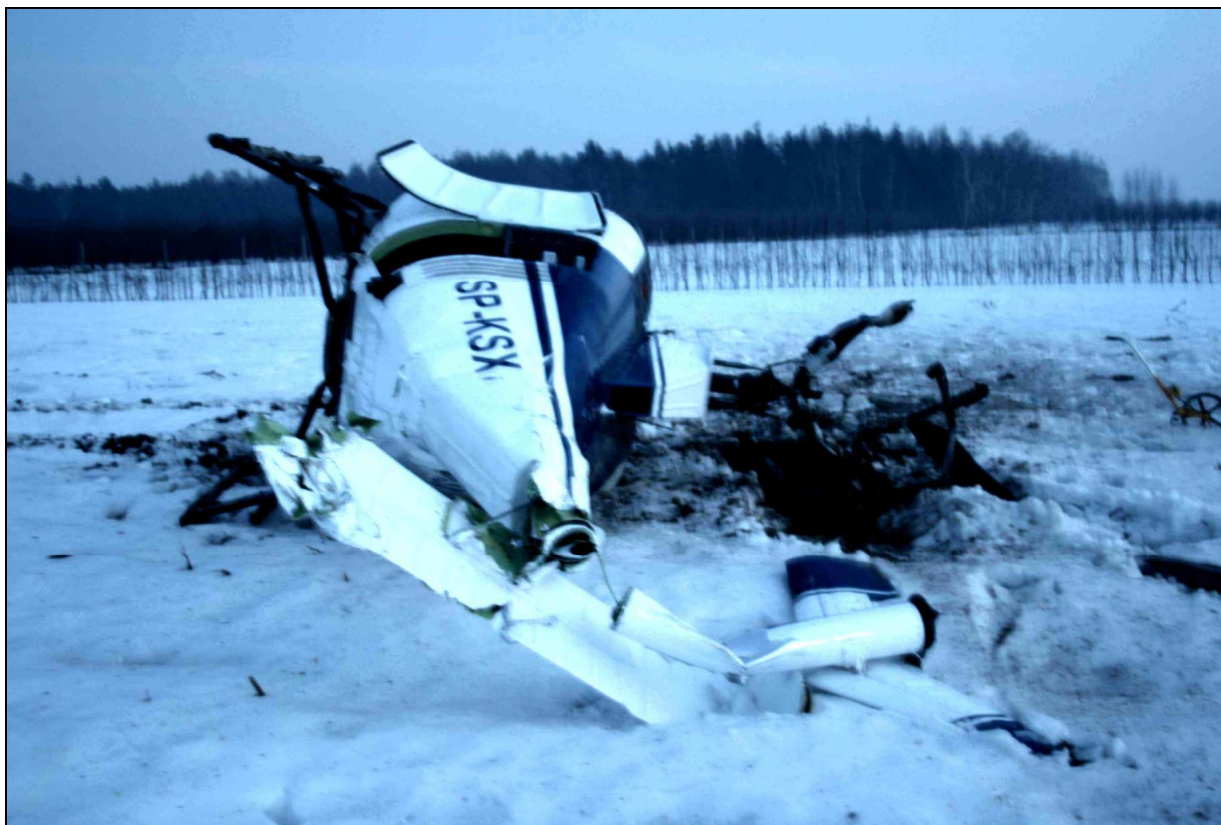
13 – Tylna część kadłuba śmigłowca od tyłu. Widoczne złamanie belki ogonowej, zniszczenie usterzenia i brak wirnika ogonowego [fot.KP Policji w Grójcu].
