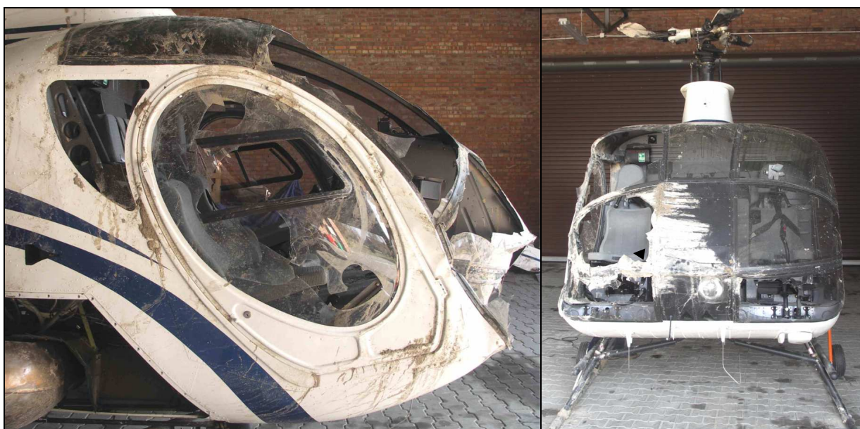
25 i 26 – Uszkodzenia przedniej części kadłuba i oszklenia kabiny [fot.PKBWL].
