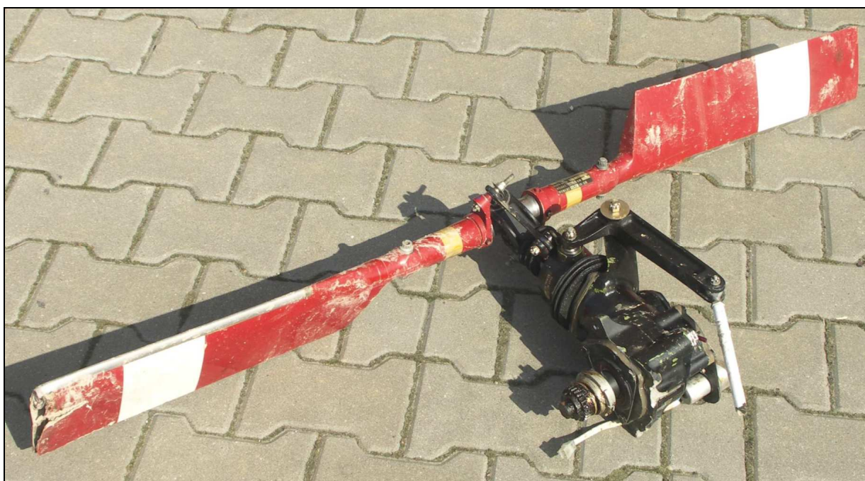
36 – Wirnik ogonowy, wraz z przekładnią kątową oderwany od belki ogonowej. Widoczne dźwignie sterowania skokiem łopaty i pozrywane popychacze sterowania [fot.PKBWL].
