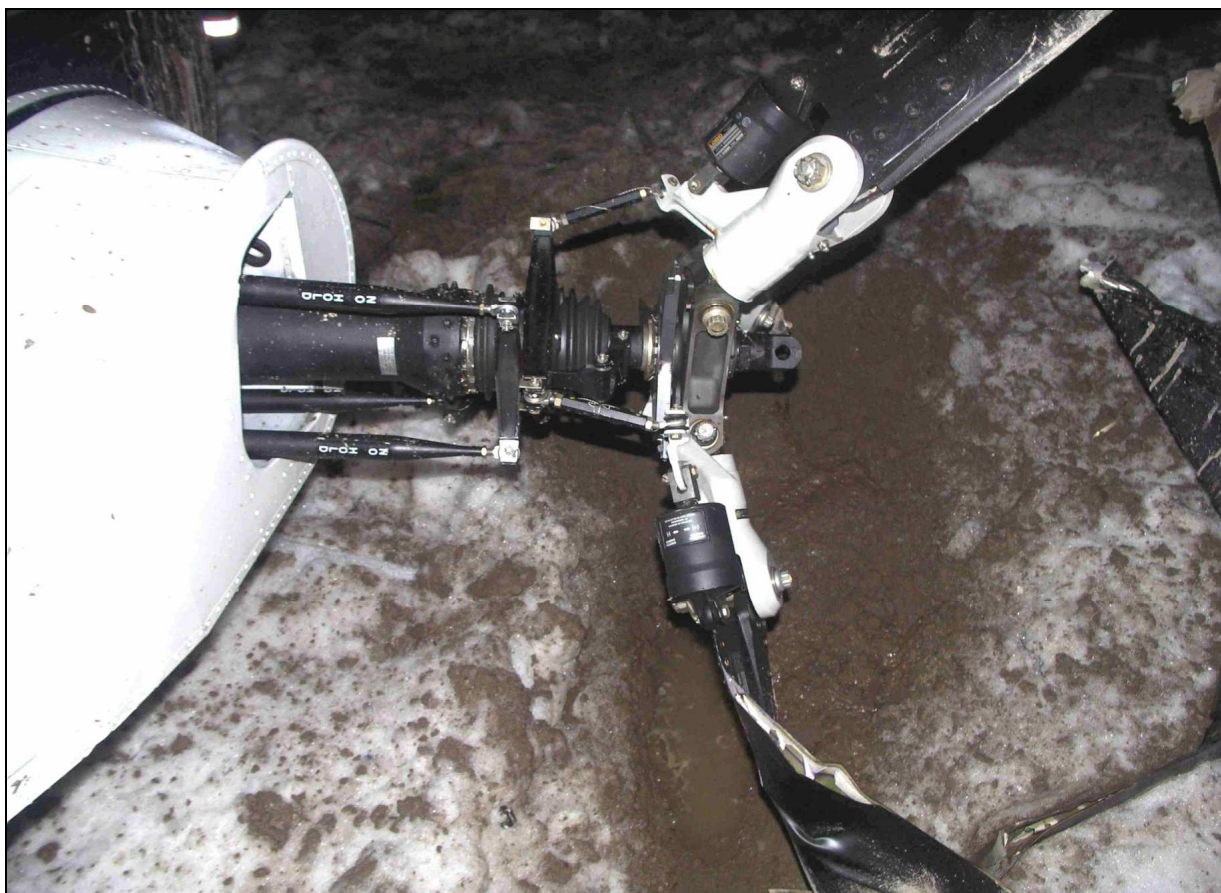
14 – Głowica wirnika głównego z resztkami łopat, widok od tyłu [fot. PKBWL].
