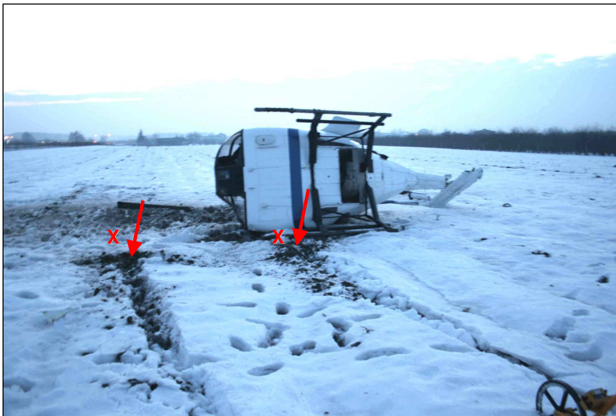
10 – Ogólny widok śmigłowca na miejscu wypadku. Widoczne ślady drugiego przyziemienia płóz i ślady zarycia nosków płóz (X↓) [fot.KP Policji w Grójcu].
