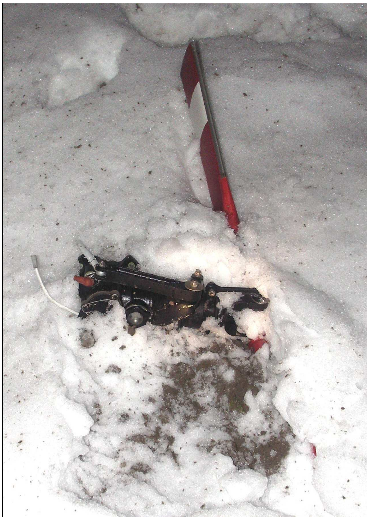
16 – Oderwany wirnik ogonowy z resztkami przekładni kątowej i układu sterowania [fot. PKBWL].
