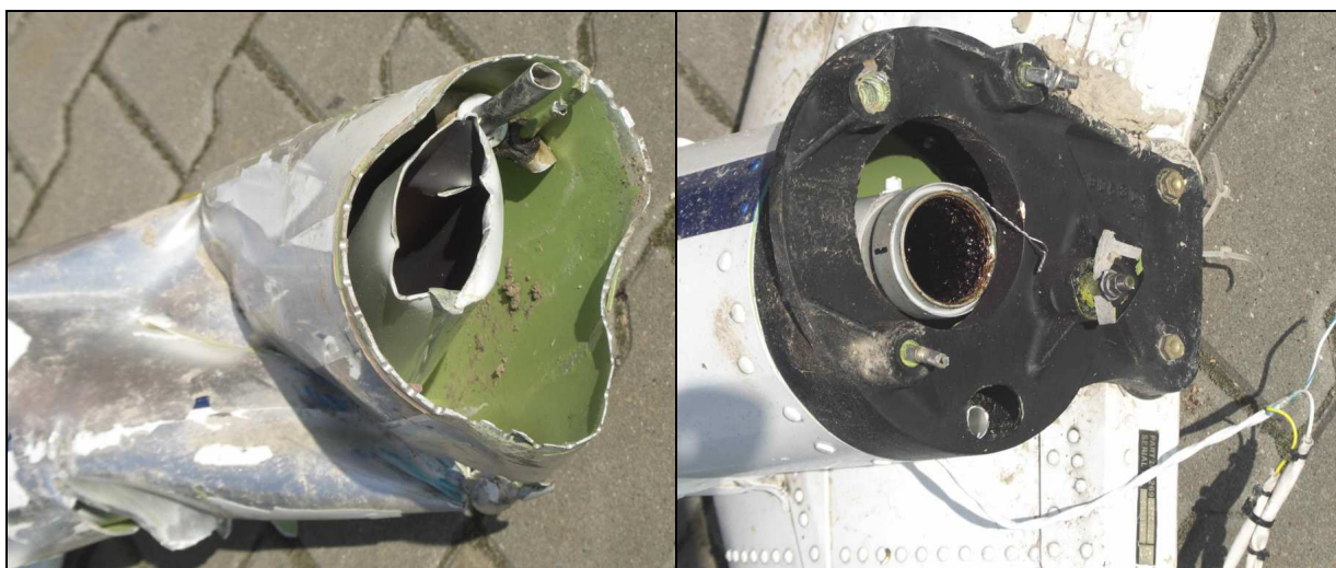
32 – Odłamany odcinek belki kadłubowej od strony kadłuba – widoczne rozdarcie pokrycia na szwie nitowym oraz przerwany wał wirnika ogonowego [fot.PKBWL].
