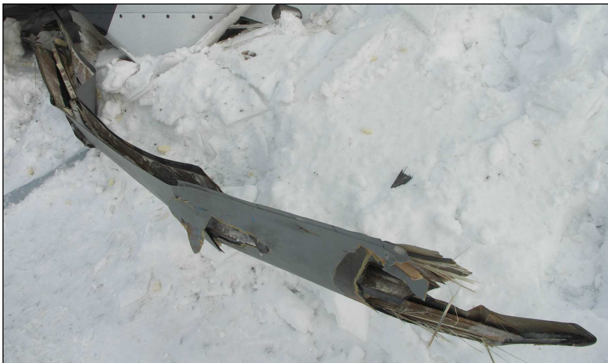
27 – Zniszczona „czerwona” łopata wirnika głównego.
