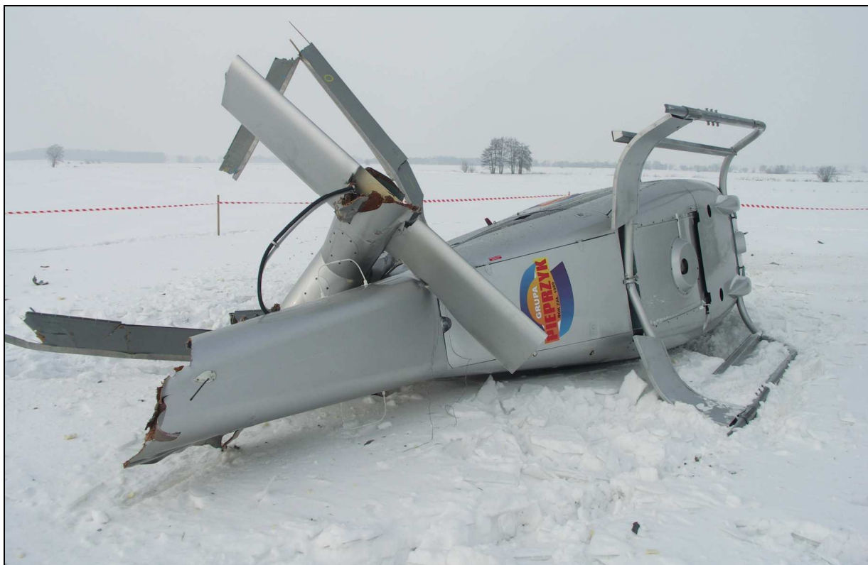
15 – Ogólny widok śmigłowca na miejscu wypadku. Obok lewej płozy (po prawej stronie) widoczny głębszy, pierwszy ślad przyziemienia.
