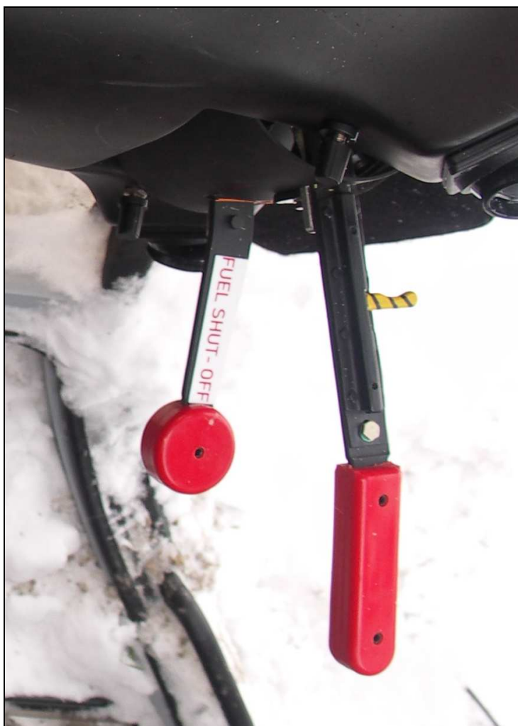
42 – Dźwignia zaworu odcinającego paliwo (po lewej) i dźwignia hamulca wirnika głównego – widok z prawej strony, tj. od strony pilota.
