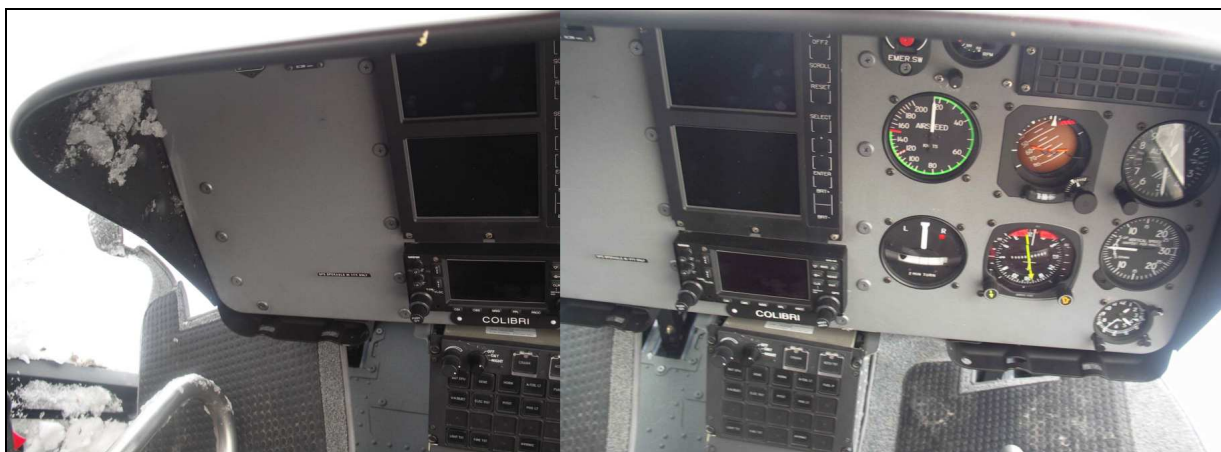
36 i 37 – Lewa i prawa strona tablicy przyrządów oraz pulpit centralny; pośrodku tablicy widoczne urządzenie VEMD (= Vehicle and Engine Multifunction Display - Wieloczynnościowy Wyświetlacz Płatuwa i Silnika) z dwoma monitorami.
