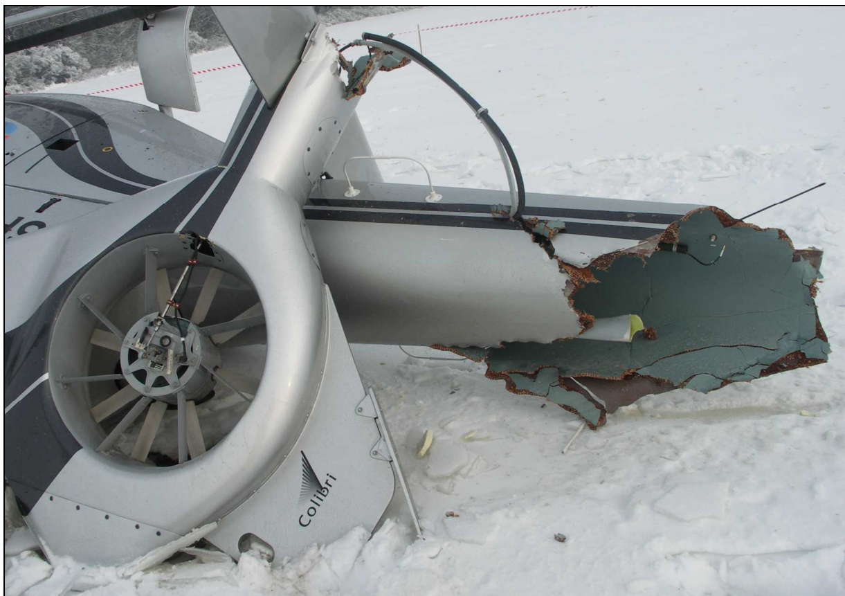
20 – Belka ogonowa zniszczona uderzeniem łopaty wirnika. Widoczny odłamany fenestron z usterzeniem poziomym.
