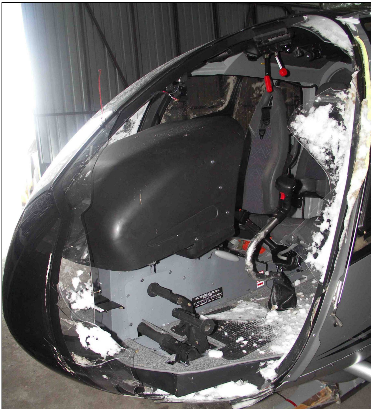
35 – Zbliżenie przedniej części kadłuba śmigłowca – widoczne zniszczone lewe oszklenie przednie, przez które wyszła pasażerka.
