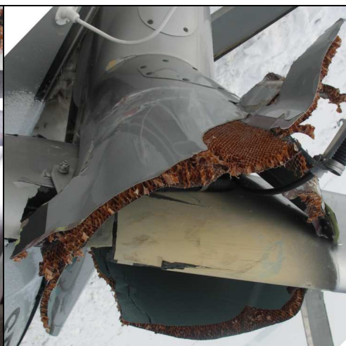
24 – Przełom belki ogonowej od strony fenestronu.
