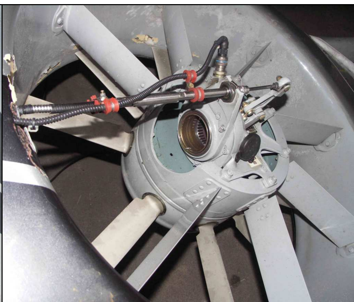
31 – Fenestron, widoczne uszkodzenia pokrycia tunelowania, cięgno sterowania i wielowypustowe sprzęgło wyrwanego wału napędowego.
