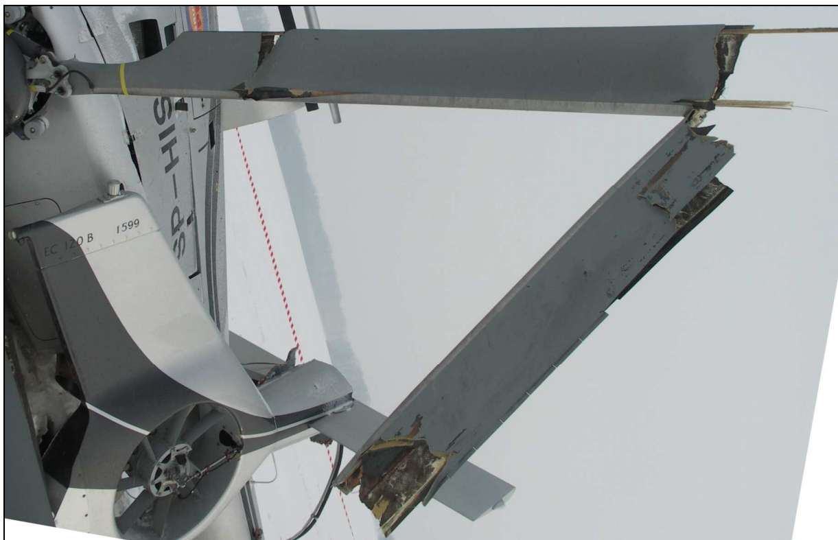
29 – Zniszczona „żółta” łopata wirnika głównego.
