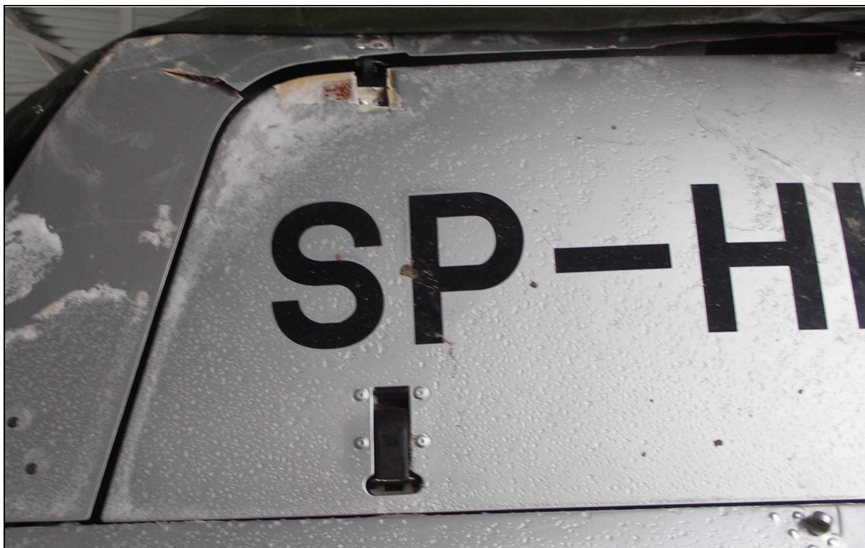
44 – Prawa pokrywa zespołu napędowego – widoczne uszkodzenia przy jej górnej tylnej krawędzi.
