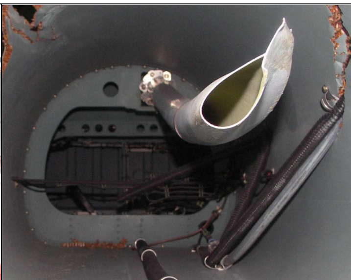
22 – Wnętrze belki kadłuba, na pierwszym planie widać przełom ukłóconego wału napędowego fenestronu.
