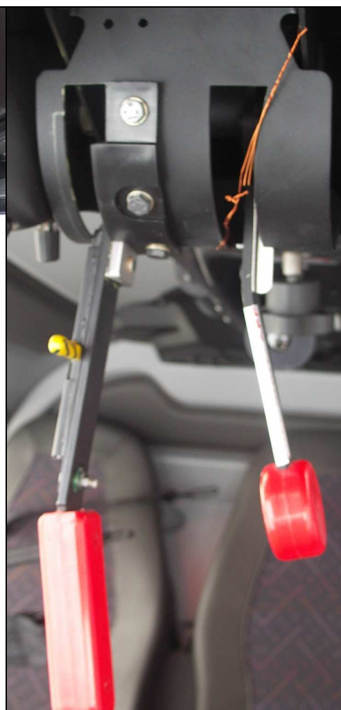
43 - Dźwignia zaworu odcinającego paliwo (po prawej) i dźwignia hamulca wirnika głównego - widok od przodu.
