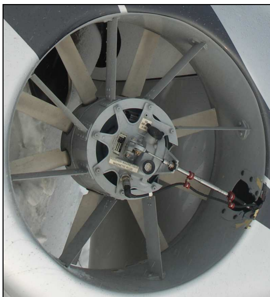
30 – Fenestron, widoczne cięgno sterowania.
