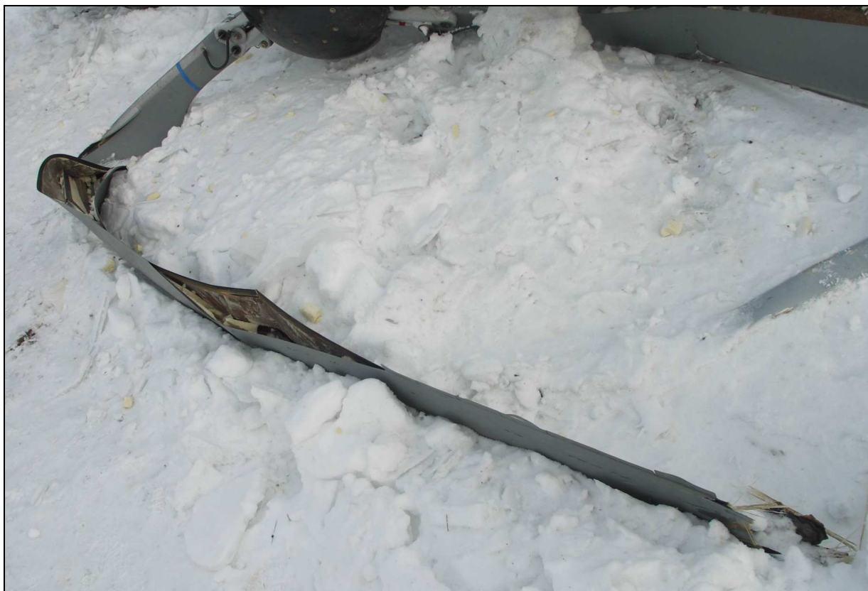
28 – Zniszczona „niebieska” łopata wirnika głównego.
