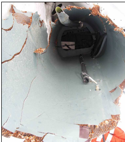
21 – Wnętrze belki kadłuba w stronę kabiny. U góry kadru widać zniszczony wał napędowy fenestronu.
