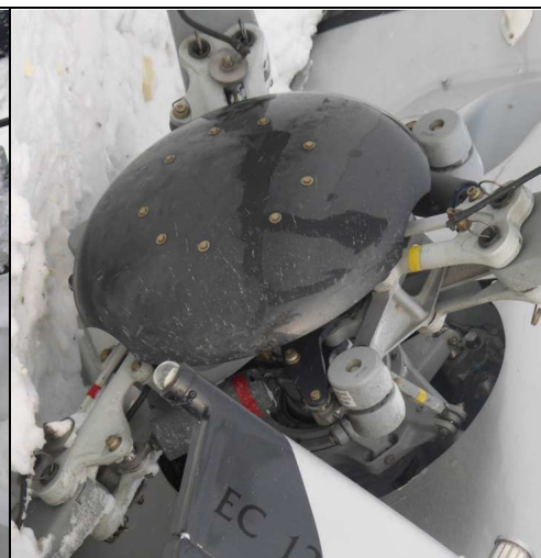
24 – Przełom belki ogonowej od strony fenestronu.
