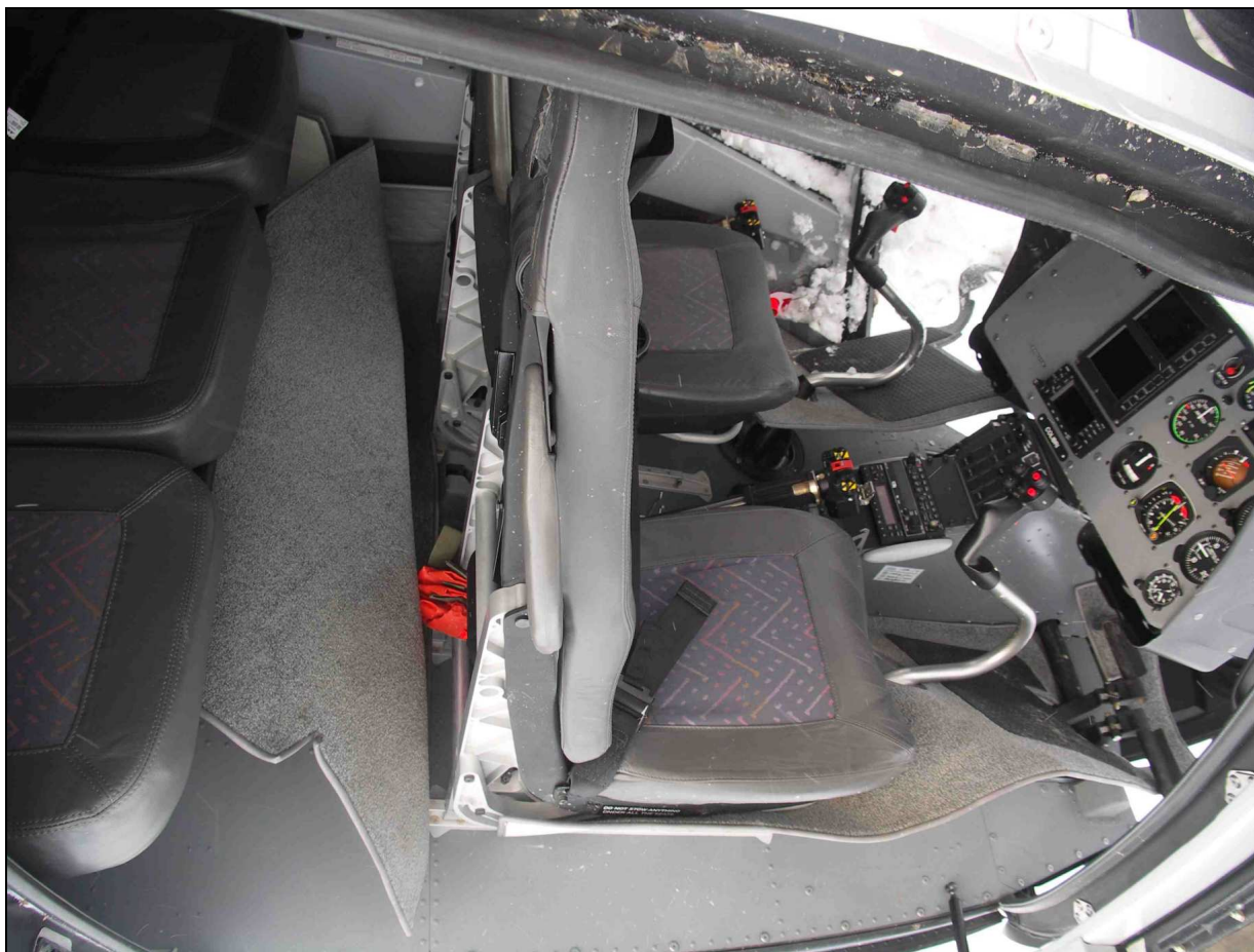
38 – Ogólny widok wnętrza kabiny z prawej strony. Stan zamocowań foteli przednich (tłumiki ruchu pionowego foteli nie zadziaływały) świadczy o małej sile pionowej podczas przyziemienia.
