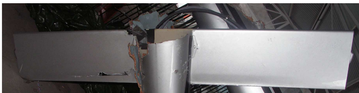
32 – Uszkodzone usterzenie poziome na odłamanej części belki ogonowej
