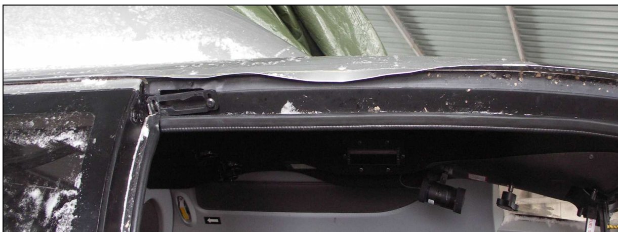
34 – Uszkodzenie krawędzi (odkształcenie) pokrycia nad prawymi drzwiami, powstałe podczas opuszczania śmigłowca przez pilota i pasażera.
