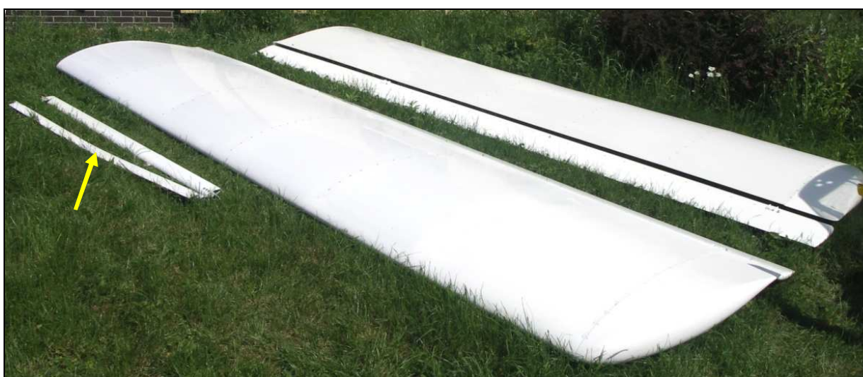
20 – Zdemonstrowane skrzydła, żółtą strzałką wskazany skrzywiony zastrzał.
