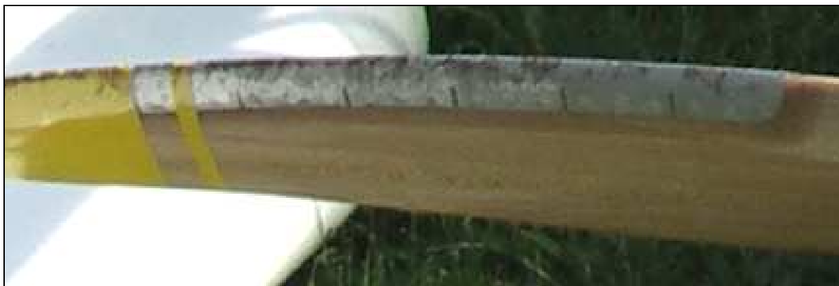
27 – Powiększenie fragmentu krawędzi natarcia łopaty śmigła ze śladami zwiększonej erozji.
