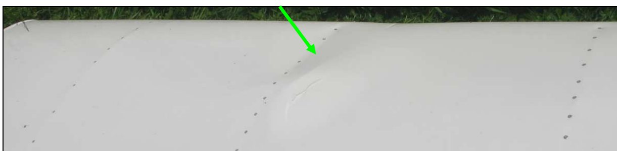
25 – Zdemontowane prawe skrzydło. Zieloną strzałką wskazana deformacja pokrycia prawego skrzydła na nosku.
