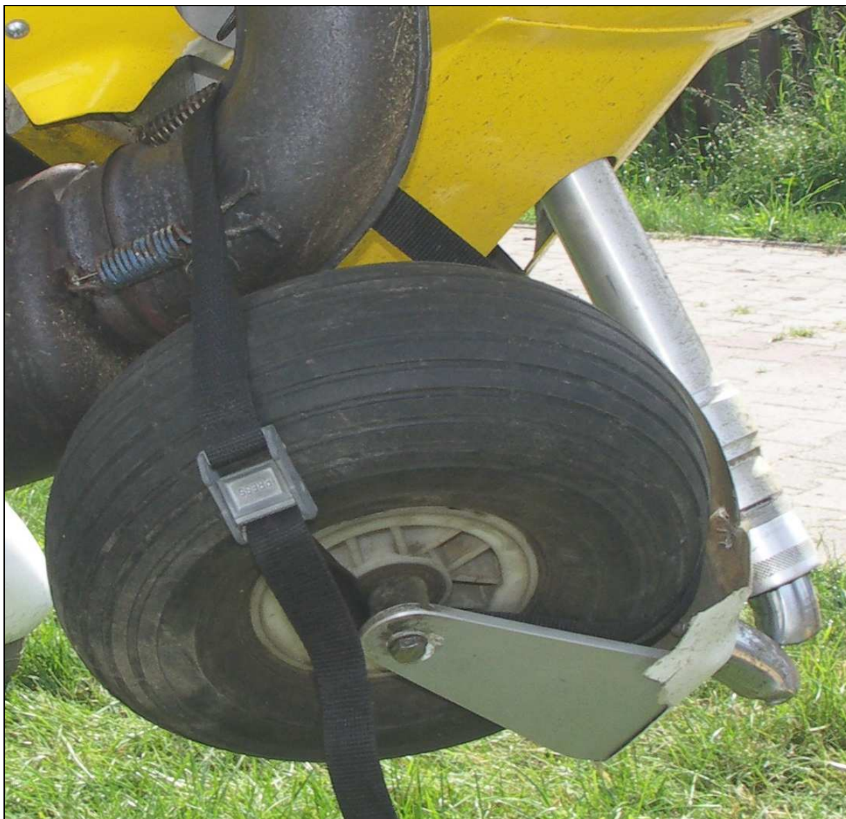
32 – Złamane podwozie przednie – zbliżenie z prawej strony.
