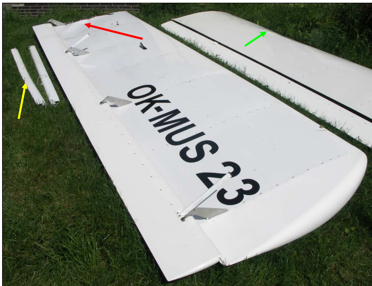
21 – Zdemontowane skrzydła, lewe skrzydło odwrócone dolną powierzchnią ku górze. Czerwoną strzałką wskazana deformacja pokrycia lewego skrzydła u nasady, zieloną – deformacja pokrycia prawego skrzydła na nosku, żółtą strzałką wskazany skrzywiony zastrzał.
