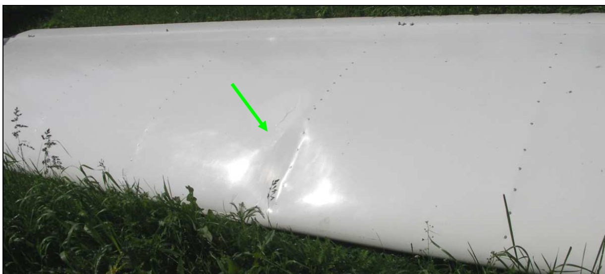
24 – Zdemontowane prawe skrzydło. Zieloną strzałką wskazana deformacja pokrycia prawego skrzydła na nosku.
