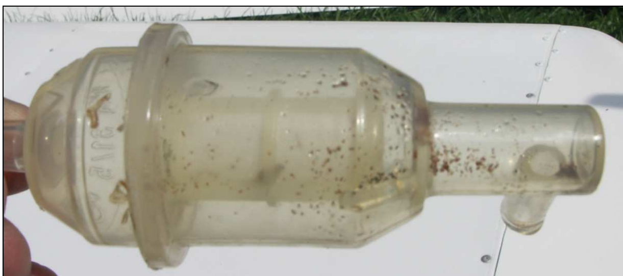
35 – Element filtrujący instalacji paliwowej – wyraźnie widoczne zanieczyszczenia, pochodzące z paliwa.
