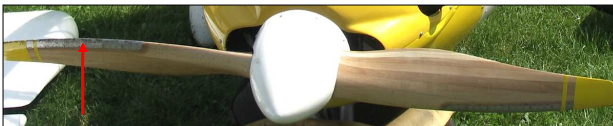
26 – Śmigło. Czerwona strzałka wskazuje zwiększoną erozję krawędzi natarcia łopaty.
