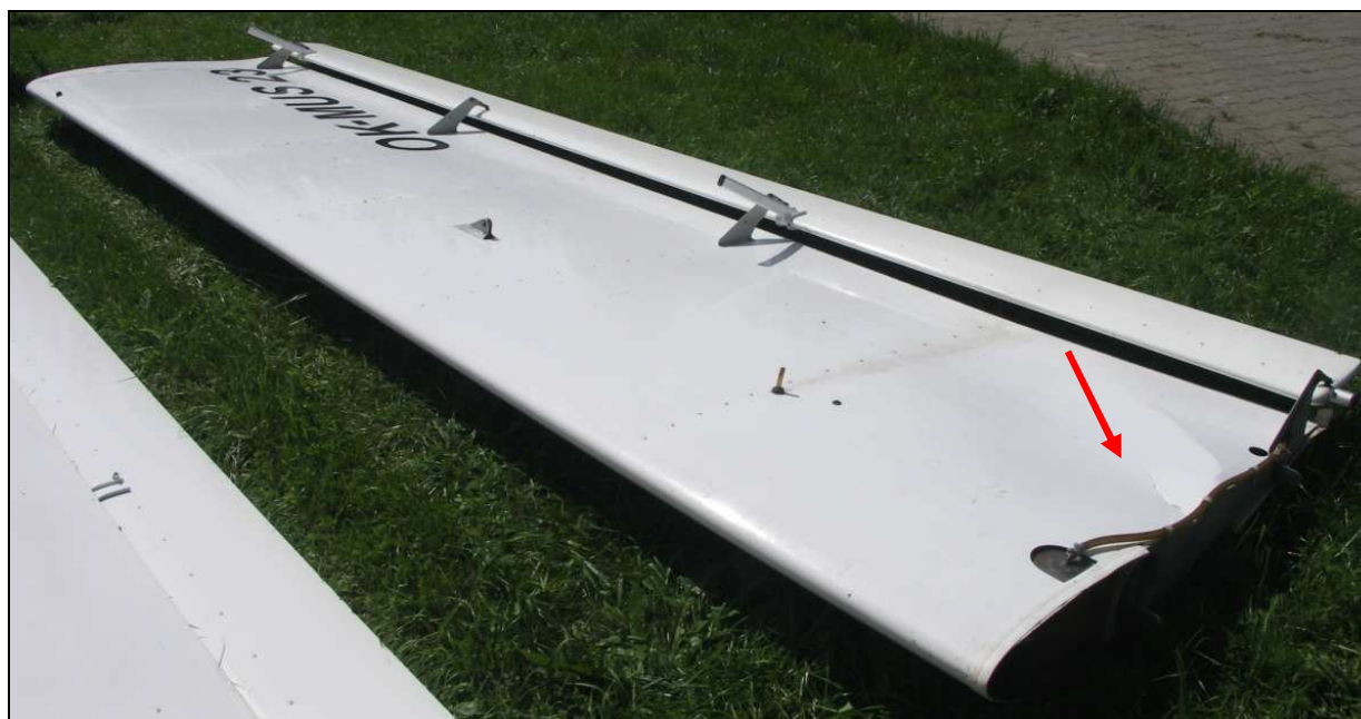
22 – Zdemontowane lewe skrzydło odwrócone dolną powierzchnią ku górze. Czerwoną strzałką wskazana deformacja pokrycia lewego skrzydła u nasady.
