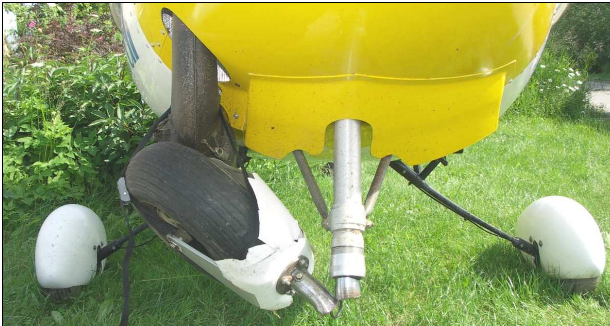
31 – Widok od przodu na podwozie samolotu. Na pierwszym planie złamana goleń podwozia przedniego i zniszczona owiewka koła.
