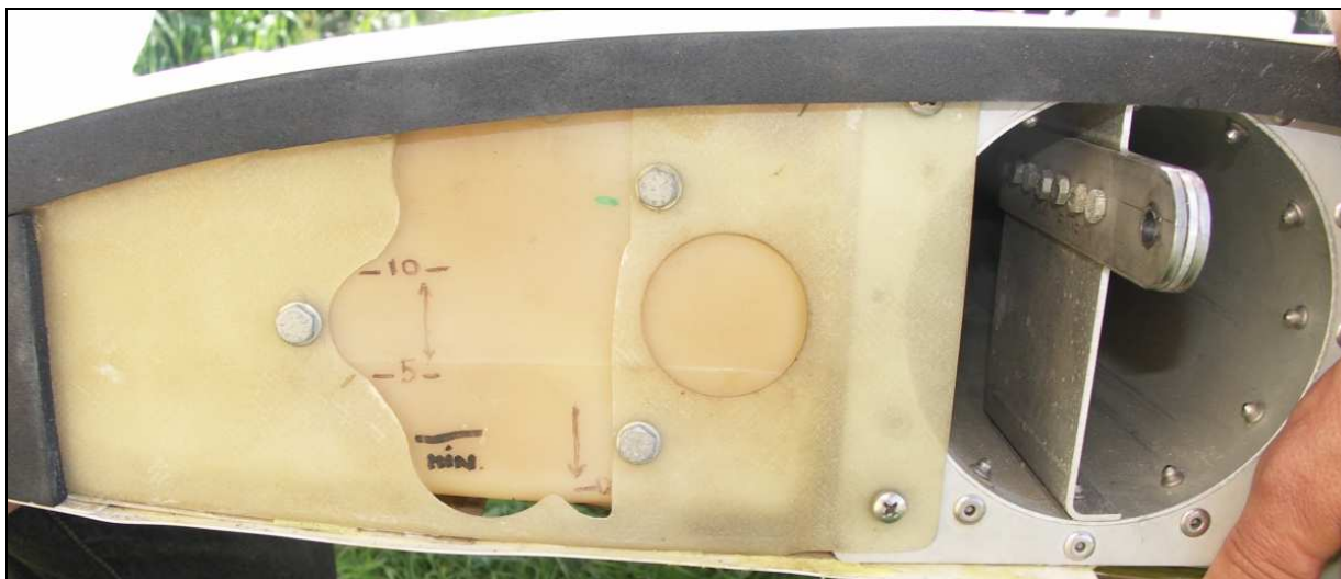
33 – Żebro nasadowe prawego skrzydła – widoczny półprzezroczysty zbiornik paliwowy z naniesioną prowizorycznie skalą.
