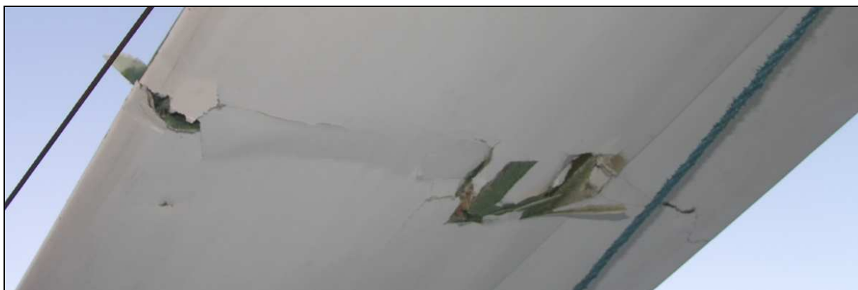
21 – Zbliżenie na zniszczony fragment dolnego pokrycia prawego skrzydła.
