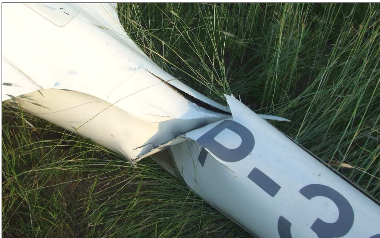
18 – Zbliżenie z lewej strony od góry na miejsce zniszczenia belki ogonowej.
