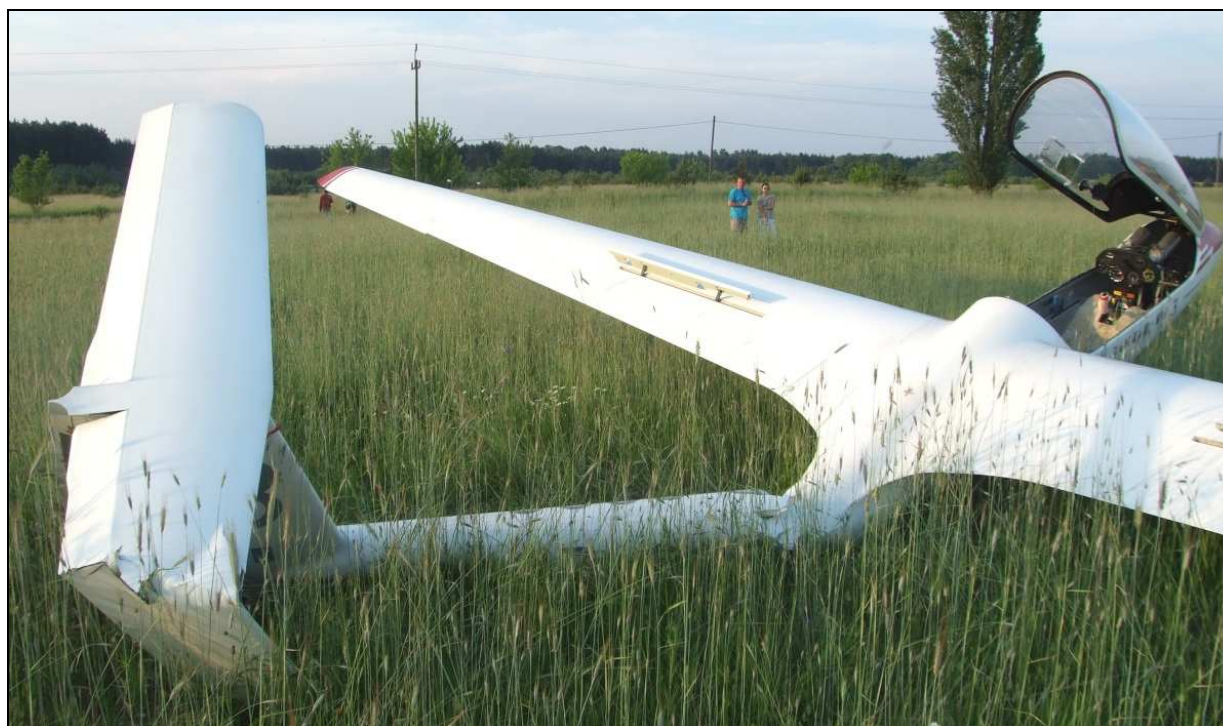
15 – Zbliżenie z prawej strony na tylną część kadłuba i usterzenie – widoczne zniszczenia belki kadłuba i usterzenia poziomego.
