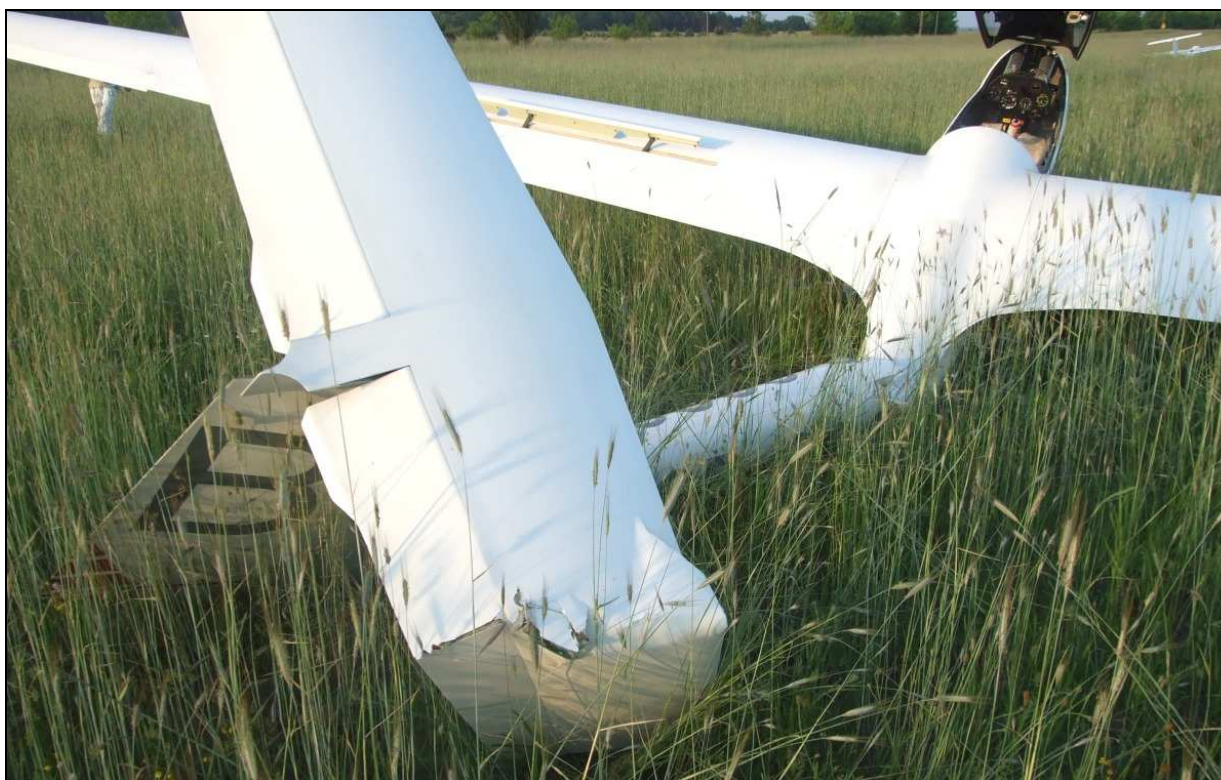
19 – Zbliżenie na miejsce zniszczenia usterzenia poziomego. W prawym górnym rogu kadru widoczny szybowiec SP-3678.
