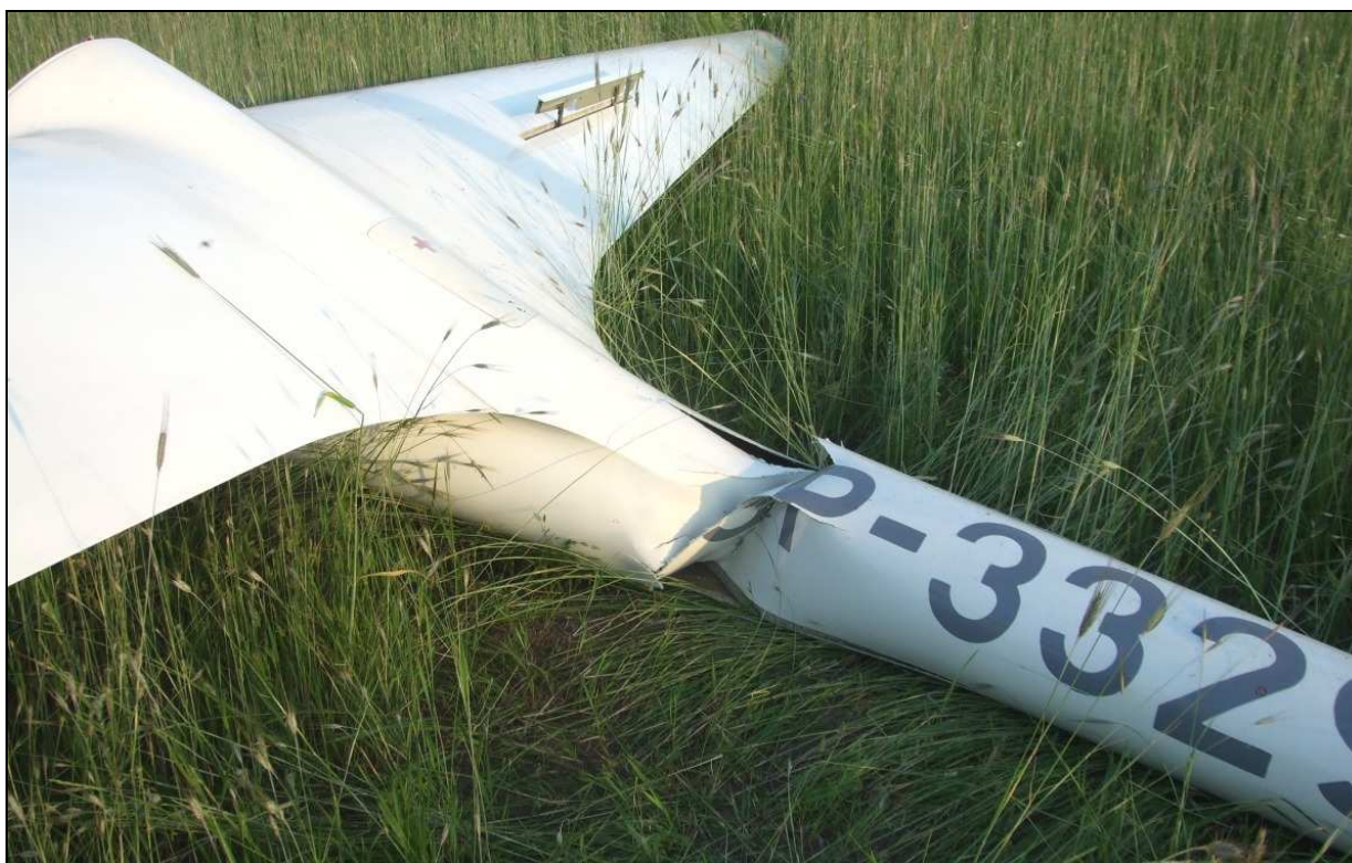
17 – Zbliżenie z lewej strony na miejsce zniszczenia belki ogonowej.
