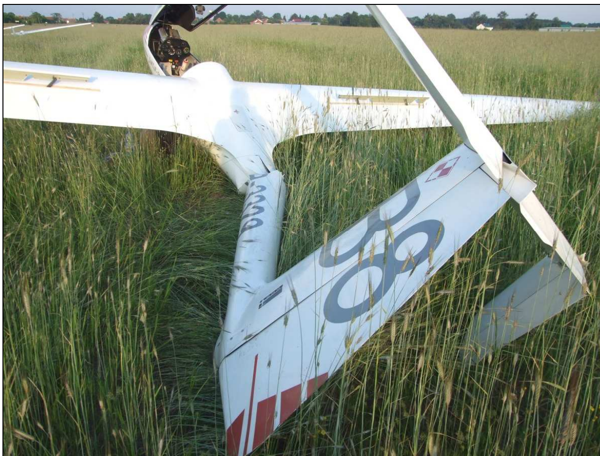
20 – Zbliżenie z tyłu na tylną część kadłuba i usterzenie – widoczne zniszczenia belki kadłuba i usterzenia poziomego. W lewym górnym rogu kadru widoczny szybowiec SP-3678.
