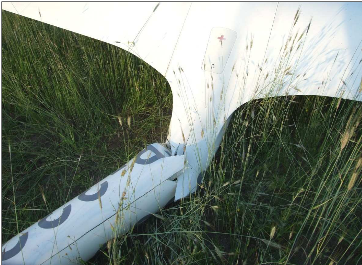
16 – Zbliżenie z prawej strony od góry na miejsce zniszczenia belki ogonowej.
