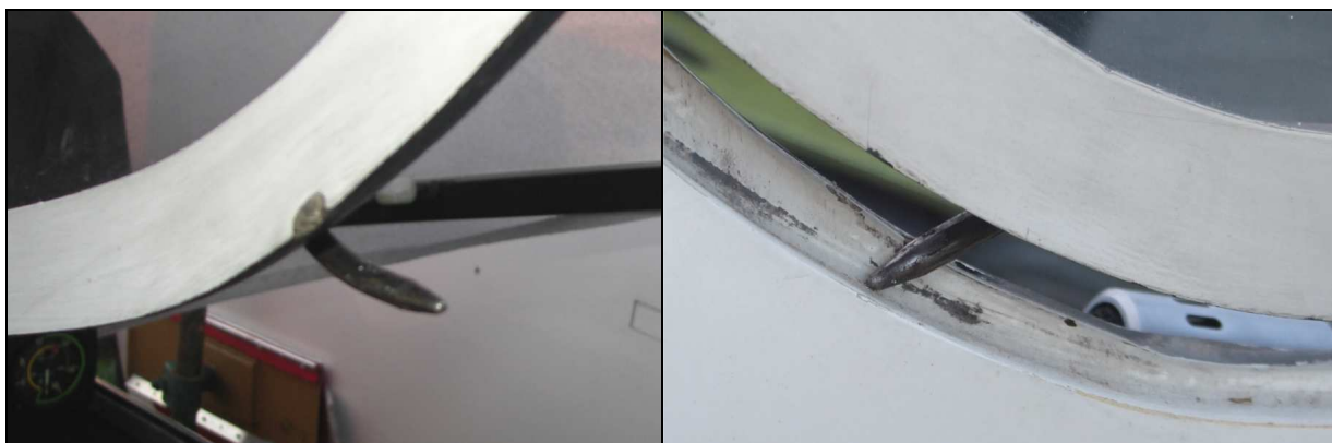
22, 23 – Uszkodzenia sworzni zamków ostony kabiny z lewej i prawej strony.
