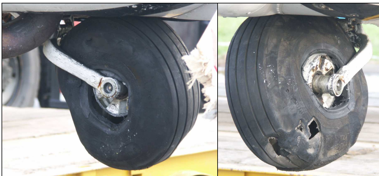
49, 50 – Wyłamane podwozie przednie, pokazane z obu stron po uniesieniu samolotu. Zwraca uwagę stopień zniszczenia obręczy koła i ogumienia.
