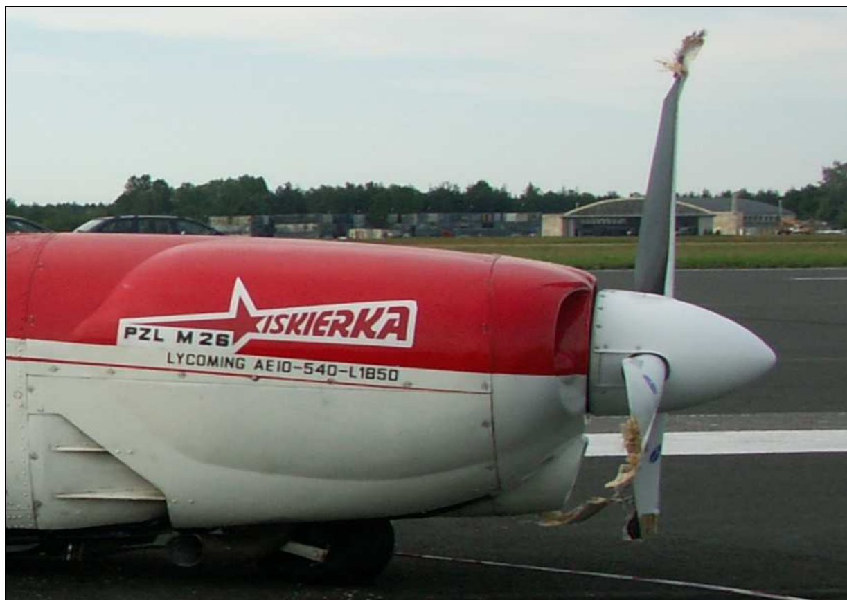
28 – Zniszczone śmigło i osłony silnika, pod nimi wyłamane podwozie przednie – widok z prawej strony.
