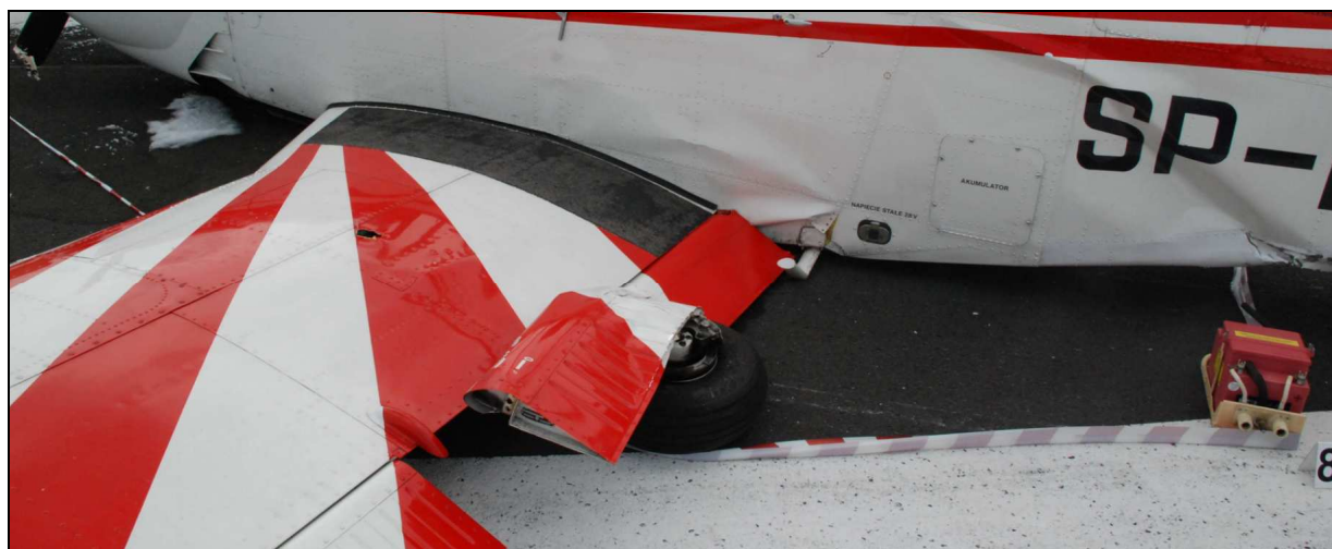
35 – Zbliżenie na lewe skrzydło z lewej strony, widoczna zniszczona kłapa, koło wyłamanego podwozia głównego, zniszczone pokrycia lewej burty kadłuba i złamany stopień. Obok samolotu akumulator [8]. [foto: Policja].
