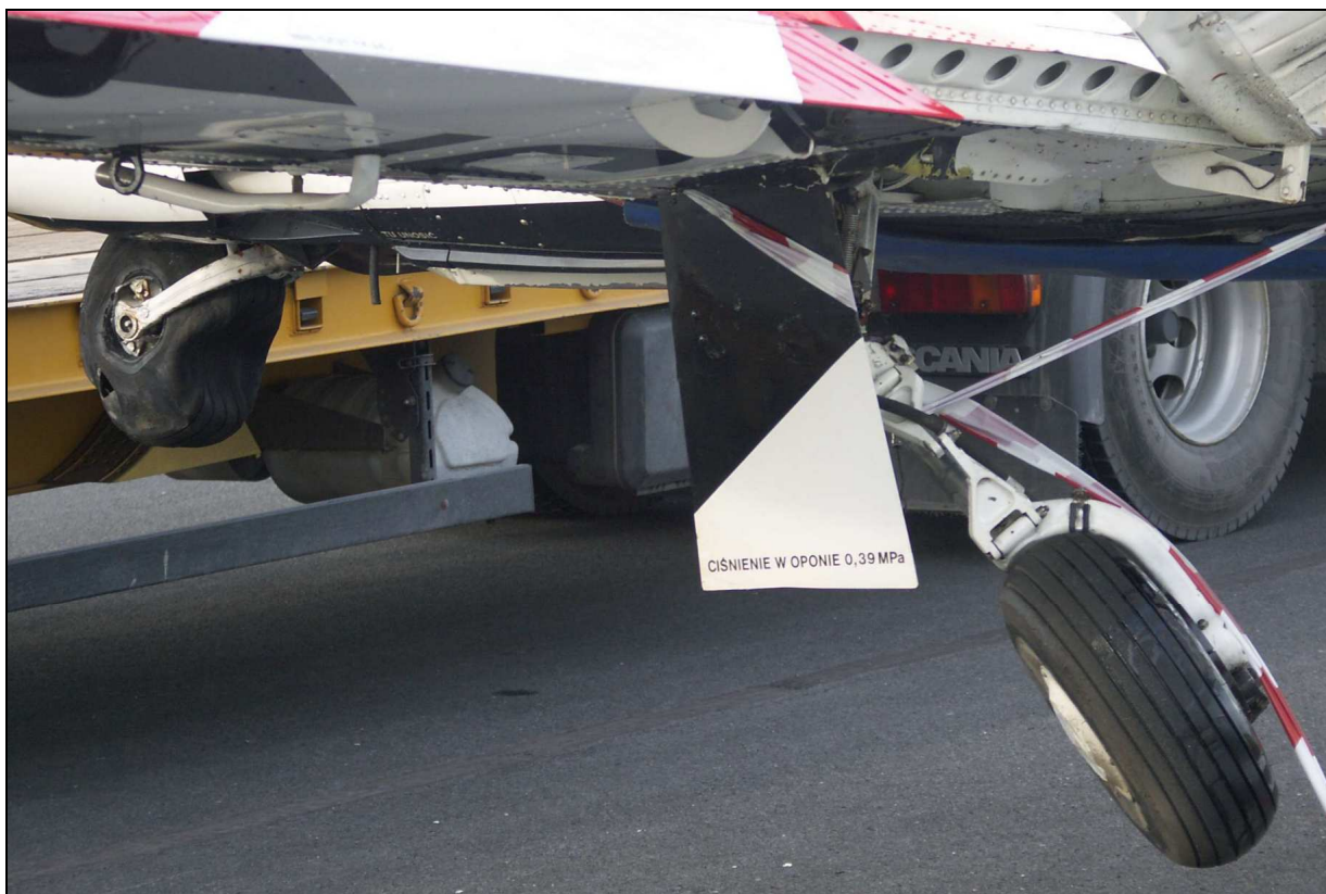
46 – Widok na wyłamane podwozie przednie (z lewej strony kadru) i wyłamane lewe podwozie główne (z prawej strony kadru).
