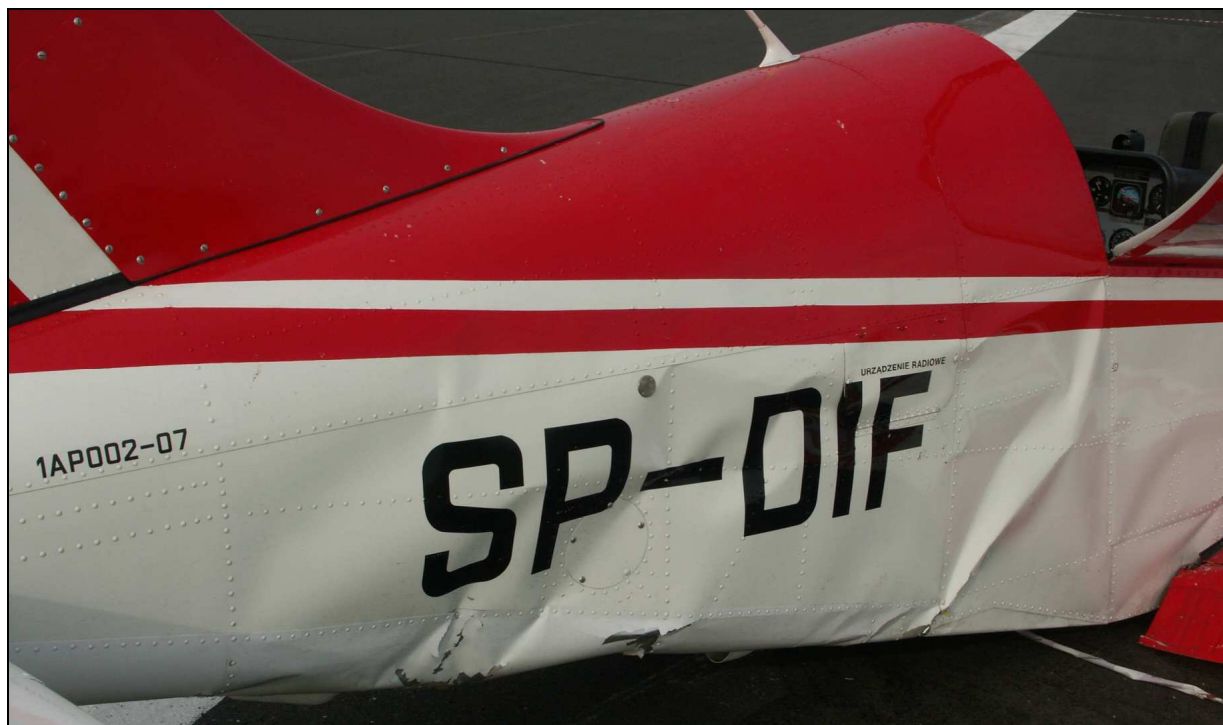
33 – Zniszczone pokrycia prawej burty tylnej części kadłuba.
