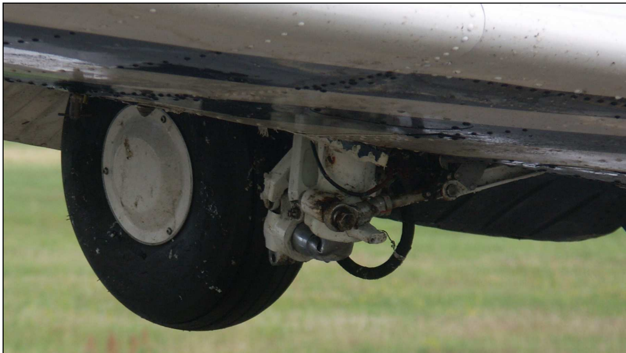
45 – Zbliżenie na złamane ku tyłowi prawe podwozie główne (stan po podniesieniu samolotu).
