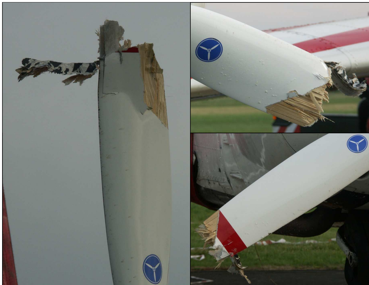
25, 26, 27 – Końcówki łopat zniszczonego śmigła.
