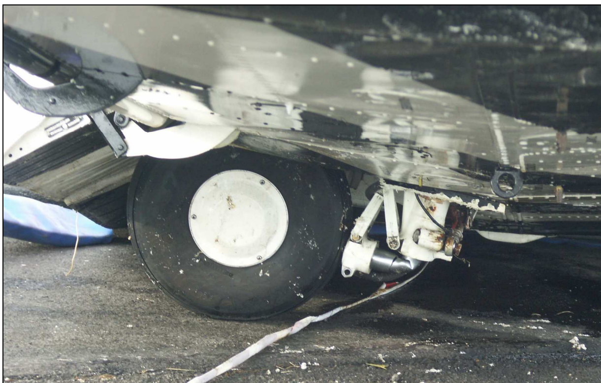
44 – Zbliżenie na złamane ku tyłowi prawe podwozie główne (stan przed podniesieniem samolotu).
