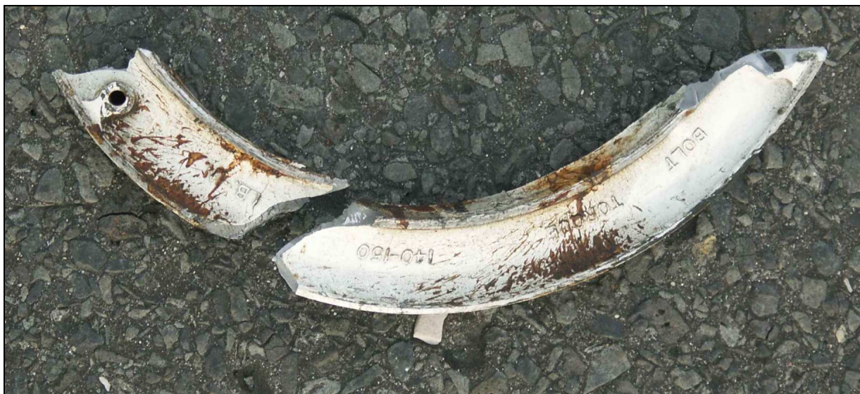
10 – Odłamane podczas przyziemienia dwa fragmenty obręczy koła podwozia przedniego.
