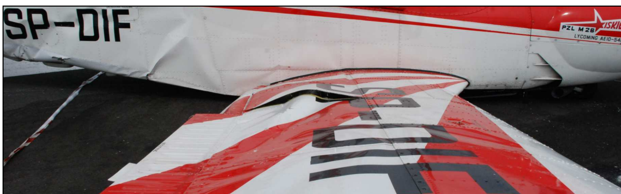
31 – Widok z prawej strony na uszkodzone prawe skrzydło i prawą burtę kabinowej części kadłuba.
