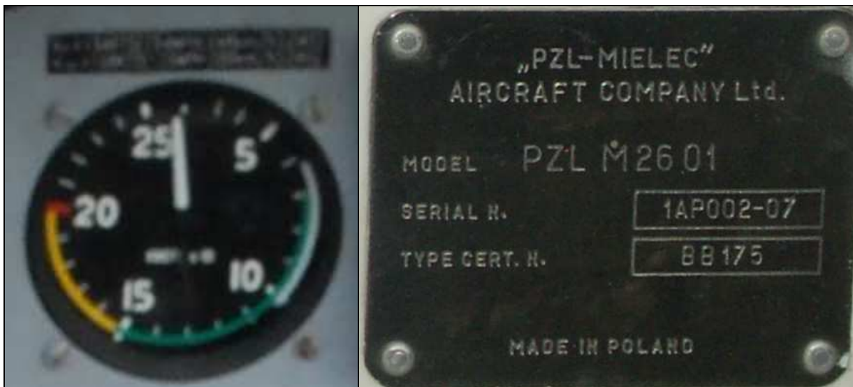
61 – Prędkościomierz przedniej kabiny sfotografowany w ok.75 minut po wypadku [foto: Policja]. 62 – Tabliczka znamionowa samolotu.
