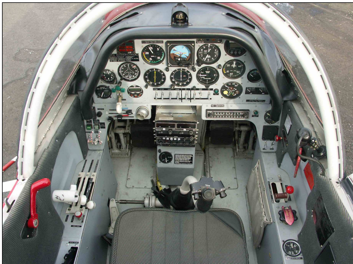
53 – Przednia tablica przyrządów, pulpit środkowy i pulpity boczne. Dobrze widoczne wszystkie sterownice i manipulatory.
