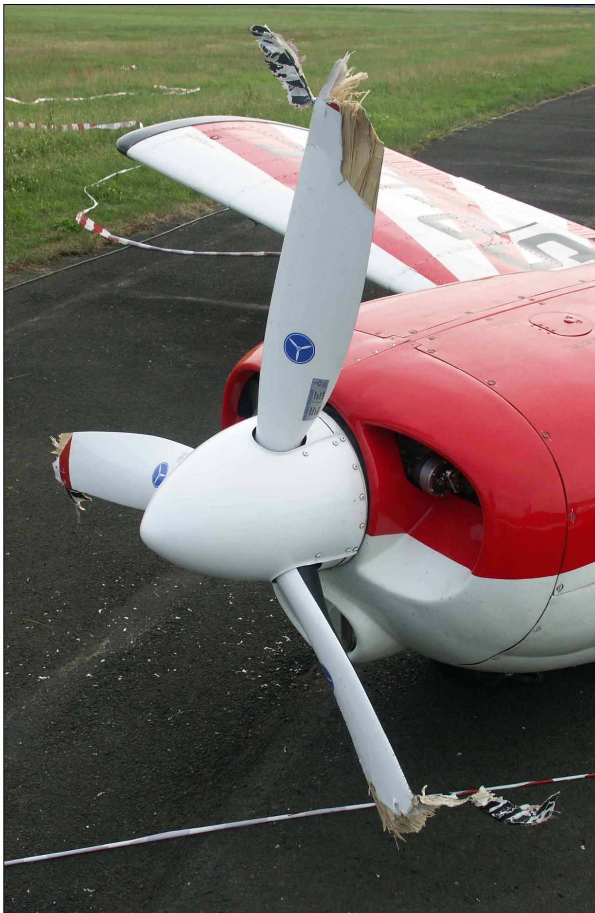
24 – Zbliżenie na zniszczone śmigło i przednią część osłon silnika.
