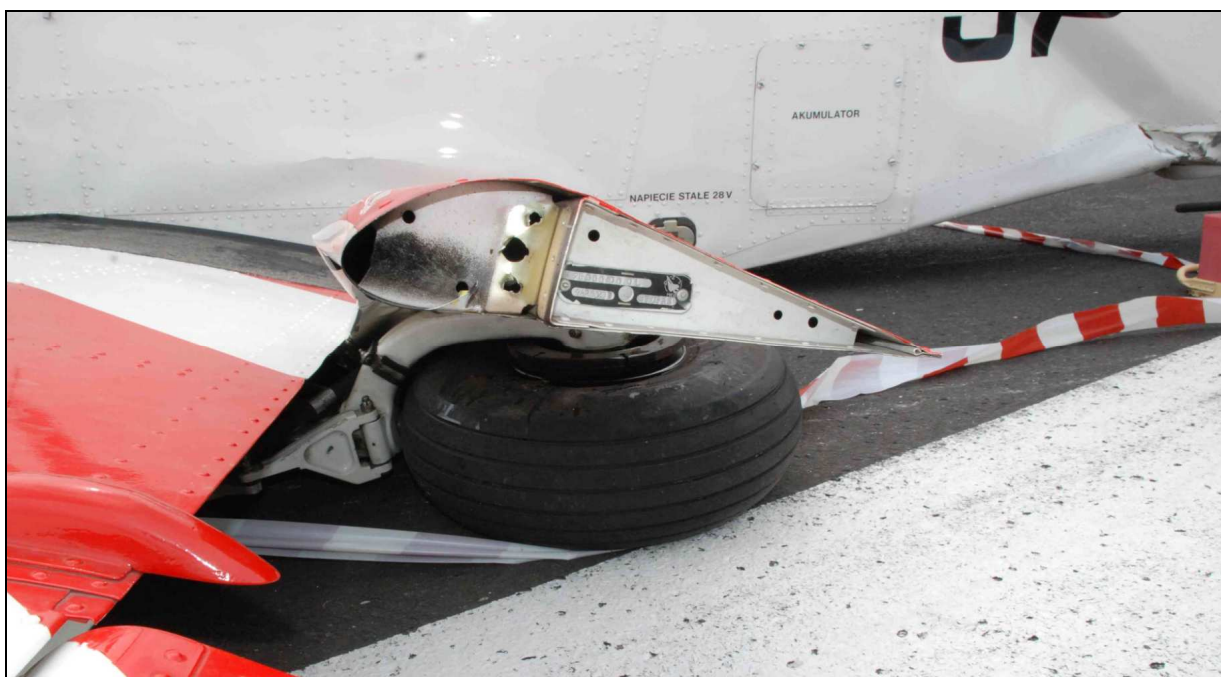
39 – Zbliżenie na lewe skrzydło z lewej strony, widoczna zniszczona kłapa, koło wyłamanego podwozia głównego i zniszczone pokrycia lewej burty kadłuba. [fot. Policja].
