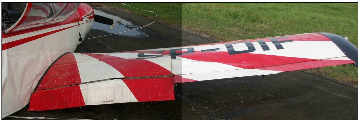
29 – Widok od tyłu na uszkodzone prawe skrzydło i prawą burtę kabinowej części kadłuba.
