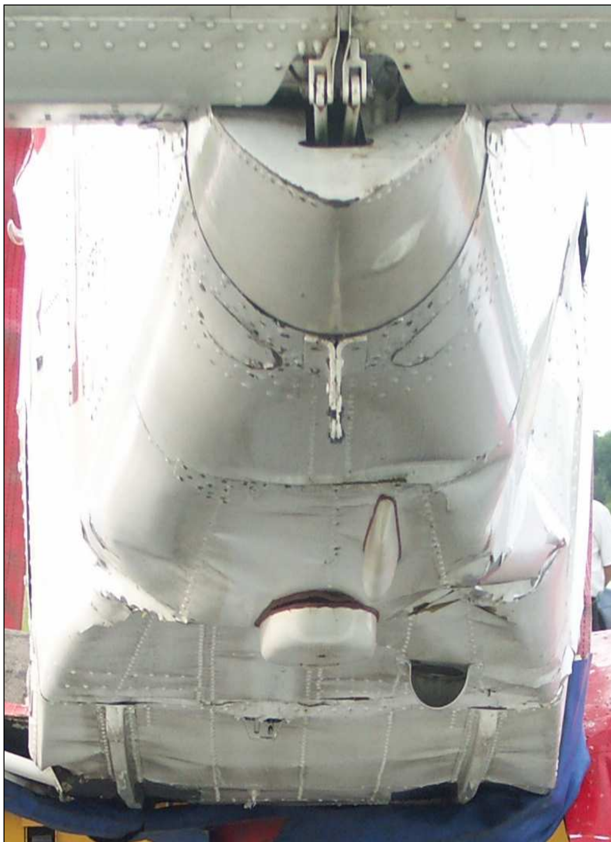
40 – Zbliżenie na zniszczone dolne pokrycia tylnej części kadłuba – widok od tyłu.
