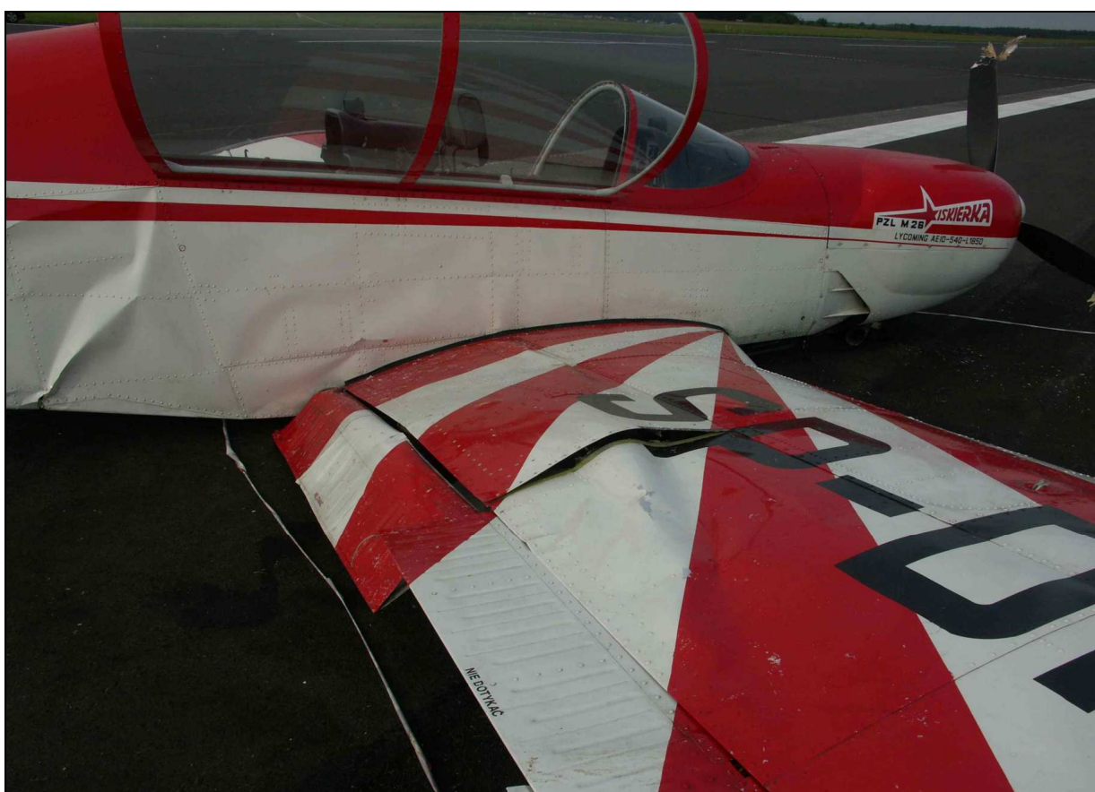
30 – Widok z prawej strony na uszkodzone prawe skrzydło i prawą burtę kabinowej części kadłuba.
