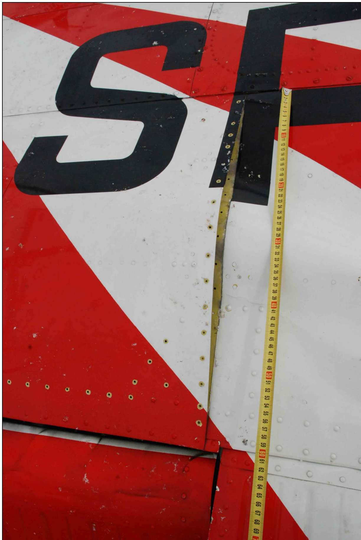
32 – Zbliżenie na zniszczony szew nitowy górnego pokrycia prawego skrzydła [foto: Policja].
