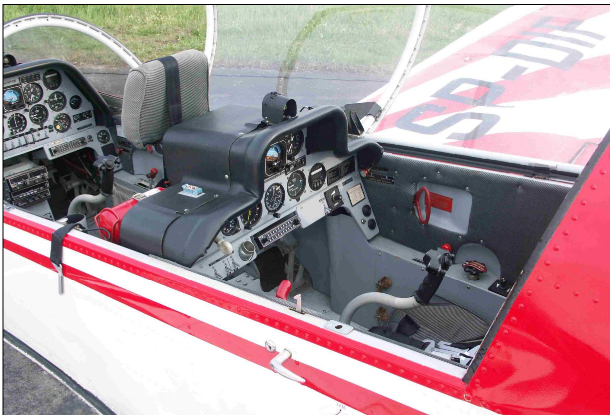
52 – Wnętrze kabiny – miejsce instruktora.
