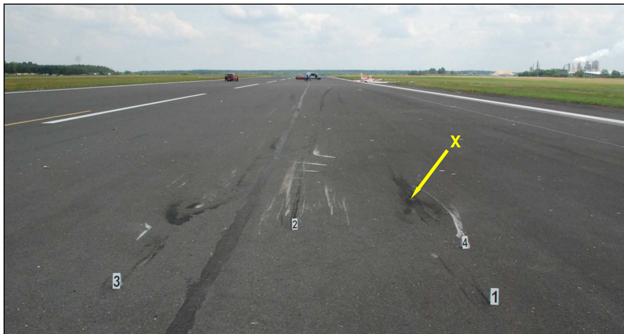
6 – Ślady przyziemienia: 1 – prawe podwozie główne, 2 – podwozie przednie (dalej ślad ścierania dolnej osłony silnika), 3 – lewe podwozie główne, 4 – początek śladu ścierania pokrywy prawego podwozia głównego, X – wgłębienie w asfalcie spowodowane uderzeniem krawędzi obręczy koła prawego podwozia głównego [foto: Policja].
