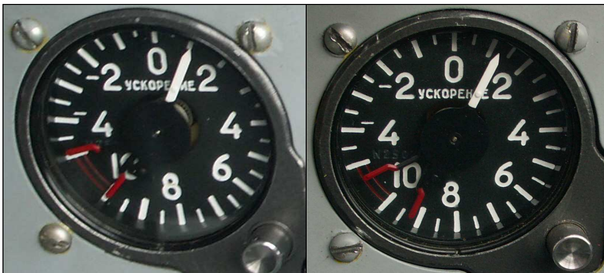
55, 56 – Zbliżenie na przeciążeniomierze przedniej (po lewej stronie) i tylnej (po prawej stronie) tablicy przyrządów. Zarejestrowane podczas wypadku przeciążenie dodatnie ok. 8,5-10 „g” (w chwili zderzenia z ziemią) i ujemne ok. 4,8-5,5 „g” (wskutek odbicia po przyziemieniu).
