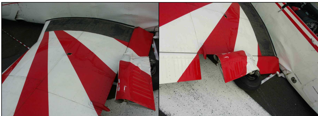
36, 37 – Zbliżenia na lewe skrzydło z lewej strony, widoczna zniszczona kłapa, koło wyłamanego podwozia głównego, przebite górne pokrycie w rejonie mocowania goleni podwozia głównego, zniszczone pokrycia lewej burty kadłuba i złamany stopień.
