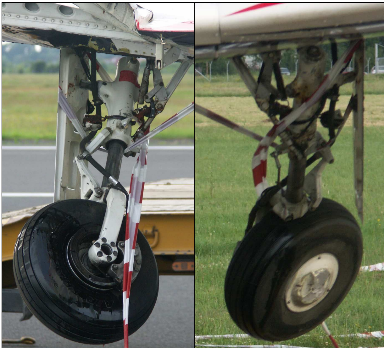
47, 48 – Wyłamane lewe podwozie główne, pokazane z obu stron po uniesieniu samolotu.
