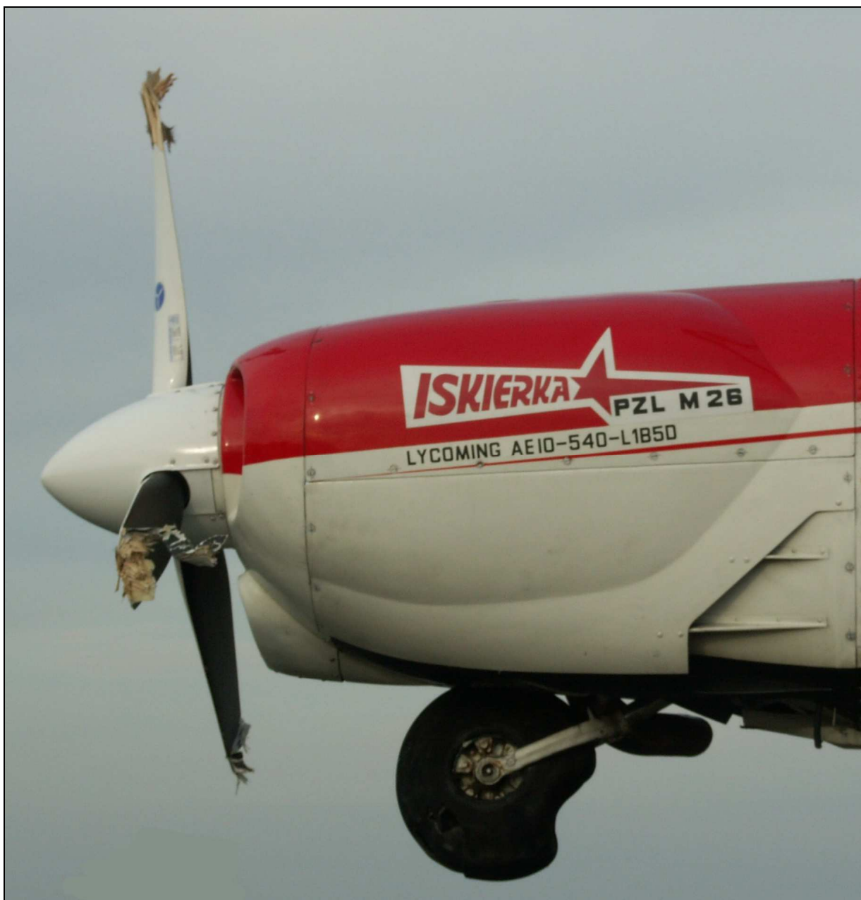
42 – Zniszczone śmigło i osłony silnika, pod nimi wyłamane podwozie przednie – widok z lewej strony po uniesieniu samolotu.
