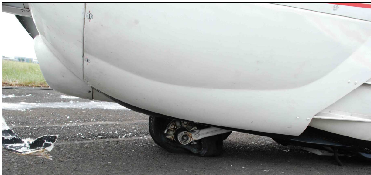
41 – Zbliżenie na dolną osłonę silnika, pod nią widoczne wyłamane podwozie przednie – widok z lewej strony [foto: Policja].
