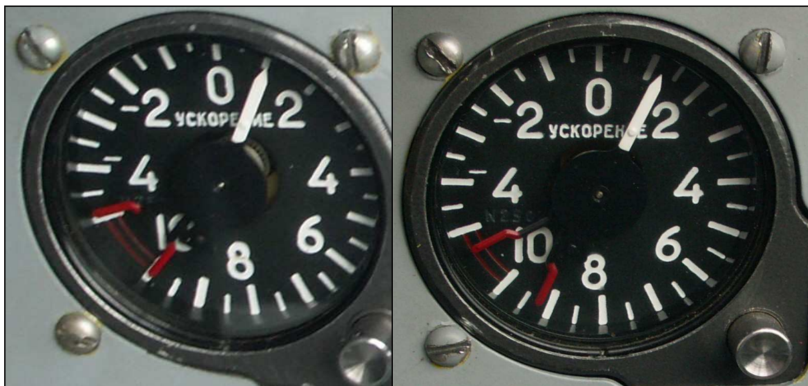
Zbliżenie na przeciążeniomierze przedniej (po lewej stronie) i tylnej (po prawej stronie) tablicy przyrządów. Zarejestrowane podczas wypadku przeciążenie dodatnie ok. 8,5-10 „g” (w chwili zderzenia z ziemią) i ujemne ok. 4,8-5,5 „g” (wskutek odbicia po przyziemieniu).
