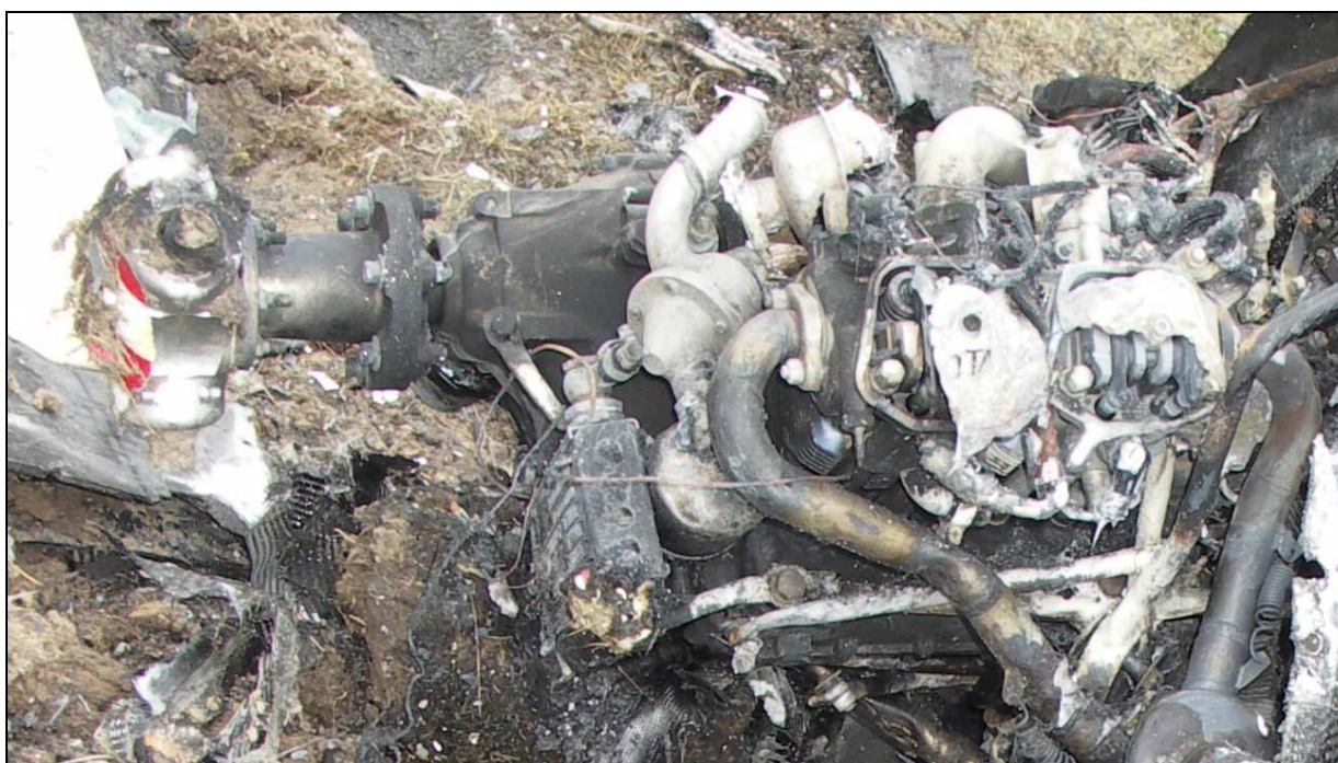
13 – Zbliżenie na zniszczony silnik z lewej strony. Widoczna piasta śmigła z utraconymi nasadami łopat.
