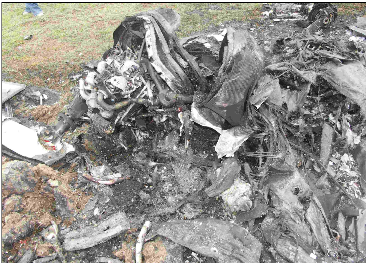
12 – Zespół napędowy z przegrodą ogniową, widziany z lewej strony.
