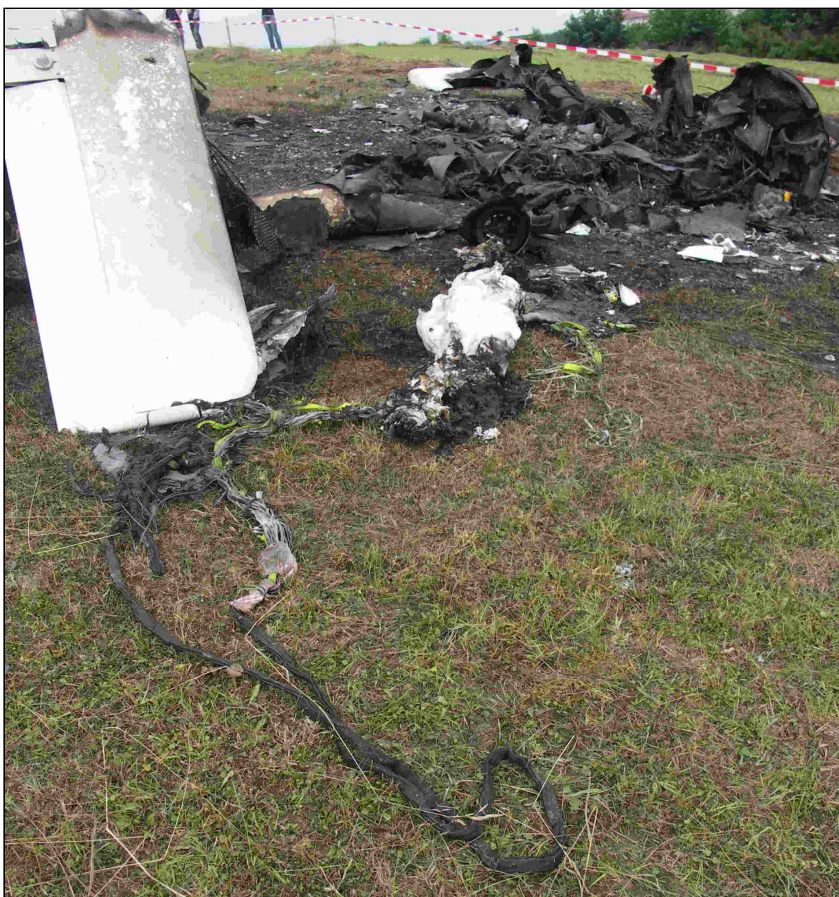
9 – Zbliżenie na szczątki tylnej części kadłuba. W centrum kadru nadpalony spadochron balistycznego systemu ratunkowego, na pierwszym planie jego linki mocujące do płatowca.
