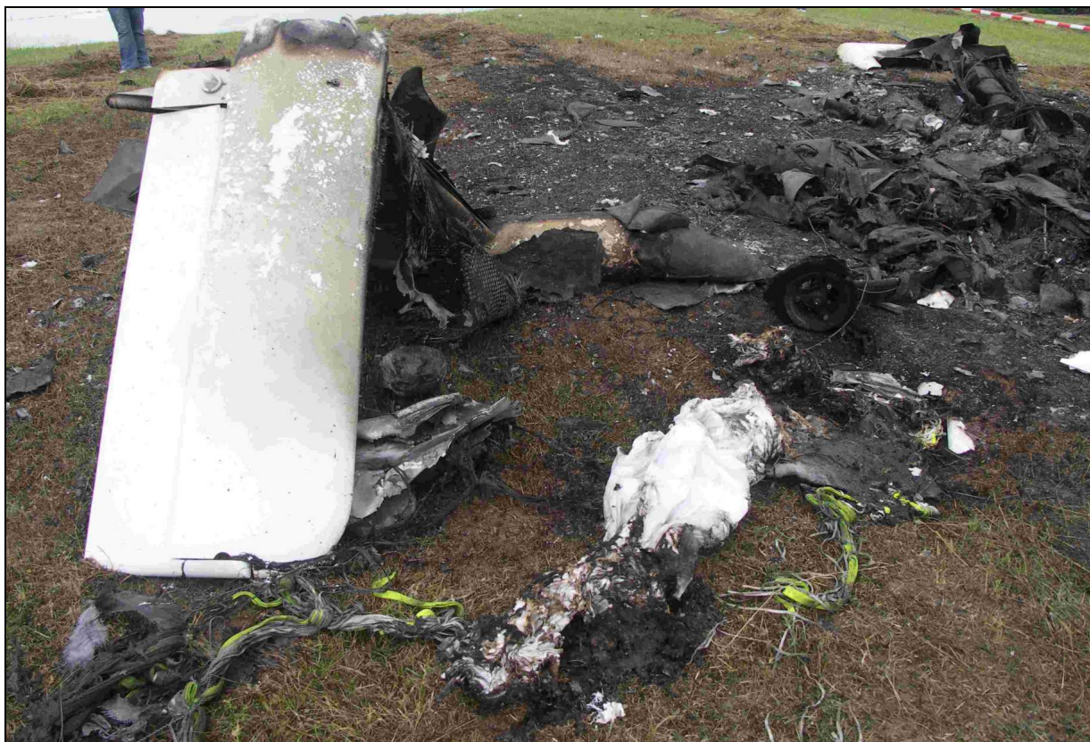
10 – Szczątki belki tylnej części kadłuba z usterzeniem. Widoczny spadochron balistycznego systemu ratunkowego z uprzężą i piastą jednego z kół podwozia głównego.
