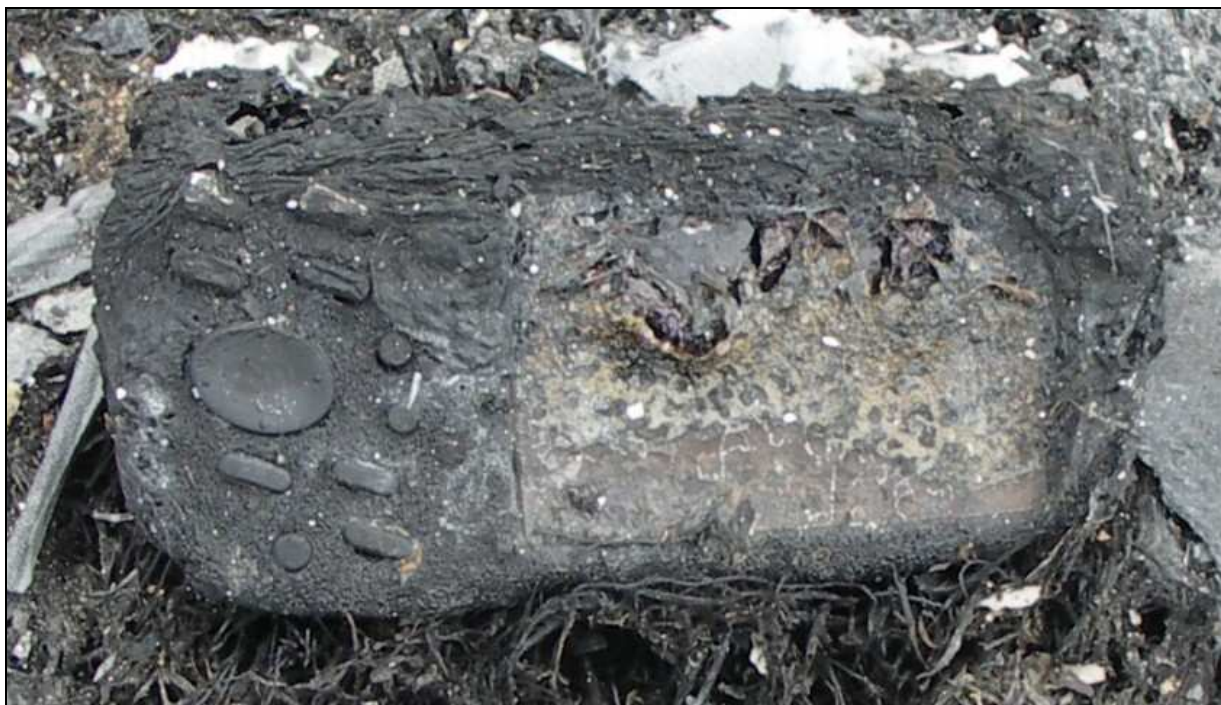
11 – Spalony odbiornik GPS wśród szczątków samolotu.
