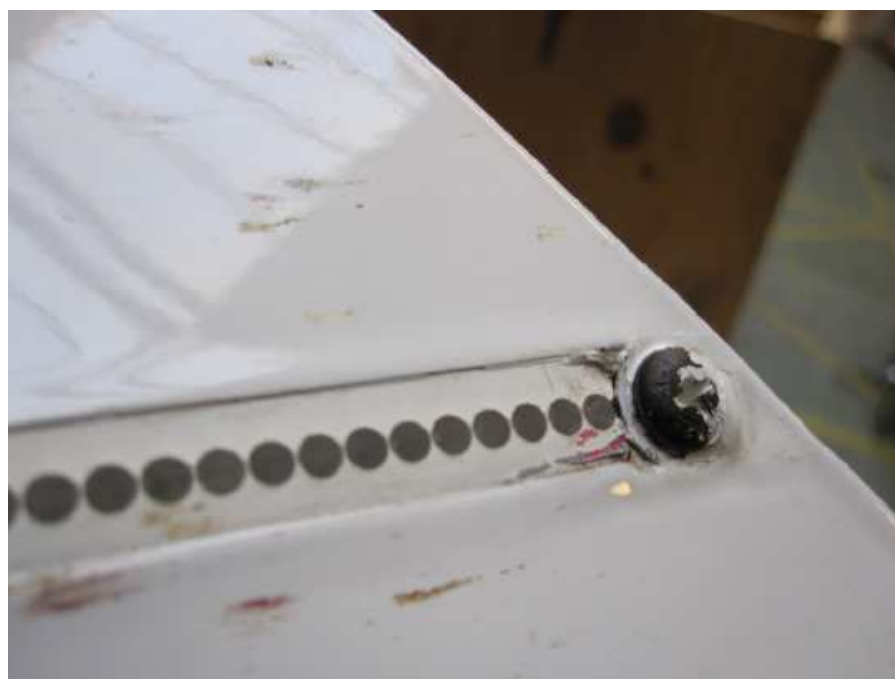
Uziemienie/Mocowanie pasa odgromnika (rozpraszacza ładunku) Zdjęcie 10
