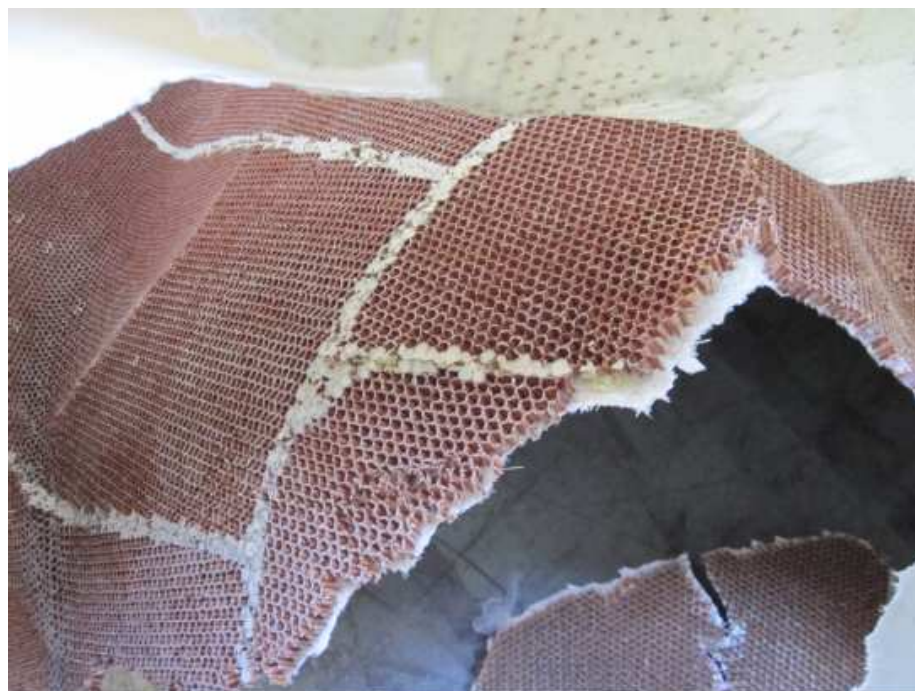
Szczegóły struktury „plastra miodu” i warstwy powłoki wewnętrznej Zdjęcie 6
