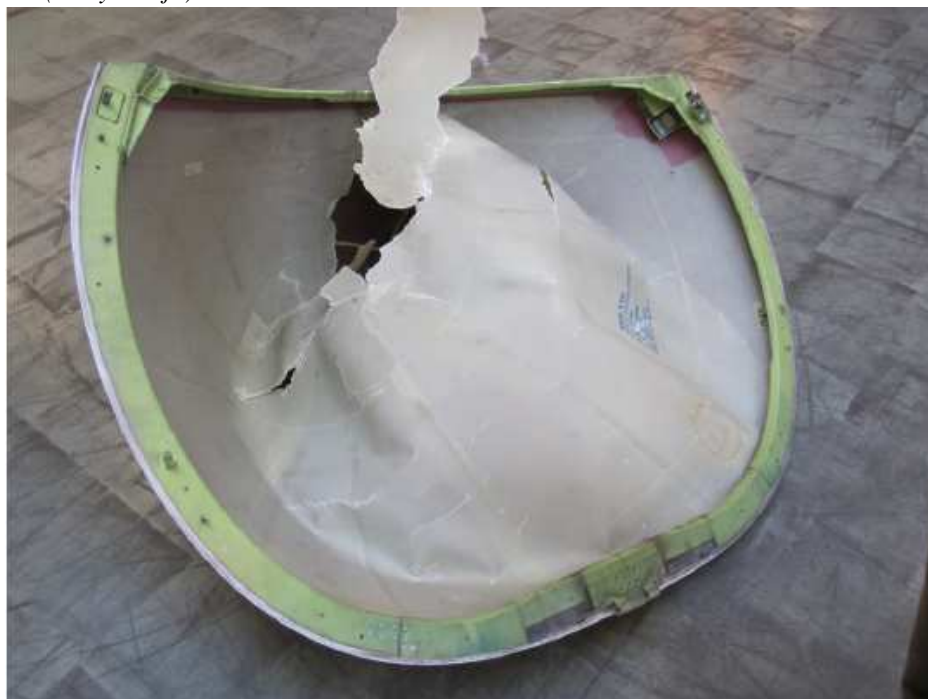
Rozwarstwione warstwy wewnętrzne Zdjęcie 8 (numeracja zgodna z oryginałem)
