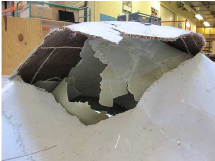
Szczegóły struktury „plastra miodu” i warstwy powłoki wewnętrznej Zdjęcie 5
