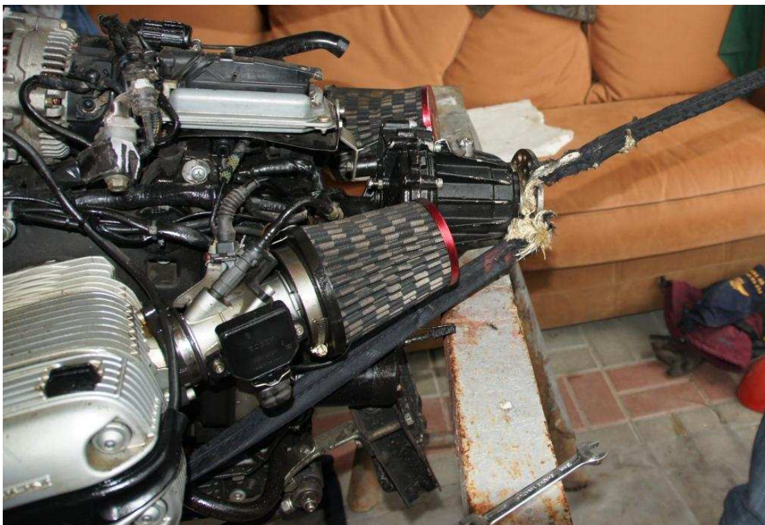
Fot. 9. widok zespołu napędowego z lewej strony (po zdjęciu śmigła) w czasie odwijania taśmy systemu GRS z wału silnika. Uwagę zwracają dobrze widoczne uszkodzenia taśmy systemu.
