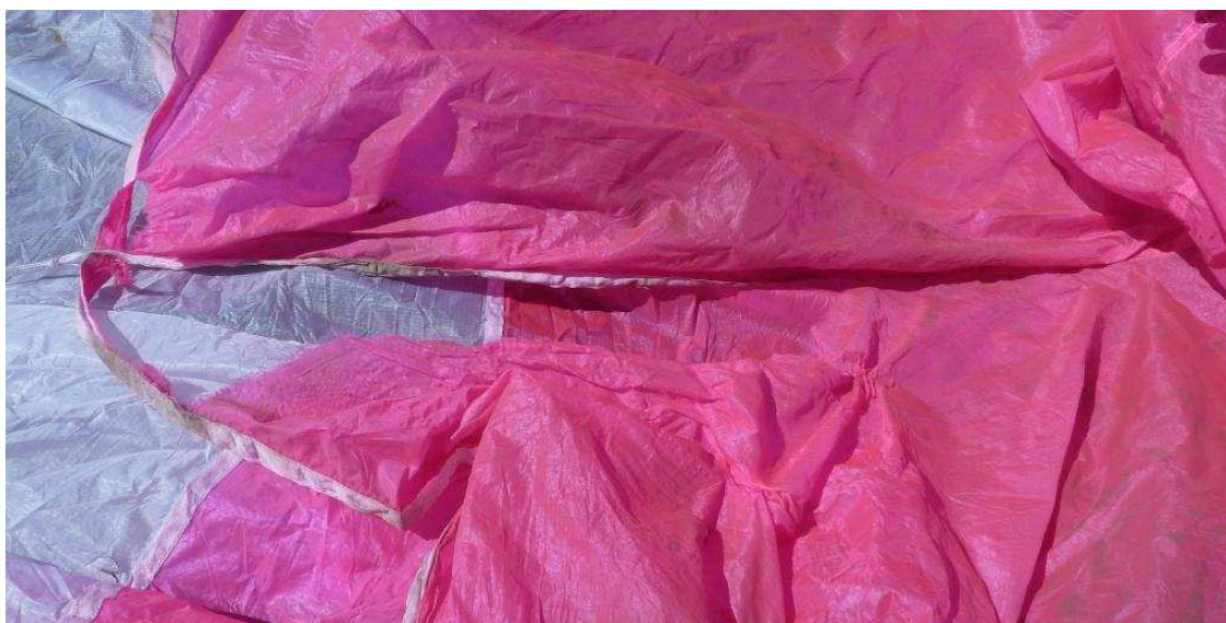
Fot. 8. Uszkodzenie obrzeża czaszy spadochronu systemu GRS, powstałe podczas zakłóconego procesu otwarcia.
