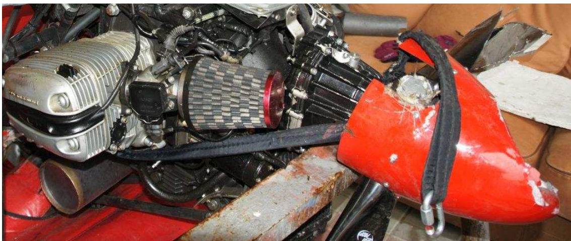
Fot. 6. Widok z lewej, tylnej strony na zespół napędowy. Uwagę zwraca przebieg taśmy systemu GRS – od miejsca mocowania taśmy do masztu wózka, pod lewym cylindrem silnika i do wału silnika. Widoczne miejsce złamania łopaty i uszkodzenie kołpaka śmigła.
