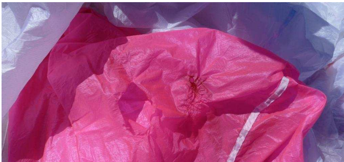
Fot. 7. Widok uszkodzeń materiału czaszy systemu GRS – z prawej strony uszkodzenie termiczne powstałe po opadnięciu czaszy na gorące elementy silnika. Z lewej strony uszkodzenia termicznego widoczne rozdarcie, które mogło powstać podczas ściągania czaszy z motolotni.
