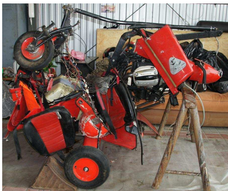
Fot. 3. Wózek motolotni z lewej strony. Widoczny maszt wózka zgięty o około 90° do tyłu.
