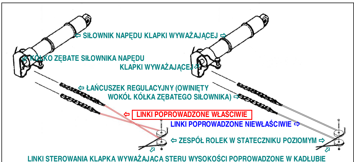
3 – Przebieg ostatniego odcinka układu sterowania klapką wyważającą steru wysokości w stateczniku poziomym – schematyczna ilustracja materialnej przyczyny incydem: po lewej stan prawidłowy (linki skrzyżowane), po prawej stan nieprawidłowy.
