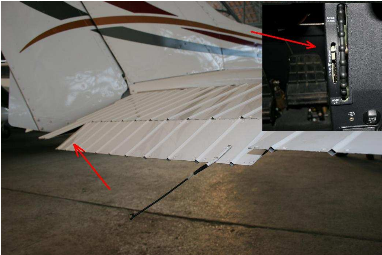
4 – Wychylenie klapki wyważającej steru wysokości w dół („ciężki na ogon”) i odpowiadające mu położenie wskaźnika w kabinie („ciężki na nos”) [fot.W.Musioł, Aviation Asset Management SA].
