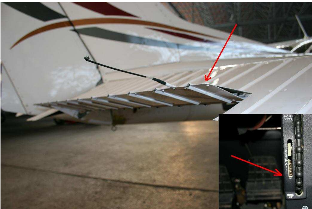
5 – Wychylenie klapki wyważającej steru wysokości w górę („ciężki na nos”) i odpowiadające mu położenie wskaźnika w kabinie („ciężki na ogon”) [fot.W.Musioł, Aviation Asset Management SA]. W okolicy pierścienia do kotwiczenia pod usterzeniem widoczny ciemniejszy fragment pokrycia – wynik przeprowadzonej naprawy.
