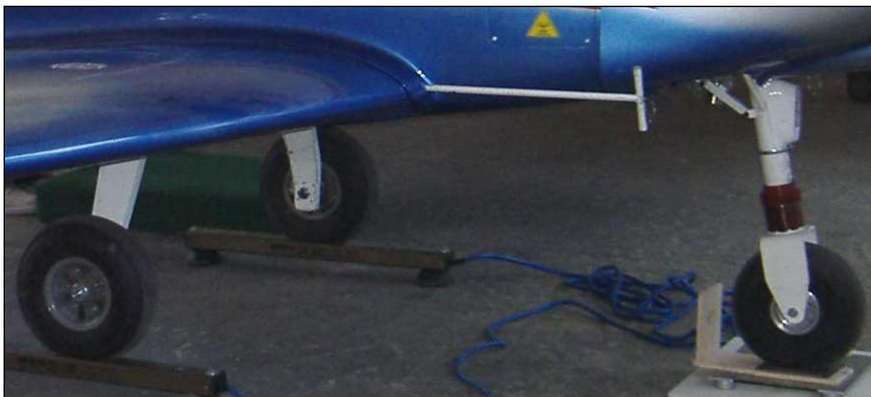
16 – Widok z prawej strony na podwozie samolotu podczas ważenia, zdjęcie sprzed wypadku.
