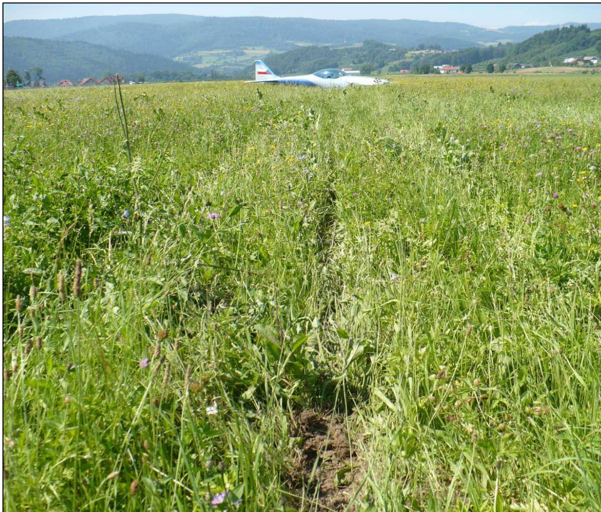
4 – Miejsce przyziemienia i ślady podwozia samolotu na trawie. W tle samolot obrocony o ok. 130° w prawo od kierunku lądowania.
