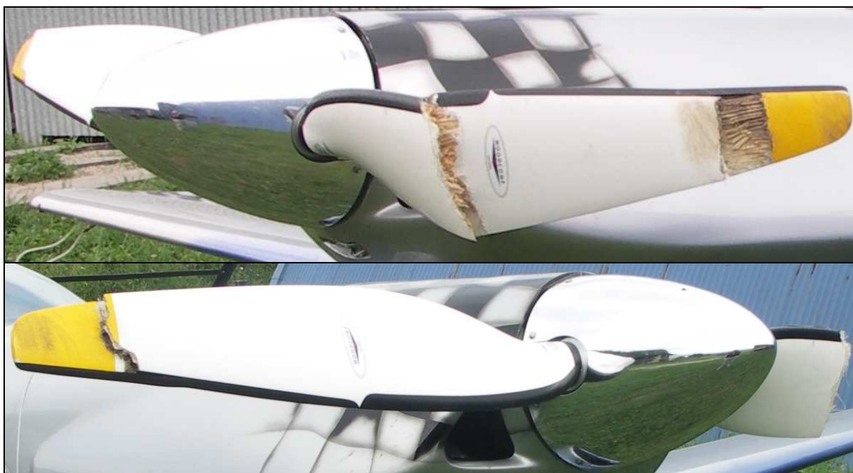
11, 12 – Zbliżenia obu połamanych łopatek śmigła z lewej i prawej strony.
