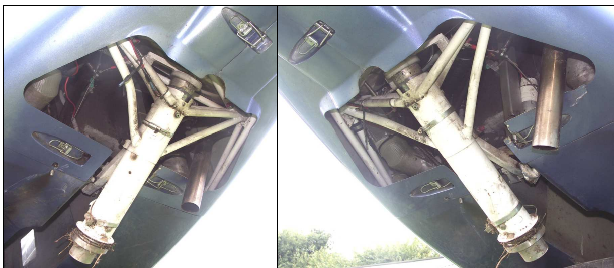
21, 22 – Wyłamane przednie podwozie samolotu, widziane od spodu z prawej i lewej strony.
