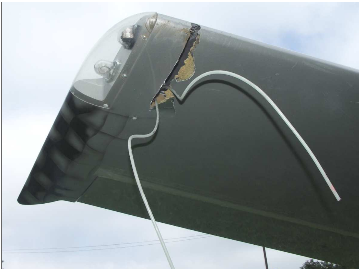
13 – Końcówka prawego skrzydła, uszkodzona w wyniku zaczepienia rurki Pitota o wysoką trawę. Widoczne wyrwane przewody systemu pomiaru ciśnienia.
