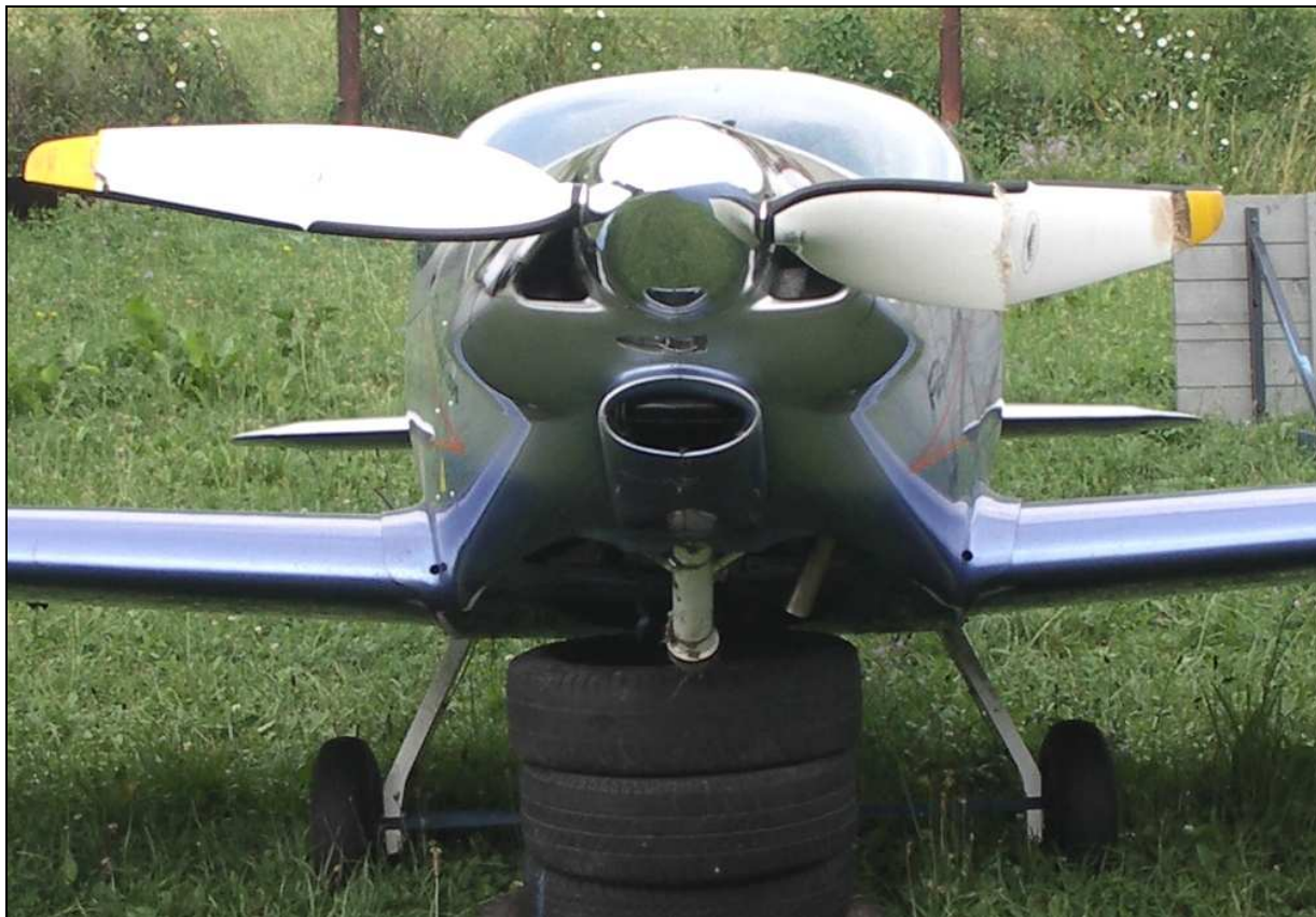
10 – Zbliżenie samolotu od przodu – widoczne połamane łopatki śmigła i wyłamane przednie podwozie bez widelca z kołem.
