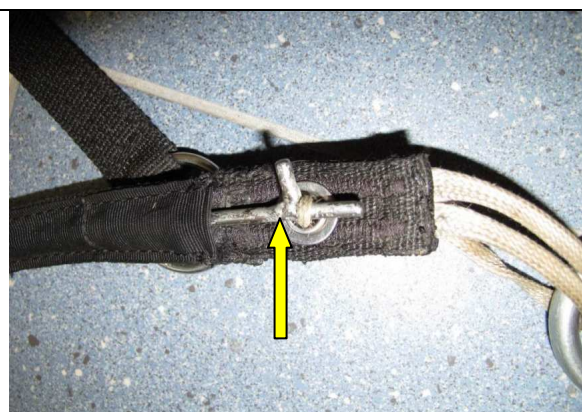
Fot. 3. Widok nieoryginalnej zawlecзки wyczepu.
