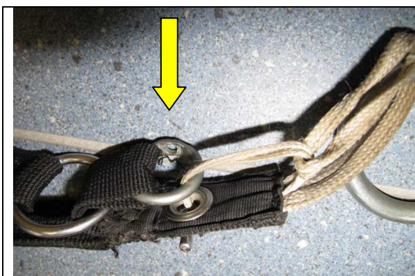
Fot.2. Widok wyczepu po naprawie. Uwagę zwraca zastosowanie nieoryginalnego kółka.
