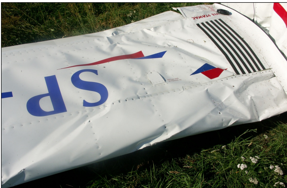
34 – Górne pokrycia prawego skrzydła u nasady od strony krawędzi natarcia – widoczne deformacje w wyniku zderzenia z ziemią.
