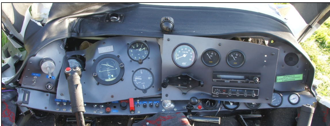
53 – Tablica przyrządów, widok ogólny. Widoczne odkształcenia.
