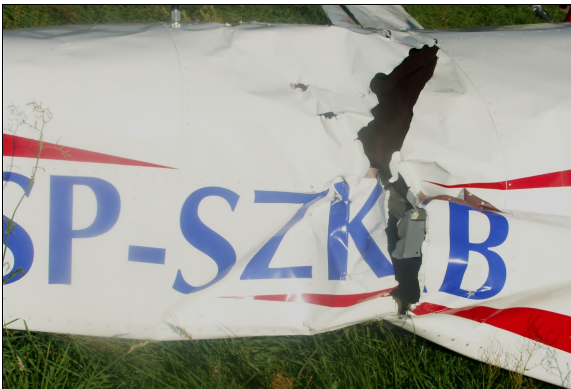
28 – Zdeformowana i rozdarta w wyniku złamania tylna część kadłuba, prawa strona.
