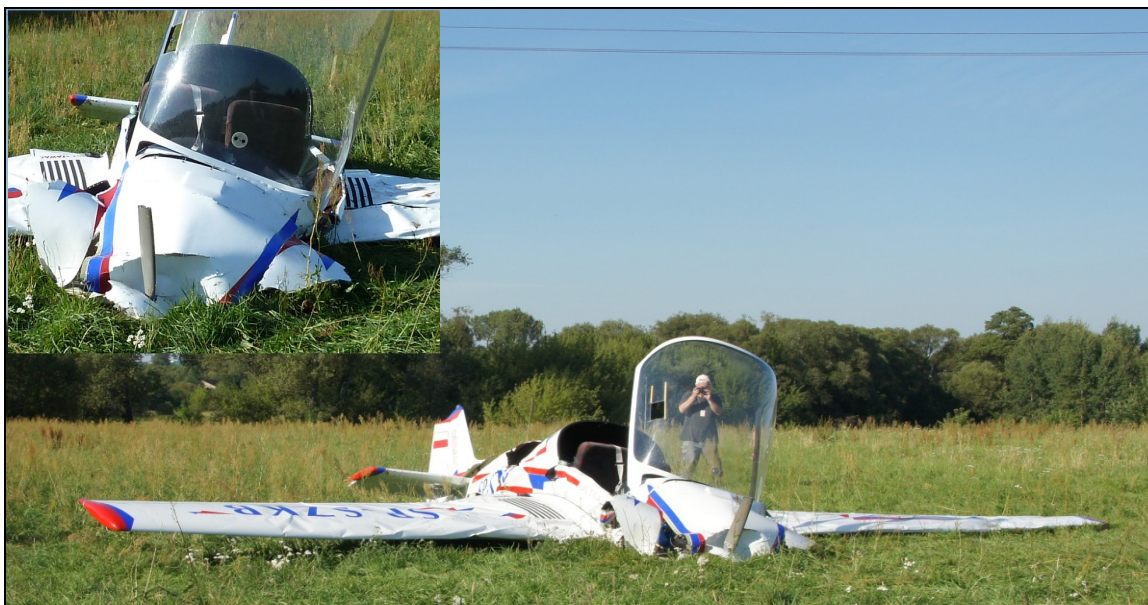
15 – Rozbity samolot ¾ od przodu z prawej strony (w powiększeniu uszkodzone śmigło).
