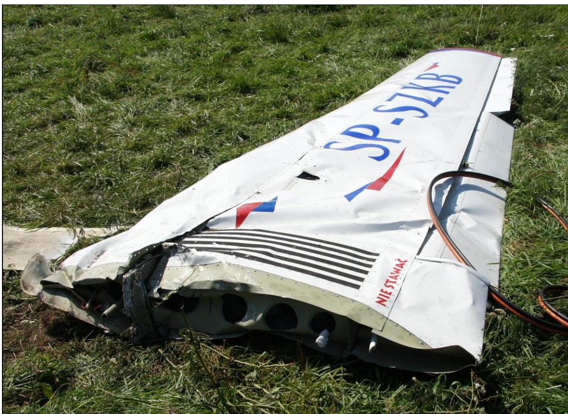
33 – Prawe skrzydło po zdemontowaniu (odcięciu), widziane od strony żebra nasadowego.
