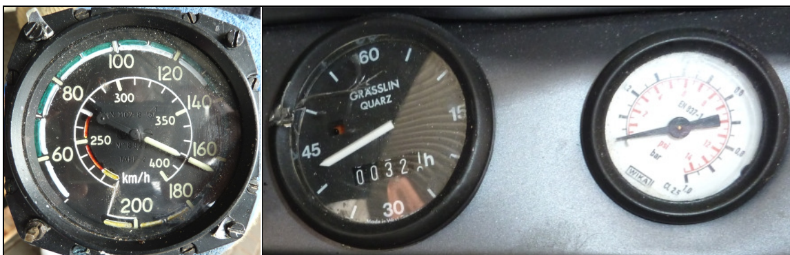
56, 57 – Zbliżenia na przyrządy pokładowe: kolejno od lewej prędkościomierz, licznik motogodzin i manometr oleju.
