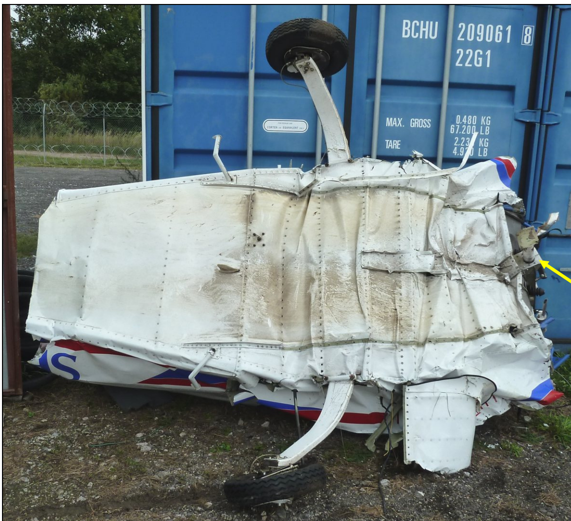
46 – Środkowa część kadłuba po odcięciu, pokazana od spodu, widoczne charakterystyczne zniszczenia dolnych pokryć i podwozia. Goleń podwozia przedniego wskazana żółtą strzałką, przednie koło z widelcem oddzielone od goleni.
