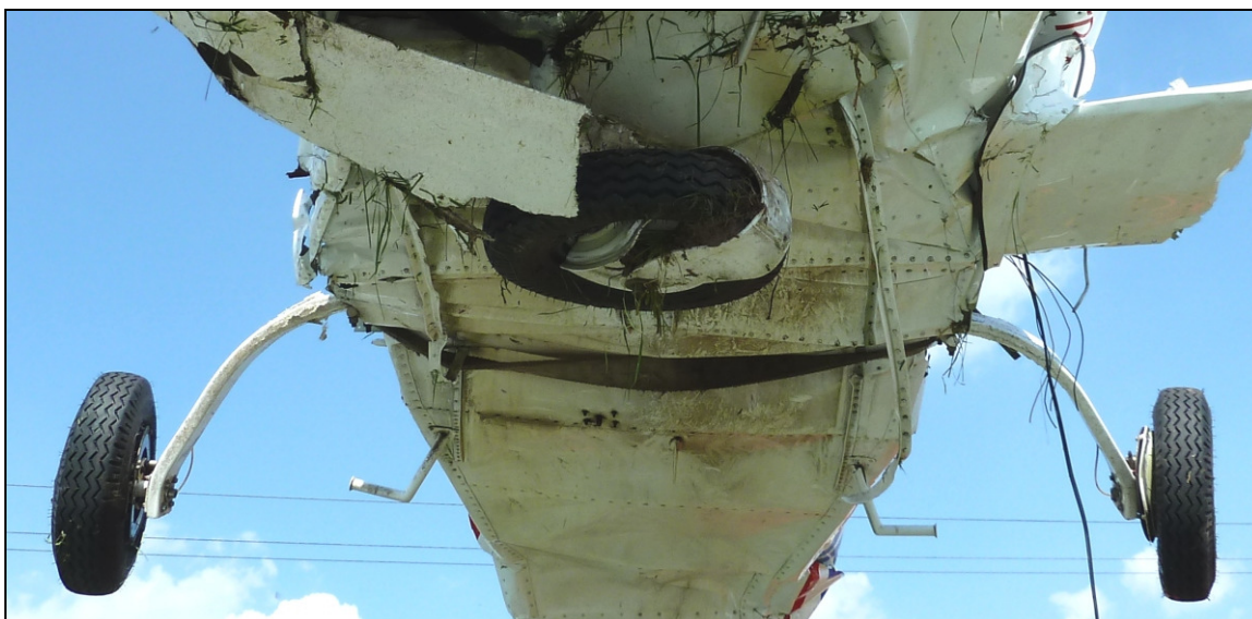
45 – Zbliżenie na podwozie od spodu. Podwozie przednie płasko podgięte do dolnego pokrycia kadłuba.
