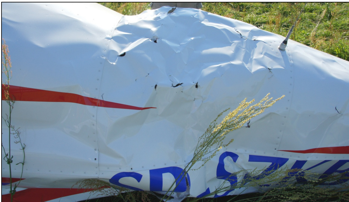
25 – Zdeformowana w wyniku złamania tylna część kadłuba, lewa strona.
