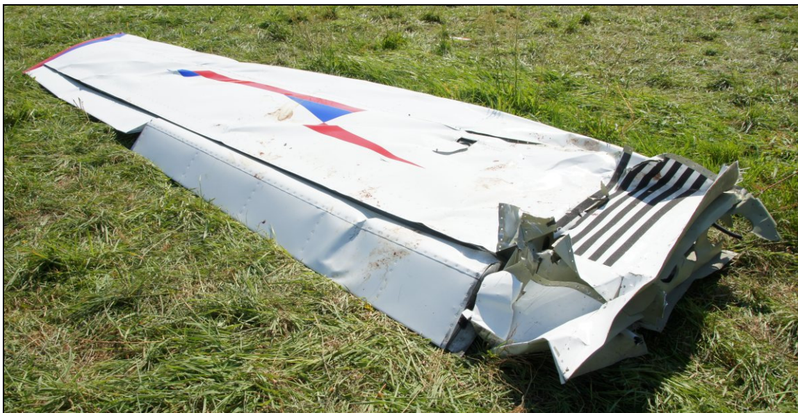
31 – Lewe skrzydło po zdemontowaniu (odcięciu), widziane od strony żebra nasadowego.
