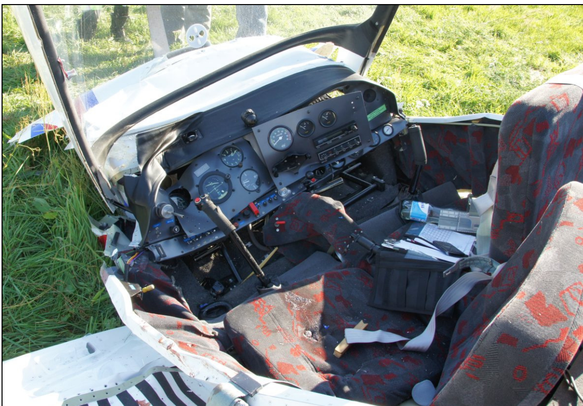
23 – Wnętrze kabiny. Zwraca uwagę wgniecenie tablicy przyrządów.
