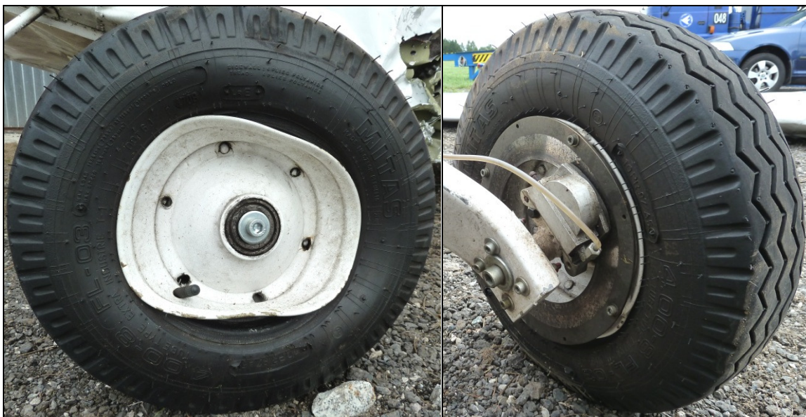
49, 50 – Zniszczone koło lewego podwozia głównego.
