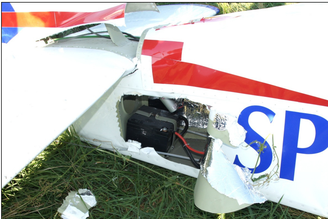
29 – Wycięcie w pokryciu tylnej części kadłuba z prawej strony przed usterzeniem, odsłaniające akumulator pokładowy.
