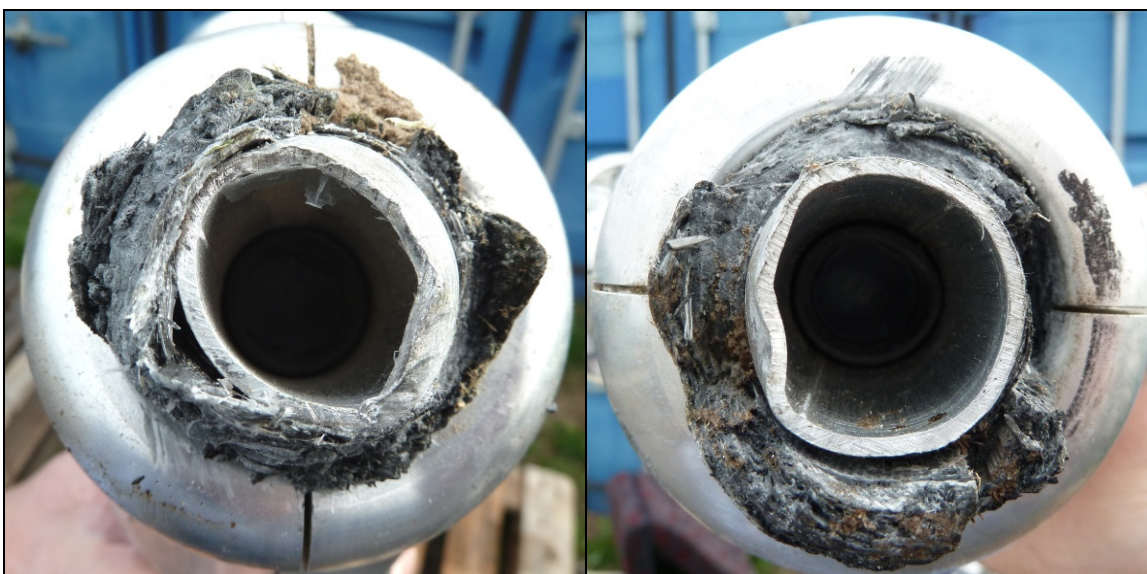
42, 43 – Przelomy zniszczonych łopat śmigła od strony piasty.
