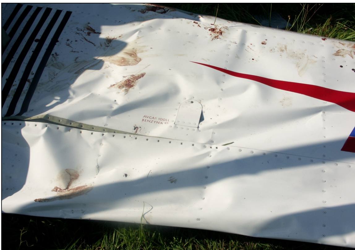
32 – Góme pokrycia lewego skrzydła u nasady od strony krawędzi natarcia – widoczne deformacje w wyniku zderzenia z ziemią.
