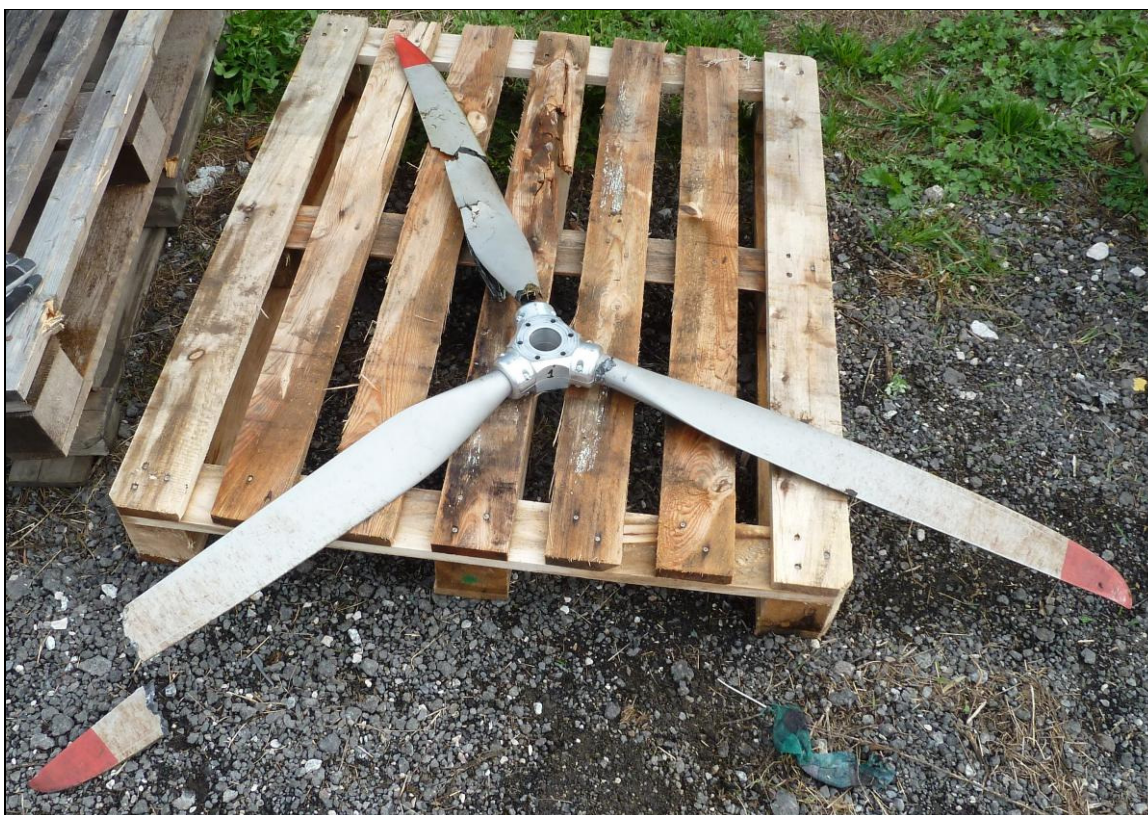
38 – Zniszczone śmigło – widok ogólny.
