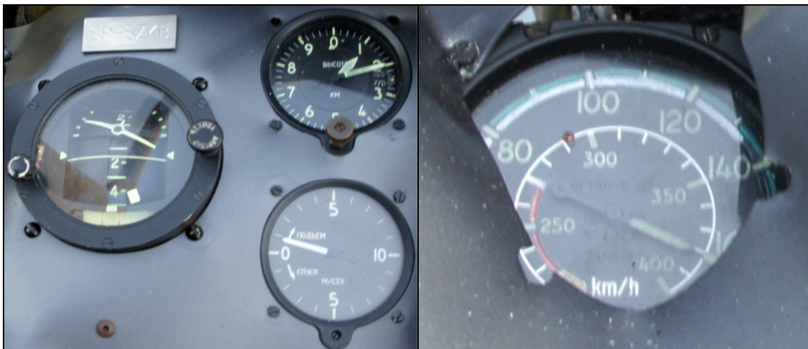
54, 55 – Zbliżenia na przyrządy pokładowe w tablicy: kolejno od lewej sztuczny horyzont, wysokościomierz, wariometr i prędkościomierz.
