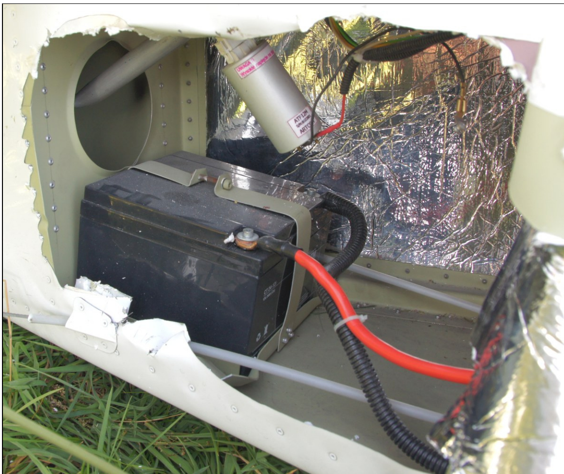
30 – Akumulator zamocowany w tylnej części kadłuba całkowicie bez możliwości szybkiego dostępu z zewnątrz.
