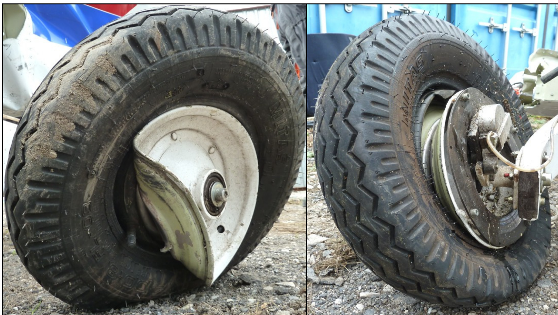
51, 52 – Zniszczone koło prawego podwozia głównego.
