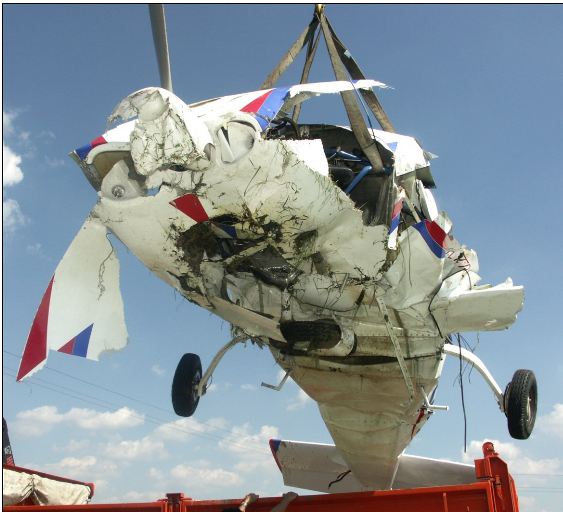
44 – Kadłub zniszczonego samolotu podczas załadunku na przyczepę transportową. Widoczne zniszczenia dolnych pokryć i podwozia.
