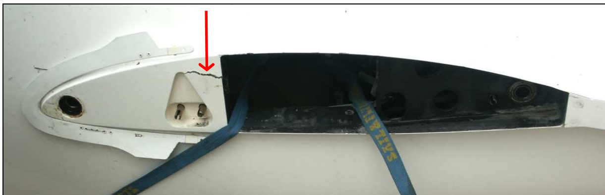
24 – Uszkodzenie pokrycia kadłuba u nasady lewego skrzydła.
