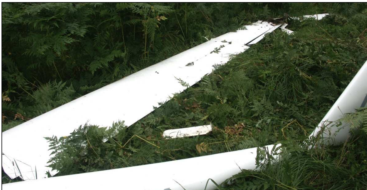
29 – Belka kadłuba i odłamane prawe skrzydło. Między skrzydłem a kadłubem widoczna oderwana prawa pokrywka luku podwozia.
