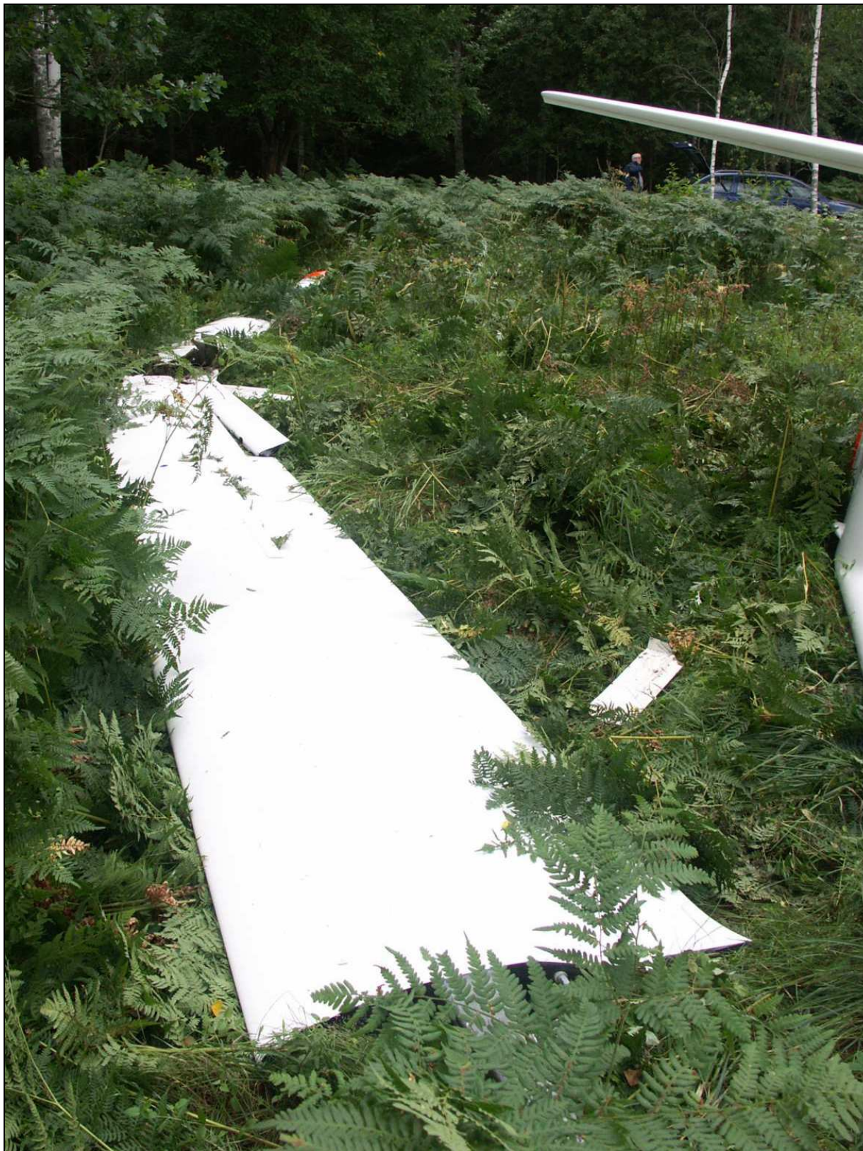
30 – Odłamane prawe skrzydło, widok ogólny. Między skrzydłem a kadłubem widoczna oderwana prawa pokrywka luku podwozia.
