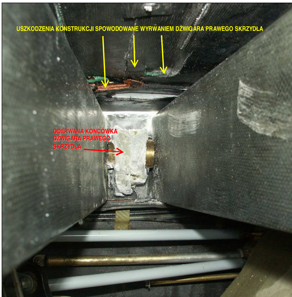
32 - Wnętrze kadłuba, widoczne nasadowe części dźwigara lewego skrzydła i uszkodzenia.
