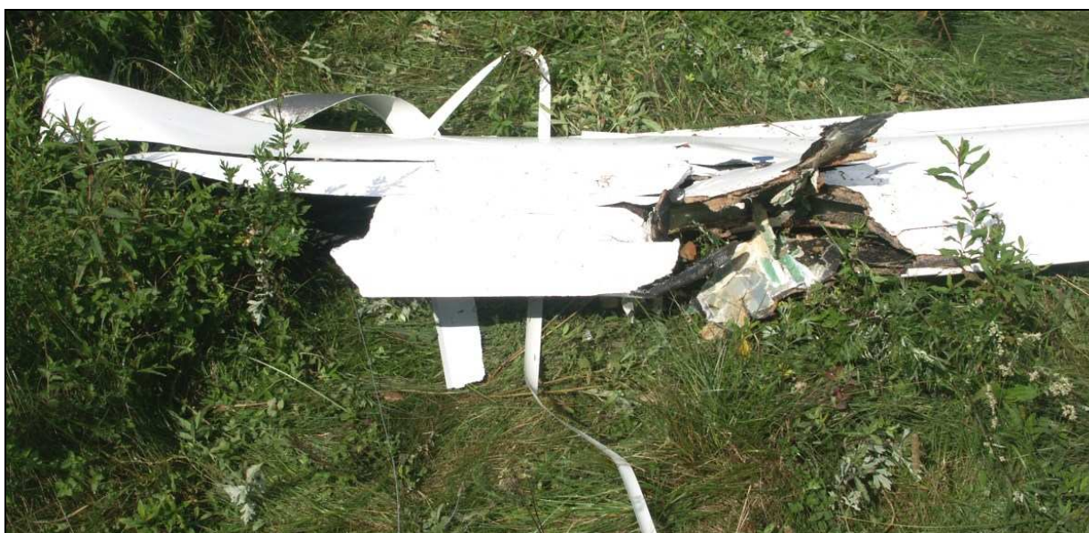
18 – Końcowa część lewego skrzydła, odłamana w wyniku uderzenia o ziemię i o pień młodej sosny - zbliżenie.
