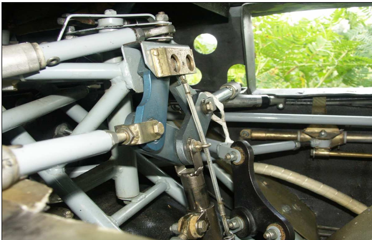
33 – Wnętrze kadłuba po demontażu skrzydeł, widoczne elementy układu sterowania i kratownica struktury.
