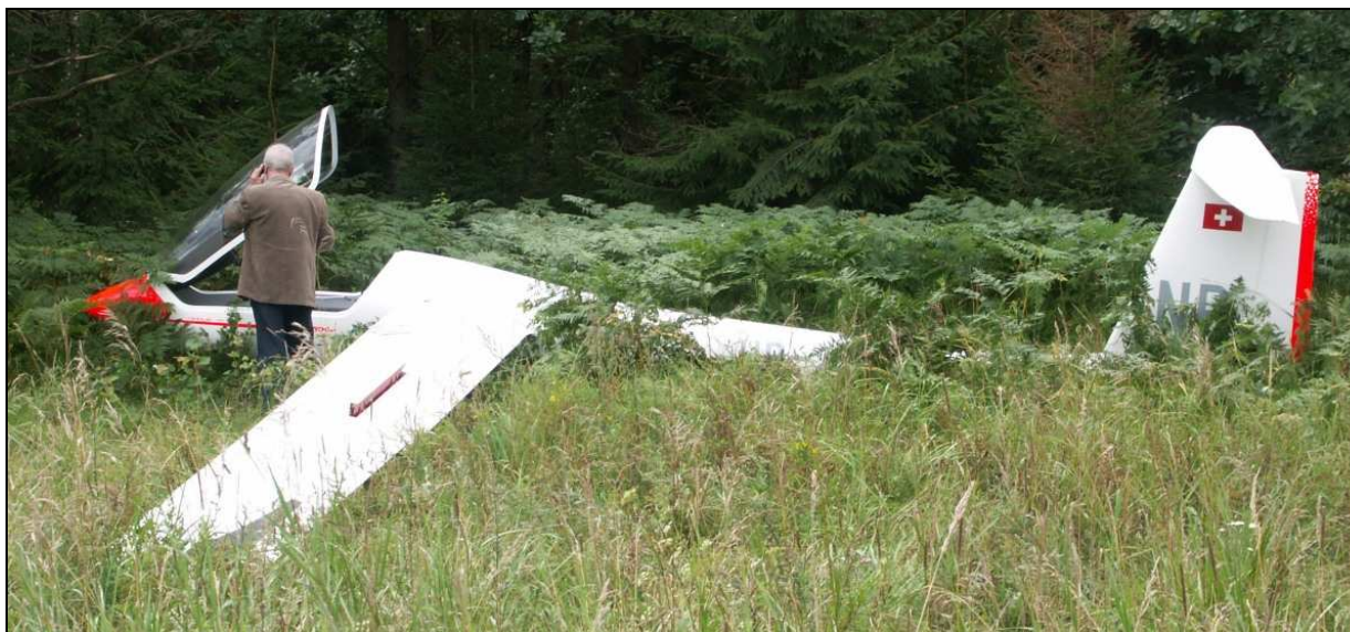
16 – Ogólny widok szybowca z lewej strony, na pierwszym planie uszkodzone lewe skrzydło.
