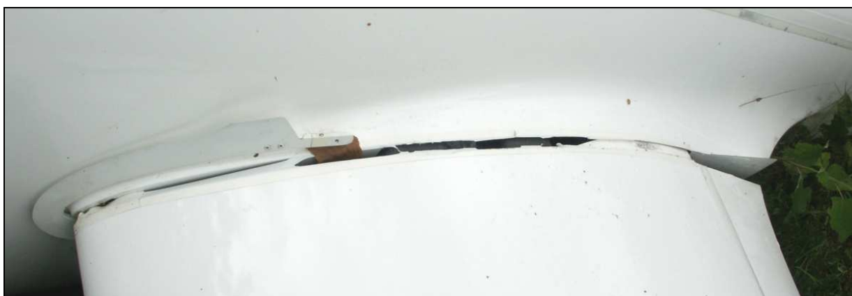
23 – Nasada lewego skrzydła przy kadłubie – widoczne uszkodzenia i odkształcenia.
