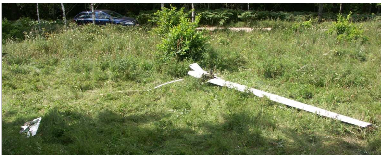
17 – Końcowa część lewego skrzydła, odłamana w wyniku uderzenia o ziemię i o pień młodej sosny.
