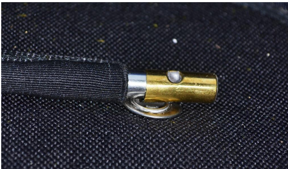
Fot. 3. Końcówka tnąca automatu spadochronowego w stanie po zadziałaniu. Fot PKBWL
