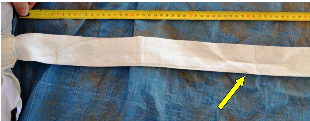
Fot.2. Żółta strzałka wskazuje czarny ślad z naniesionym obcym materiałem podobnym do pokrycia obudowy kamery oraz nietypowe wzdlużne zagięcie taśmy. Najbardziej prawdopodobne miejsce zaczepienia taśmy łączącej o obudowę kamery. Fot. PKBWL.
