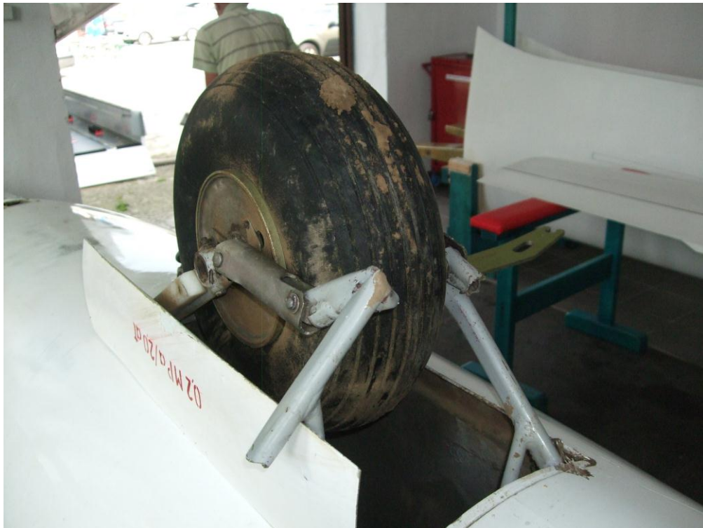
Fot. 3 Uszkodzenie konstrukcji podwozia
