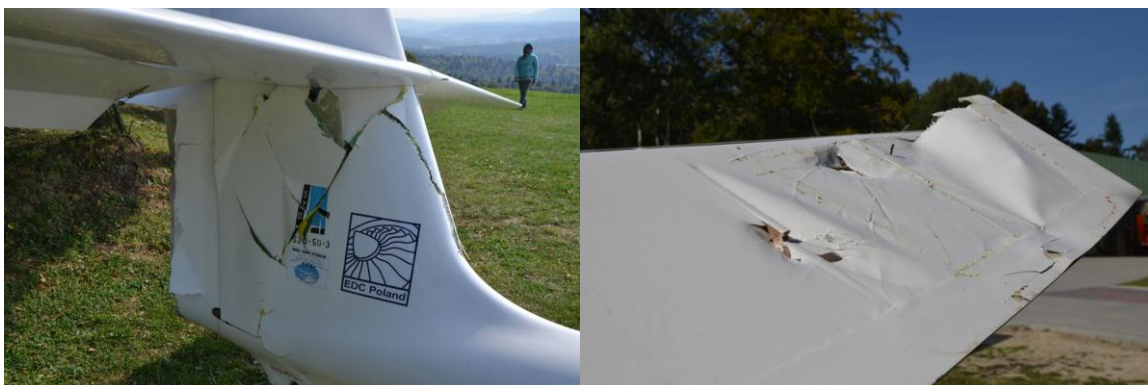
Fot. 3 Widok uszkodzeń szybowca (usterzenie pionowe i pionowe)
