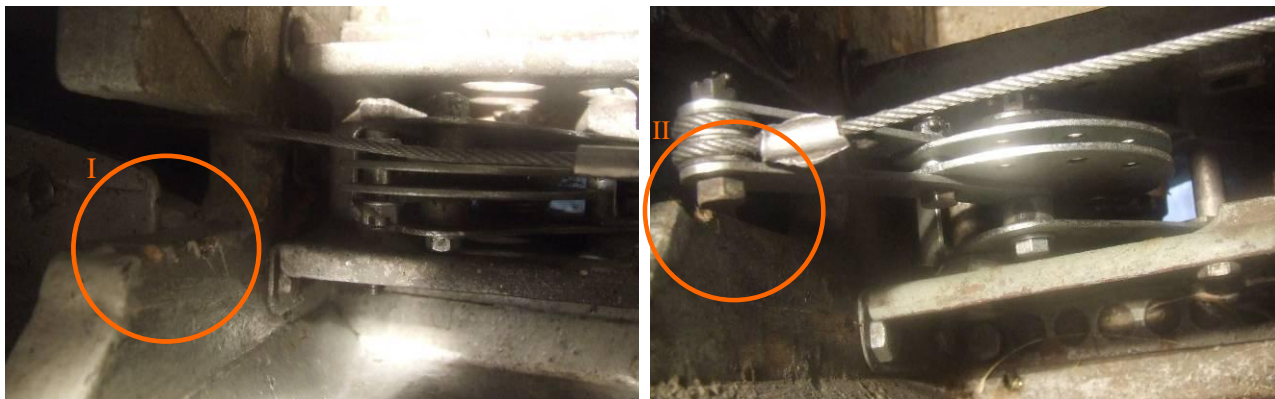
Porównanie warunków pracy zaczepów: I - w szybowcu biorącym udział w zdarzeniu; II - innym szybowcu tego samego typu
