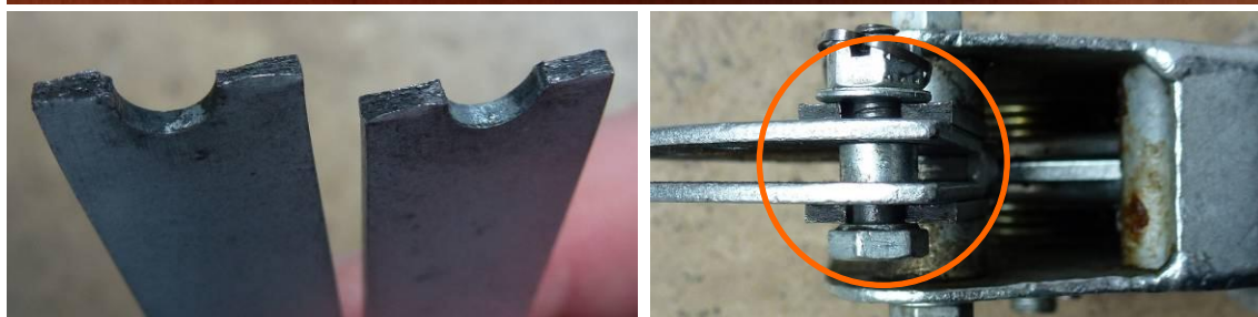
Zaczep holowniczy SZD-III A56 o nr fabr. W 415 z urwaną dźwignią (widok ogólny oraz przełomu na obu elementach)
