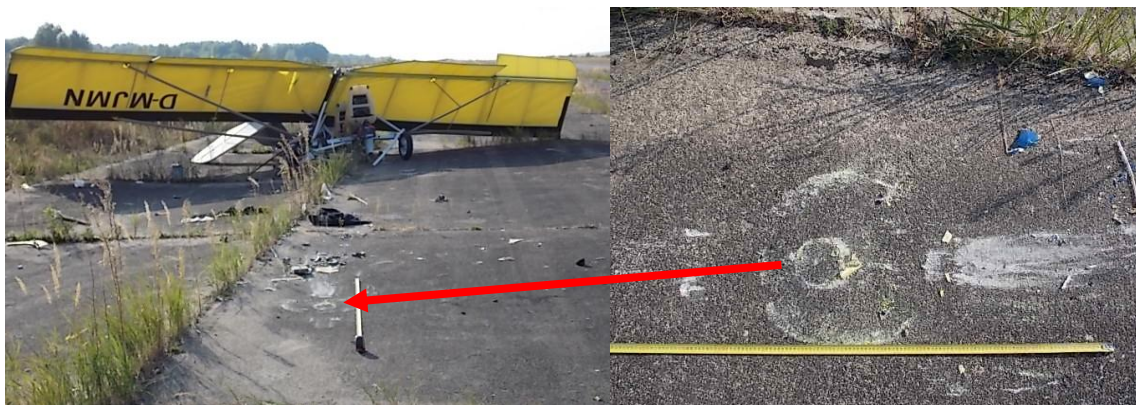
Fot. 1 Miejsce zderzenia samolotu z ziemią
