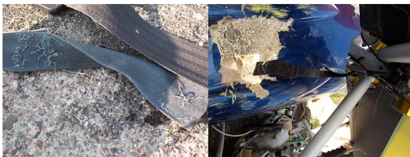
Fot. 2 Widok zerwanych pasów biodrowych i barkowych
