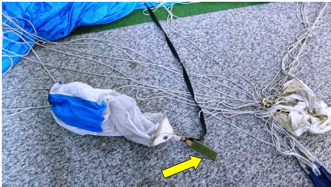
Rys. 1. Widok pilocika z taśmą łączącą przechodzącą przez linkę. Żółta strzałka wskazuje dodatkową taśmę zamocowaną przez mechanika. Fot. PKBWL
