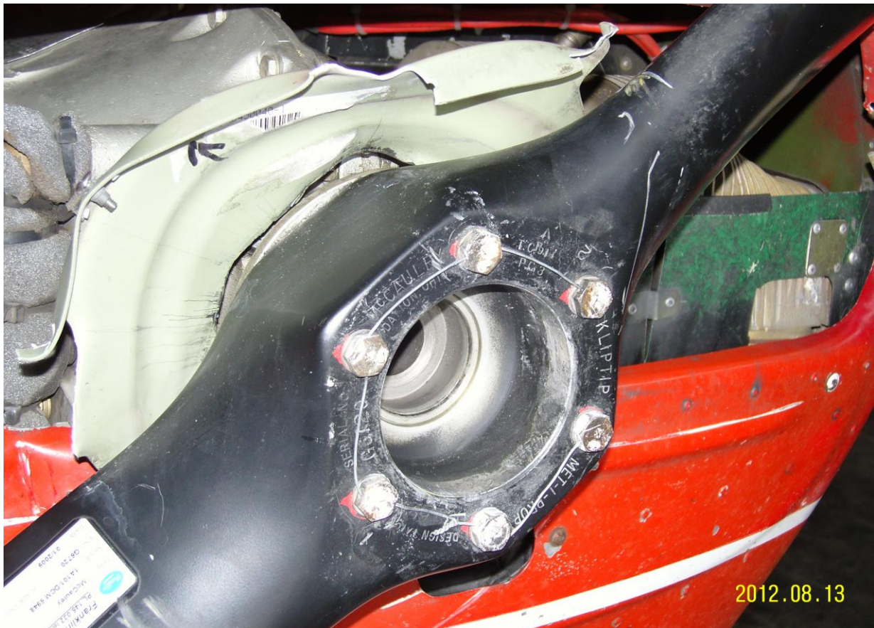
Rys.1. Kołpak i zabezpieczenia śrub mocujących śmigło po lądowaniu. Widoczna rozerwana tarcza kołpaka, nieprawidłowo zabezpieczone śruby oraz zarysowania na śmigle.[foto A. Wr]
