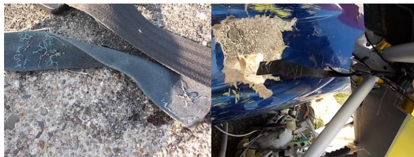
[Fot. PKBWL] Widok zerwanych pasów biodrowych i barkowych
