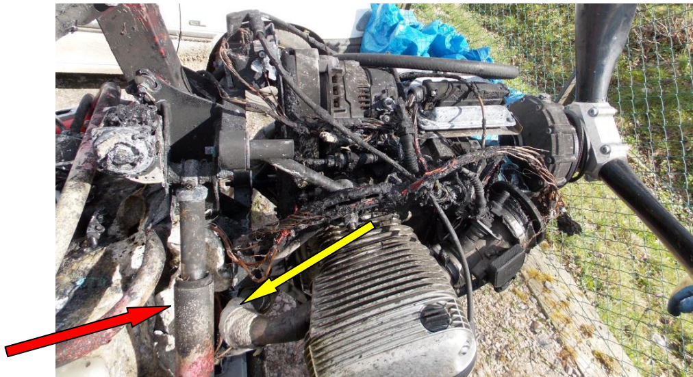
Fot.1. Czerwona strzałka wskazuje rejon zniszczonej tylnej ściany zbiornika paliwa. Żółta strzałka wskazuje rurę wydechową biegnącą od lewego cylindra. Część rury wydechowej była owinięta białym bandażem z niepalnej tkaniny. Fot. PKBWL.
