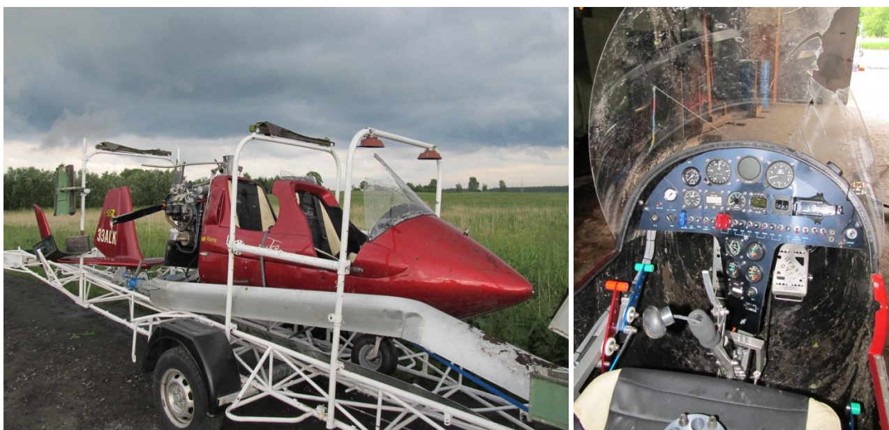
Foto 7, 8. Widok uszkodzeń wiatrakowca – uszkodzeniu uległy między innymi: wirnik nośny, maszt wirnika, śmigło, usterzenie, kabina pilota [zdjęcia: Albert Skorupa]
