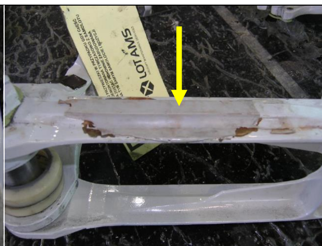
Miejsce naniesienia uszczelniacza i farby.
