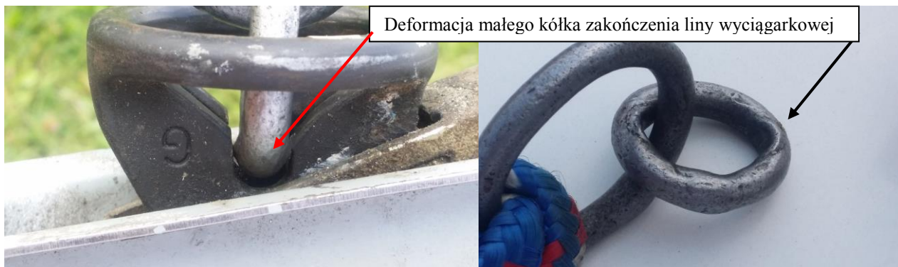
fot.1 Widok zakleszczonego ogniwa w zaczepie.
