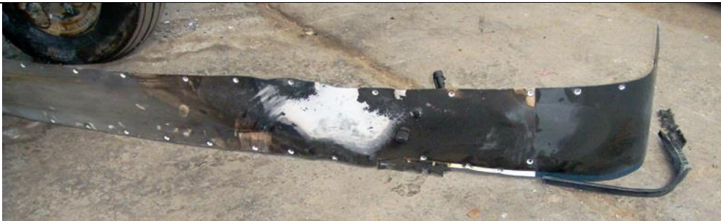
Zdemontowana owiewka skrzydło-kadłub
