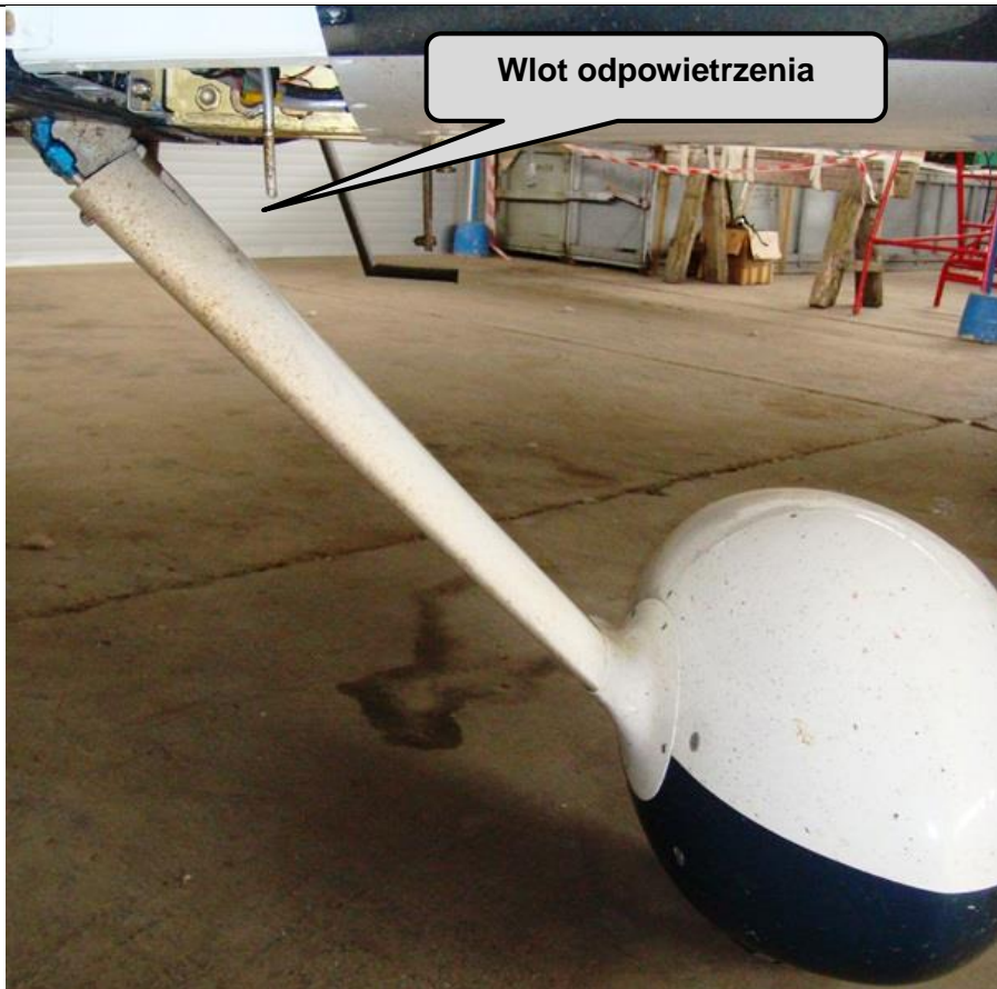
Odpowietrzenie zbiornika paliwa – widok z przodu (lewa strona)
