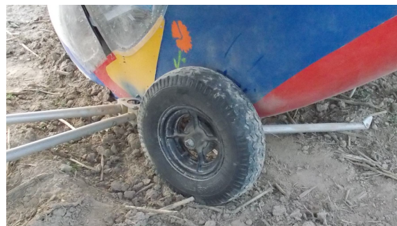
Uszkodzenia lewego podwozia głównego
