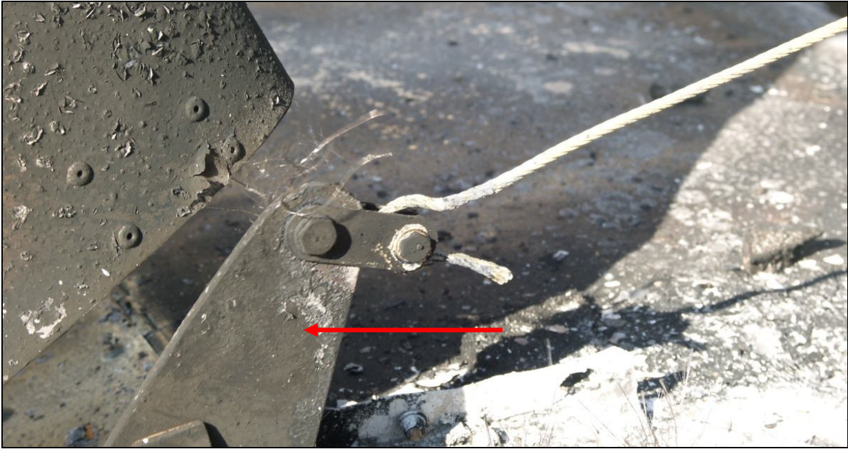
22 – Zbliżenie fragmentu usterzenia z lewej strony. Strzałką wskazana górna dźwignia steru wysokości. Zwraca uwagę brak kauszy i opaski na zakończeniu linki sterowania przy dźwigni, które zostały zniszczone przez pożar.
