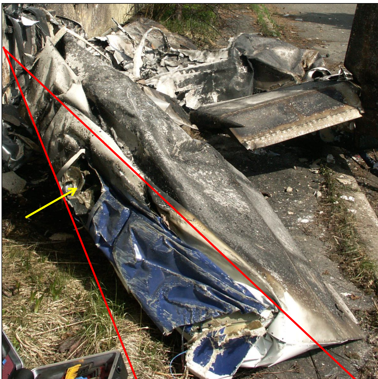
16 – Zniszczone zderzeniem i pożarem lewe skrzydło, widok od strony noska. Kąt ostry między czerwonymi liniami obrazuje kąt, jaki tworzył nosek skrzydła ze ścianą budynku w chwili zderzenia. Żółtą strzałką wskazane reflektory.
