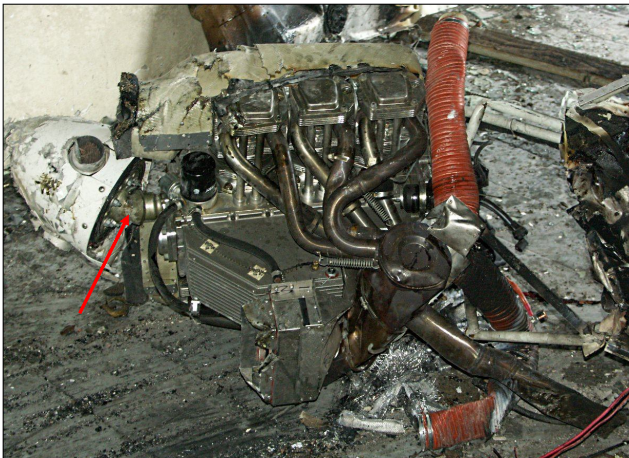
29 – Zespół napędowy – widok od spodu z lewej strony. Zwraca uwagę złamany wał śmigła.
