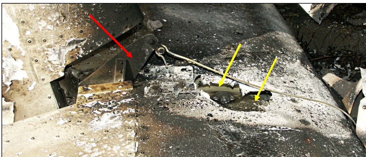
21 – Zbliżenie fragmentu usterzenia z prawej strony. Strzałką wskazana górna dźwignia steru wysokości. Zwraca uwagę wypalenie i wytopienie pokrycia statecznika poziomego w rejonie płaszczyzny symetrii, spowodowane paleniem się kompozytowej owiewki (żółte strzałki).
