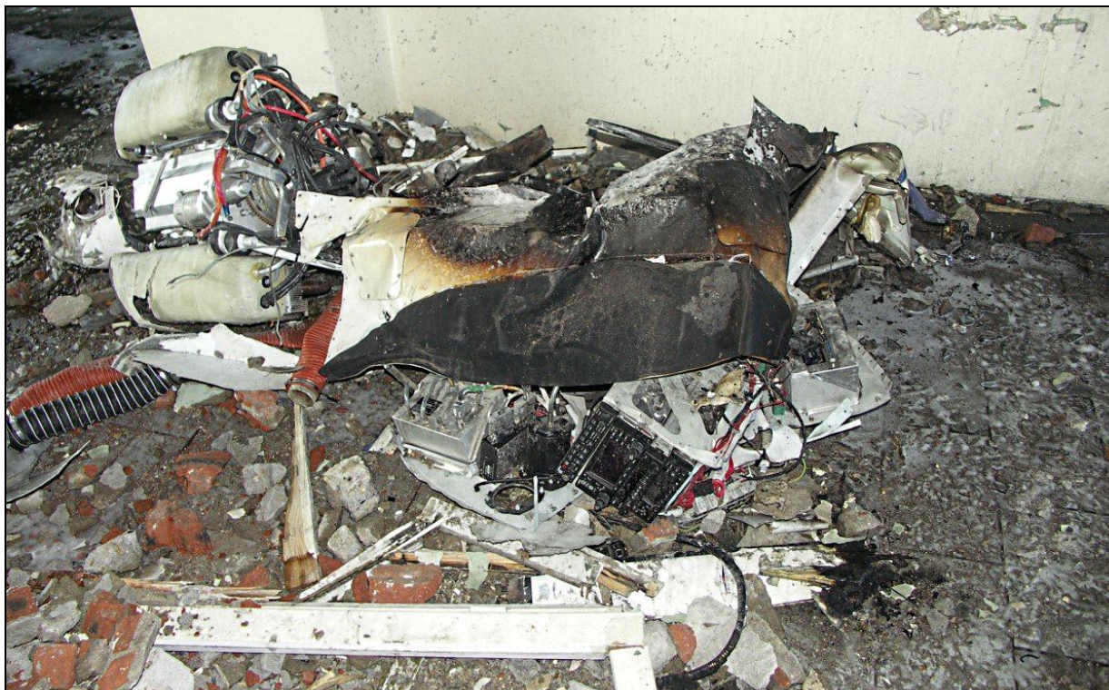
28 – Zespół napędowy i szczątki tablicy przyrządów, które w wyniku wypadku znalazły się wewnątrz pomieszczenia, w którego okno uderzył samolot.
