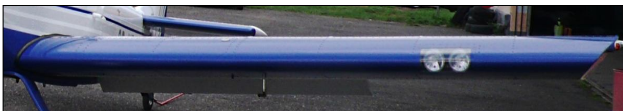
17 – Lewe skrzydło od strony noska na nie zniszczonym samolocie – dla porównania z zasięgiem zniszczeń konstrukcji podczas wypadku, pokazanych na zdjęciu poprzednim. Dobrze widoczne reflektory w nosku skrzydła. [fot. B.Regulski]
