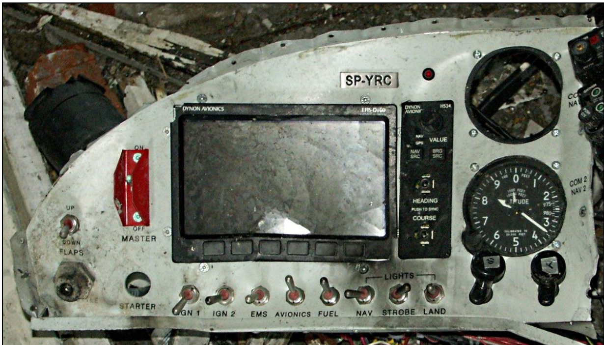
37 – Lewa część tablicy przyrządów. Dobrze widoczne położenia przełączników instalacji elektrycznej. Przełącznik położenia kłap uszkodzony [jego naciśnięcie-wychylenie powoduje uruchomienie napędu wychylania kłap, sam wraca do położenia neutralnego, gdy nie jest naciskany].
