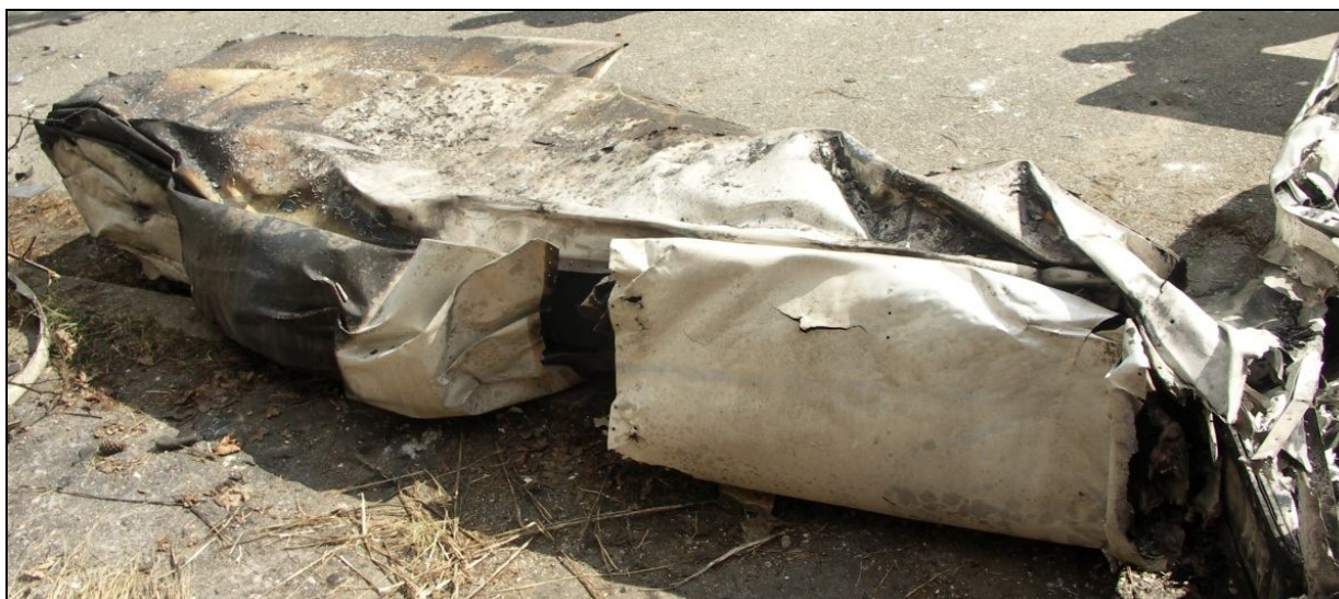
13 – Zniszczone zderzeniem i pożarem prawe skrzydło, widok od strony noska. Kłapa „podwinięta” pod spód skrzydła.
