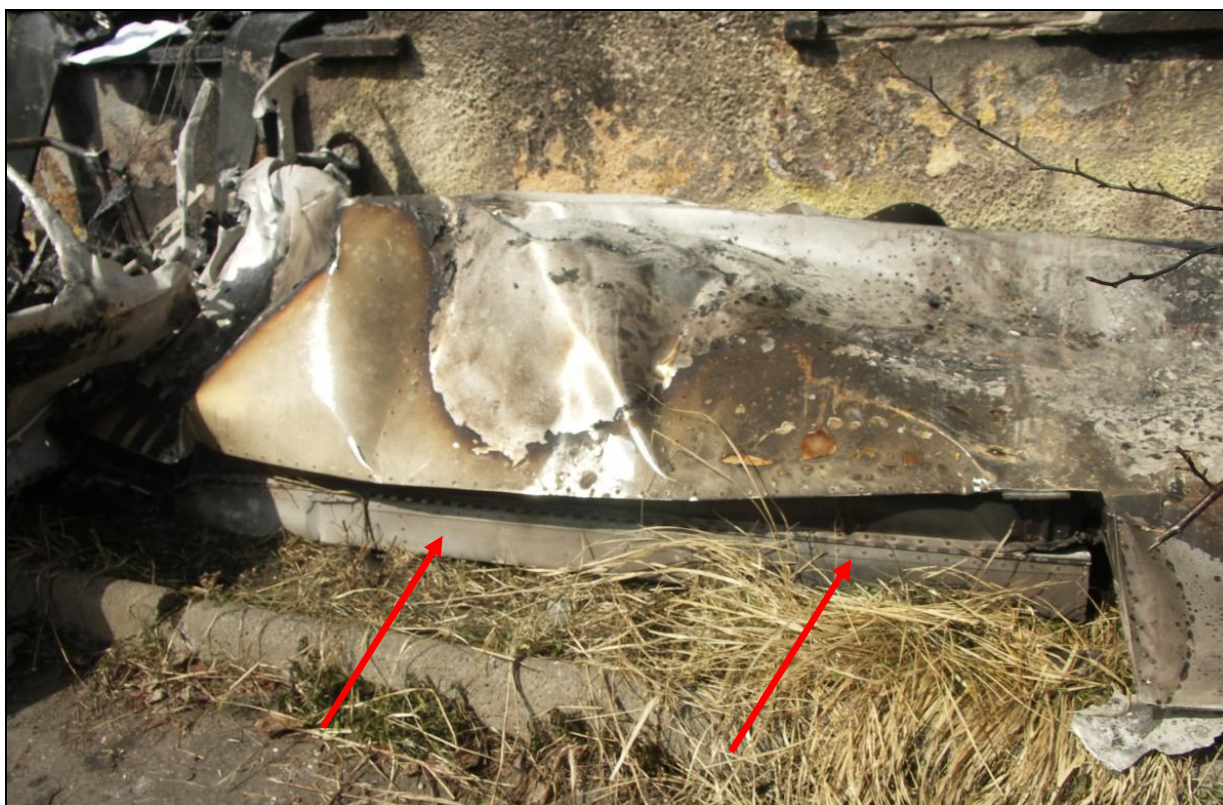
11 – Zniszczone zderzeniem i pożarem prawe skrzydło, część przykadłubowa – zbliżenie. Kłapa „podwinięta” pod spód skrzydła.
