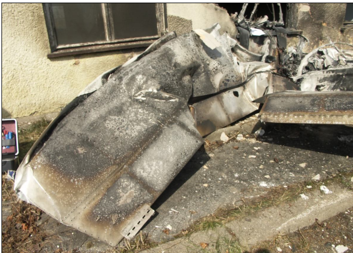
14 – Zniszczone zderzeniem i pożarem lewe skrzydło.
