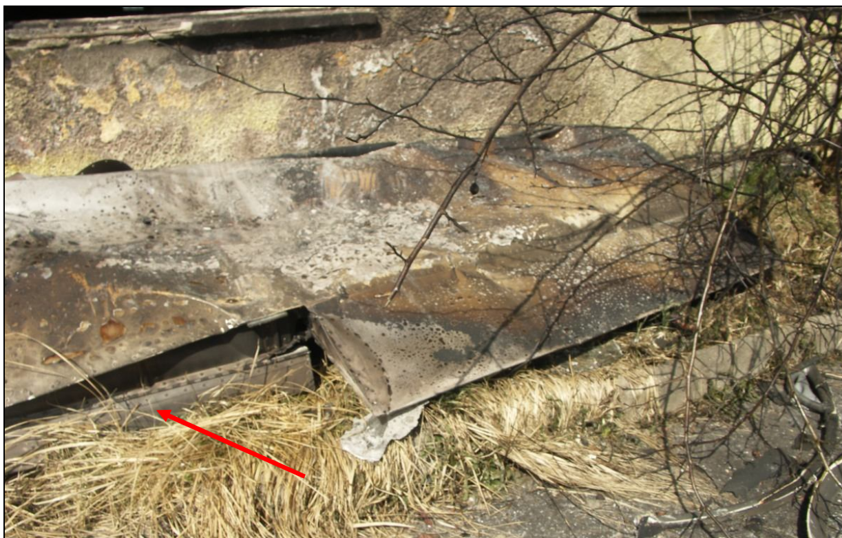
12 – Zniszczone zderzeniem i pożarem prawe skrzydło, część lotkowa – zbliżenie. Kłapa „podwinięta” pod spód skrzydła.
