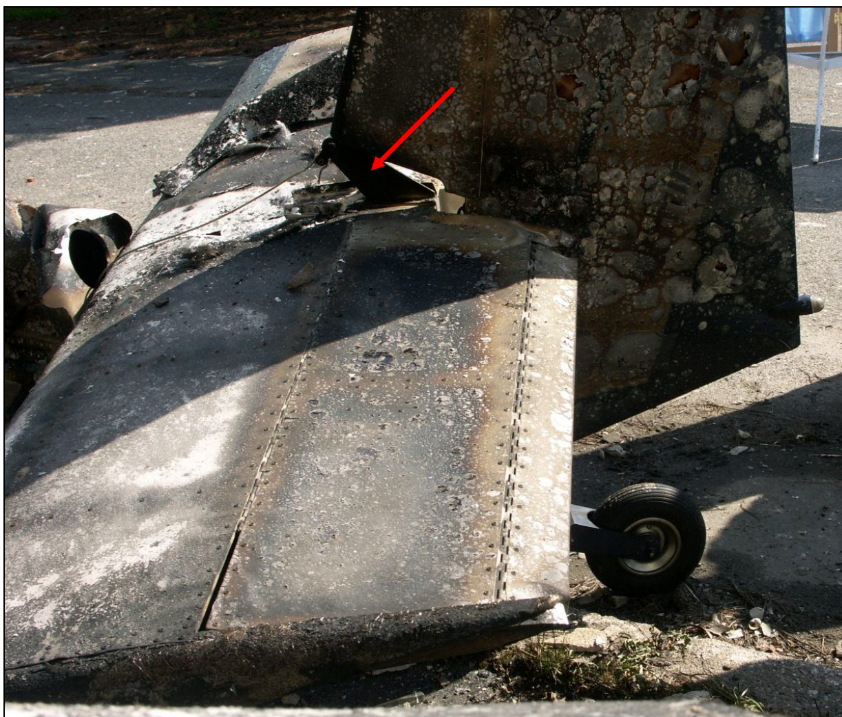
20 – Ogólny widok usterzenia z lewej strony. Strzałką wskazana górna dźwignia steru wysokości.
