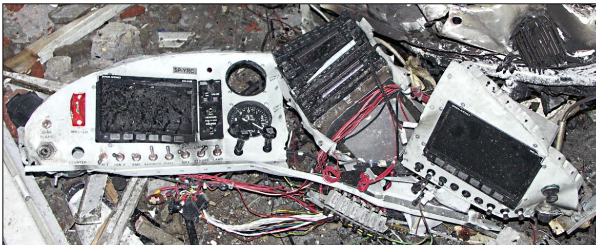
35 – Zniszczona tablica przyrządów w szczątkach samolotu (po odwróceniu).
