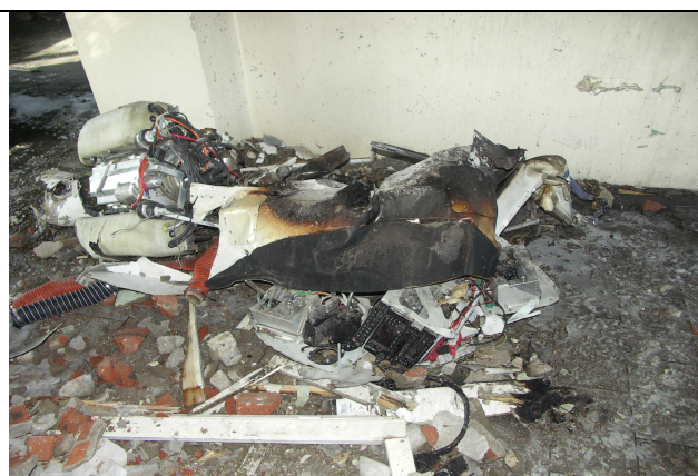
Silnik, radiostacja oraz elementy tablicy przyrządów pokładowych
